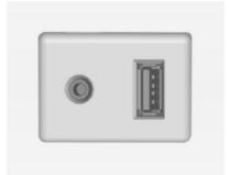
In der Mittelkonsole unterhalb der Bedienelemente für die Klimaanlage gibt es eine AUX- und eine USB-Buchse für den Anschluss externer Audiodatenquellen.
