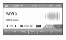
Jeder Wellenbereich verfügt über drei Autostore-Listen (AS 1/3, AS 2/3 und AS 3/3), in denen jeweils fünf Sender gespeichert werden können.
