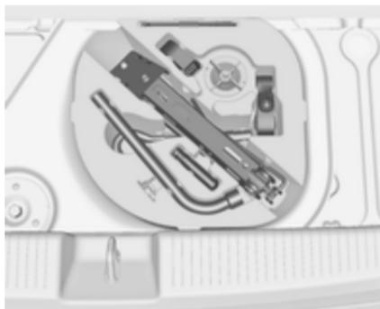
Wagenheber, Radschraubenschlüssel, Wagenwerkzeug und zwei Sicherungsriemen für das defekte Rad befinden sich im Werkzeugkasten unter der Bodenabdeckung im Laderaum ↪ 67.
