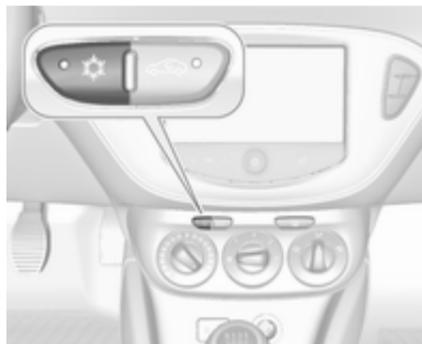
Taste drücken, um die Kühlung einzuschalten. Die Betätigung wird durch die LED auf der Taste angezeigt. Die Kühlung ist nur bei laufendem Motor und eingeschaltetem Klimatisierungsgebläse funktionsfähig.
