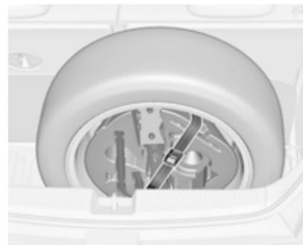
9. Den Werkzeugkasten innen im Rad platzieren und mit dem Riemen **2** fixieren, der durch zwei Speichen des Rades geführt wird.
