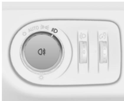
Wird durch Drücken der Taste
