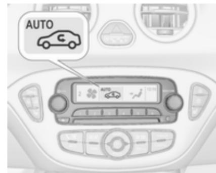
Die Einstellungen der Klimatisierung werden auf dem Info-Display angezeigt. Änderungen der Einstellungen werden kurz über dem aktuell angezeigten Menü eingeblendet.
