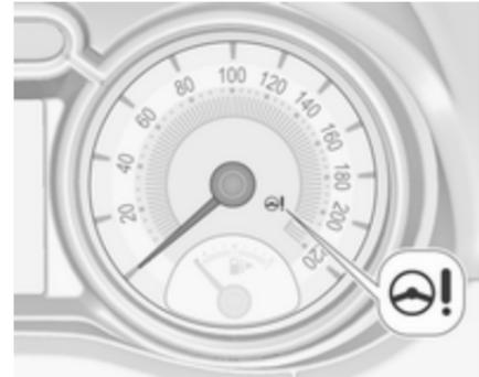
Bei einer Systemstörung leuchtet
