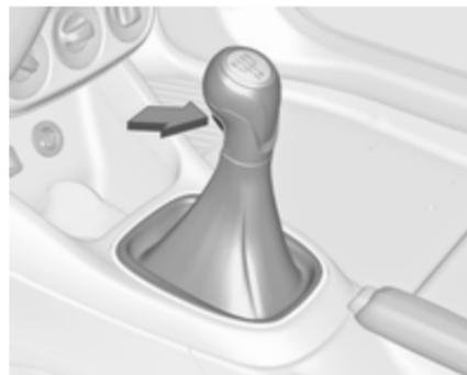
Zum Einlegen des Rückwärtsgangs das Kupplungspedal betätigen, den Knopf am Wählhebel betätigen und den Gang einlegen.
