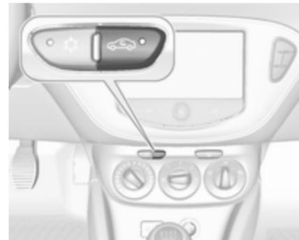
Zum Einschalten des Umluftbetriebs Taste drücken. Die Betätigung wird durch die LED auf der Taste angezeigt.
