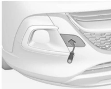
1. Die kleine Kappe mit einem Schraubendreher an der markierten Position lösen.
