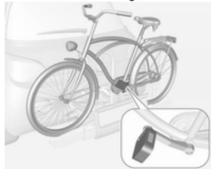
1. Die Pedale in die abgebildete Position drehen und das Fahrrad auf der Radaufnahme platzieren. Das Fahrrad muss mittig auf den Radaufnahmen stehen.
