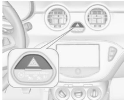
Wird durch Drücken der Taste
