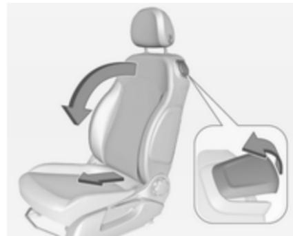
Entriegelungshebel nach vorne ziehen und Rückenlehne nach vorne klappen. Dann den Sitz bis zum Anschlag nach vorne schieben.
