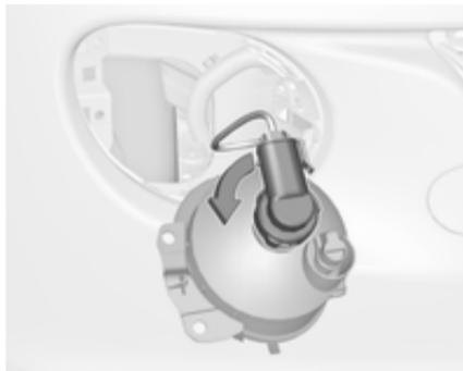
3. Die Lampenfassung durch Drehen nach links lösen und herausnehmen.
