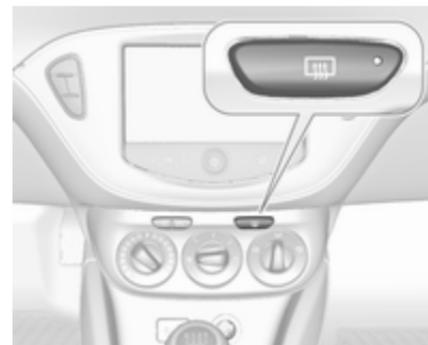
Die Heizung wird durch Drücken der Taste
