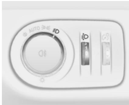
Zur Anpassung der Leuchtweite an die Fahrzeuglast, um Blendwirkung zu reduzieren: Daumenrädchen
