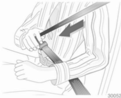
Den Gurt aus dem Aufroller herausziehen, unverdreht über den Körper legen und die Schloßzunge in das Gurtschloß einstecken, bis sie einrastet. Den Beckengurt während der Fahrt durch Ziehen am Schultergurt regelmäßig spannen.
