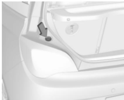
Die Leuchtenbaugruppe mit den Haltestiften in die Aussparungen der Fahrzeugkarosserie einsetzen und die Sicherungsmutter vom Laderauminneren aus festziehen. Den Dichtring über die Aussparung im Leuchtengehäuse ziehen.
