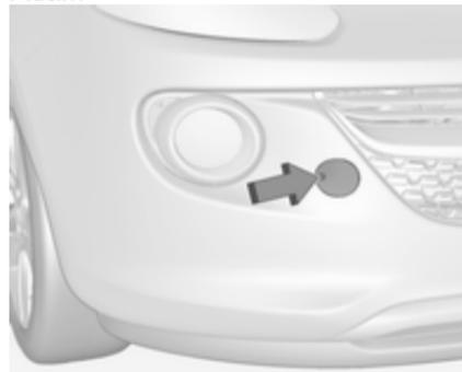
1. Auf die gekennzeichnete Stelle drücken, um die Abdeckung zu lösen.
