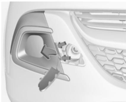
2. Die Abdeckung zum Entfernen mit den Fingern an den markierten Stellen herausziehen, siehe Pfeile in der Abbildung.
