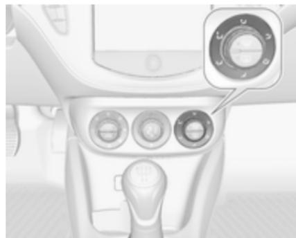
Den rechten Drehknopf auf die gewünschte Einstellung drehen. Die Einstellung wird auf dem Info-Display angezeigt.
