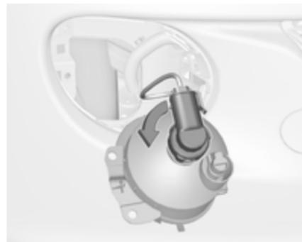
4. Die Lampenfassung durch Drehen nach links lösen und herausnehmen.
