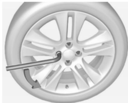
2. Radschraubenschlüssel ansetzen und sicherstellen, dass er gut sitzt. Die Radschrauben jeweils eine halbe Umdrehung lösen.
