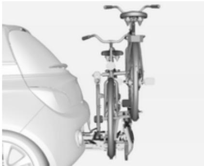
Das Heckträgersystem (Flex-Fix-System) bietet die Möglichkeit, ein Fahrrad auf einem in den Fahrzeugboden integrierten herausziehbaren Träger zu befestigen. Auf einem Anbaustück kann ein weiteres Fahrrad transportiert werden. Der Transport anderer Gegenstände ist nicht zulässig.
