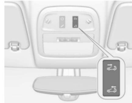
Der Schalter kann auf zwei Arten bedient werden: Kurzes Drücken für Automatikbetrieb und längeres Drücken für manuelle Bedienung.
