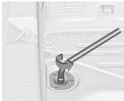
3. Radschraubenschlüssel auf die Sechskantschraube in der Nähe des Werkzeugkastens aufsetzen und gegen den Uhrzeigersinn drehen, bis ein Widerstand bemerkbar ist.
