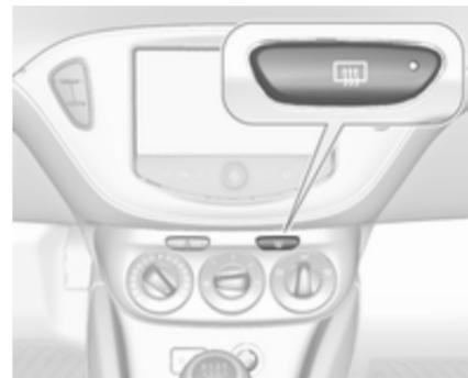
Wird durch Drücken der Taste
