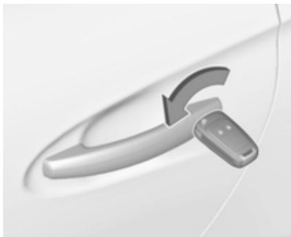
Fahrtür durch Drehen des Schlüssels im Schloss manuell entriegeln. Zündung einschalten und Zentralverriegelungstaste
