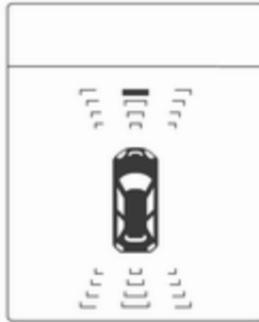
Der Abstand zu einem Hindernis an der Front oder am Heck wird durch Änderung der Abstandslinien im Driver Information Center angezeigt.
