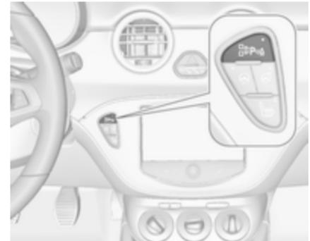
Bei der Front-Heck-Einparkhilfe und der erweiterten Einparkhilfe wird jeweils dieselbe Taste zur Aktivierung und Deaktivierung verwendet:
