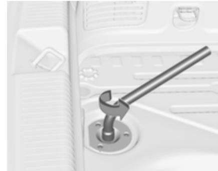
3. Radschraubenschlüssel auf die Sechskantschraube in der Nähe des Werkzeugkastens aufsetzen und linksherum drehen, bis ein Widerstand bemerkbar ist.
