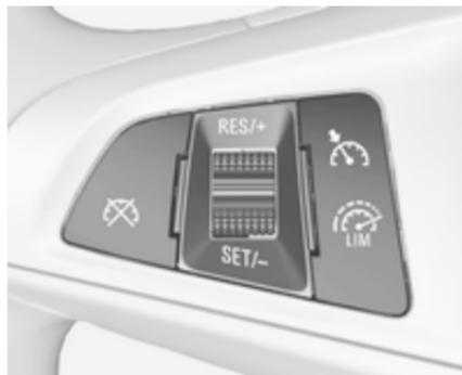
☁ drücken. Wenn zuvor der Geschwindigkeitsregler aktiviert wurde, wird dieser beim Aktivieren des Geschwindigkeitsbegrenzers ausgeschaltet. Die Kontrollleuchte
