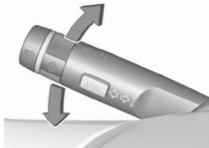
Hebel nach oben : Blinker rechts
