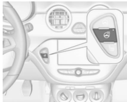
Die Heizung durch Drücken von ☼ einschalten. Die Betätigung wird durch die LED in der Taste angezeigt.
