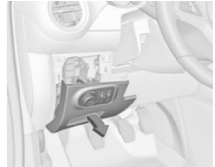
Der Sicherungskasten befindet sich hinter dem Lichtschalter in der Instrumententafel.
