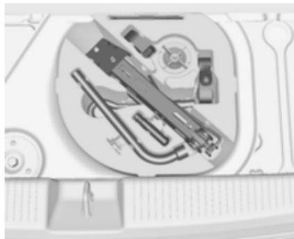
Wagenheber, Radschraubenschlüssel, Wagenwerkzeug und zwei Sicherungsriemen für das defekte Rad befinden sich im Werkzeugkasten unter der Bodenabdeckung im Laderaum ↷ 68.
