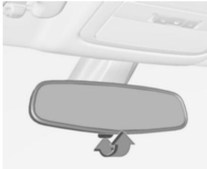
Den Hebel an der Unterseite des Spiegelgehäuses nach vorne oder hinten bewegen, um die Blendwirkung zu verringern. In der normalen Betriebsposition befindet sich der Hebel in der mittleren Stellung.
