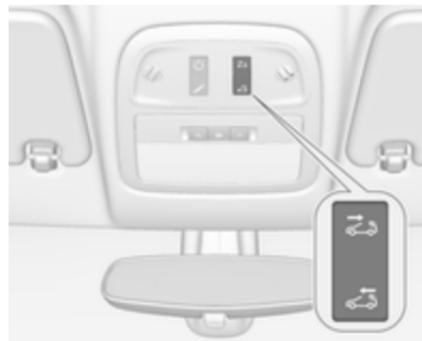
Der Schalter kann auf zwei Arten bedient werden: Kurzes Drücken für Automatikbetrieb und längeres Drücken für manuelle Bedienung.
