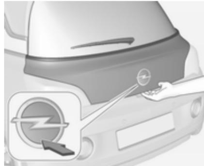
Zum Entriegeln und Öffnen der Hecktür auf die untere Hälfte des Markenemblems drücken.
