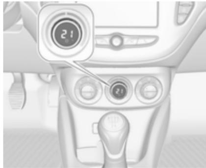
Ist die Mindesttemperatur **Lo** eingestellt, läuft die Klimaanlage mit maximaler Kühlung, sofern Kühlung ☀ eingeschaltet ist.
