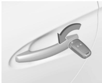
Fahrtür durch Drehen des Schlüssels im Schloss manuell entriegeln. Zündung einschalten und Zentralverriegelungstaste
