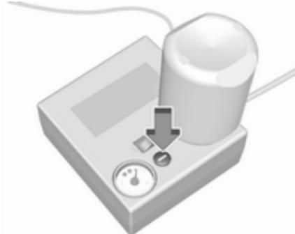
Wird der vorgeschriebene Reifendruck nicht innerhalb von zehn Minuten erreicht, das Reifenreparaturset entfernen. Das Fahrzeug um eine Reifenumdrehung bewegen. Das Reifenreparaturset
