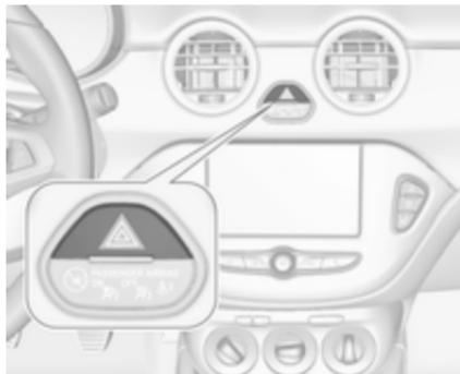
Wird durch Drücken von ▲ bedient.
