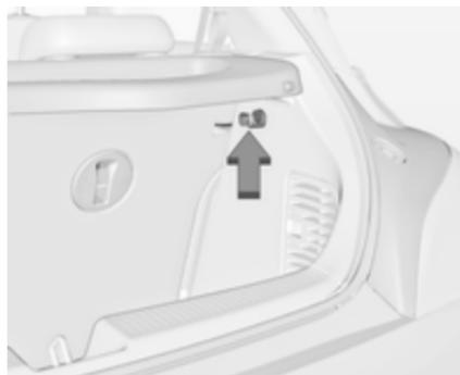
Der Haken an der rechten Seitenwand im Laderaum kann für Tragetaschen verwendet werden. Maximales Tragvermögen: 5 kg.
