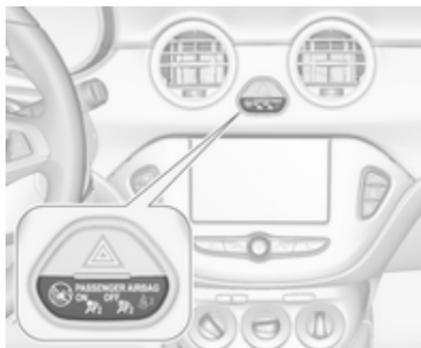
Wenn die Kontrollleuchte
