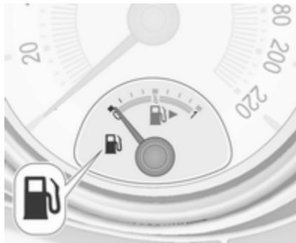
Zeigt den Füllstand im Kraftstofftank an.
