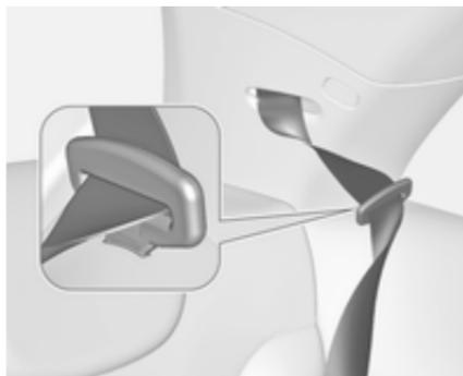
Die Schlosszunge des Sicherheitsgurtes in den seitlichen Halter stecken, um den Gurt vor Beschädigung zu schützen.
