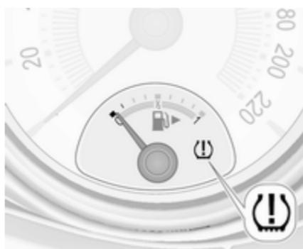
Wenn niedriger Reifendruck erkannt wird, wird dies durch die Kontrollleuchte (⚠) gemeldet ⇨ 92.
