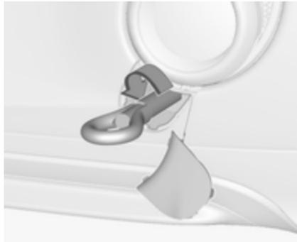
Abschleppöse bis zum Anschlag in waagrechter Stellung einschrauben.
