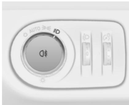
Wird durch Drücken von
