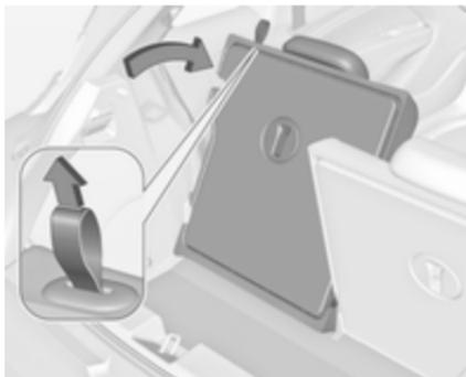
An der Schlaufe einer oder beider Rückenlehnen ziehen und diese auf die Sitzfläche umklappen.
