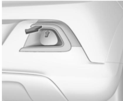
1. Die Abdeckung zum Entfernen mit der Hand an der markierten Stelle herausziehen, siehe Pfeil in der Abbildung.
