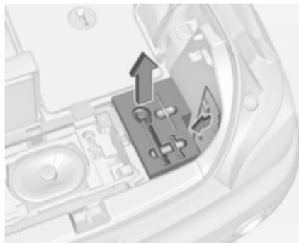
Um Zugang zur rechten Abdeckung im Laderaum zu erhalten, etwa zum Auswechseln von Glühlampen, die rechte hintere Rückenlehne umklappen und den Werkzeugkasten neben dem Subwoofer herausziehen.
