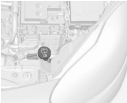
Mit einem Gemisch aus sauberem Wasser und einer geeigneten Menge zugelasener Scheibenwaschflüssigkeit mit Frostschutzmittel auffüllen.
