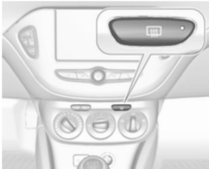
Wird durch Drücken von
