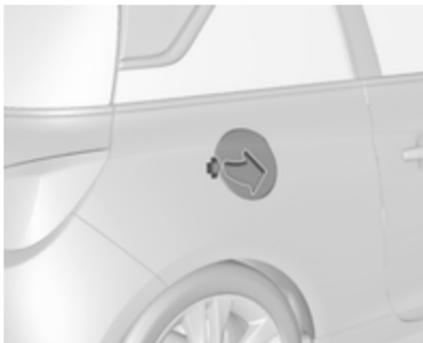
Die Tankklappe lässt sich nur bei entriegeltem Fahrzeug öffnen.
