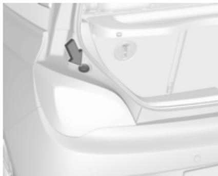
Den Leuchtenzusammenbau mit den Haltestiften in die Aussparungen der Fahrzeugkarosserie einsetzen und die Kunststoffsicherungsmutter vom Laderauminnen aus festziehen. Den Dichtring über die Aussparung im Leuchtengehäuse ziehen.
