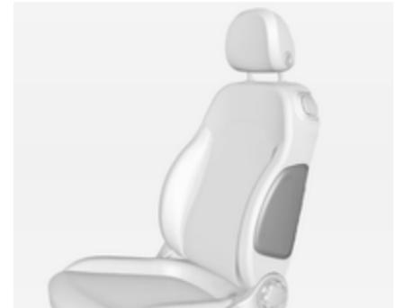
Das Seiten-Airbag-System besteht aus einem Airbag in der Rückenlehne jedes Vordersitzes. Diese Stelle ist durch das Wort **AIRBAG** gekennzeichnet.
