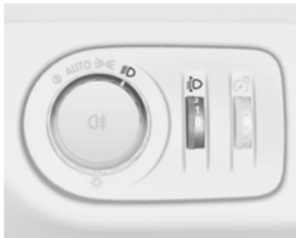
Zur Anpassung der Leuchtweite an die Fahrzeuglast, um Blendwirkung zu reduzieren: Daumenrädchen
