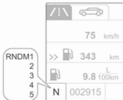
Im Automatikmodus wird das Fahrprogramm durch **D** im Driver Information Center angezeigt.
