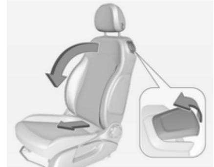
Entriegelungshebel nach vorne ziehen und Rückenlehne nach vorne klappen. Dann den Sitz bis zum Anschlag nach vorne schieben.
