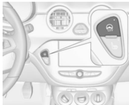
Bei laufendem Motor
