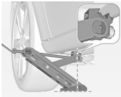
4. Wagenheber auf die erforderliche Höhe einstellen. Direkt unter dem Wagenheberaufnahmeepunkt so positionieren, dass er nicht abrutschen kann.
