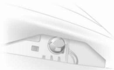
1. Lampenträger durch Drehen und Wegziehen vom Fahrzeug ausbauen.
