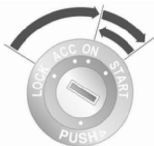
Schlüssel in Stellung **ACC** drehen. Lenkrad zum Lösen der Lenkrsperre leicht bewegen. Kupplung und Bremse betätigen, Automatikgetriebe in **N** oder **P** schalten, kein Gas geben; Schlüssel auf **START** drehen und Schlüssel loslassen.
