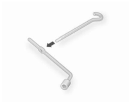
4. Wagenhebergriff am Radschraubenschlüssel anbringen (wie in der Abbildung dargestellt) und das Hakenende des Wagenhebergriffs in die Wagenheberöse einhängen.
