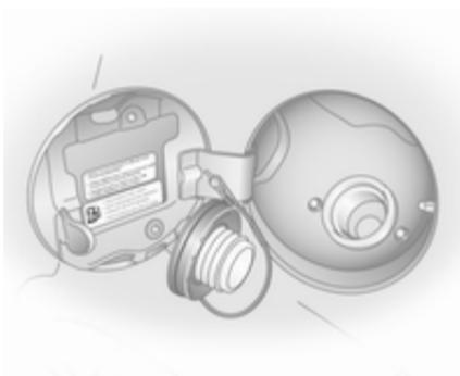
Tankdeckel öffnen: Entgegen dem Uhrzeigersinn drehen.
