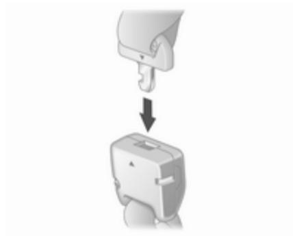
Die Schließungenverbindung des mittleren Rücksitzgurtes aus dem Schlitz der Deckenhalterung ziehen. Mit übereinstimmenden Pfeilen bis zum hörbaren Einrasten in die Verbindung einsetzen.
