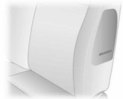
Das Seiten-Airbag-System besteht aus einem Airbag in der Rückenlehne jedes Vordersitzes. Dies ist durch die Aufschrift **SRS AIRBAG** gekennzeichnet.
