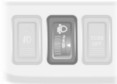
Zur Anpassung der Scheinwerfer-Leuchtweite an die Fahrzeuglast, um Blendwirkung zu reduzieren: Rändelrad in gewünschte Stellung drehen.
