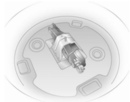
Wagenheber und Wagenwerkzeug befinden sich in einem Staufach im Laderaum unter dem Reserverad. Reserverad ↷ 119.
