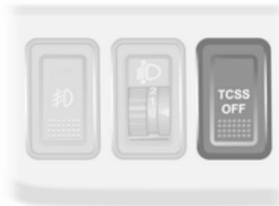
Die Traktionskontrolle kann ausgeschaltet werden, wenn ein Durchdrehen der Antriebsräder erwünscht ist: Taste **TCSS OFF** drücken.
