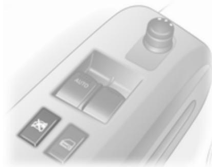
Wenn sich ein Kind auf dem Beifahrersitz befindet, den Schalter
