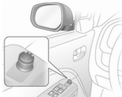
Entsprechenden Außenspiegel durch Drehen des Schalters nach links (L) oder rechts (R) auswählen. In Mittelstellung ist kein Spiegel ausgewählt. Danach das Bedienelement schwenken, um den Spiegel einzustellen.
