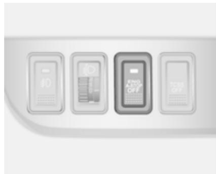
Die Stopp-Start-Automatik lässt sich durch Drücken der Taste **ENG A-STOP OFF** manuell deaktivieren. Die Deaktivierung wird durch das Aufleuchten der gelben Anzeige **ENG A-STOP** im Instrument angezeigt.
