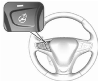
Die Heizung durch Drücken von
