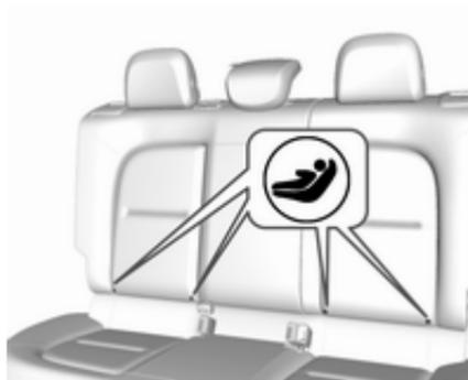
Für das Fahrzeug zugelassene ISOFIX-Kindersicherheitsysteme an den ISOFIX-Befestigungshalterungen befestigen. Die speziellen Positionen für ISOFIX-Kindersicherheitsysteme sind aus der ISOFIX-Tabelle ersichtlich ⇨ 57.
