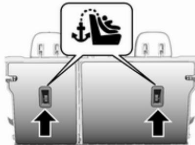
Zusätzlich zu den ISOFIX-Befestigungshalterungen den Top-Tether-Gurt an den Top-Tether-Befestigungsösen befestigen.
