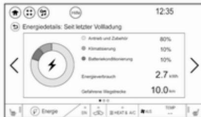
Der Bildschirm **Energiedetails** zeigt, wie die Energie seit dem letzten vollständigen Aufladen der Hochspannungsbatterie verwendet wurde. Dies umfasst **Fahrstil und Nutzergeräte**, **Klima-Einstellungen** und **Batterie-Optimierung**. Das Kreisdiagramm
