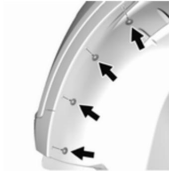
1. Das Rad drehen und die Schrauben an der Außenseite der Radblende abnehmen.
