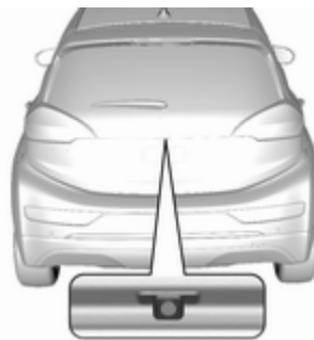
Die Kamera ist zwischen den Kennzeichenleuchten integriert und verfügt über einen Blickwinkel von 130°.
