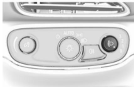
Zur Anpassung der Leuchtweite an die Fahrzeugbeladung, um Blendwirkung zu reduzieren: Daumenrad  $\text{D}$  in die gewünschte Stellung drehen.
