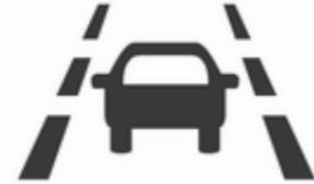
Wenn die Kontrollleuchte
