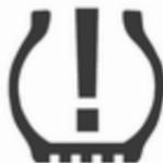
Wenn niedriger Reifendruck erkannt wird, wird dies durch die Kontrollleuchte  $\text{!}$  gemeldet  $\diamond$  85.
