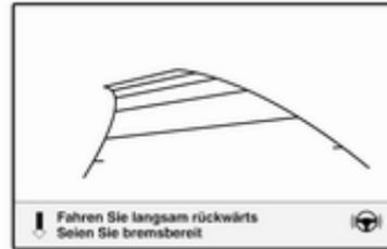
Die vom System vorgeschlagene Parklücke gilt als akzeptiert, wenn der Fahrer das Fahrzeug innerhalb von 10 Metern (Längsparklücken) bzw. 6 Metern (Querparklücken) nach dem Aufleuchten der Meldung **Stop** anhält. Das System berechnet den optimalen Fahrweg in die Parklücke.
