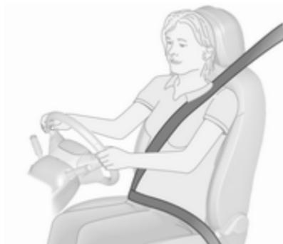
Sicherheitsgurt herausziehen und im Gurtschloss einrasten. Der Sicherheitsgurt muss unverdreht und eng am Körper anliegen. Die Rückenlehne darf nicht zu weit nach hinten geneigt sein (maximal ca. 25°). Zum Lösen rote Taste am Gurtschloss drücken.
