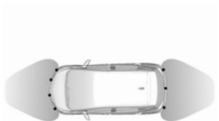
Das System umfasst vier Ultraschall-Parksensoren im Frontstoßfänger und drei Ultraschall-Parksensoren im Heckstoßfänger.
