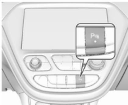
Eine leuchtende LED in der Einparkhilfe-Taste **P** mit einem Dreieck zeigt an, dass das System betriebsbereit ist.
