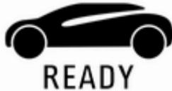
Wenn das Fahrzeug fahrbereit ist, leuchtet unten rechts im Instrument die Leuchte „Fahrzeug bereit“.
