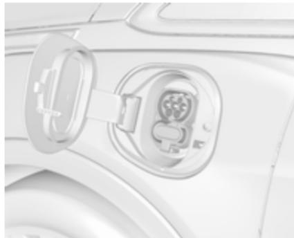
5. Den Fahrzeugstecker des Ladekabels in den Ladeanschluss am Fahrzeug stecken. Sicherstellen, dass die Ladestatusanzeige oben auf der Instrumententafel aufleuchtet und ein hörbares Piepen ertönt. Ladestatus ↪ 218.
