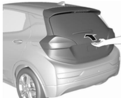
Zum Öffnen der Heckklappe den Touchpad-Schalter drücken.
