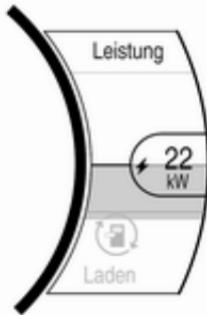
Die Anzeige zu eingeschränkter regenerativer Energie ist grau, wenn die regenerative Energie eingeschränkt ist. Zusätzlich wird eine horizontale Leiste angezeigt. Dies tritt üblicherweise auf, wenn die Hochspannungsbatterie nahezu vollständig geladen oder kalt ist. Regeneratives Bremsen ↷ 170.
