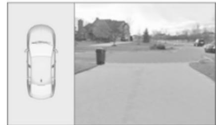
Im Info-Display kann eine Ansicht des Bereichs vor dem Fahrzeug angezeigt werden. Die Frontansicht wird angezeigt, nachdem aus **R** in **D** geschaltet wird und wenn sich das Fahrzeug mit einer Geschwindigkeit unter 8 km/h vorwärts bewegt.
