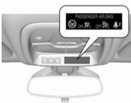
☘<sup>2</sup> für den Beifahrersitz leuchtet oder blinkt rot in der Dachkonsole, wenn der Sitz belegt ist.
