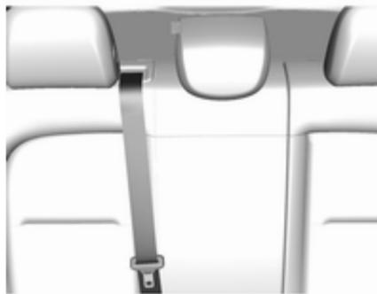
Der Sicherheitsgurt am Mittelsitz kann eingeklemmt werden, wenn die Sitzlehne zu schnell zurückgeklappt wird. Um den Aufroller zu entsperren, Sicherheitsgurt ca. 20 mm hineindrücken oder herausziehen und dann loslassen.
