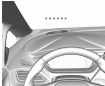
Wenn sich das Fahrzeug einem erkannten Fußgänger zu schnell nähert, wird eine rot blinkende LED-Warnung im Sichtfeld des Fahrers in die Windschutzscheibe projiziert und ein Warnton ertönt. Das Bremssystem kann eine Bremsung des Fahrers antizipieren und dabei eine kurze, leichte Verlangsamung des Fahrzeugs verursachen. Das Bremspedal weiter nach Bedarf betätigen.
