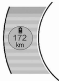
Diese Anzeige gibt Auskunft über den Ladezustand der Hochspannungsbatterie. Der Wert in der Mitte stellt die geschätzte verbleibende Reichweite des Fahrzeugs mit der verbleibenden Ladung an. Er basiert auf dem Fahrverhalten und den Fahrbedingungen, die über mehrere Tage erfasst wurden.
