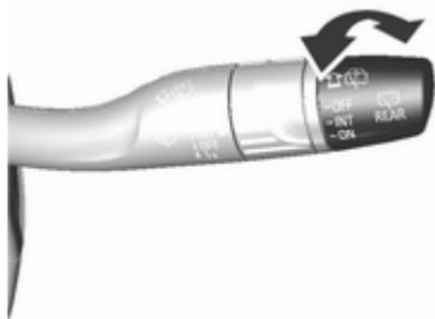
Zum Einschalten des Heckscheibenwischers die äußere Kappe drehen:
