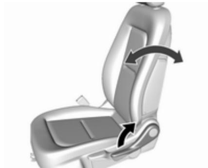
Hebel ziehen, Neigung einstellen und Hebel loslassen. Die Rückenlehne muss hörbar einrasten.
