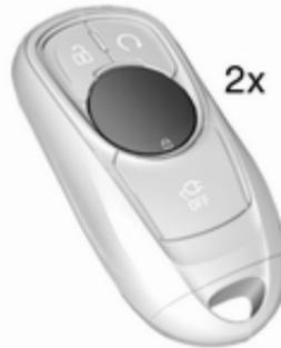
🔒 am elektronischen Schlüssel innerhalb von fünf Sekunden zweimal drücken.
