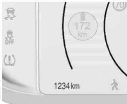
Die erfasste Gesamtfahrstrecke wird in km angezeigt.
