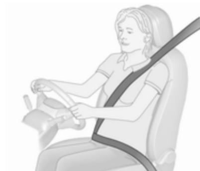
Bei starker Beschleunigung oder Verzögerung des Fahrzeugs blockieren die Sicherheitsgurte, um die Insassen in ihrer Sitzposition zu halten. Dadurch wird die Verletzungsgefahr deutlich verringert.
