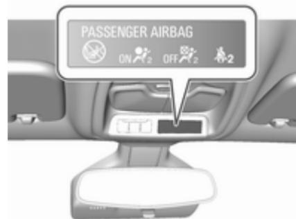
Wenn die Kontrollleuchte ON
