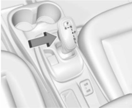
Die Taste zur Freigabe der Schaltsperre soll ein unbeabsichtigtes Schalten aus **P** verhindern. Das Schalten aus dieser Stellung ist nur möglich, wenn das Fahrzeug eingeschaltet ist, das Bremspedal betätigt ist und die Freigabetaste der Schaltsperre gedrückt wird.
