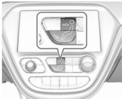
Drücken Sie die entsprechende Taste für die gewünschte Korrektur. Die LED in der Taste leuchtet auf, um die Aktivierung anzuzeigen.
