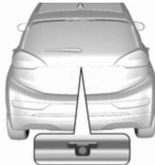
Die Kamera ist zwischen den Kennzeichenleuchten integriert und verfügt über einen Blickwinkel von 130°.
