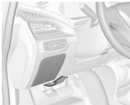
Zum Öffnen des Fachs die Verschlusslaschen zusammendrücken und die Abdeckung herunterklappen und entfernen.
