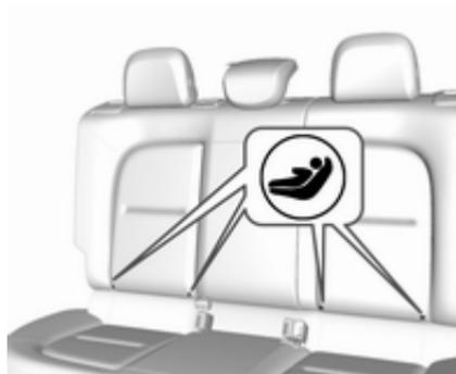
Für das Fahrzeug zugelassene ISOFIX-Kindersicherheitssysteme an den ISOFIX-Befestigungshalterungen befestigen. Die speziellen Positionen für ISOFIX-Kindersicherheitssysteme sind aus der ISOFIX-Tabelle ersichtlich ⇨ 55.
