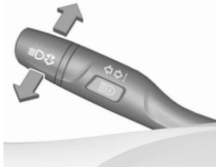
Zum Umschalten von Abblend- auf Fernlicht den Hebel drücken.
