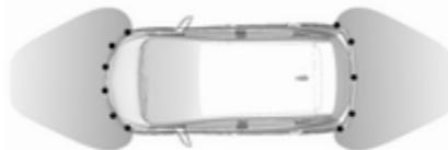
Die erweiterte Einparkhilfe ist immer mit der Front-Heck-Einparkhilfe kombiniert. Beide Systeme nutzen dieselben Sensoren im vorderen und hinteren Stoßfänger.
