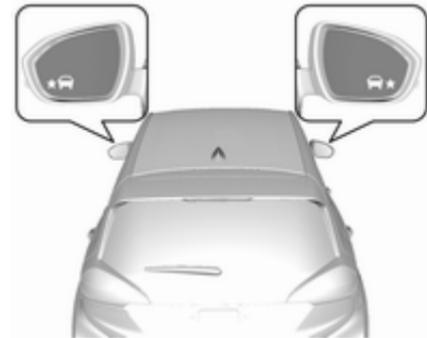
Beim Starten des Fahrzeugs leuchten die Anzeigen in beiden Außenspiegeln kurz auf, um den Betrieb des Systems anzuzeigen.
