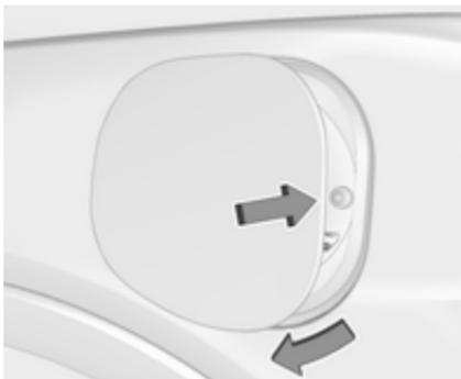
2. Drücken Sie die hintere Kante der Ladeanschlussklappe nach innen, und lassen Sie sie los, um die Klappe zu öffnen.
