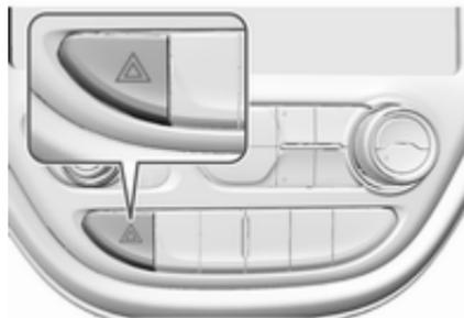
Bei einem Unfall mit Airbagauslösung wird der Warnblinker automatisch eingeschaltet.
