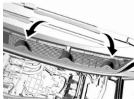
Der Lufteinlass im Motorraum außen vor der Windschutzscheibe muss zur Luftzufuhr frei sein. Gegebenenfalls Laub, Schmutz oder Schnee entfernen.
