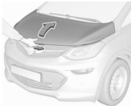
2. Den Sicherungshaken zur linken Fahrzeugseite drücken und die Motorhaube öffnen.
