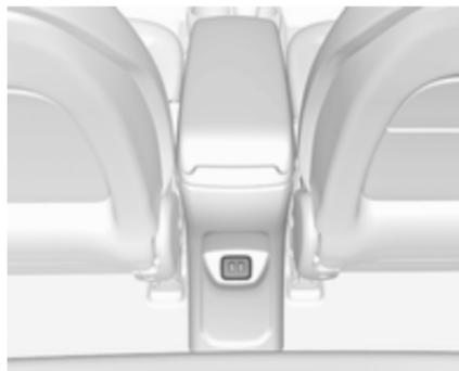
Zwei weitere USB-Anschlüsse, die ausschließlich zum Laden von Geräten vorgesehen sind, befinden sich an der Rückseite der Mittelkonsole.
