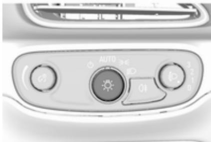
Bei aktivierter Funktion „Automatisches Fahrlicht“ und eingeschaltetem Fahrzeug schaltet das System abhängig von den äußeren Lichtverhältnissen zwischen Tagfahrlicht und Scheinwerfern automatisch um.
