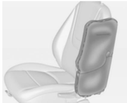
Der aufgeblähte Airbag dämpft den Aufprall, wodurch die Verletzungsgefahr für Oberkörper und Becken bei einem Seitenaufprall deutlich verringert wird.
