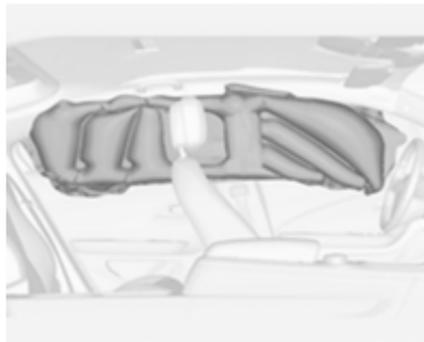
Der aufgeblähte Airbag dämpft den Aufprall, wodurch die Verletzungsgefahr für den Kopf bei einem Seitenaufprall deutlich verringert wird.
