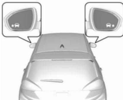
Beim Starten des Fahrzeugs leuchten die Anzeigen in beiden Außenspiegeln kurz auf, um den Betrieb des Systems anzuzeigen.
