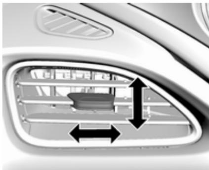
Richtung des Luftstroms durch Kippen und Schwenken der Lamellen einstellen.
