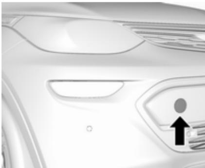
Die Spitze eines Schlitzschraubendrehers mit einem Tuch umwickeln, um den Lack zu schützen. Den Schraubendreher in den Schlitz an der kürzeren Kante der Abdeckung einführen. Abdeckung durch vorsichtiges Seitwärtsbewegen des Schraubendrehers lösen.
