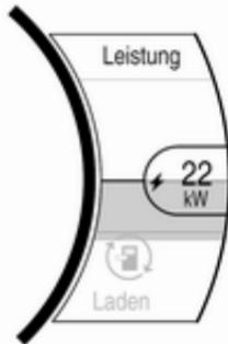
Die Anzeige zu eingeschränkter regenerativer Energie ist grau, wenn die regenerative Energie eingeschränkt ist. Zusätzlich wird eine horizontale Leiste angezeigt. Dies tritt üblicherweise auf, wenn die Hochspannungsbatterie nahezu vollständig geladen oder kalt ist.
