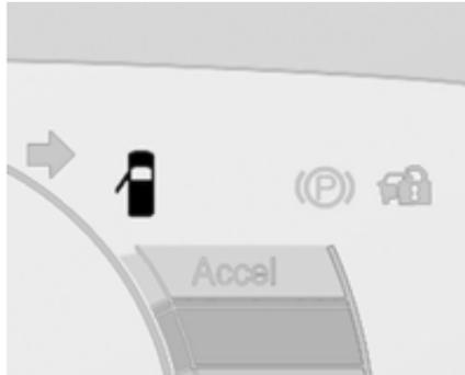
Die Anzeige leuchtet, wenn eine Tür, die Motorhaube oder die Heckklappe geöffnet ist. Das Symbol ändert sich entsprechend.
