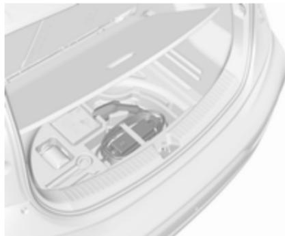
3. Die Heckklappe öffnen. Die Bodenabdeckung anheben und das Ladekabel entnehmen.
