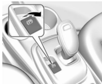
Die elektrische Parkbremse kann immer betätigt werden, auch bei ausgeschaltetem Fahrzeug.
