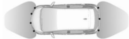
Das System umfasst vier Ultraschall-Parksensoren im Frontstoßfänger und drei Ultraschall-Parksensoren im Heckstoßfänger.
