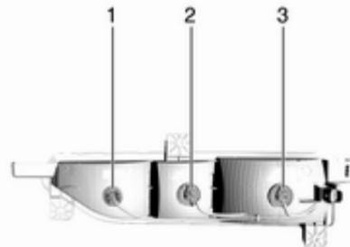
Der Zusammenbau Rückleuchten befindet sich im Heckstoßfänger. Die Lampen sind von der Fahrzeugunterseite her zugänglich.
