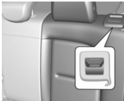
Den Entriegelungsgriff an einer oder beiden Außenseiten ziehen und die Rückenlehnen auf die Sitzfläche umklappen.
