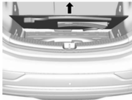
Die hintere Bodenabdeckung anheben, um Zugriff auf das Ladekabel, das Wagenwerkzeug und das Warndreieck zu erhalten.
