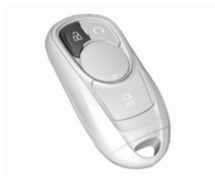
☑ drücken, um Türen und Laderaum zu entriegeln. Türen durch Ziehen an den Griffen öffnen.
