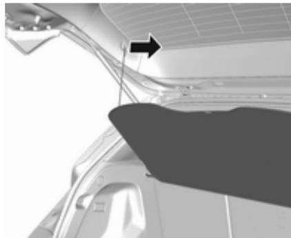
Befestigungsschnüre von der Heckklappe aushaken.
