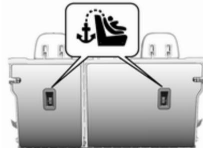
Zusätzlich zu den ISOFIX-Befestigungshalterungen den Top-Tether Befestigungsgurt an den Top-Tether Befestigungen verankern.
