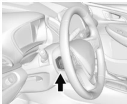
Die manuell aktivierte Regenerierung ermöglicht eine stärkere Verzögerung durch Drücken und Halten der Lenkradwippen. Diese Funktion arbeitet in den Stellungen **D** (Fahrmodus) und **L** (niedrige Fahrstufe). Die Funktion arbeitet nur bei gelöstem Gaspedal.
