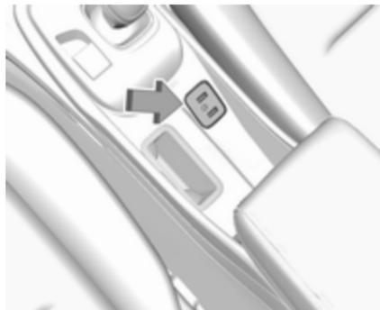
In der Mittelkonsole befinden sich zwei USB-Anschlüsse. Diese Anschlüsse können als Verbindung zum Infotainment System oder zum Laden von Geräten verwendet werden.
