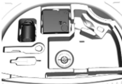
Das Reifenreparaturset befindet sich im Werkzeugkasten unter der Bodenabdeckung im Laderaum.
