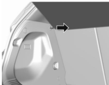
Die Befestigungsschnüre aus den Seitenwänden des Laderaums aushaken.
