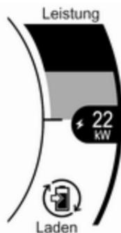
Die Leistungsanzeige zeigt die momentane Ladeleistung und Entladeleistung an, die in die bzw. aus der Hochspannungsbatterie fließt. Die maximale Entladeleistung ist verfügbar, wenn die Hochspannungsbatterie vollständig geladen ist. Im normalen Betrieb kann die Entladeleistung mit sinkendem Ladezustand der Hochspannungsbatterie ebenfalls leicht sinken.
