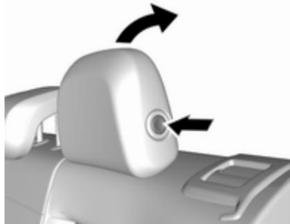
Die Kopfstütze nur dann für eine bessere Sicht einklappen, wenn der Rücksitz nicht belegt ist. Den Knopf drücken und die Kopfstütze nach hinten drücken.
