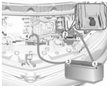
Reihenfolge für das Anschließen der Kabel:
