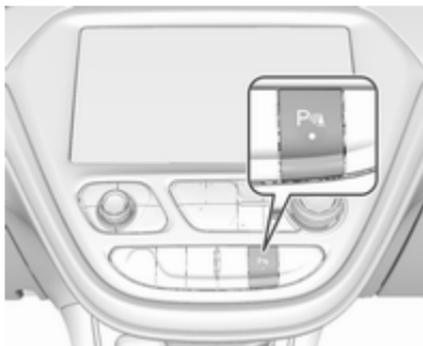
Eine leuchtende LED in der Einparkhilfe-Taste **P**▲ zeigt an, dass das System betriebsbereit ist.
