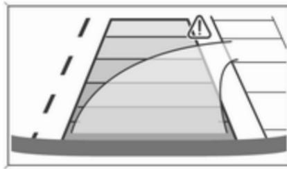
Die Fahrzeugspur wird entsprechend des Lenkwinkels angezeigt.
