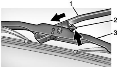
5. Den Haken durch Drücken des Entriegelungshebels (2) lösen und das Wischerblatt (3) aus dem Wischerarm (1) ziehen.
