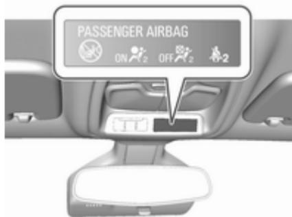
Wenn die Kontrollleuchte ON
