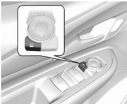
Zur Deaktivierung der elektrischen Fensterbetätigung der Hintertüren ☒ drücken. Die LED leuchtet auf.
