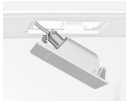
3. Die Fassung im Uhrzeigersinn drehen und das Leuchtengehäuse von der Fassung abnehmen.
