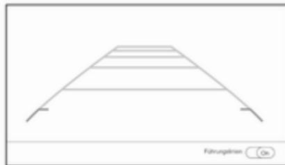
Die Aktivierung bzw. Deaktivierung der optischen Führungslinien und Warnsymbole kann über das Menü **Einstellungen** im Info-Display geändert werden. Wählen Sie die relevante Einstellung unter **Einstellungen**, ➔ **Rückfahrkamera** aus.
