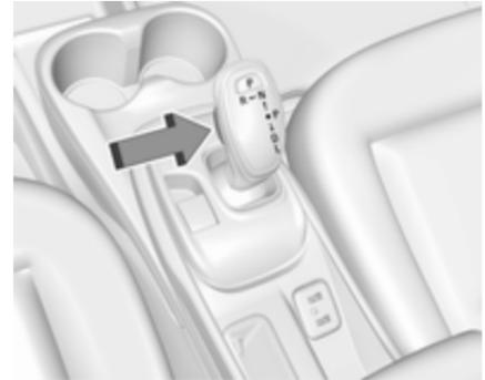
Die Freigabetaste soll ein unbeabsichtigtes Schalten aus **P** verhindern. Das Schalten aus dieser Stellung ist nur möglich, wenn der Motor läuft, das Bremspedal betätigt und die Freigabetaste gedrückt wird.
