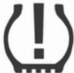
Wenn niedriger Reifendruck erkannt wird, wird dies durch die Kontrollleuchte (U) gemeldet ⇨ 83.
