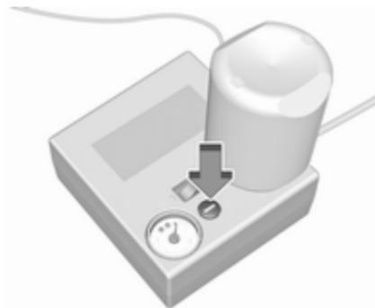
Wird der vorgeschriebene Reifendruck nicht innerhalb von 10 Minuten erreicht, Reifenreparaturset entfernen. Das Fahrzeug um eine Reifenumdrehung bewegen. Das Reifenreparaturset wieder anschließen und Füllvor-
