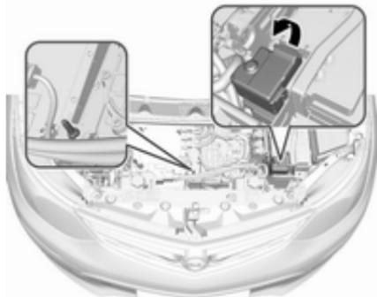
Die Batterieklemmen, über die dem eigenen Fahrzeug Starthilfe gegeben wird, befinden sich im Motorraum.
