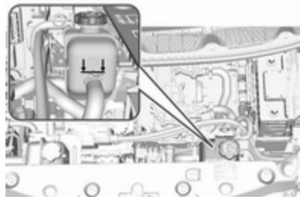
Überprüfen, ob Kühlmittel im Kühlmittelbehälter der Motorelektronik- und Lademodule sichtbar ist. Wenn Kühlmittel sichtbar ist, der Kühlmittelstand jedoch unter der Kaltfüllmarkierung liegt, könnte das Kühlsystem undicht sein.
