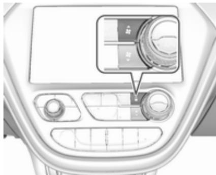
Mit der unteren Taste wird die Gebläsedrehzahl verringert und mit der oberen Taste erhöht. Die Gebläseschwindigkeit wird im unteren Displaybereich angezeigt.
