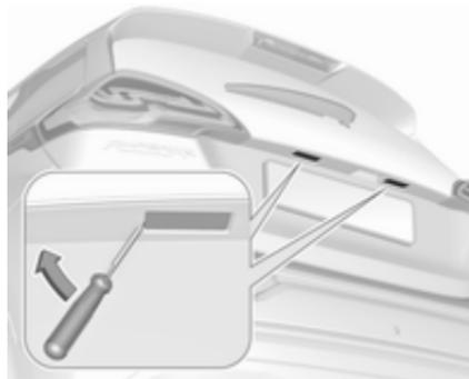
1. Einen Schraubendreher in den Schlitz links an der Leuchte stecken und anhebeln.
