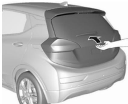
Nach dem Entriegeln den Touchpad-Schalter betätigen und die Heckklappe öffnen.
