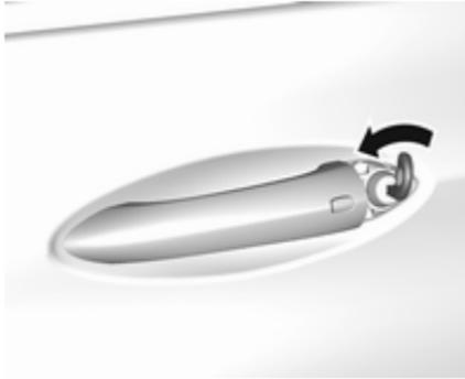
Die Fahrertür durch Einsetzen und Drehen des Schlüssels im Schließzylinder von Hand entriegeln.
