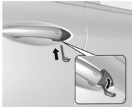
Zum Entfernen der Kappe den Knopf an der Rückwand drücken und das Schlüsselblatt aus dem Gehäuse ziehen. Den Schlüssel in die Aussparung am unteren Rand der Kappe stecken und den Schlüssel nach oben drücken.
