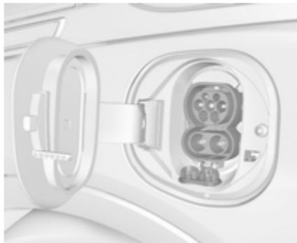
3. Die DC-Staubschutzkappe öffnen. Den DC-Fahrzeugstecker DC-Ladeanschluss des Fahrzeugs einstecken. Sicherstellen, dass der DC-Fahrzeugstecker vollständig im DC-Ladeanschluss
