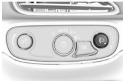
Zur Anpassung der Leuchtweite an die Fahrzeugbelastung, um Blendwirkung zu reduzieren: Daumenrad  $\frac{1}{2}$  in die gewünschte Stellung drehen.
