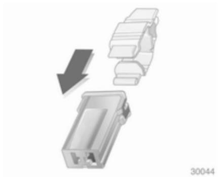
Sicherungszieher von oben oder seitlich auf die verschiedenen Ausführungen von Sicherungen stecken und Sicherung herausziehen.
