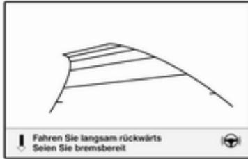
Die vom System vorgeschlagene Parklücke gilt als akzeptiert, wenn der Fahrer das Fahrzeug innerhalb von 10 m (Längsparklücken) bzw. 6 m (Querparklücken) nach dem Aufleuchten der Meldung **Stop** anhält. Das System berechnet den optimalen Fahrweg in die Parklücke.
