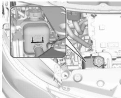
Überprüfen, ob im Kühlmittelbehälter für die Hochspannungsbatterie Kühlmittel sichtbar ist. Wenn Kühlmittel sichtbar ist, der Kühlmittelstand jedoch unter der Kaltfüllmarkierung liegt, könnte das Kühlsystem undicht sein.
