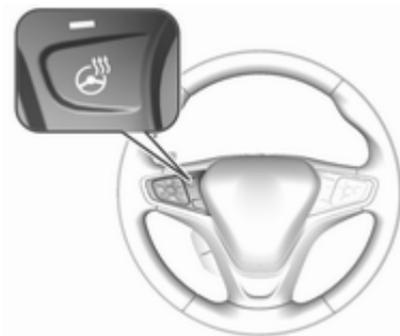
Die Heizung durch Drücken von
