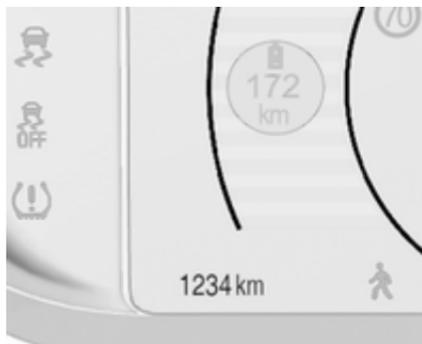
Die erfasste Gesamtfahrstrecke wird in km angezeigt.
