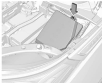
Der Sicherungskasten befindet sich vorn links im Motorraum.
