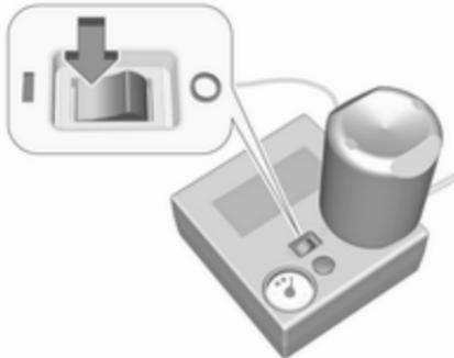
Wippschalter am Kompressor auf I stellen, der Reifen wird mit dem Dichtmittel gefüllt.
