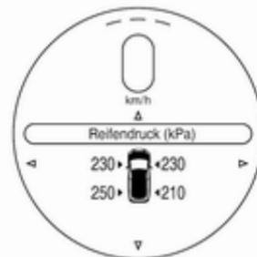
Die Seite „Reifendruck“ kann mit den rechten Lenkradtasten über das Fahrzeug-Info-Menü und mit ▲ oder ▼ aufgerufen werden.
