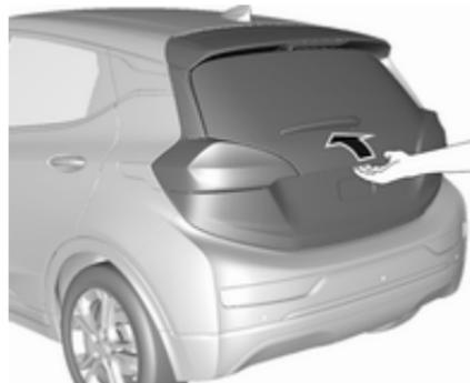
Zum Öffnen der Heckklappe den Touchpad-Schalter drücken.
