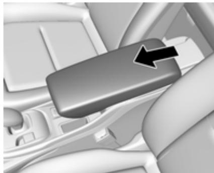
Die Armlehne kann um 9 cm nach vorn verschoben werden. Unter der Armlehne befindet sich ein Staufach. Armlehnenfach ↗ 60.
