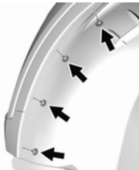
1. Das Rad einlenken und die Schrauben an der Außenseite des Radkastens herausdrehen. Den Schraubendreher aus dem Wagenwerkzeug benutzen.
