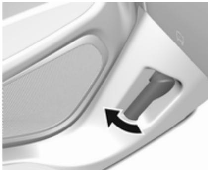
1. Entriegelungshebel der Motorhaube ziehen und in die Ausgangsposition zurückführen.
