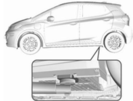
Position des hinteren Arms der Hebebühne am Unterboden.
