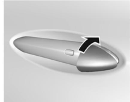
Nach dem Verriegeln den Schließzylinder mit der Kappe bedecken: Die Kappe mit der unteren Seite in die Aussparungen einsetzen und so lange neigen und drücken, bis sie an der Oberseite eingerastet ist.
