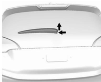
1. Rechts an der Abdeckung ziehen, bis sich diese löst.
