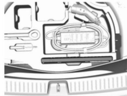
Das Warndreieck im Werkzeugkasten unter der hinteren Bodenabdeckung im Laderaum verstauen.
