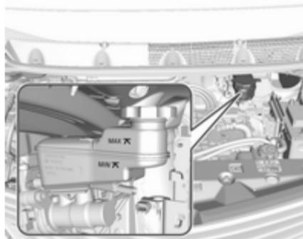
Wenn das Fahrzeug seit mind. 1 Minute abgestellt ist, ist der maximale Füllstand die obere Behälterkante. Bei eingeschaltetem Fahrzeug muss sich der Bremsflüssigkeitsstand zwischen den Markierungen **MIN** und **MAX** befinden.
