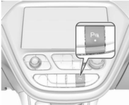
Zum Deaktivieren die Taste Einparkhilfe **P**▲ drücken; die LED in der Taste erlischt.
