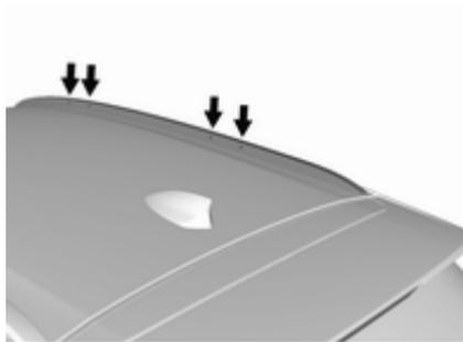
Zur Befestigung des Dachgepäckträgers Montagebolzen in die abgebildeten Bohrungen stecken.
