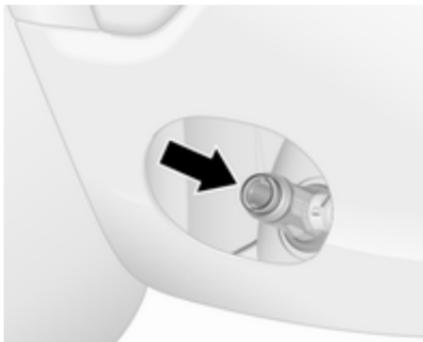
4. Die Zapfpistole bis zum Anschlag in den Einfüllstutzen einführen und betätigen.
