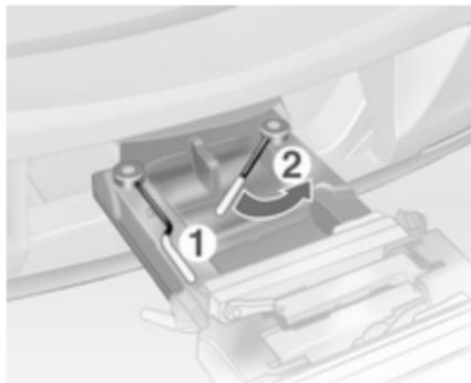
Zuerst den linken Spannhebel (1), danach den rechten Spannhebel (2) bis zum Anschlag nach hinten schwenken. Beide Spannhebel müssen nach hinten zeigen, weil sonst keine sichere Funktion gewährleistet ist.
