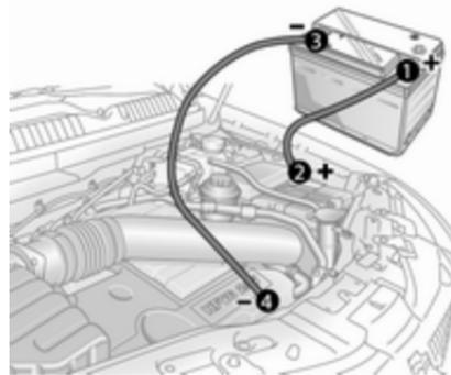
Reihenfolge für das Anschließen der Kabel:
