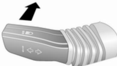
Zum Umschalten von Abblendlicht auf Fernlicht Hebel nach vorne drücken.
