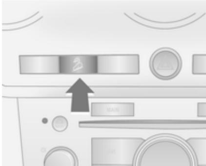
Bei Geschwindigkeiten unter ca. 50 km/h
