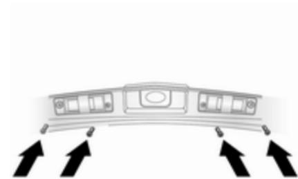
1. Lösen Sie die 4 Schrauben (Pfeil) und entfernen Sie die Leuchtenabdeckungen.
