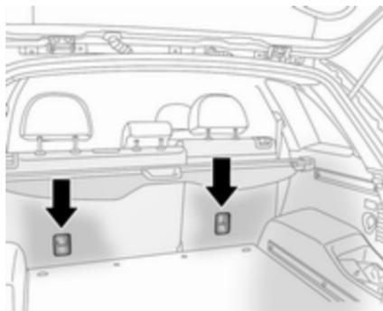
Die Top-Tether-Verankerungen befinden sich auf der Rückseite der Rückenlehnen und sind nur zur Fixierung von Kindersicherheitsystemen bestimmt, die mit Befestigungen für Top-Tether-Verankerungen ausgestattet sind. Folgen Sie den dem Top-Tether-Kindersicherheitsystem beiliegenden Anweisungen.
