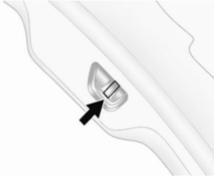
Bei einem Ausfall der Elektrik kann die Hecktür wie folgt geöffnet werden: Die Innenverkleidung von der mittleren Verriegelung abnehmen und dann den Hebel mit einem geeigneten Werkzeug nach unten drücken.
