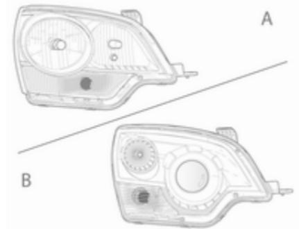
Halogen-Scheinwerfer **A** unterscheiden sich von Xenon-Scheinwerfern **B** durch die Form der Streuscheibe.
