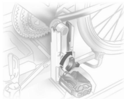
Die Tretkurbel durch Drehen der Klemmschraube an der Tretkurbelfixierung festklemmen.
