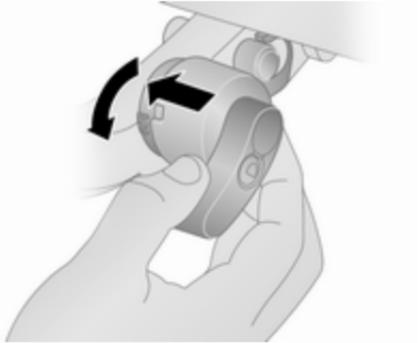
Entriegeln Sie die Kugelstange und ziehen Sie den Schlüssel ab. Ziehen Sie den Hebel nach links, in Richtung Kugelstange, und drehen Sie ihn nach unten. Ziehen Sie die Kugelstange aus dem Kupplungsgehäuse heraus.
