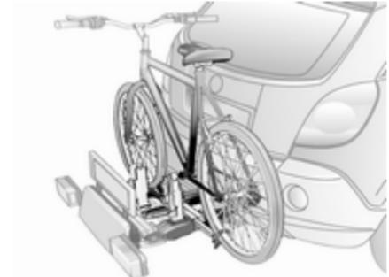
Das Heckträgersystem (Flex-Fix-System) bietet die Möglichkeit, Fahrräder auf einem in den Fahrzeugboden integrierten herausziehbaren Träger zu befestigen. Der Transport anderer Gegenstände ist nicht zulässig.
