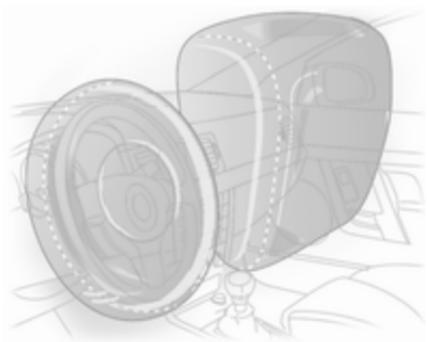
Die entfalteten Airbags dämpfen den Aufprall und verringern damit für die Insassen auf den Vordersitzen erheblich die Gefahr von Verletzungen im Oberkörper- und Kopfbereich.
