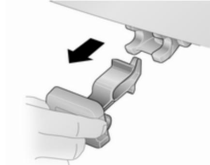
Entfernen Sie den Verschlussstopfen aus der Aufnahmeöffnung für die Kugelstange und bewahren Sie diese im Laderaum auf.
