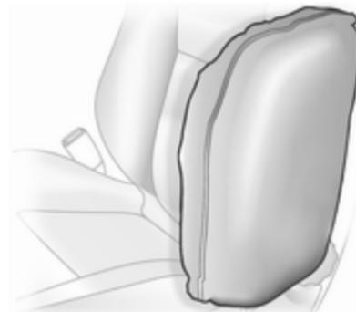
Der aufgeblähte Airbag dämpft den Aufprall, wodurch die Verletzungsgefahr für den Oberkörper und das Becken bei einem Seitenaufprall deutlich verringert wird.
