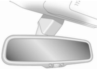
Zur Aktivierung der Funktion die Taste auf dem Spiegelgehäuse drücken. Die Taste leuchtet auf und die Blendung durch nachfolgende Fahrzeuge bei Nacht wird automatisch reduziert. Zum Ausschalten der Funktion erneut auf die Taste drücken.
