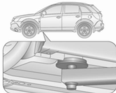
Position des vorderen Arms der Hebebühne mittig unter der Aussparung im Schweller.
