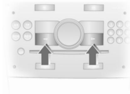
Im Menü **Settings** wird die gewünschte Funktion durch Drücken auf **OK** aufgerufen. Mit den Pfeiltasten werden die Einstellungen geändert.
