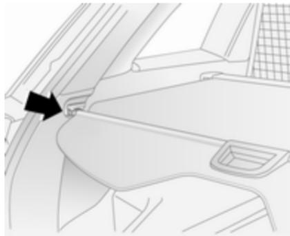
Laderaumabdeckung am Griff nach hinten ziehen und Halter in die Halterungen auf beiden Seiten des Laderaums einsetzen.
