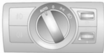
Wenn das automatische Fahrlicht eingeschaltet ist und der Motor läuft, wird das Abblendlicht abhängig von den äußeren Lichtverhältnissen automatisch eingeschaltet.
