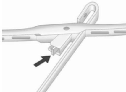
Heben Sie den Wischerarm an, drücken Sie den Halteclip und ziehen Sie das Wischerblatt ab.
