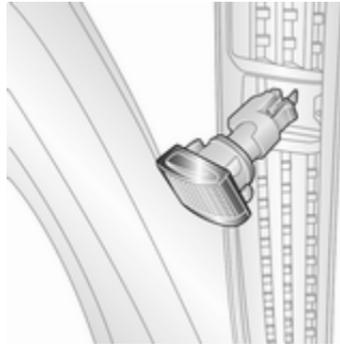
1. Hebeln Sie die Leuchte mit einem Schraubendreher aus dem Kotflügel.
