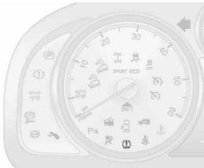
Wenn niedriger Reifendruck erkannt wird, wird dies durch die Kontrollleuchte (⚠) gemeldet ⇨ 94.
