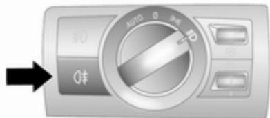
Wird durch Drücken von ☼ bedient. Kontrollleuchte ☼ ⇨ 96 am Instrument leuchtet beim Einschalten der Nebelschlussleuchte auf.
