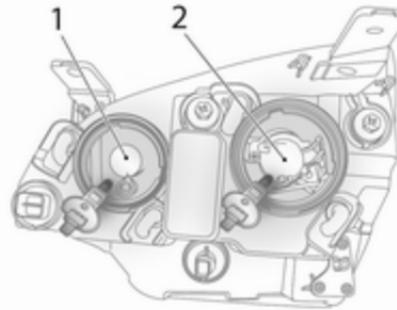
Halogen-Scheinwerfer haben getrennte Systeme für Fernlicht **1** (innere Lampen) und Abblendlicht **2** (äußere Lampen).
