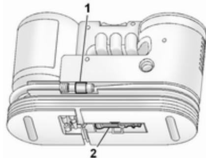
1. Den Dichtmittel-Einfüllschlauch 1 und den Stecker 2 lösen.
