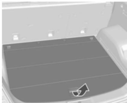
Um das Reifenreparaturset zu entnehmen, die Hecktür öffnen und den Griff der Bodenabdeckung nach oben ziehen ⇨ 72.
