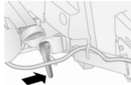
Auf den Klemmhebel drücken und den Leuchtenhalter bis zum Anschlag in die Aufnahme schieben.
