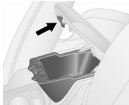
Öffnen: Ziehen Sie den Hebel hoch und öffnen Sie den Deckel.
