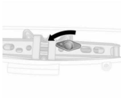
Die Flügelschraube des Wagenhebers gegen den Uhrzeigersinn abschrauben und den Wagenheber und das Täschchen mit dem Radschraubenschlüssel herausnehmen. Die Gurte, mit denen das Täschchen des Radschraubenschlüssels fixiert ist, entfernen. Den Radschraubenschlüssel aus dem Täschchen nehmen.
