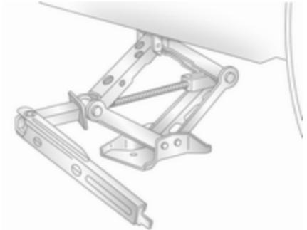
5. Radschraubenschlüssel am Loch der Gewindestange anbringen und zum Anheben des Fahrzeugs im Uhrzeigersinn drehen.
