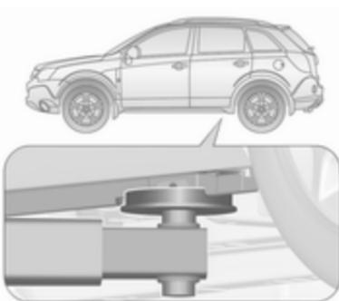
Position des hinteren Arms der Hebebühne mittig unter der Aussparung im Schweller.
