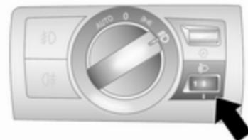
Leuchtweite der Scheinwerfer bei eingeschaltetem Abblendlicht der Fahrzeugbeladung anpassen. Eine richtige Scheinwerfereinstellung vermindert die Blendung anderer Verkehrsteilnehmer.
