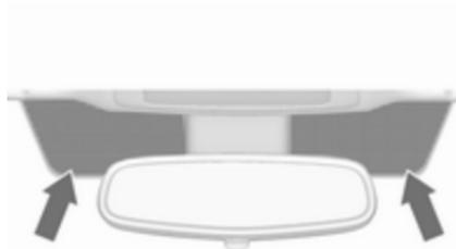
Die markierten Bereiche der Windschutzscheibe hinter dem Innenspiegel sind von der Beschichtung ausgespart. Geräte für die elektronische
