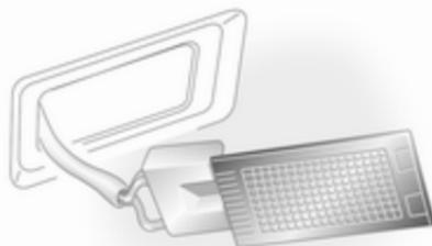
1. Lösen Sie die Streuscheibe mit einem Schraubendreher von der Leuchteneinheit.
