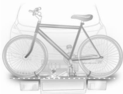
Die Radaufnahmen so einstellen, dass das Fahrrad ungefähr waagrecht steht. Der Abstand zwischen den Pedalen und der Hecktür sollte dabei mindestens 5 cm betragen.
