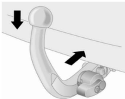
Führen Sie die Kugelstange in das Kupplungsgehäuse ein und drücken Sie kräftig nach unten, bis die Kugelstange hörbar einrastet. Wenn sie nicht einrastet, wiederholen Sie den Vorgang.
