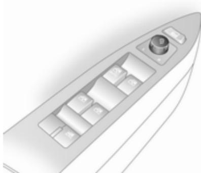
Gewünschten Außenspiegel durch Drehen des Schalters nach links (**L**) bzw. rechts (**R**) wählen. Danach das Bedienelement schwenken, um den Spiegel einzustellen.
