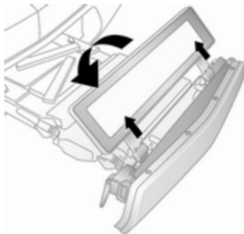
Ziehen Sie den Kennzeichenhalter nach oben und klappen Sie ihn in waagerechte Position.
