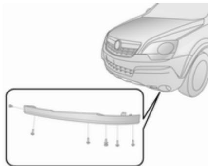
Die Spoilerlippe von der linken Fahrzeugseite abnehmen. Dazu die sechs Schrauben an der Fahrzeugunterseite lösen. Dann die Abschleppöse befestigen.
