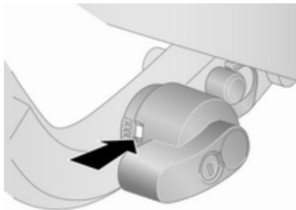
Prüfen Sie, dass die Farbmarkierung am Hebel rot ist.
