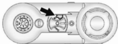
5. Den Wahlschalter gegen den Uhrzeigersinn auf die Position **sealant + air** (Dichtmittel + Luft) drehen.
