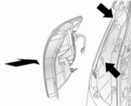
6. Setzen Sie die Leuchteneinheit wieder ein, indem Sie die Führungslappen in die dazugehörigen Öffnungen schieben.
