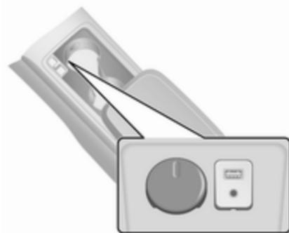
12-Volt-Zubehörsteckdosen befinden sich unter dem Getränkehalter in der vorderen Mittelkonsole, in der hinteren Mittelkonsole und rechts im Laderaum.
