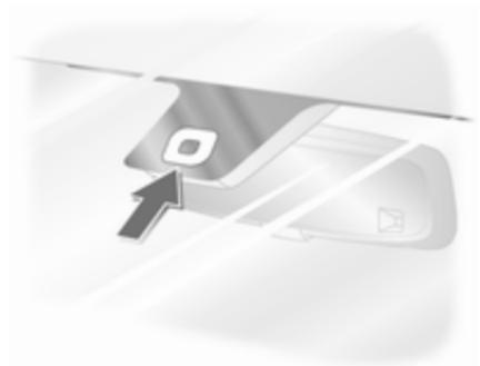
Halten Sie den Bereich des Regensensors durch Betätigung der Scheibenwaschanlage sauber.
