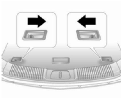
Um Zugang zum Staufach unter der Bodenabdeckung zu erhalten, die beiden Bodenhebel zum Griff hin drücken und die Abdeckung mit dem Griff anheben (modellabhängig).
