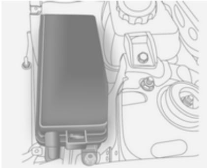
Der Sicherungskasten befindet sich neben dem Kühlmittelbehälter im Motorraum.
