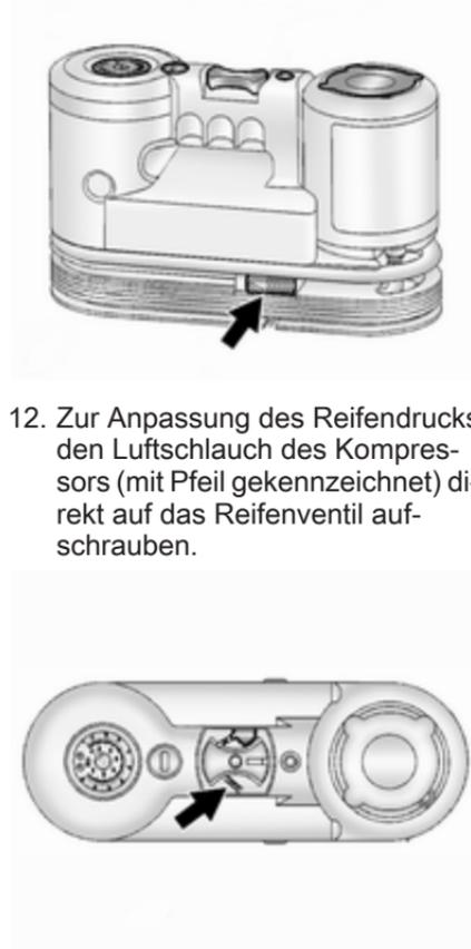
12. Zur Anpassung des Reifendrucks den Luftschlauch des Kompressors (mit Pfeil gekennzeichnet) direkt auf das Reifenventil aufschrauben.
