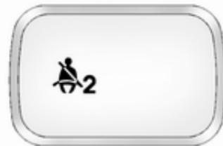
Bei laufendem Motor blinkt die Kontrollleuchte
