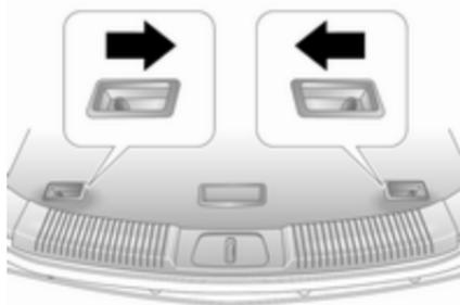
Beide Hebel in der Bodenabdeckung zum Griff hin drücken und die Abdeckung mit dem Griff anheben.
