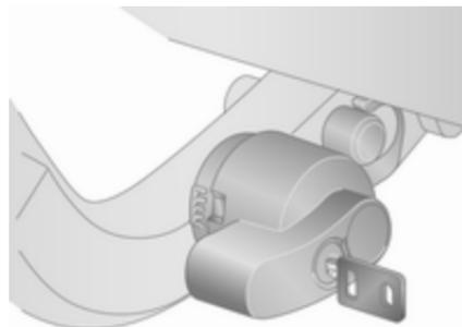
Verriegeln Sie die Kugelstange durch Drehen des mitgelieferten Schlüssels im Schließzylinder der Kugelstange. Ziehen Sie den Schlüssel ab.
