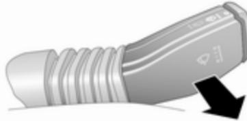
Hebel ziehen. Waschflüssigkeit wird auf die Windschutzscheibe gesprüht.
