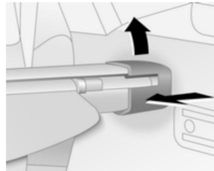
Laderaumabdeckung öffnen. Ziehen Sie die Muffe auf einer Seite der Abdeckung zur Fahrzeugmitte, heben Sie die Abdeckung an und lösen Sie diese von den seitlichen Führungen. Einbau in umgekehrter Reihenfolge.
