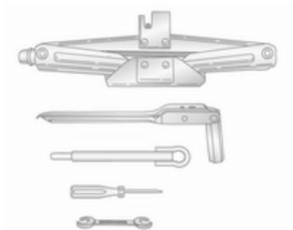
Fahrzeuge mit Reserverad verfügen über Wagenheber und Werkzeugsatz.
