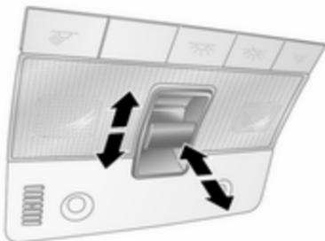
Für einen stufenweisen Betrieb den Schalter kurz in die gewünschte Richtung drücken. Zum automatischen Öffnen oder Schließen den Schalter lange gedrückt halten.
