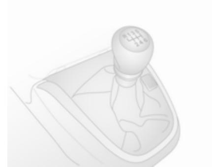
Zum Einlegen des Rückwärtsgangs bei stehendem Fahrzeug nach dem Treten des Kupplungspedals 3 Sekunden warten und dann den Gang einlegen.
