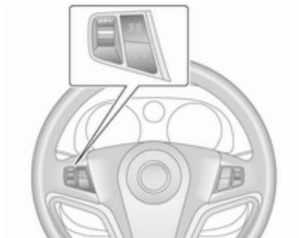
Durch Drehen des Stellrads wird die gewünschte Funktion aufgerufen.
