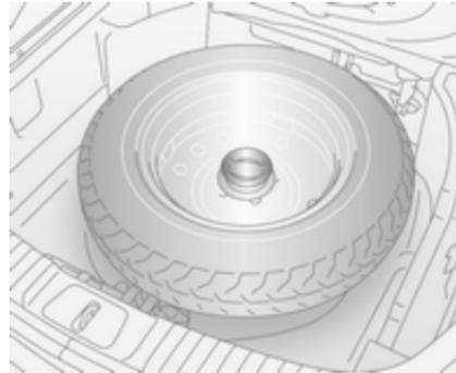
Das Notrad befindet sich im Laderaum unter der Bodenabdeckung und ist durch eine Schraubhalterung befestigt.
