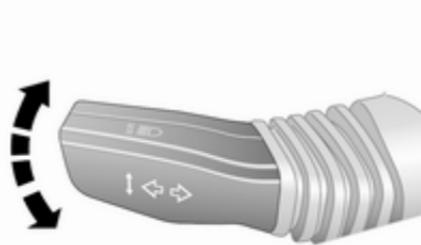
Hebel nach oben : Blinker rechts
