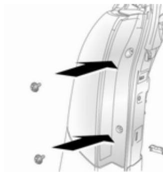
1. Öffnen Sie die Hecktür und entfernen Sie 2 Schrauben und die Leuchteneinheit.
