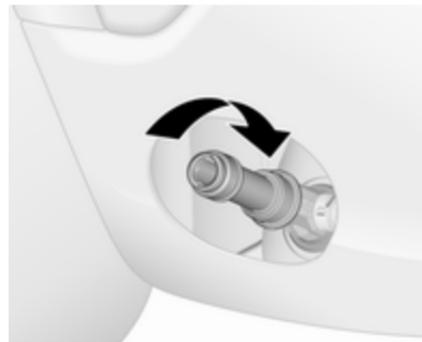
4. Den Adapter (im Handschuhfach) am Einfüllstutzen anbringen.
