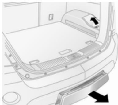
Entriegelungshebel anheben. Das System rastet aus und fährt schnell aus dem Stoßfänger.
