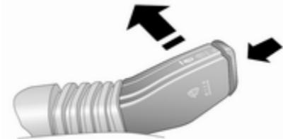
Hebelbewegungen zur Aktivierung des Heckscheibenwischers:
