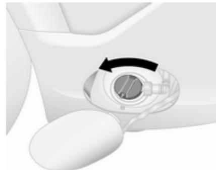
3. Die Schutzkappe linksherum drehen, um sie vom Einfüllstutzen abzuschrauben.
