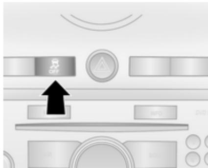
Wenn die Räder bei aktiver ESC-Funktion auf nasser, verschneiter oder vereister Fahrbahn rutschen, erhöht sich die Motordrehzahl beim Tre-
