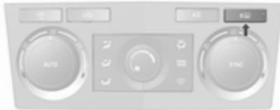
Die Heizung wird durch Drücken auf
