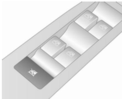
☒ drücken, um die elektrische Fensterbetätigung hinten zu deaktivieren. Zur Reaktivierung erneut auf ☒ drücken.
