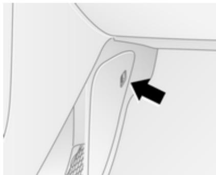
Der Sicherungskasten befindet sich auf der linken Seite des Beifahrerfußraums bzw. in Rechtslenkern auf der linken Seite des Fahrerfußraums.
