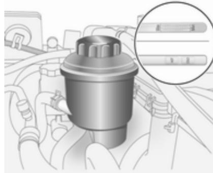
Den Deckel öffnen und entfernen. Den Messstab trocken wischen und die Kappe im Behälter drehen. Den Deckel wieder öffnen und den Füllstand der Lenkunterstützungsflüssigkeit ablesen.
