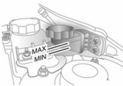
Wenn der Flüssigkeitsstand im Vorratsbehälter unter die Markierung **MIN** sinkt, Hilfe einer Werkstatt in Anspruch nehmen.
