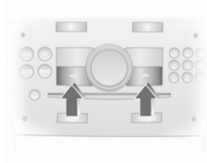
Wählen Sie mit den Pfeiltasten des Infotainment-Systems eine Funktion aus. Das Menü der gewählten Funktion wird angezeigt.
