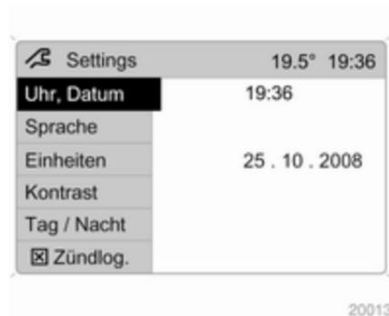
Die Einstellungen werden im Menü **Settings** vorgenommen. Zum Aufrufen der Hauptanzeige auf **Main** (nicht bei allen Infotainment-Systemen vorhanden) auf dem Infotainment System drücken. **Settings** drücken. Beim Infotainment System CD 30 sicherstellen, dass kein Menü ausgewählt wurde. Das Menü **Settings** wird angezeigt.
