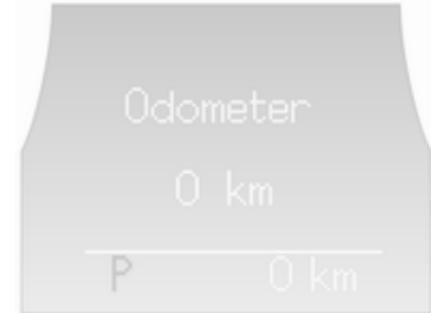
Anzeige der gefahrenen Entfernung in km in der unteren Zeile.
