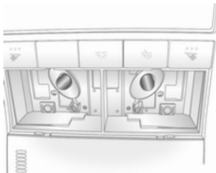
1. Die Streuscheibe der Leuchte mit einem geeigneten Schraubendreher aus der Dachkonsole hebeln.
