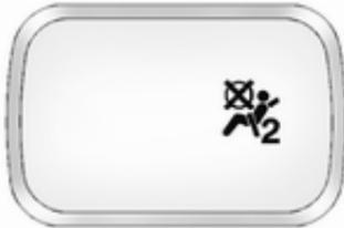
Die Kontrollleuchten für das Beifahrer-Airbag-System befinden sich auf der Beifahrerseite in der Instrumententafel.
