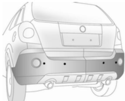
Die Einparkhilfe erleichtert das Parken, indem sie die Entfernung zwischen dem Fahrzeug und Hindernissen davor und dahinter misst und diese durch akustische Signale angibt.
