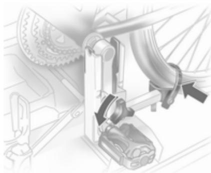
Spannbänder an beiden Fahrradreifen lösen.
