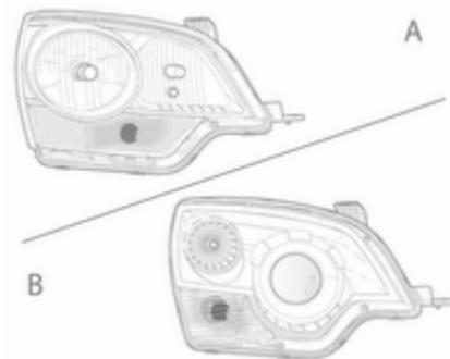
Xenon-Scheinwerfer **B** unterscheiden sich von Halogen-Scheinwerfern **A** durch die Form der Streuscheibe.
