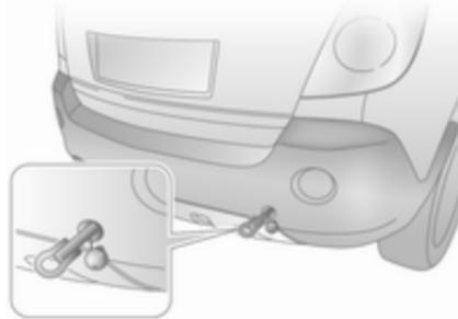
Entfernen Sie die Abdeckung am hinteren Stoßfänger durch Drücken auf den unteren Teil der Abdeckung.
