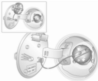
Tankdeckel entriegeln: Drehen Sie ihn gegen den Uhrzeigersinn. Falls ein Zischen zu hören ist, den Deckel erst vollständig abschrauben, nachdem das Zischen aufgehört hat.
