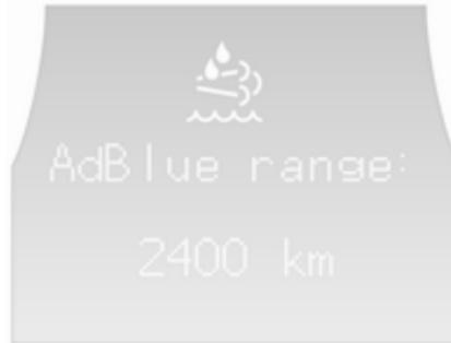
Wenn der AdBlue-Füllstand unter einen bestimmten Wert fällt, wird im Driver Information Center, das sich in der Mitte des Instruments befindet, eine Warnmeldung (z. B. „AdBlue-Reichweite: 2400 km“) angezeigt  $\rightarrow$  97.
