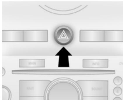
Wird durch Drücken von ▲ bedient.
