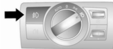
Wird durch Drücken von  $\text{D}$  bedient. Kontrollleuchte  $\text{D}$   $\rightarrow$  96 am Instrument leuchtet beim Einschalten der Nebelleuchten auf.
