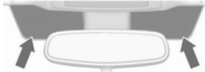
Die markierten Bereiche der Windschutzscheibe hinter dem Innenspiegel sind von der Beschichtung ausgespart. Geräte für die elektroni-
