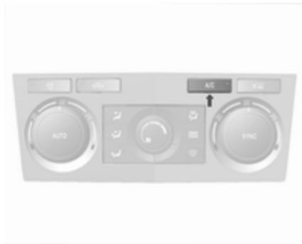
Die Klimatisierungseinstellungen können durch Drücken von **A/C** bzw. durch Verstellen des Gebläsegeschwindigkeits- oder Luftverteilungs-
