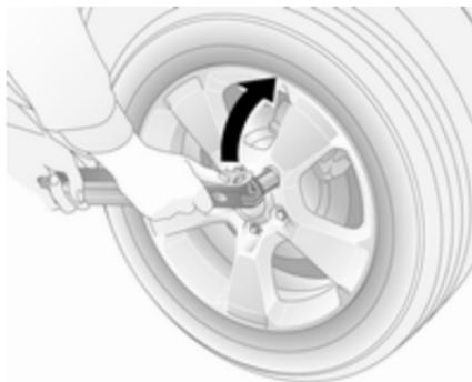
10. Radschraubenschlüssel ansetzen und sicherstellen, dass er gut sitzt. Alle Radmuttern über Kreuz festziehen. Das Anzugsdrehmoment beträgt 140 Nm.
