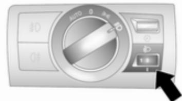
Leuchtweite der Scheinwerfer bei eingeschaltetem Abblendlicht der Fahrzeugbeladung anpassen. Eine richtige Scheinwerfereinstellung vermindert die Blendung anderer Verkehrsteilnehmer.
