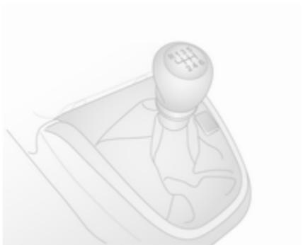
Rückwärtsgang: Bei stehendem Fahrzeug nach dem Treten des Kupplungspedals 3 Sekunden warten und dann den Gang einlegen.
