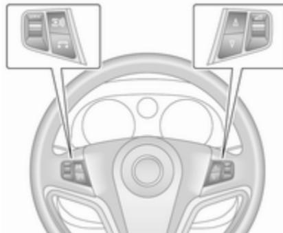
Mit den Bedienelementen am Lenkrad können Sie das Infotainment-System steuern und ein angeschlossenes Mobiltelefon betreiben.
