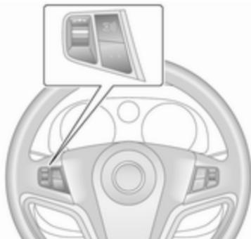
Durch Drehen des Stellrads wird die gewünschte Funktion aufgerufen.
