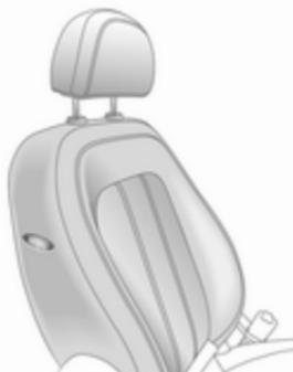
Das Seiten-Airbag-System besteht aus einem Airbag in der Rückenlehne jedes Vordersitzes. Diese Stellen sind mit dem Wort **AIRBAG** gekennzeichnet.
