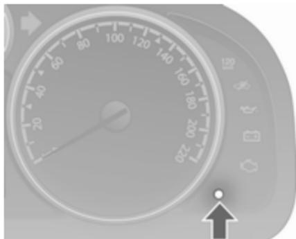
Zum Zurücksetzen bei eingeschalteter Zündung die Taste des Tageskilometerzählers drücken und einige Sekunden gedrückt halten.
