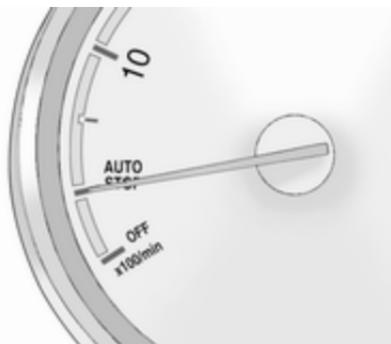
Ein Autostopp wird auf dem Drehzahlmesser angezeigt, indem die Nadel auf der Position **AUTOSTOP** steht.
