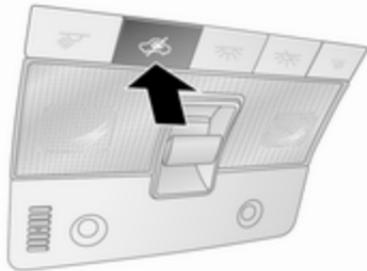
Die Überwachung des Fahrzeuginnenraums und der Fahrzeugneigung ausschalten, wenn Personen oder Tiere im Fahrzeug bleiben, da durch Bewegung verursachte Ultraschallsignale die Alarmanlage auslösen. Auch auf Fähren oder Zügen ausschalten.
