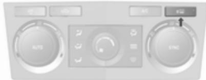
Betätigung durch Drücken von **RHEH**. Eine LED leuchtet in der Taste auf.
