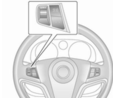
Durch Drehen des Stellrads wird die gewünschte Funktion aufgerufen.
