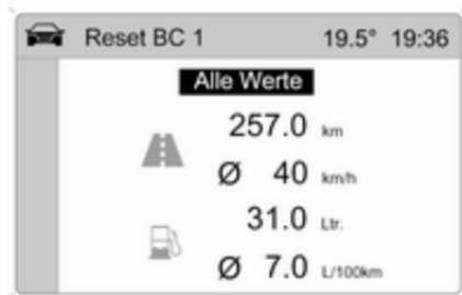
Um alle Informationen eines Bordcomputers zurückzusetzen, Menüpunkt **Alle Werte** auswählen. Nach dem Zurücksetzen wird für die ausgewählten Bordcomputerinformationen "- - -" angezeigt. Die neu berechneten Werte werden nach kurzer Verzögerung angezeigt.
