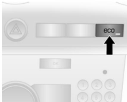
Die Stopp-Start-Automatik lässt sich durch Drücken von **eco** manuell deaktivieren. Die Deaktivierung wird durch das Erlöschen der LED in der Taste angezeigt.
