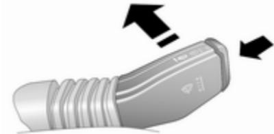
Hebelbewegungen zur Aktivierung des Heckscheibenwischers:
