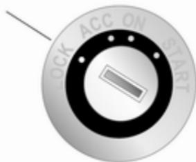
Das System ist Teil des Zündschalters und überprüft, ob das Fahrzeug mit dem verwendeten Schlüssel gestartet werden darf.
