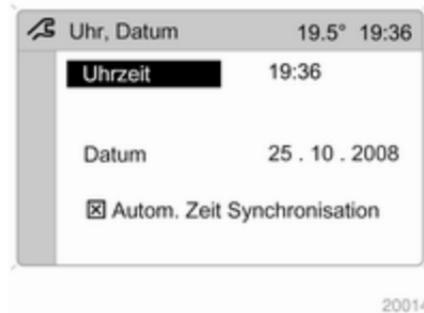
Bei vorhandenem Navigationssystem werden Datum und Uhrzeit nach Empfang eines GPS-Satellitensignals automatisch eingestellt. Wenn die angezeigte Zeit nicht der Ortszeit entspricht, kann sie manuell bzw. automatisch durch Empfang eines RDS-Zeitsignals korrigiert werden.
