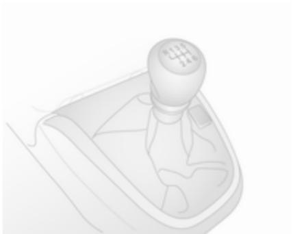
Zum Einlegen des Rückwärtsgangs bei stehendem Fahrzeug nach dem Treten des Kupplungspedals 3 Sekunden warten und dann den Gang einlegen.
