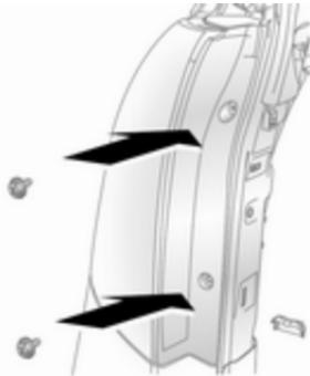
1. Öffnen Sie die Hecktür und entfernen Sie 2 Schrauben und die Leuchteneinheit.
