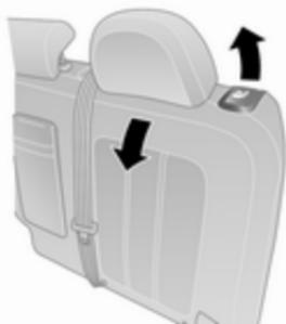
Heben Sie zum Einstellen der Rückenlehnen den Entriegelungshebel oben auf der Rückenlehne an und bringen Sie die Rückenlehne nach vorne/hinten in die gewünschte Position.
