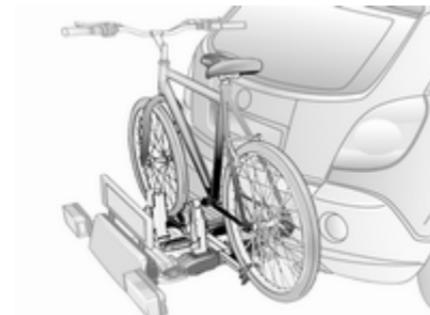
Das Heckträgersystem (Flex-Fix-System) bietet die Möglichkeit, Fahrräder auf einem in den Fahrzeugboden integrierten herausziehbaren Träger zu befestigen. Der Transport anderer Gegenstände ist nicht zulässig.
