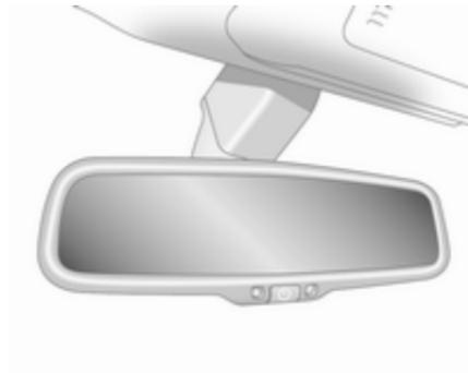
Zur Aktivierung der Funktion die Taste auf dem Spiegelgehäuse drücken. Die Taste leuchtet auf und die Blendung durch nachfolgende Fahrzeuge bei Nacht wird automatisch reduziert. Zum Ausschalten der Funktion erneut auf die Taste drücken.
