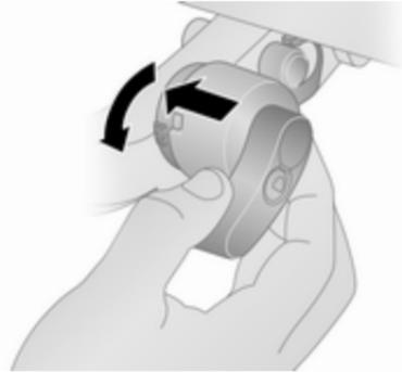
Entriegeln Sie die Kugelstange und ziehen Sie den Schlüssel ab. Ziehen Sie den Hebel nach links, in Richtung Kugelstange, und drehen Sie ihn nach unten. Ziehen Sie die Kugelstange aus dem Kupplungsgehäuse heraus.
