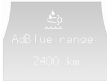
Wenn der AdBlue-Füllstand unter einen bestimmten Wert fällt, wird im Driver Information Center, das sich in der Mitte des Instruments befindet, eine Warnmeldung (z. B. „AdBlue-Reichweite: 2400 km“) angezeigt ↻ 97.
