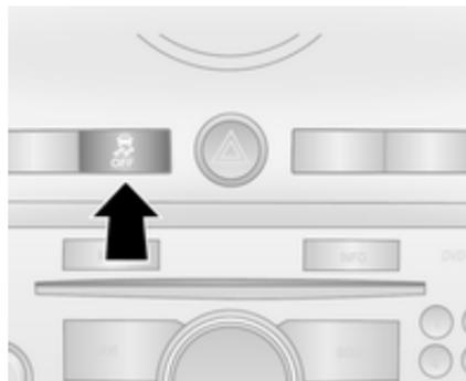
Wenn die Räder bei aktiver ESC-Funktion auf nasser, verschneiter oder vereister Fahrbahn rutschen, erhöht sich die Motordrehzahl beim
