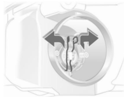
4. Federdrahtbügel nach vorn aus den Haltenasen ausrasten und nach unten schwenken.
