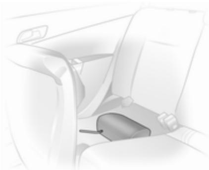
Hintere äußere Kopfstützen ausbauen, mittlere Kopfstütze ganz nach unten schieben ⇨ 49. Ausgebaute Kopfstützen in der Mulde unter den hochgestellten Sitzflächen verstauen.
