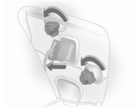
3. Befestigungsmuttern mit Rad-schraubensteckschlüssel lösen und von Hand abschrauben. Wagenwerkzeug ↻ 194.
