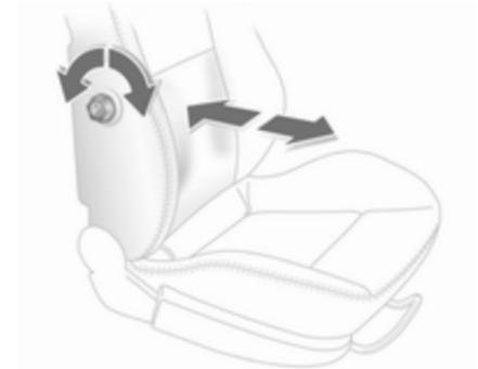
Handrad drehen. Zum Einstellen Rückenlehne entlasten.
