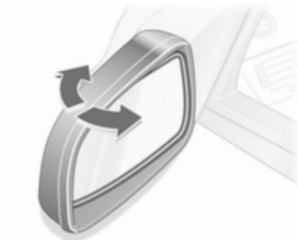
Zur Sicherheit von Fußgängern klappen die Außenspiegel bei Anstoßen aus ihrer Ausgangslage. Durch leichten Druck auf das Spiegelgehäuse wieder einrasten.
