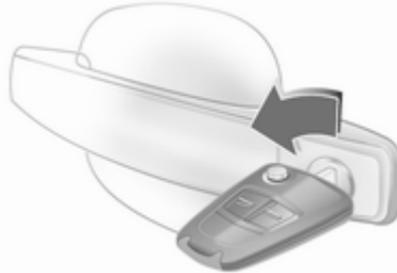
Schlüssel oder Notschlüssel
