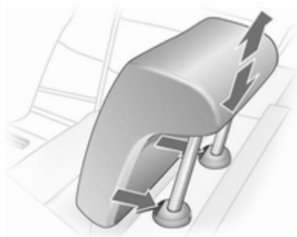
Kopfstütze nach oben ziehen bzw. beide Rastfedern zum Entriegeln drücken und die Kopfstütze dann nach unten schieben.
