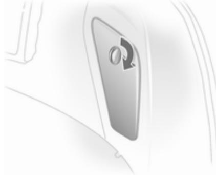
1. Zum Wechseln der Glühlampen auf der rechten Seite eine Münze verwenden, um die Verriegelung zu öffnen, und die Abdeckung herunterklappen.
