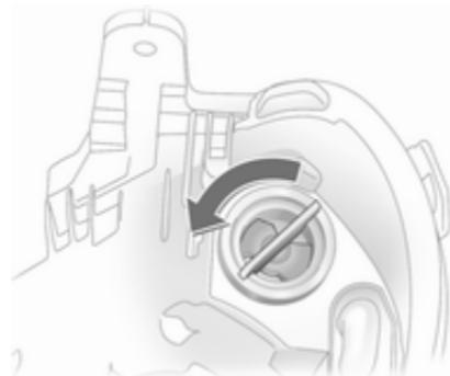
2. Lampenträger nach links drehen und ausrasten.
