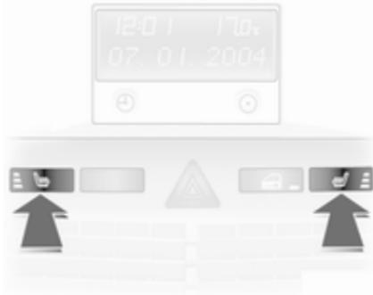
Je nach gewünschter Heizleistung Taste
