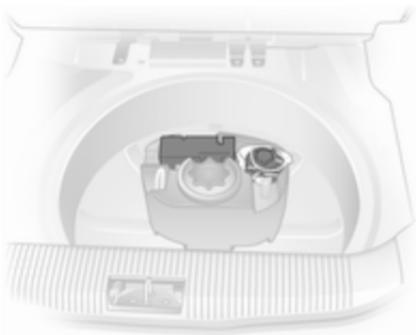
Das Reifenreparaturset befindet sich im Staufach unter der Bodenabdeckung im Laderaum.
