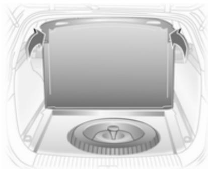
Adapter und Haken aus den Schienen in den Laderaumwänden nehmen. Hintere Verzurrösen hochstellen und Bodenabdeckung bis zur Senkrechten anheben, so dass sie an der Dachinnenverkleidung stehen bleibt. Beim Zurückklappen die Verzurrösen durch die Schlitzlöcher in der Bodenabdeckung führen. Fahrzeuge mit Cargo-Box: Ausbau ↗ 77.
