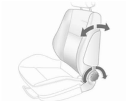
Handrad drehen. Zum Einstellen Rückenlehne entlasten.
