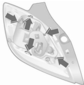
5. Dichtung von der Befestigungsschraube abnehmen. Die Sperrungen an den Außenseiten des Lampenträgers nach außen drücken und Lampenträger herausnehmen.
