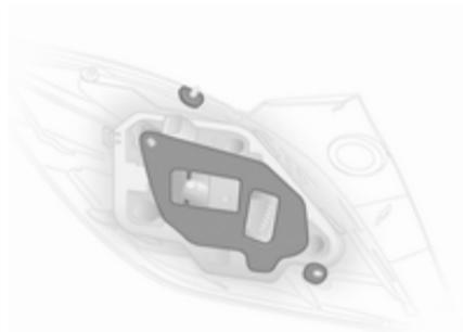
8. Sicherstellen, dass die Dichtungen am Lampenträger und an den Befestigungsschrauben ange-setzt sind.
