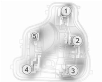
6. Glühlampe herausnehmen und neue Glühlampe einsetzen.
