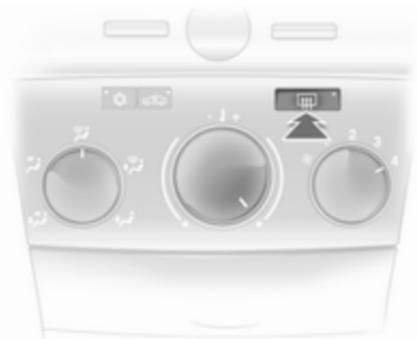
Die Heizung wird durch Drücken der Taste
