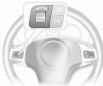
Menüpunkt durch Drehen auswählen. Zum Auswählen Markierung oder zum Bestätigen von Befehlen Stellrad drücken.
