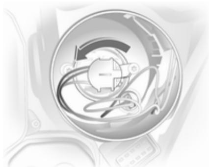
3. Linken Lampenträger drehen und austrasten.
