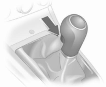
Zum Einlegen des Rückwärtsgangs nach Betätigung des Kupplungspedals bei stehendem Fahrzeug 3 Sekunden warten, anschließend den Entriegelungsknopf am Wählhebel nach oben ziehen und den Gang einlegen.
