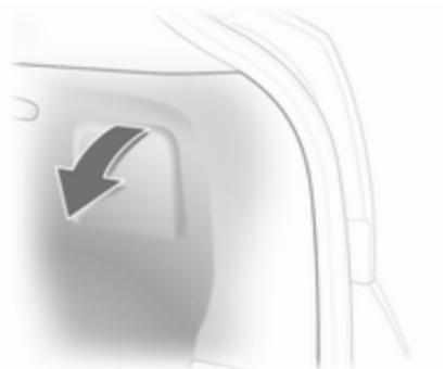
1. Zum Lampenwechsel Deckel nach unten klappen.
