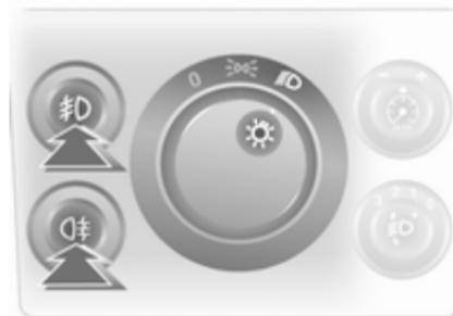
Die Nebelscheinwerfer lassen sich nur bei eingeschalteter Zündung und eingeschalteten Scheinwerfern oder Seitenleuchten einschalten.
