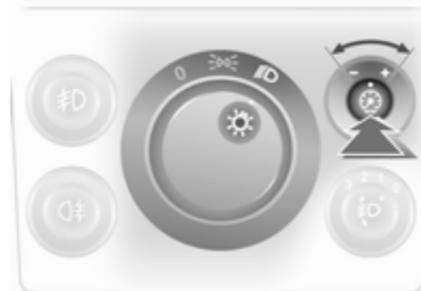
Helligkeit bei eingeschalteter Außenbeleuchtung einstellbar: Knopf
