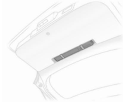
Warndreieck in Aussparung an der Hecktür einsetzen und mit Haltern rechts und links befestigen.
