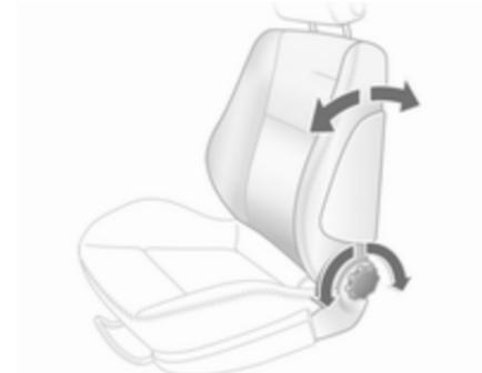
Handrad drehen. Zum Einstellen Rückenlehne entlasten.
