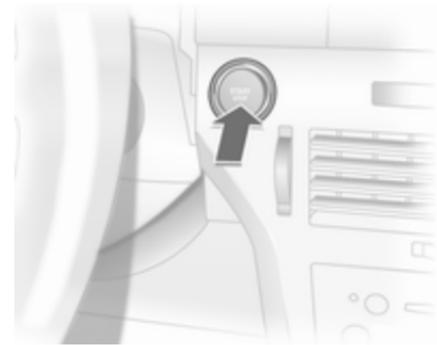
Taste **Start/Stop** drücken. Die Zündung schaltet sich ein. Elektronische Wegfahrsperrung und Lenksperre werden deaktiviert.
