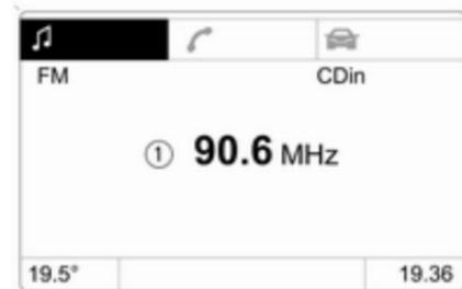
Für jeden Funktionsbereich gibt es eine Hauptseite (Main), die am oberen Displayrand ausgewählt wird (nicht bei Infotainmentsystem CD 30 oder Mobile Phone Portal):
