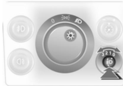
Leuchtweite der Fahrzeugbeladung anpassen, um das Blenden anderer zu vermeiden: Knopf durch Druck lösen und auf gewünschte Position drehen.
