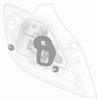
8. Sicherstellen, dass die Dichtungen am Lampenträger und an den Befestigungsschrauben angebracht sind.
