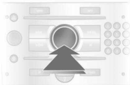
Zum Markieren von Menüpunkten oder Befehlen und zur Auswahl von Funktionsbereichen Multifunktionsknopf drehen.
