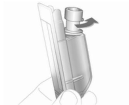
4. Lampenträger nach links drehen und ausrasten.
