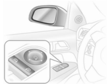
Zuerst entsprechenden Außenspiegel wählen, dann durch Schwenken des Schalters einstellen.
