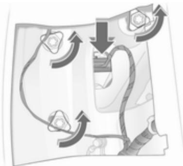
2. Kabelstecker vom Lampenträger abziehen.
