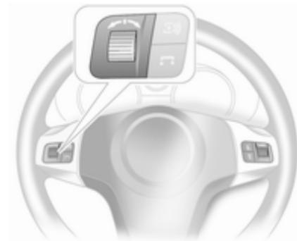
Das Infotainmentsystem und das Info-Display können vom Lenkrad aus bedient werden.
