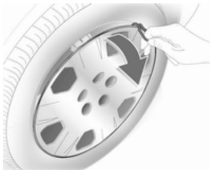
1. Radabdeckung mit dem Haken abziehen. Wagenwerkzeug  $\diamond$  194.
