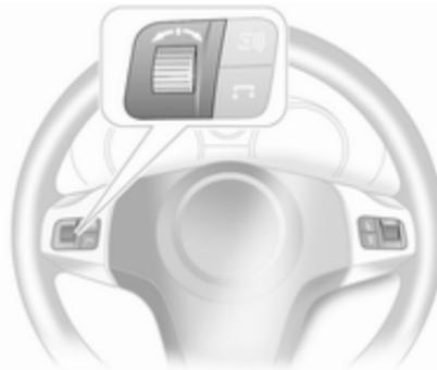
Drücken des Stellrads ruft das Menü **BC** auf. Im Menü **BC** wird die Stoppuhr bedient bzw. die Messung und Berechnung neu gestartet.
