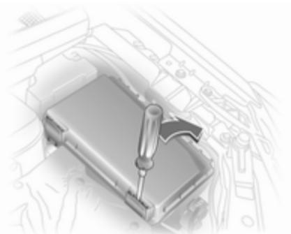
Schraubendreher bis zum Anschlag in Öffnungen stecken und zur Seite schwenken. Deckel nach oben klappen und abnehmen.
