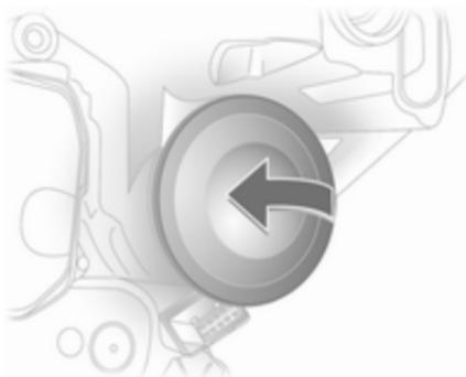
1. Lampenwechsel durch die Öffnungen in den Radkästen durchführen.
