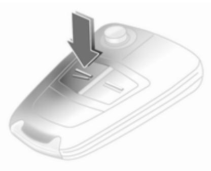
Wenn die Türen mit der Zentralverriegelung verriegelt sind, kann der Laderaumdeckel nicht mit der Taste
