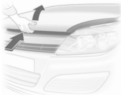
Sicherungsgriff hochdrücken und Motorhaube öffnen.
