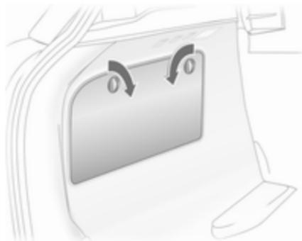
Der Sicherungskasten befindet sich hinter einer Abdeckung.
