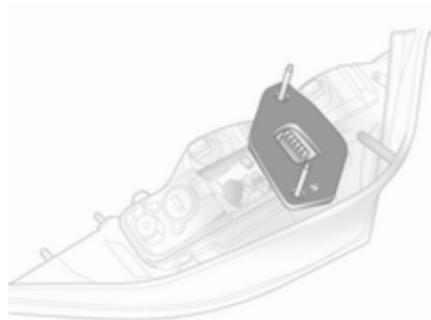
7. Dichtung am Lampenträger ansetzen. Sicherstellen, dass die Dichtung im Bereich um die Schrauben plan anliegt.
