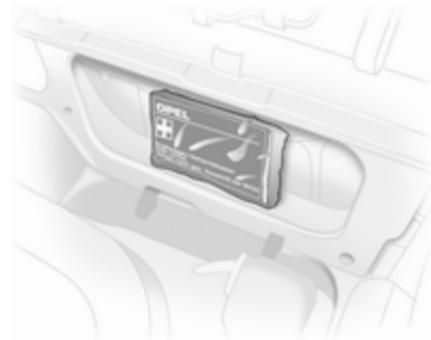
Verbandstasche im Staufach hinter dem Fahrersitz unterbringen. Zum Öffnen der Abdeckung die Rastnase drücken.
