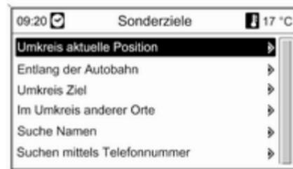
Taste **DEST** drücken und anschließend **Sonderziele** auswählen.
