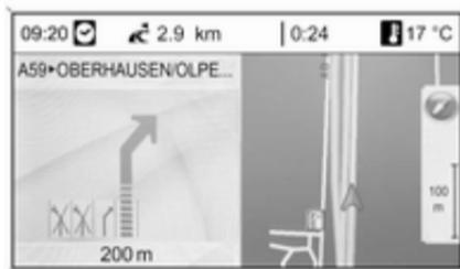
Bei aktivierter Option **Fahrspurasistent** im Menü **Darstellung Zielführung** ⇨ 75 wird folgende Darstellung angezeigt:
