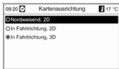
Ausrichtung (Nordweisend/In Fahrtrichtung) und Dimensionen (2D/3D) des Kartenausschnittes auswählen (3D nur bei DVD 800 verfügbar).
