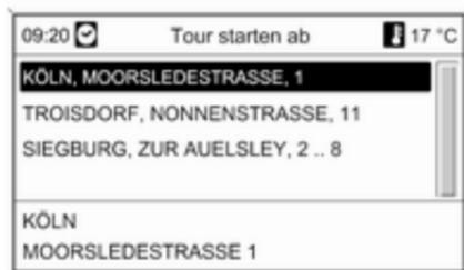
Das gewünschte nächste Ziel auswählen. Es wird eine direkte Route zum ausgewählten Zwischenziel berechnet.
