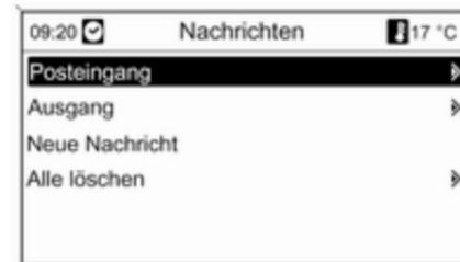
Wenn das Mobiltelefon mittels SAP-Modus gepaart wurde, können über das Mobiltelefon Portal Nachrichten angezeigt, verfasst und verschickt werden. Die Nachrichten können in diesem Menü auch gelöscht werden. Zur Anzeige empfangener Nachrichten: **Posteingang** auswählen.
