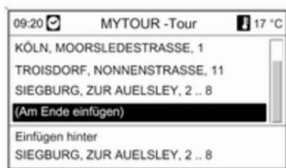
Neue Zwischenziele werden standardmäßig am Ende der Liste hinzugefügt. Wenn eine andere Position gewünscht wird, den Multifunktionsknopf drehen, um einen anderen Einfügepunkt auszuwählen.
