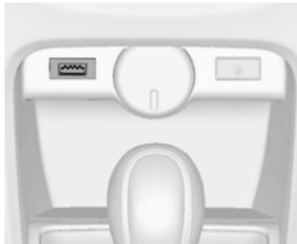
In der Mittelkonsole befindet sich eine USB-Buchse zum Anschluss externer Audioquellen.
