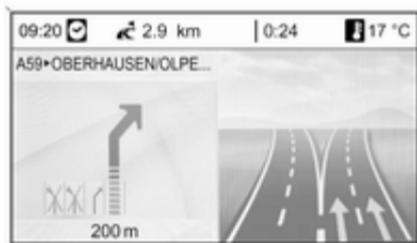
Mit der Option **Einblendautomatik** kann ausgewählt werden, ob Zielführungsinformationen der Navigation in anderen Betriebsarten (z. B. Radio) eingeblendet werden sollen. Nach einer bestimmten Zeit oder durch Drücken der Taste **BACK** werden die Informationen ausgeblendet.
