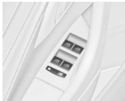
Zur Deaktivierung der elektrischen Fensterbetätigung der Hintertüren Fenster Schalter
