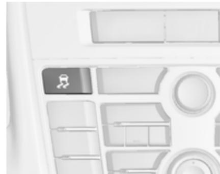
Die Traktionskontrolle kann ausgeschaltet werden, wenn ein Durchdrehen der Antriebsräder erwünscht ist: Taste
