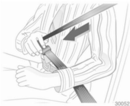
Den Gurt aus dem Aufroller herausziehen, unverdreht über den Körper legen und die Schlosszunge in das Gurtschloss einstecken, bis sie einrastet. Den Beckengurt während der Fahrt durch Ziehen am Schultergurt regelmäßig spannen. Sicherheitsgurt anlegen
