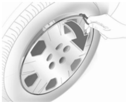
1. Radmutternkappen mit einem Schraubendreher lösen und abnehmen. Radabdeckung mit dem Haken abziehen. Wagenwerkzeug ↗ 198.
