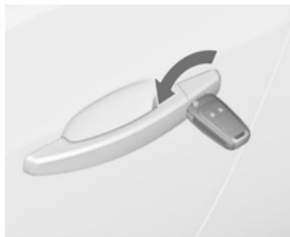
Fahrtür durch Drehen des Schlüssels im Schloss manuell entriegeln. Zündung einschalten und Zentralverriegelungstaste
