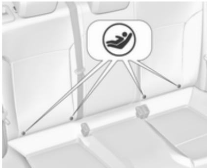
Für das Fahrzeug zugelassene ISOFIX Kindersicherheitsysteme an ISOFIX Befestigungsbügeln befestigen. Die speziellen Positionen für ISOFIX Kindersicherheitsysteme sind in der Tabelle mit IL gekennzeichnet.
