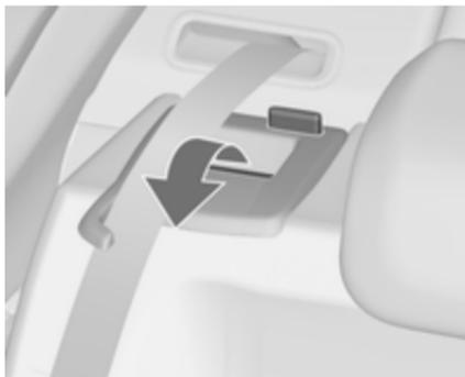
Die Sicherheitsgurte durch die seitlichen Halterungen führen, um sie vor Beschädigung zu schützen. Beim Umklappen der Rückenlehnen die Sicherheitsgurte mitziehen.
