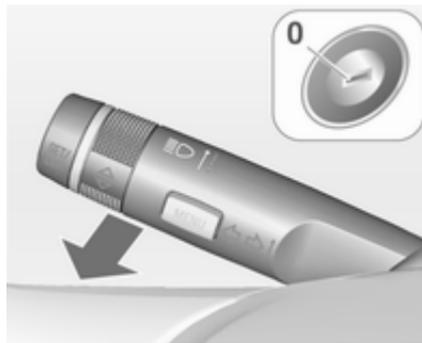
Scheinwerfer, Rückleuchten, Rückfahrlicht und Kennzeichenleuchte beleuchten für eine einstellbare Zeit nach dem Verlassen des Fahrzeugs die Umgebung.
