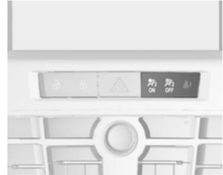
Solange die Kontrollleuchte
