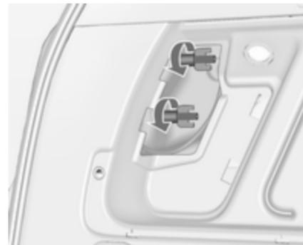
3. Zwei Kunststoff-Befestigungsmutter von innen mit der Hand abschrauben.
