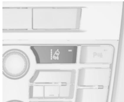
Der Spurassistent wird durch Drücken der Taste
