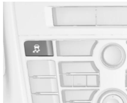
Für extremes Hochleistungsfahren kann ESC deaktiviert werden: Taste
