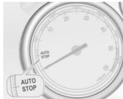
Ein Autostop wird auf dem Drehzahlmesser angezeigt, indem die Nadel auf der Position **AUTOSTOP** steht. Bei einem Autostop bleiben Heizleistung und Bremskraft erhalten.
