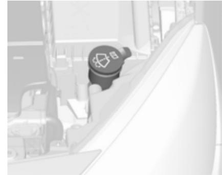
Mit einem Gemisch aus sauberem Wasser und einer geeigneten Menge Frostschutzmittelhaltiger Scheibenwaschflüssigkeit auffüllen. Das richtige Mischverhältnis ist auf dem Waschflüssigkeitsbehälter angegeben.
