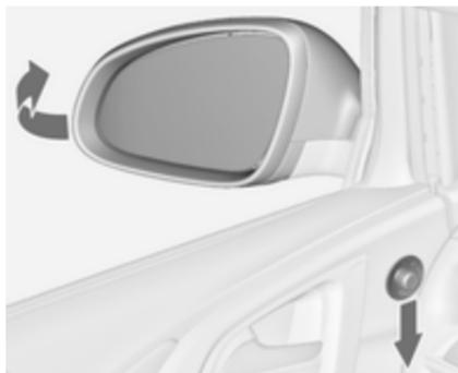
Bedienelement auf **0** drehen und dann hinunterdrücken. Beide Außenspiegel werden eingeklappt.
