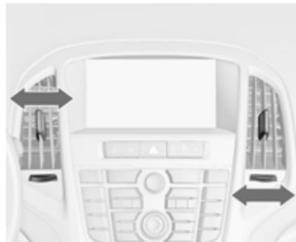
Zum Öffnen der Düse das Einstellrädchen zum größeren Symbol
