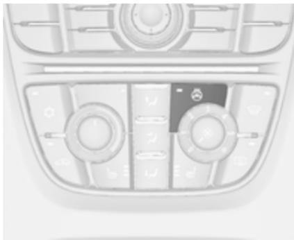
Die Heizung durch Drücken der Taste
