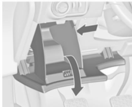
In Linkslenkern befindet sich der Sicherungskasten hinter dem Staufach in der Instrumententafel.
