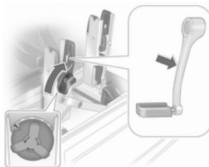
Bei Fahrrädern mit gekrümmten Tretkurbeln die Tretkurbelanlage vollständig hineindrehen (Position 1).
