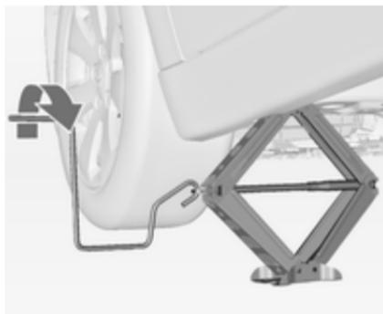
Kurbelstange anbringen und den korrekt ausgerichteten Wagenheber hochkurbeln, bis das Rad vom Boden abhebt.
