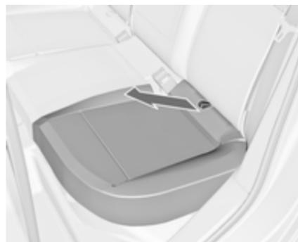
An der Schlaufe einer oder beider Sitzflächen ziehen und die Rückseite der Fläche nach vorne anheben.
