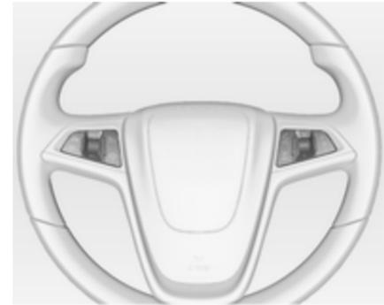
Das Infotainment-System, der Geschwindigkeitsregler und ein angeschlossenes Mobiltelefon können mit den Lenkradelementen bedient werden.
