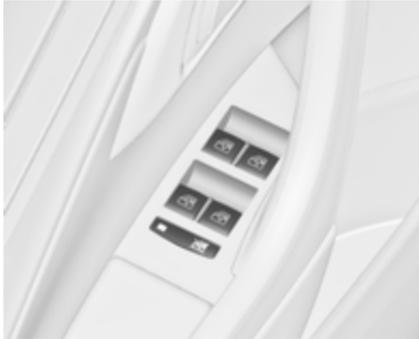
Zur Deaktivierung der elektrischen Fensterbetätigung der Hintertüren Schalter
