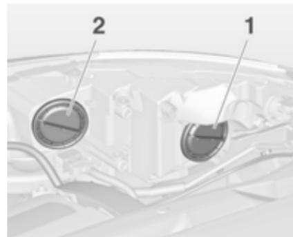
Scheinwerfer haben getrennte Systeme für Abblendlicht **1** (äußere Lampen) und Fernlicht **2** (innere Lampen).
