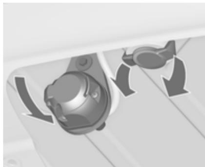
Die Steckdose ausrasten und nach unten klappen. Den Verschlussstopfen von der Öffnung für die Kugelstange entfernen und verstauen.
