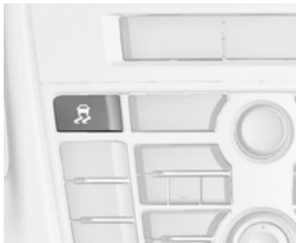
Für extremes Hochleistungsfahren kann ESC deaktiviert werden: Taste
