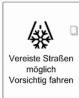
Wenn die Außentemperatur auf 3 °C sinkt, wird im Driver Information Center mit Uplevel-Display eine Warnmeldung angezeigt.
