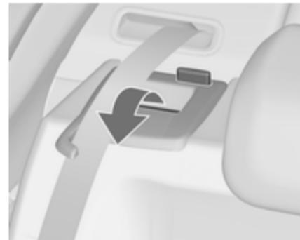
Sicherheitsgurte zum Schutz vor Beschädigung durch seitliche Halterungen führen. Beim Vorklappen der Lehnen die Sicherheitsgurte mit herausziehen.
