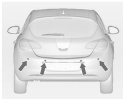
Die Einparkhilfe erleichtert das Parken, indem sie die Entfernung zwischen dem Fahrzeug und Hindernissen misst und diese durch akustische Signale angibt.
