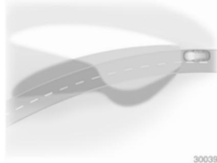
Der Lichtstrahl wird auf Basis des Lenkradwinkels und der Geschwindigkeit geschwenkt, was die Ausleuchtung von Kurven verbessert.
