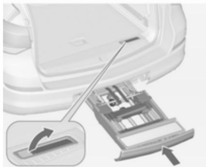
Den Entriegelungshebel nach oben ziehen und das Heckträgersystem in den Stoßfänger schieben, bis es hörbar einrastet.
