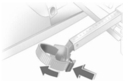
Entriegelungshebel am Spannband drücken und Spannband herausziehen.
