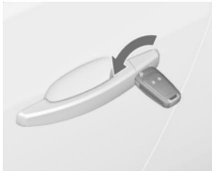
Die Fahrertür durch Drehen des Schlüssels im Schloss von Hand entriegeln. Zündung einschalten und Zentralverriegelungstaste
