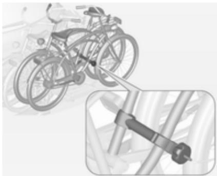
Das vierte Fahrrad mit der kurzen Zusatzhalterung befestigen. Die Halterung muss zwischen den Rahmen des dritten und des vierten Fahrrads fixiert werden.
