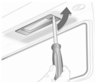
1. Schraubendreher in die Aussparung der Abdeckung einführen, zur Seite drücken und die Feder lösen. Abdeckung abnehmen.
