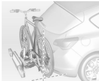
Fahrrad in Fahrzeuginnenrichtung ausrichten: Tretlagerfixierung etwas lösen.
