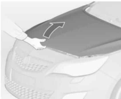
Verschlusshaken nach rechts ziehen und Motorhaube öffnen.
