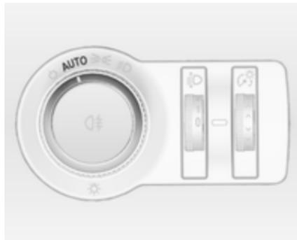
Bei aktivierter Funktion 'Automatisches Fahrlicht' und laufendem Motor schaltet das System abhängig von den Lichtverhältnissen und den Informationen des Regensensors zwischen Tagfahrlicht und Scheinwerfern automatisch um.
