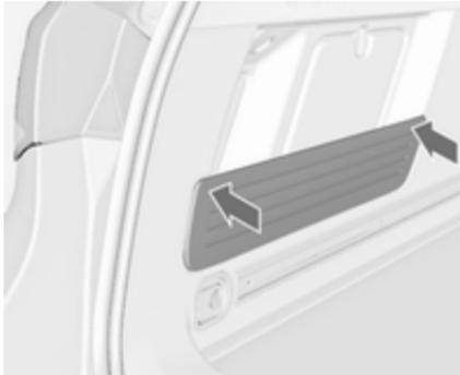
Beim Zusammenbau Sonnenrollo in die Gummitüllen drücken, um volle Haltekraft zu erreichen.
