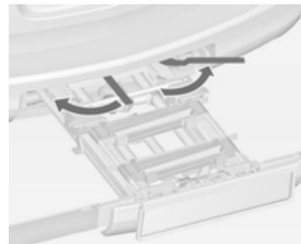
Die beiden Spannhebel so weit wie möglich zur Seite schwenken.
