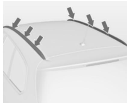
Zur Befestigung des Dachgepäckträgers Montagebolzen in die abgebildeten Bohrungen stecken.
