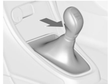
Zum Einlegen des Rückwärtsgangs, bei stehendem Fahrzeug Knopf am Wählhebel betätigen und Gang einlegen.
