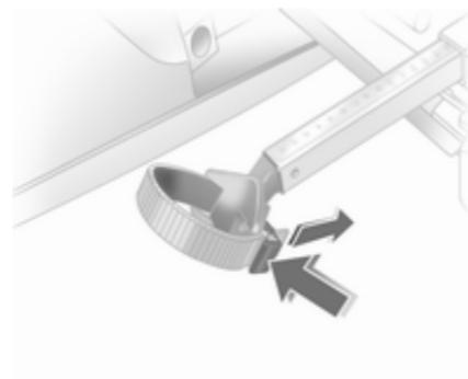
Spannband einführen und soweit wie möglich nach unten festziehen.
