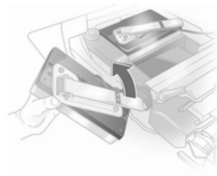
Den Leuchtenhalter an der Rückseite der Rückleuchte vollständig ausklappen.
