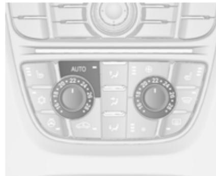
Bei Einstellung der Mindesttemperatur arbeitet die Klimaanlage mit maximaler Kühlleistung.
