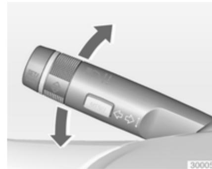
Hebel nach oben = Blinker rechts
