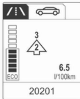
Ein Pfeil zeigt an, dass ein Hochschalten empfohlen wird, um Kraftstoff zu sparen.
