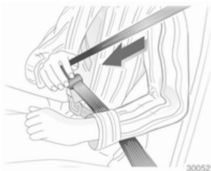
Den Gurt aus dem Aufroller herausziehen, unverdreht über den Körper legen und die Schlosszunge in das Gurtschloss einstecken, bis sie einrastet. Den Beckengurt während der Fahrt durch Ziehen am Schultergurt regelmäßig spannen. Sicherheitsgurt anlegen
