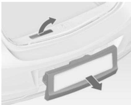
Entriegelungshebel nach oben ziehen. Das System rastet aus und fährt schnell aus dem Stoßfänger.
