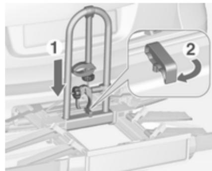
Den Träger (1) nach unten drücken und den Griff (2) nach hinten schwenken und einrasten lassen.
