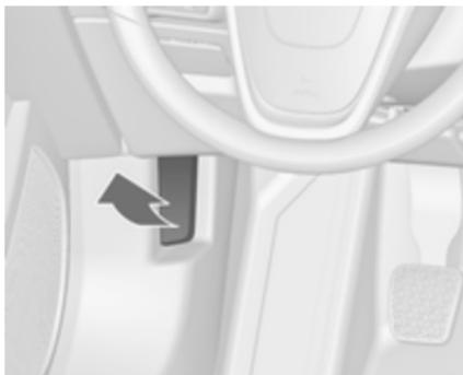
Entriegelungshebel ziehen und in die Ausgangsposition zurückführen.
