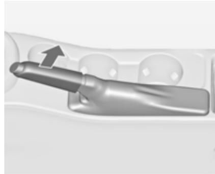
Parkbremse immer ohne Betätigung des Entriegelungsknopfes fest anziehen; bei Gefälle oder Steigung so fest wie möglich anziehen.
