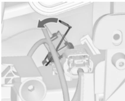
1. Die Federklammer lösen und nach hinten schwenken.
