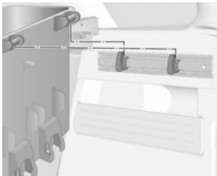
Zwei Haken in die obere Schiene einbauen. Die oberen Halterungen der Box von oben in die Haken einsetzen.
