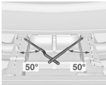
Das Heckträgersystem ist verriegelt, wenn die Spannhelme zu etwa 50° eingeschwenkt sind. Nur dann ist ein sicheres Funktionieren gewährleistet.
