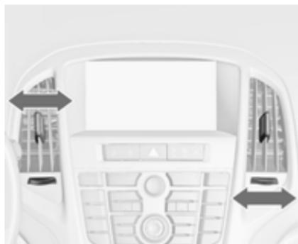
Zum Öffnen der Düse das Einstellrädchen zum größeren Symbol ■ drehen.
