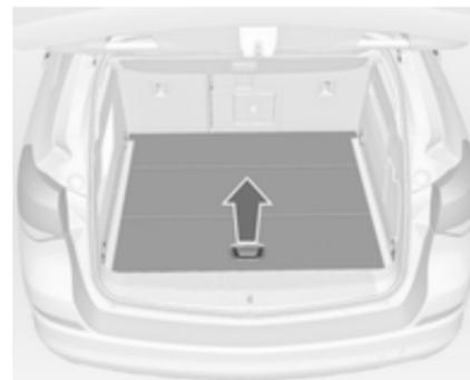
Die Bodenabdeckung am Griff nach oben ziehen. Die Abdeckung zusammenfalten und hinter den Rücksitzen verstauen.
