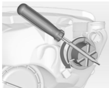
1. Die Kappe nach links drehen und abnehmen. Den Schraubendreher zum Drehen der Kappe verwenden.
