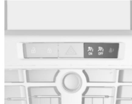
Solange die Kontrollleuchte
