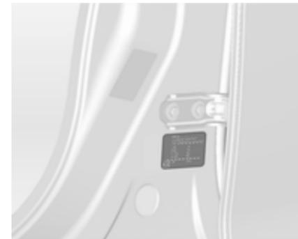
Das Typenschild befindet sich am linken Vordertürrahmen.
