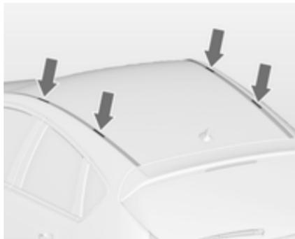
Die Abdeckung von jedem Befestigungspunkt mit einer Münze entfernen.
