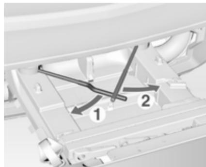
Zuerst den linken Spannhebel (1), danach den rechten Spannhebel (2) bis zum Anschlag schwenken.
