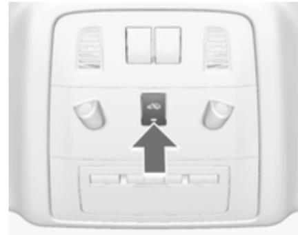
Wenn Tiere im Fahrzeug zurückgelassen werden, muss die Überwachung des Fahrzeuginnenraums und der Fahrzeugneigung abgeschaltet werden, weil laute Ultraschallsignale oder Bewegungen den Alarm auslösen Auch ausschalten, wenn das Fahrzeug auf einer Fähre oder einem Zug transportiert wird.
