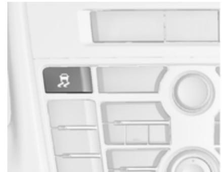
Die Traktionskontrolle kann ausgeschaltet werden, wenn ein Durchdrehen der Antriebsräder erwünscht ist: Taste
