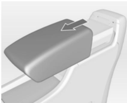
Die Armlehne kann um 10 cm nach vorn verschoben werden. Unter der Armlehne befindet sich ein Staufach. Armlehnenfach ↗ 58.
