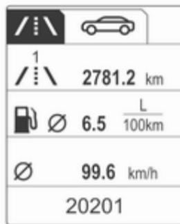
In der erweiterten Ausführung des Uplevel-Displays lassen sich die Menüs über Symbole oben auf dem Display auswählen:
