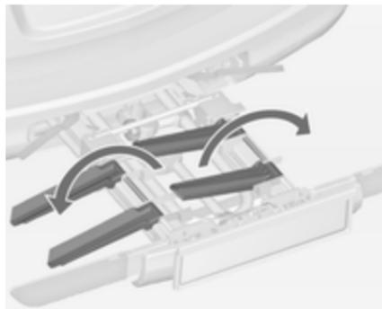
Beide Radaufnahmen ausklappen.
