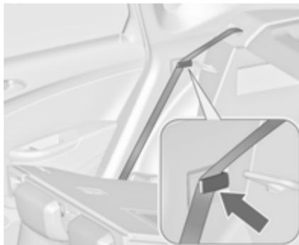
Wenn das Fahrzeug durch eine Hintertür beladen werden soll, den Sicherheitsgurt wie in der Abbildung gezeigt aus der Führung der Rückenlehne nehmen und hinter die Halterung schieben.
