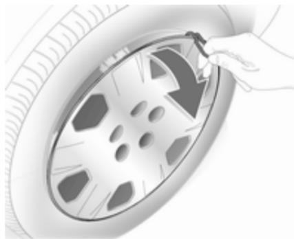
1. Radmutterkappen mit Schraubendreher lösen und abnehmen. Radabdeckung mit dem Haken abziehen. Wagenwerkzeug ⇨ 207.
