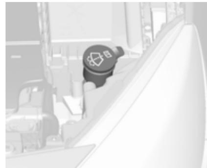
Mit einem Gemisch aus sauberem Wasser und einer geeigneten Menge Frostschutzmittelhaltiger Scheibenwaschflüssigkeit auffüllen. Das richtige Mischverhältnis ist auf dem Waschflüssigkeitsbehälter angegeben.
