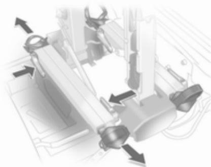
Entriegelungshebel drücken und Radaufnahmen herausziehen.
