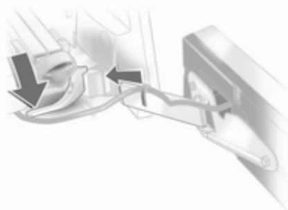
Spannhebel nach unten drücken und Lampenträger in die Halterung drücken, bis er einrastet.
