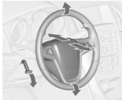
Hebel entriegeln, Lenkrad einstellen, Hebel einrasten und darauf achten, dass er komplett verriegelt ist.
