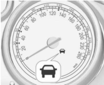
Wenn das System ein vorausfahrendes Fahrzeug in der Fahrspur erkennt, leuchtet die Anzeige für ein erkanntes vorausfahrendes Fahrzeug
