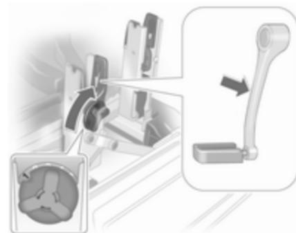
Bei Fahrrädern mit gekrümmten Tretkurbeln die Tretkurbelanlage vollständig hineindrehen (Position 1).
