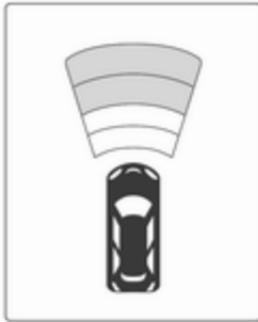
Bei Ausführungen mit Uplevel-Display zeigen wechselnde Segmente den Abstand zu einem Hindernis vor dem Fahrzeug an.
