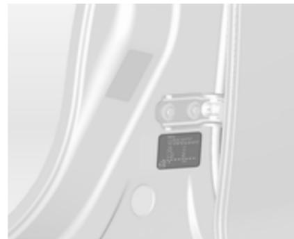
Das Typenschild befindet sich am linken Vordertürrahmen.
