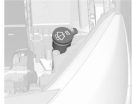
Mit einem Gemisch aus sauberem Wasser und einer geeigneten Menge Frostschutzmittelhaltiger Scheinwaschflüssigkeit auffüllen. Das richtige Mischverhältnis ist auf dem Waschflüssigkeitsbehälter angegeben.
