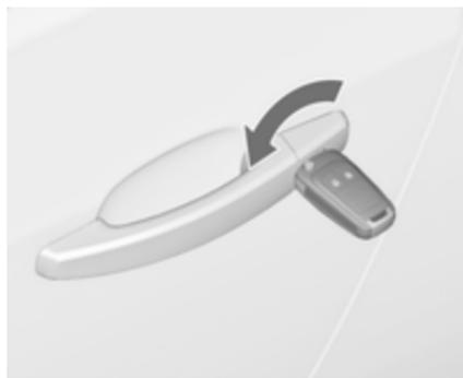
Fahrtür durch Drehen des Schlüssels im Schloss manuell entriegeln. Zündung einschalten und Zentralverriegelungstaste
