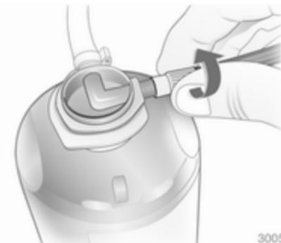
4. Kompressor-Luftschlauch an den Anschluss der Dichtmittelflasche schrauben.
