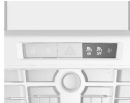
Wenn die Kontrollleuchte
