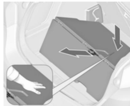
Zum Absenken der Abdeckung den Haltegriff nach hinten ziehen und gleichzeitig die Vorderkante der Abdeckung in der Mitte nach unten drücken.
