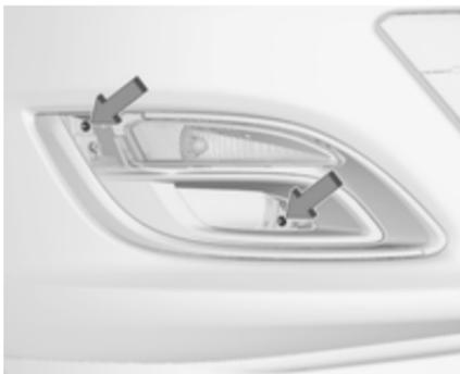
2. Beide Schrauben ausdrehen und den Leuchtenschaubehälter vom Stoßfänger abnehmen.
