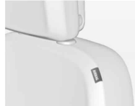
Das Seiten-Airbag-System besteht aus einem Airbag in der Rückenlehne jedes Vordersitzes. Diese Stellen sind mit dem Wort **AIRBAG** gekennzeichnet.
