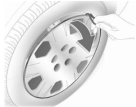
1. Radmutternkappen mit Schraubendreher lösen und abnehmen. Radabdeckung mit dem Haken abziehen. Wagenwerkzeug ↷ 261.
