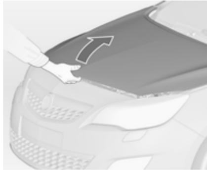
Verschlusshaken nach rechts ziehen und Motorhaube öffnen.
