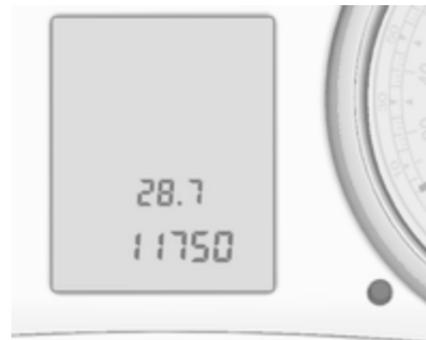
Anzeige der gefahrenen Entfernung in km in der unteren Zeile.
