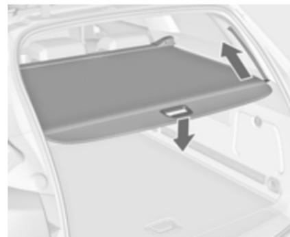
Den Griff am Ende der Abdeckung nach unten drücken. Die Rückseite der Abdeckung kommt automatisch nach oben.
