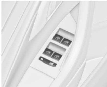
Zur Deaktivierung der elektrischen Fensterbetätigung der Hintertüren Schalter
