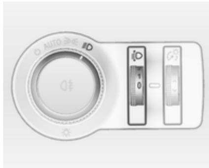
Zur Anpassung der Leuchtweite an die Fahrzeuglast, um Blendwirkung zu reduzieren: Daumenrädchen
