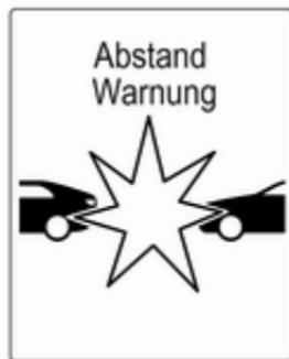
Beim zu schnellen Heranfahren an ein vorausfahrendes Fahrzeug wird die Auffahrwarnungsmeldung im Fahrerinformationszentrum angezeigt. Gleichzeitig ertönt ein Signalton. Betätigen sie das Bremspedal, wenn es die Situation erfordert.
