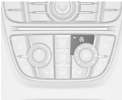
Die Heizung durch Drücken der Taste
