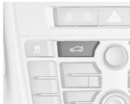
Wenn die Türen über die Zentralverriegelung verriegelt sind, kann der Laderaumdeckel nicht über die Taste
