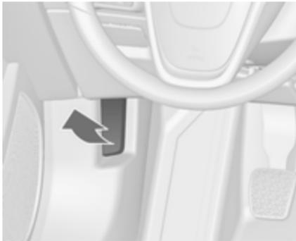
Entriegelungshebel ziehen und in die Ausgangsposition zurückführen.
