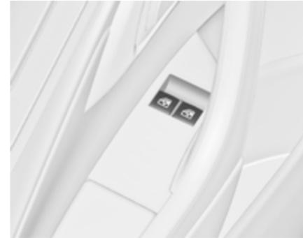
Schalter für das betreffende Fenster betätigen, indem er zum Öffnen gedrückt bzw. zum Schließen gezogen wird.
