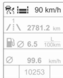
Das Symbol für den adaptiven Geschwindigkeitsregler, der eingestellte Sicherheitsabstand und die festgelegte Geschwindigkeit werden in der obersten Zeile des Fahrerinformationszentrums angezeigt.
