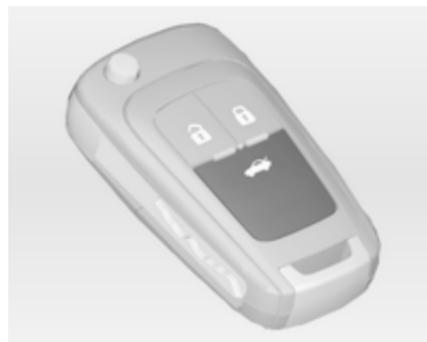
Durch Drücken der Taste
