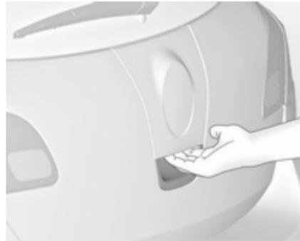
Nach dem Entriegeln den Touchpad-Schalter unterhalb des Emblems betätigen und die Hecktür öffnen.
