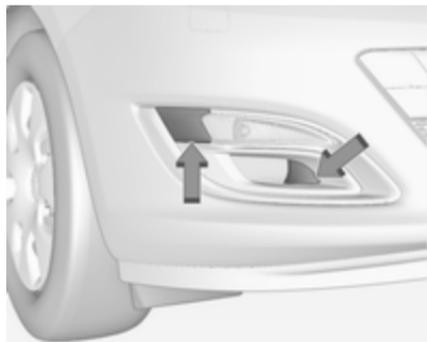
1. Beide Abdeckungen durch Ansetzen eines Schraubendrehers an den markierten Stellen entfernen.
