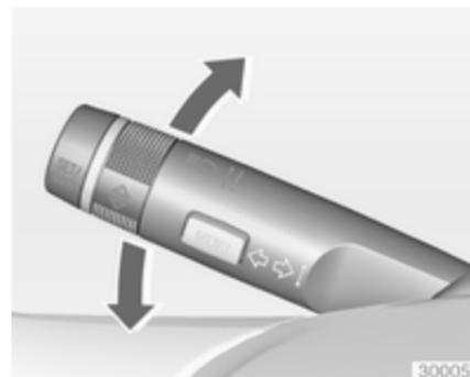
Hebel nach oben = Blinker rechts
