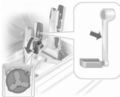
Mit dem Drehgriff an der Tretkurbelaufnahme die verstellbare Tretkurbelanlage grob an die Kröpfung der Tretkurbel anpassen.
