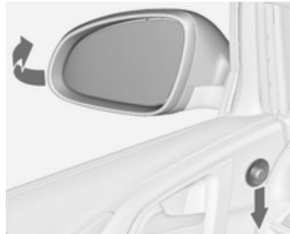
Bedienelement auf **0** drehen und dann hinunterdrücken. Beide Außenspiegel werden eingeklapppt.
