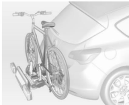
Das Heckträgersystem (Flex-Fix-System) bietet die Möglichkeit, Fahrräder auf einem in den Fahrzeugboden integrierten herausziehbaren Träger zu befestigen. Der Transport anderer Gegenstände ist nicht zulässig.
