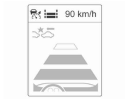
Beachten Sie, dass die Einstellung der Warnempfindlichkeit mit der Abstandswarnung des adaptiven Geschwindigkeitsreglers zusammenhängt. Durch Ändern der Warnempfindlichkeit wird auch die Einstellung der Abstandswarnung des adaptiven Geschwindigkeitsreglers geändert.
