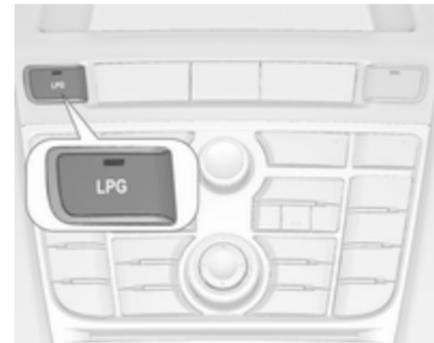
Taste **LPG** drücken, um zwischen Benzin- und Flüssiggasbetrieb zu wechseln. Die LED-Leuchte ● zeigt den aktuellen Betriebsmodus.
