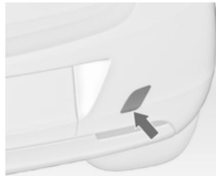
Mit einem Schraubendreher in den Schlitz an der unteren Beuge der Abdeckung fahren. Abdeckung durch vorsichtiges Abwärtsbewegen des Schraubendrehers lösen.
