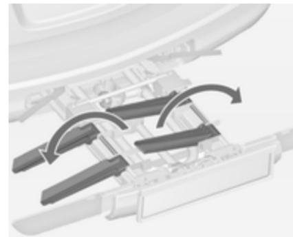
Beide Radaufnahmen ausklappen.
