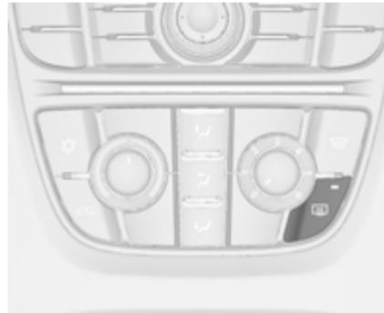
Die Heizung wird durch Drücken der Taste
