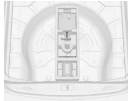
Bei Ausführungen mit dem Heckträgersystem ⇨ 68 sind das Reifenreparaturset, ein Schraubendreher und die Abschleppöse im Schubfach unter dem Beifahrersitz verstaut ⇨ 66.
