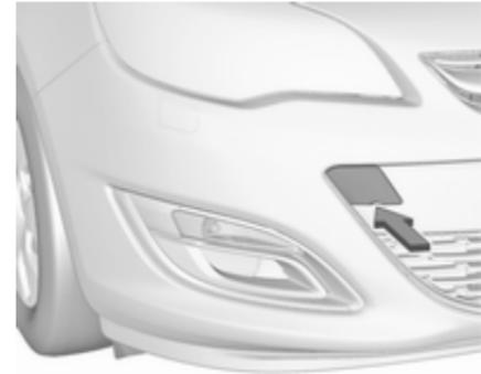
Mit einem Schraubendreher in den Schlitz unten an der Abdeckung fahren. Abdeckung durch vorsichtiges Abwärtsbewegen des Schraubendrehers lösen.
