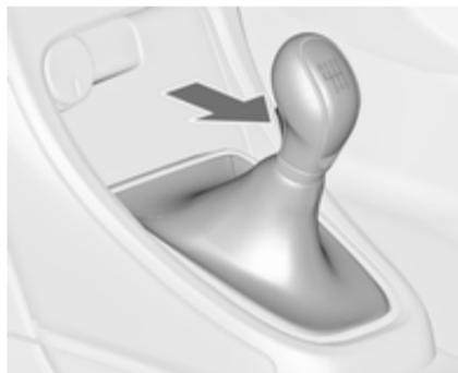
Zum Einlegen des Rückwärtsgang bei stehendem Fahrzeug das Kupplungspedal treten, den Entriegelungsknopf am Wählhebel drücken und Gang einlegen.
