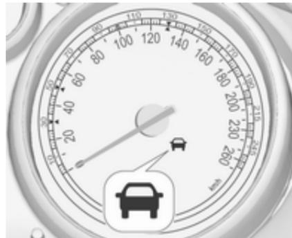
Wenn das System ein vorausfahrendes Fahrzeug in der Fahrspur erkannt hat, leuchtet die Kontrollleuchte für ein erkanntes vorausfahrendes Fahrzeug
