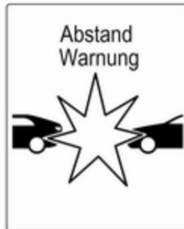
Wenn der Abstand zu einem vorausfahrenden Fahrzeug zu gering wird oder Sie sich einem anderen Fahrzeug zu schnell nähern, wird im DIC das Kollisionswarnsymbol angezeigt.
