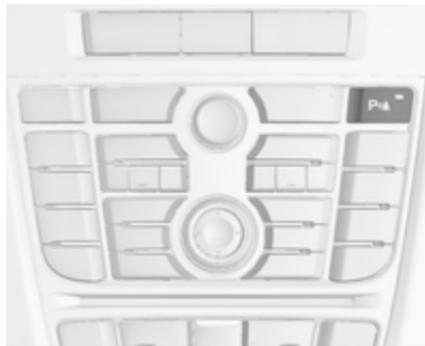
Die Front-Heck-Einparkhilfe wird mit der Taste **P** mit einem Dreieckssymbol betätigt. Wenn das Fahrzeug zusätzlich mit der erweiterten Einparkhilfe ausgestattet ist (siehe nachfolgende Beschreibung), enthält das System die Taste **P** mit einem Quadrat-Symbol. In diesem Fall werden beide Systeme über **P** mit einem Quadrat-Symbol bedient.
