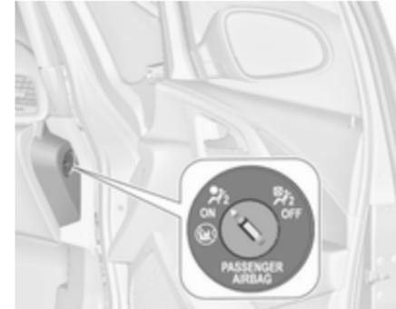
Das Beifahrer-Airbag-System kann mit dem Schlüssel über einen Schalter an der rechten Seite der Instrumententafel deaktiviert werden.
