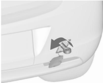
Abschleppöse bis zum Anschlag in waagrechtter Stellung einschrauben.
