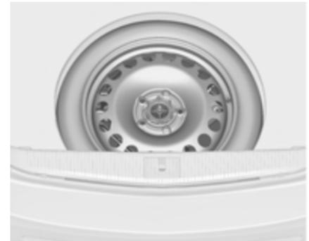
Das Reserverad befindet sich im Laderaum unter der Abdeckung des Laderaumbodens. Es ist mit einer Flügelmutter befestigt.
