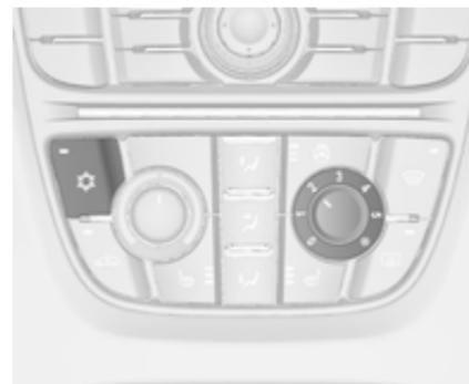
drücken, um die Kühlung einzuschalten. Die Aktivierung wird durch das Leuchten der LED auf der Taste angezeigt. Die Kühlung ist nur bei laufendem Motor und eingeschaltetem Gebläse der Klimatisierung funktionsfähig.
