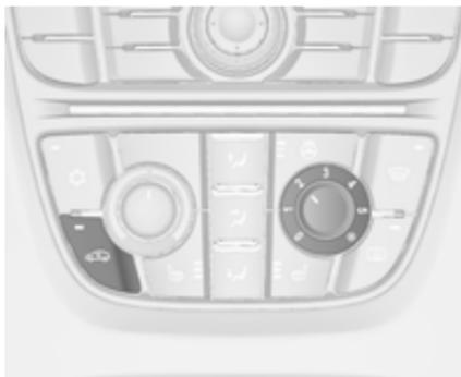
Zum Einschalten des Umluftbetriebs
