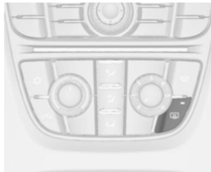
Wird durch Drücken von
