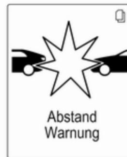
Wenn das System ein vorausfahrendes Fahrzeug in der Fahrspur erkennt, leuchtet die Kontrollleuchte für ein erkanntes vorausfahrendes Fahrzeug 🚗 grün im Instrument auf. Wenn der Abstand zu einem vorausfahrenden Fahrzeug zu gering wird oder Sie sich einem anderen Fahrzeug zu schnell nähern, wird im DIC das Kollisionswarnsymbol angezeigt. Gleichzeitig ertönt ein Warnton.
