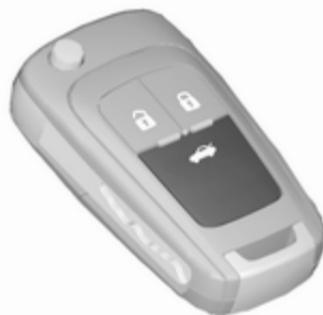
Durch Drücken auf
