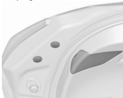
1. Die Hecktür öffnen und die Abdeckung und Blindabdeckungen auf beiden Seiten ausbauen.
