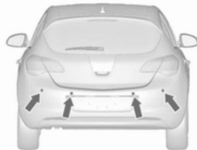
Das System besteht aus vier Ultraschall-Parkensensoren im hinteren Stoßfänger.
