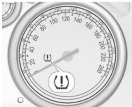
Wenn niedriger Reifendruck erkannt wird, wird dies durch die Kontrollleuchte (⚠) gemeldet ⇨ 123.
