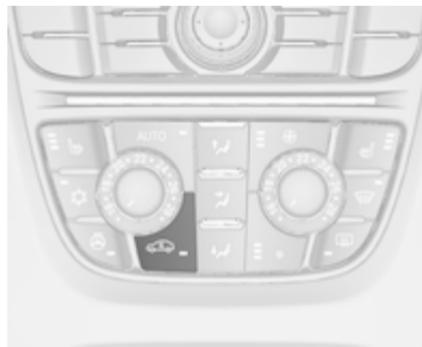
Zum Einschalten des Umluftbetriebs
