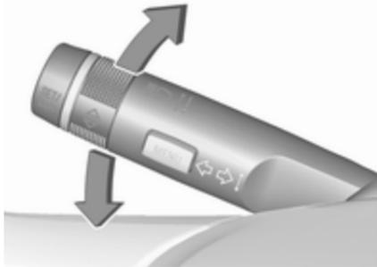
Hebel nach oben = Blinker rechts
