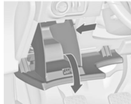
In Linkslenkern befindet sich der Sicherungskasten hinter dem Staufach in der Instrumententafel.
