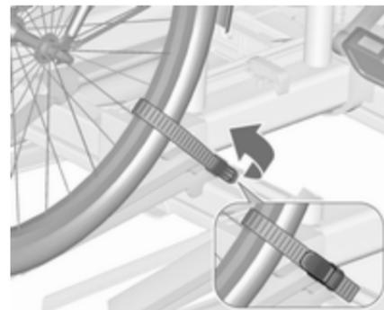
3. Beide Fahrradreifen mit Spannbändern an den Radaufnahmen sichern.
