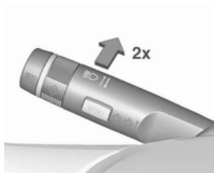
Durch zweimaliges Drücken des Blinkerhebels werden die intelligente Leuchtweitenregulierung und das automatische Fernlicht eingeschaltet. Sie können bei eingeschalteter Zündung eingeschaltet werden.
