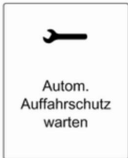
Arbeitet das System nicht ordnungsgemäß, werden Fahrzeugmeldungen im DIC angezeigt.
