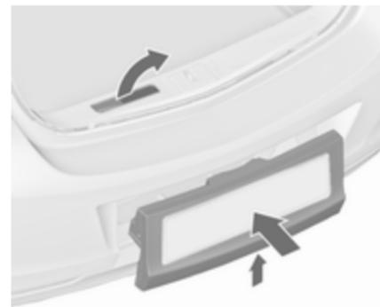
Entriegelungshebel nach oben drücken und halten. Das System etwas anheben und bis zum Einrasten in den Stoßfänger drücken.
