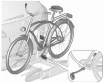
1. Die Pedale in die abgebildete Position drehen und das Fahrrad auf der vordersten Radaufnahme platzieren.
