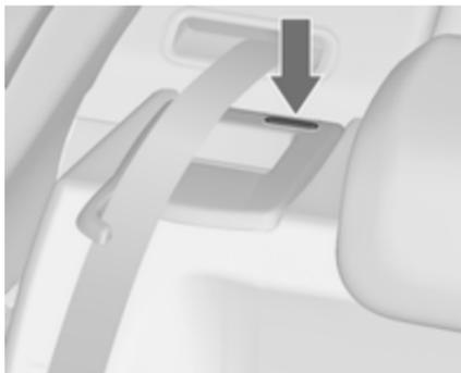
Die Rückenlehnen sind korrekt eingerastet, wenn die roten Markierungen auf beiden Seiten neben dem Entriegelungsgriff nicht mehr sichtbar sind.
