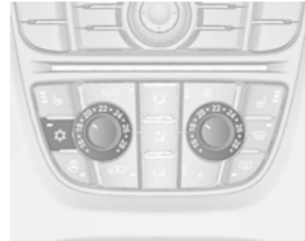
☀ drücken, um die Kühlung einzuschalten. Die Aktivierung wird durch das Leuchten der LED auf der Taste angezeigt. Die Kühlung ist nur bei laufendem Motor und eingeschaltetem Gebläse der Klimatisierung funktionsfähig.
