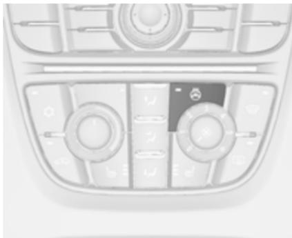
Die Heizung durch Drücken von
