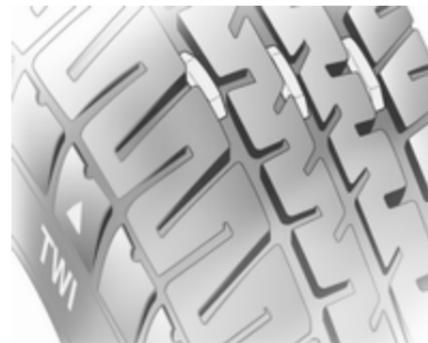
Die gesetzlich zulässige Mindestprofiltiefe (1,6 mm) ist erreicht, wenn das Profil bis zu einem der Verschleißanzeiger (TWI = Tread Wear Indicator) abgefahren ist. Deren Lage wird durch Markierungen an der Reifenflanke angezeigt.
