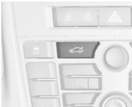
Wenn die Türen über die Zentralverriegelung verriegelt sind, kann der Kofferraumdeckel nicht durch Drücken auf
