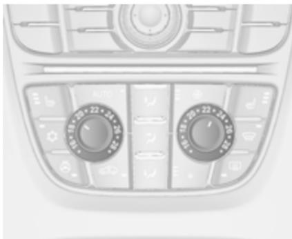
Ist die Mindesttemperatur **Lo** eingestellt, läuft die Klimaanlage mit maximaler Kühlung, sofern die Kühlung
