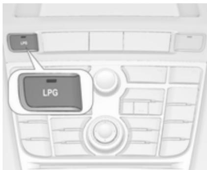
Durch Drücken von **LPG** wird zwischen Benzin- und Flüssiggasbetrieb umgeschaltet, sobald die erforderlichen Parameter (Kühlmitteltemperatur, Gastemperatur und Mindestdrehzahl des Motors) erreicht sind. Die Anforderungen sind normalerweise nach etwa 60 Sekunden (je nach Außentemperatur) und der ersten festen
