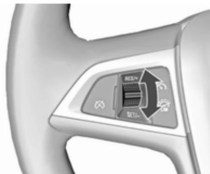
Bei aktiviertem Geschwindigkeitsbegrenzer das Daumenrad in Position **RES/+** gedreht halten oder wiederholt in Position **RES/+** drehen, bis die gewünschte Höchstgeschwindigkeit im DIC angezeigt wird.
