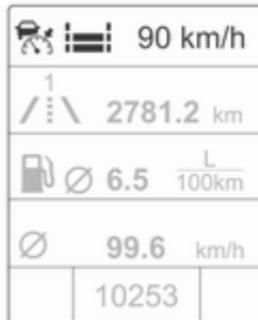
Das Symbol für den adaptiven Geschwindigkeitsregler, der eingestellte Sicherheitsabstand und die festgelegte Geschwindigkeit werden in der obersten Zeile des Driver Information Center (DIC) angezeigt.
