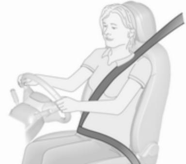
Bei starker Beschleunigung oder Verzögerung des Fahrzeugs blockieren die Sicherheitsgurte, um die Insassen in Sitzposition zu halten. Dadurch wird die Verletzungsgefahr deutlich verringert.
