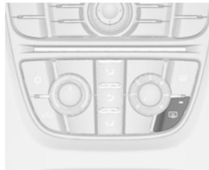
Die Heizung wird durch Drücken von
