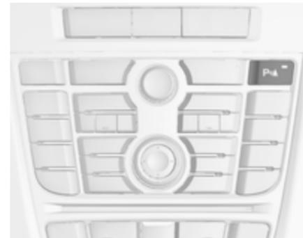
Durch kurzes Drücken auf **P** mit einem Dreieckssymbol oder **ESC** kann die Funktion manuell deaktiviert werden.
