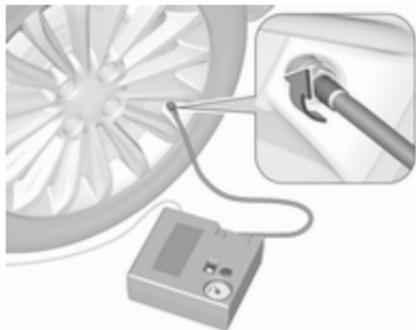
Wenn der Reifendruck mehr als 1,3 bar beträgt, auf den vorgeschriebenen Wert korrigieren. Vorgang wiederholen, bis kein Druckverlust mehr auftritt.
