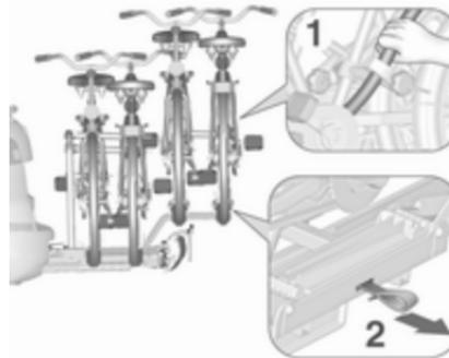
Den Rahmen (1) des hintersten Fahrrads mit einer Hand halten und zum Lösen des Trägers an der Schlaufe (2) ziehen.
