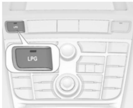
**LPG** drücken, um zwischen Benzin- und Flüssiggasbetrieb umzuschalten. Die LED-Leuchte
