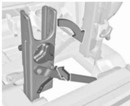
Den Arretierhebel an der diagonalen Stütze ausrasten und beide Trekkurbelaufnahmen nach unten klappen.
