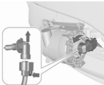
3. Die Lampenfassung linksherum drehen und aus dem Reflektor herausnehmen.
