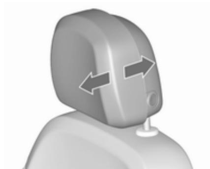
Für die Horizontaleinstellung Kopfstütze nach vorne ziehen. Sie rastet in verschiedenen Positionen ein.
