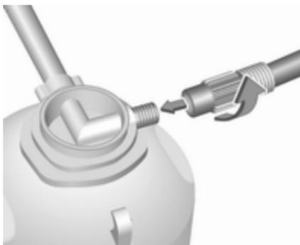
4. Kompressor-Luftschlauch an den Anschluss der Dichtmittelflasche schrauben.
