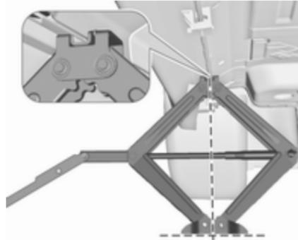
Wagenheber auf die erforderliche Höhe einstellen. Den Heber unmittelbar unter den Ansatzpunkt stellen und sicherstellen, dass er nicht rutschen kann.
