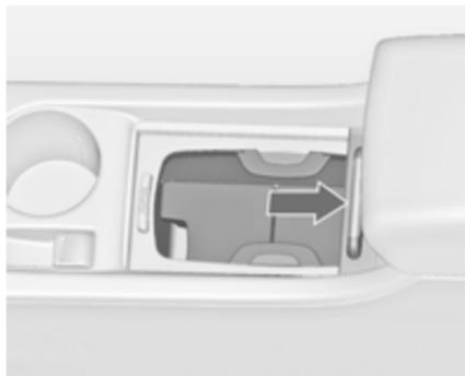
Je nach Version befinden sich Getränkehalter unter einer Abdeckung in der Mittelkonsole. Abdeckung nach hinten schieben. Bei hochgeklappter Mittelablage können Flaschen abgestellt werden ⇨ 66.
