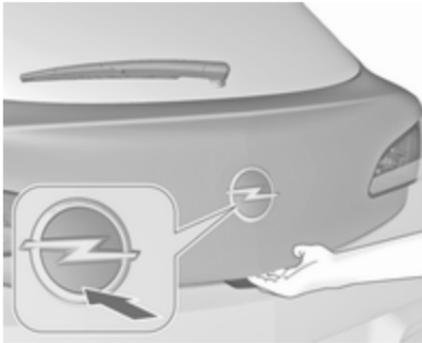
Zum Öffnen der Hecktür auf die untere Hälfte des Markenemblems drücken.
