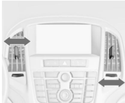
Zum Öffnen der Düse das Einstellrädchen zum größeren Symbol
