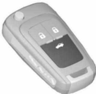
Durch Drücken auf
