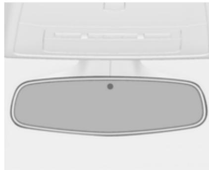
Bei Nacht wird die Blendwirkung durch nachfolgende Fahrzeuge automatisch reduziert.
