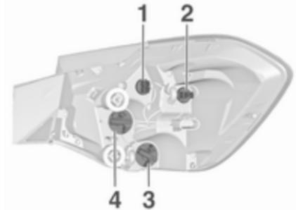
6. Die Lampenfassung durch Drehen gegen den Uhrzeigersinn ausbauen und die Lampe ersetzen. Hierzu die Lampe herausziehen oder leicht in die Fassung drücken und gegen den Uhrzeigersinn drehen:
