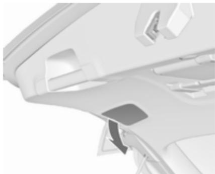
Die Nebelscheinwerfer bzw. das Rückfahrlicht (2) (je nach Seite) können über eine Abdeckung in der Hecktür ersetzt werden, ohne den Leuchtensammenbau auszubauen: Hierzu die Abdeckung abnehmen, die Lampenfassung drehen und die Lampe durch gegen den Uhrzeigersinn ersetzen.
