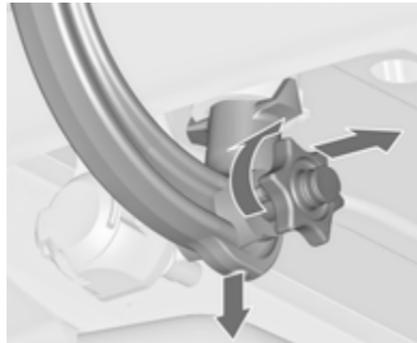
Die Schutzklappe öffnen und zum Entriegeln der Kugelstange den Schlüssel in Position
