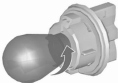
3. Lampe durch Drehen gegen den Uhrzeigersinn aus der Lampenfassung nehmen.
