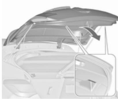
Einen der Innengriffe verwenden. Während die Hecktür zugeklappt wird, weder den Touchpad-Schalter noch das Emblem drücken, da sonst die Hecktür erneut entriegelt wird. Zentralverriegelung
