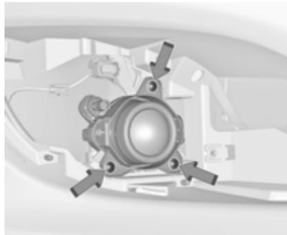
3. Die drei Schrauben ausdrehen und den Nebelscheinwerferzusammenbau vom Stoßfänger abnehmen.
