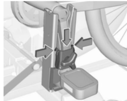
Tretkurbelfixierung von oben in die jeweils äußere Schiene der Tretkurbelaufnahme einführen und mindestens bis unter die Einkerbung nach unten schieben.
