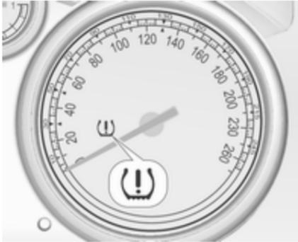
Wenn niedriger Reifendruck erkannt wird, wird dies durch die Kontrollleuchte
