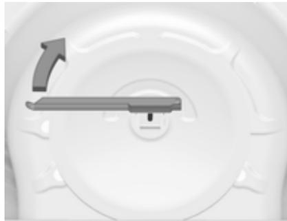
2. Nur Sports Tourer und Stufenheck, 4-türig, mit Not-Reserverad: Den Verlängerungsbolzen unter Verwendung des Sechskantschlüssels des Radschlüssels durch den kurzen Bolzen ersetzen.
