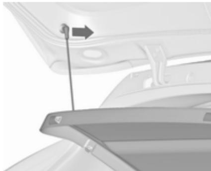
Befestigungsurte von Hecktür lösen.
