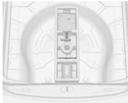
Bei Ausführungen mit dem Heckträgersystem ⇨ 67 sind das Reifenreparaturset, ein Schraubendreher und die Abschleppöse im Schubfach unter dem Beifahrersitz verstaut ⇨ 65.
