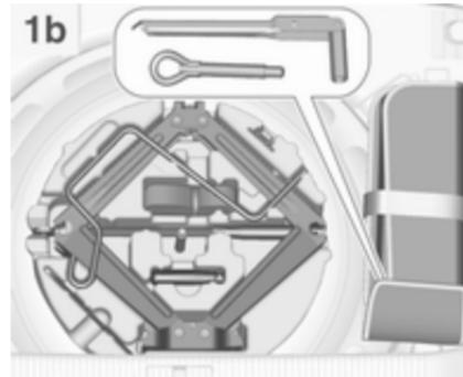
Gleicher Inhalt wie Variante 1a, jedoch mit einem klappbarem anstelle des festen Radschlüssels im Wagenwerkzeug.
