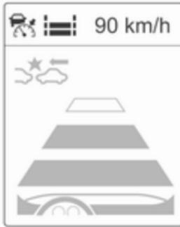
Der ausgewählte Sicherheitsabstand wird durch ausgefüllte Abstandsbalken auf der Seite des adaptiven Geschwindigkeitsreglers angezeigt.
