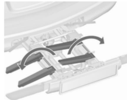
Beide Radaufnahmen ausklappen.
