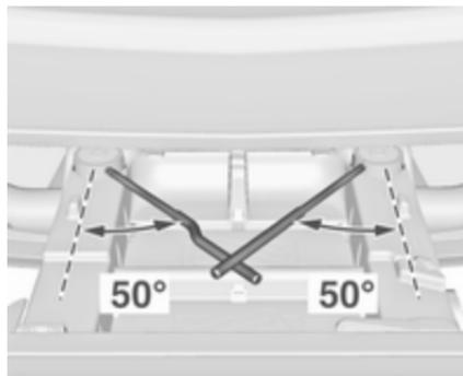
Das Heckträgersystem ist verriegelt, wenn die Spannhebel zu etwa 50° eingeschwenkt sind. Nur dann ist eine sichere Funktion gewährleistet.
