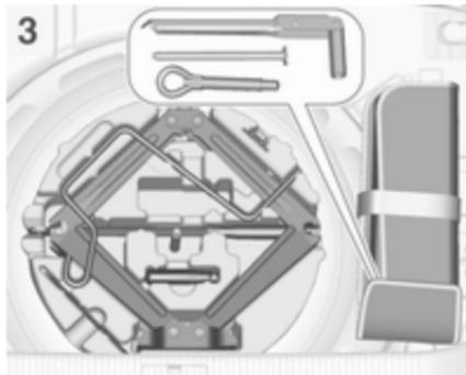
Der Wagenheber und das Wagenwerkzeug befinden sich im Werkzeugkasten unter dem Reserverad im Laderaum. Der Radschlüssel, die Abschleppöse und der Verlängerungsbolzen zum Befestigen eines beschädigten Rads (nur Fahrzeuge mit Not-Reserverad) befinden sich in der Werkzeugtasche, die in der Nähe des Werkzeugkastens in der Reserveradaufnahme verstaut ist. Reserverad ⇨ 290.
