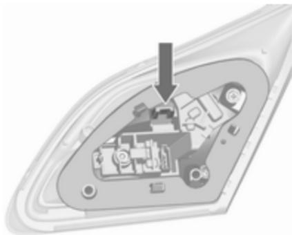
4. Auf die Haltenase drücken und die Lampenfassung aus dem Leuchtzusammenbau herausnehmen.
