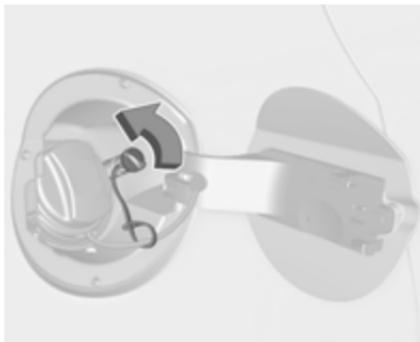
Die Schutzkappe vom Einfüllstutzen abschrauben.
