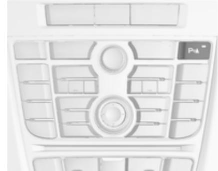
Die Front-Heck-Einparkhilfe wird mit **P** mit einem Dreieckssymbol betätigt. Wenn das Fahrzeug zusätzlich mit der erweiterten Einparkhilfe ausgestattet ist (siehe nachfolgende Beschreibung), enthält das System **P** mit einem Dreieckssymbol und einem Pluszeichen. Beide Systeme werden durch **P** mit einem Dreieckssymbol betrieben.
