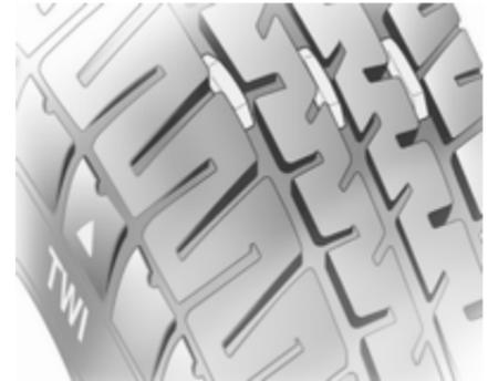
Die gesetzlich zulässige Mindestprofiltiefe (1,6 mm) ist erreicht, wenn das Profil bis zu einem der Verschleißanzeiger (TWI = Tread Wear Indicator)
