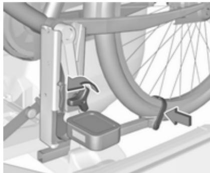
Spannbänder an beiden Fahrradreifen lösen.
