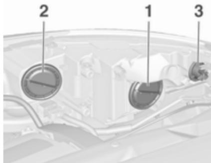
Halogen-Scheinwerfer mit separaten Lampen für Ablend- und Fernlicht.
