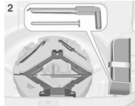
Der Wagenheber, das Wagenwerkzeug und die Abschleppöse befinden sich im Werkzeugkasten unter dem Reserverad im Laderaum. Der Radschlüssel und der Verlängerungsbolzen zum Befestigen eines beschädigten Rads (nur Fahrzeuge mit Not-Reserverad) befinden sich in der Werkzeugtasche, die in der Nähe des Werkzeugkastens in der Reserveradaufnahme verstaut ist. Reserverad ↪ 290.
