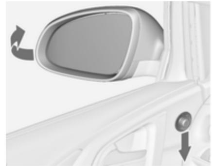
Bedienelement auf **0** drehen und dann hinunterdrücken. Beide Außenspiegel werden eingeklappt.
