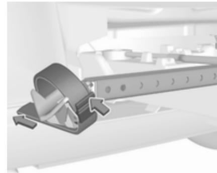
Das Spannband einführen und so weit wie möglich nach unten festziehen.
