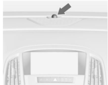
Die Status-LED ist in den Sensor oben auf der Instrumententafel integriert.
