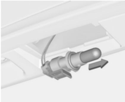
3. Die Lampenfassung linksherum drehen, um sie aus dem Lampengehäuse zu entfernen.
