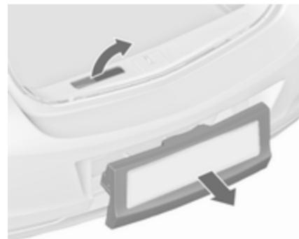
Den Entriegelungshebel nach oben ziehen. Das System rastet aus und fährt schnell aus dem Stoßfänger.
