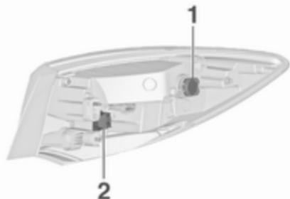
5. Die Lampenfassung durch Drehen ausbauen und die Lampe ersetzen. Hierzu die Lampe herausziehen oder leicht in die Fassung drücken und gegen den Uhrzeigersinn drehen:
