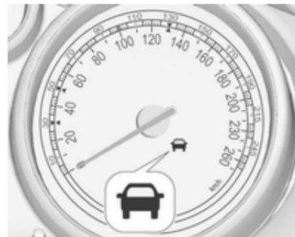
Ein vorausfahrendes Fahrzeug wird durch die Kontrollleuchte
