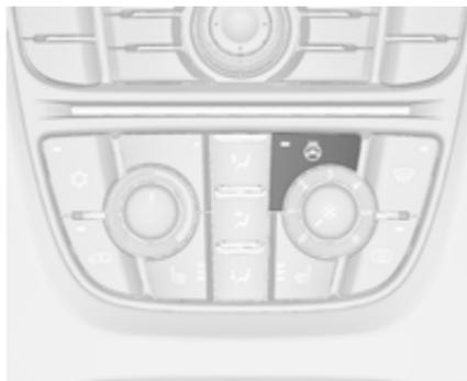
Die Heizung durch Drücken von
