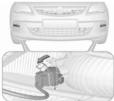
1. Die Federklammer lösen und nach hinten schwenken.
