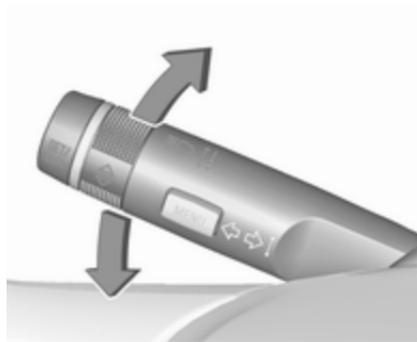
Hebel nach oben : Blinker rechts
