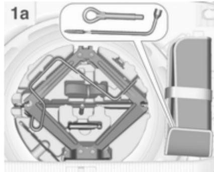
Wagenheber, Wagenwerkzeug und ein Gurt zur Befestigung eines beschädigten Rades befinden sich im Werkzeugkasten unter dem Reserverad im Laderaum. Der Radschlüssel und die Abschleppöse befinden sich in der Werkzeugtasche, die in der Nähe des Werkzeugkastens in der Reserveradaufnahme verstaut ist. Reserverad ↪ 290.
