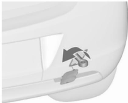
Abschleppöse bis zum Anschlag in waagrechtener Stellung einschrauben.
