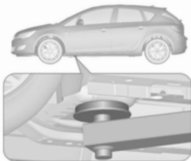
Position des vorderen Hebebühnenarms am Unterboden.
