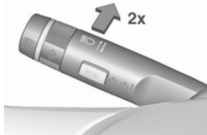
Der Fernlichtassistent wird aktiviert, wenn bei einer Geschwindigkeit über 40 km/h zweimal der Blinkerhebel gedrückt wird.
