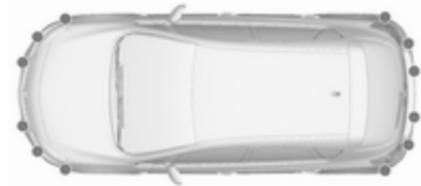
Die erweiterte Einparkhilfe führt den Fahrer durch Anweisungen im DIC und akustische Signale in eine Parklücke. Der Fahrer muss selbst beschleunigen, bremsen, lenken und schalten.
