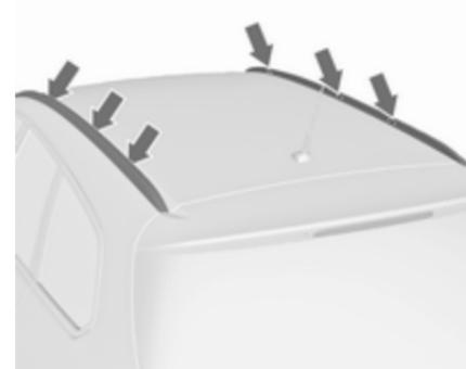
Den Dachgepäckträger im Bereich der Löcher, die in der Abbildung mit Pfeilen gekennzeichnet sind, befestigen.
