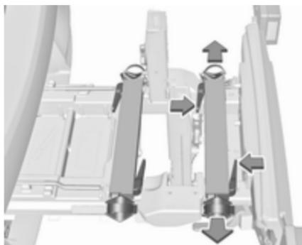
Den Entriegelungshebel drücken und die Radaufnahmen herausziehen.
