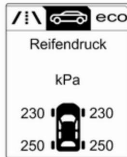
Reifendruck-Kontrollsystem durch Drehen des Einstellrädchens wählen.
