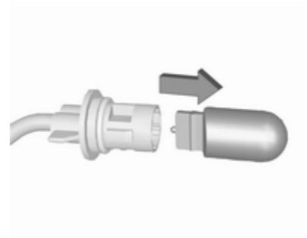
3. Die Lampe aus der Fassung ziehen und ersetzen.
