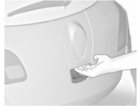
Nach dem Entriegeln den Touchpad-Schalter unter dem Markenemblem betätigen und die Hecktür öffnen.
