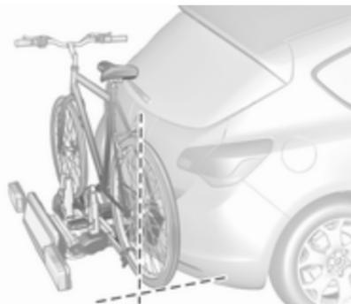
Das Fahrrad in Fahrzeuginnenrichtung ausrichten: Die Tretlagerfixierung etwas lösen.
