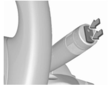
Zur Betätigung des Heckscheibenwischer Wippschalter drücken:
