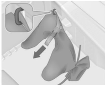
Der Beutel mit der Kugelstange ist im hinteren Staufach auf dem Boden verstaut.
