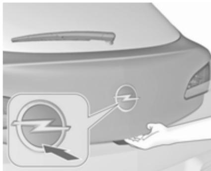
Zum Entriegeln und Öffnen der Heckklappe
