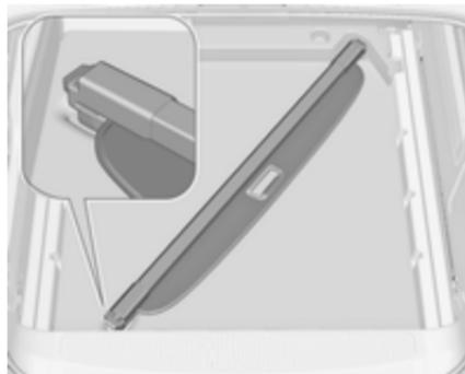
Die abgenommene Abdeckung kann wie in der Abbildung gezeigt unter der Bodenabdeckung verstaut werden.
