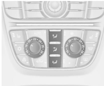
Entsprechende Taste für die gewünschte Einstellung drücken. Die Aktivierung wird durch das Leuchten der LED auf der Taste angezeigt.
