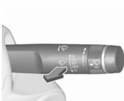
Hebel ziehen. Waschflüssigkeit spritzt auf die Windschutzscheibe und der Wischer wird für einige Wischbewegungen eingeschaltet.
