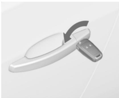
Fahrtür durch Drehen des Schlüssels im Schloss manuell entriegeln. Zündung einschalten und Zentralverriegelungstaste
