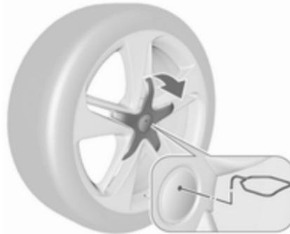
Leichtmetallräder mit Radzierkappen in der Mitte: Radzierkappe lösen. Dazu Abzieher in die Aussparung des Markenemblems stecken und daran ziehen. Wagenwerkzeug ⇨ 274.
