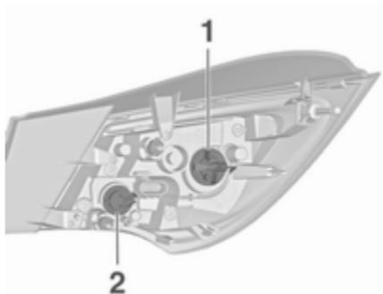
5. Die Lampenfassung durch Drehen ausbauen und die Lampe ersetzen. Hierzu die Lampe herausziehen oder leicht in die Fassung drücken und gegen den Uhrzeigersinn drehen:
