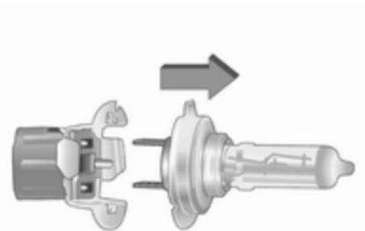
3. Die Lampe aus der Lampenfassung lösen und ersetzen.
