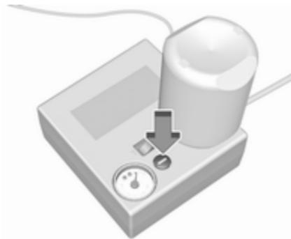
Wird der vorgeschriebene Reifendruck nicht innerhalb von 10 Minuten erreicht, Reifenreparaturset entfernen. Das Fahrzeug um eine Reifenumdrehung bewegen. Das Reifenreparaturset wieder anschließen und Füllvorgang für 10 Minuten fortsetzen. Wird der vorgeschriebene Reifendruck danach immer noch nicht erreicht, ist der Reifen zu stark beschädigt. Hilfe einer Werkstatt in Anspruch nehmen.
