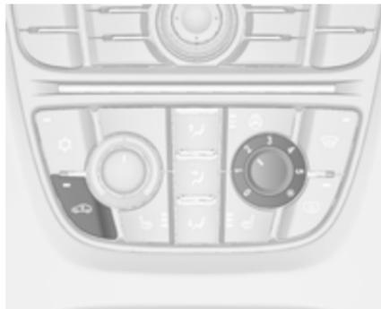
Zum Einschalten des Umluftbetriebs
