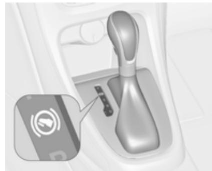
Bei nicht betätigtem Bremspedal leuchtet die Kontrollleuchte (☹) auf. Wenn der Wählhebel bei Ausschalten der Zündung nicht in Stellung **P** ist, blinken die Kontrollleuchten (☹) und **P**.
