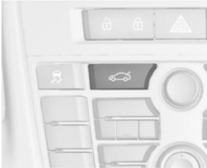
Wenn die Türen über die Zentralverriegelung verriegelt sind, kann der Kofferraumdeckel nicht durch Drücken auf
