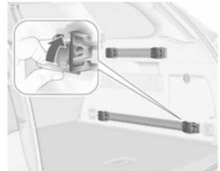
Die Griffplatte aufklappen, den Adapter in die obere und untere Nut der Schiene einsetzen und in die gewünschte Position bringen. Die Griffplatte zum Arretieren des Adapters nach oben schwenken. Zum Ausbau die Griffplatte nach unten drehen und aus der Schiene nehmen.
