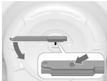
1. Den Sechskantschlüssel des Radschlüssels ansetzen und sichergehen, dass er fest auf der Schraube sitzt.
