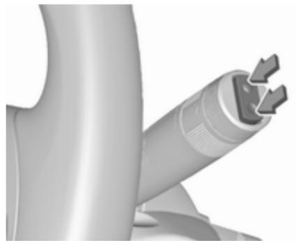
Zur Betätigung des Heckscheibenwischers Wippschalter drücken:
