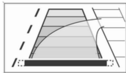
Die Fahrzeugspur wird entsprechend des Lenkwinkels angezeigt.
