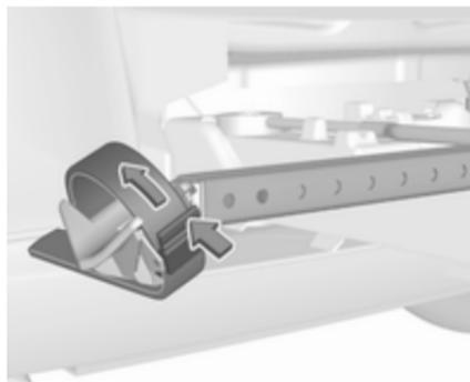
Den Entriegelungshebel am Spannbänder drücken und das Spannbänder herausziehen.
