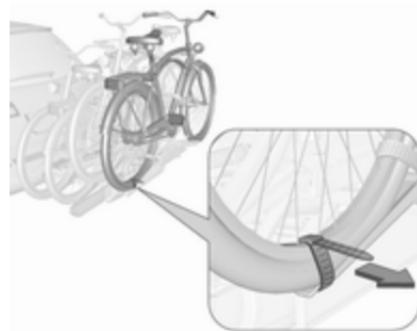
6. Beide Reifen des vierten Fahrrads mit Spannbändern zusätzlich an den Radaufnahmen sichern.
