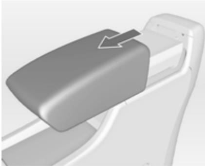
Die Armlehne kann um 10 cm nach vorn verschoben werden. Unter der Armlehne befindet sich ein Staufach. Armlehnenfach ↗ 65.
