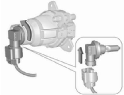
4. Die Lampenfassung linksherum drehen und aus dem Reflektor herausnehmen.
