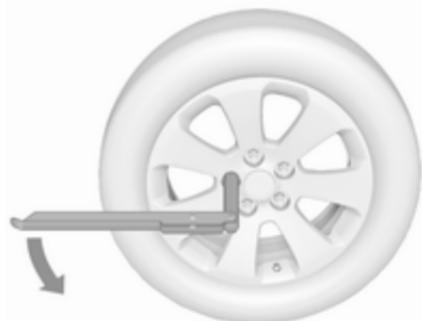
Radschraubenschlüssel herausklappen und sicherstellen, dass er gut sitzt. Jede Radmutter um eine halbe Drehung lösen.
