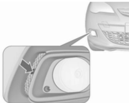
1. Mit einem Schraubendreher in die Aussparung fahren, Abdeckung lösen und abnehmen.
