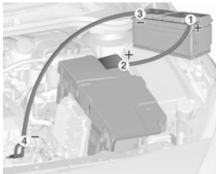
Reihenfolge für das Anschließen der Kabel:
