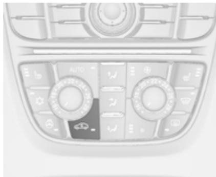
Zum Einschalten des Umluftbetriebs
