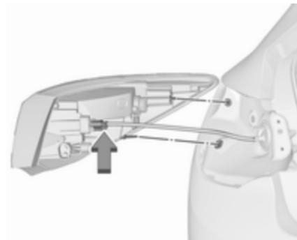
3. Rückleuchtenzusammenbau vorsichtig aus der Aussparung nehmen und entfernen. Darauf achten, dass der Kabelkanal nicht verschoben wird.
