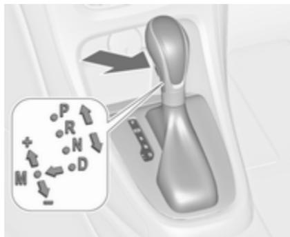
**P** : Parkstellung, Freigabetaste drücken, Räder sind blockiert; nur bei stillstehendem Fahrzeug und betätigter Parkbremse einlegen
