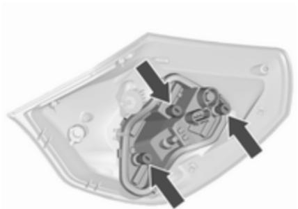
6. Die drei Schrauben mit einem Schraubendreher lösen und die Lampenfassung vom Leuchtenzusammenbau abnehmen.
