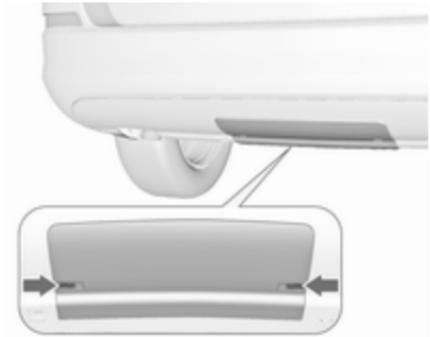
Alle Ausführungen außer Schrägheck, 3-türig: Befestigungen nach innen drücken und Abdeckung vorne nach unten klappen. Abdeckung abnehmen.
