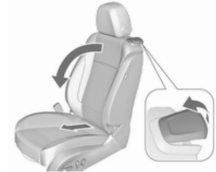
Entriegelungshebel anheben und Sitzlehne nach vorn klappen. Der Sitz wird automatisch bis zum Anschlag nach vorne verschoben.
