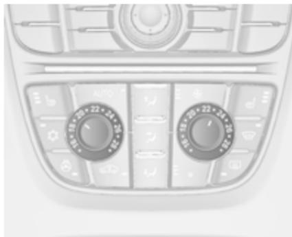
Ist die Mindesttemperatur **Lo** eingestellt, läuft die Klimaanlage mit maximaler Kühlung, sofern die Kühlung ☀ eingeschaltet ist.
