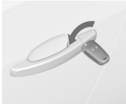
Fahrtür durch Drehen des Schlüssels im Schloss manuell entriegeln. Zündung einschalten und Zentralverriegelungstaste
