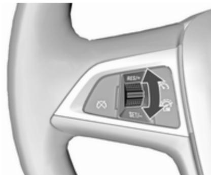
Bei aktiviertem Geschwindigkeitsbegrenzer das Daumenrad auf Position **RES/+** gedreht halten oder wiederholt auf Position **RES/+** drehen, bis die gewünschte Höchstgeschwindigkeit im Fahrerinformationszentrum angezeigt wird.
