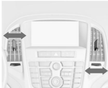
Zum Öffnen der Düse das Einstellrädchen zum größeren Symbol **■** drehen. Durch Drehen am Einstellrad die Luftmenge an der Düse einstellen.
