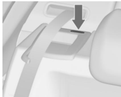
Die Rückenlehnen sind korrekt eingearastet, wenn die roten Markierungen auf beiden Seiten neben dem Entriegelungsgriff nicht mehr sichtbar sind.
