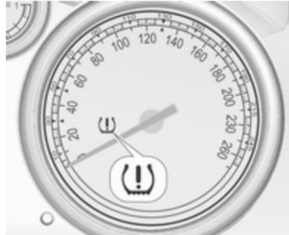
Wenn niedriger Reifendruck erkannt wird, wird dies durch das Aufleuchten der Kontrollleuchte
