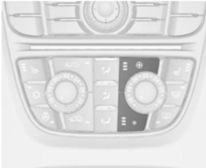
Mit der unteren Taste wird die Gebläsedrehzahl verringert und mit der oberen Taste erhöht. Die Gebläsegeschwindigkeit ist anhand der Anzahl der Segmente auf dem Display erkennbar.
