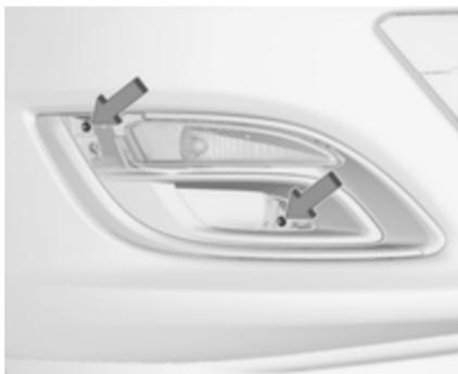
2. Beide Schrauben ausdrehen und den Leuchtensammelnut und den Leuchtensammelnut vom Stoßfänger abnehmen.
