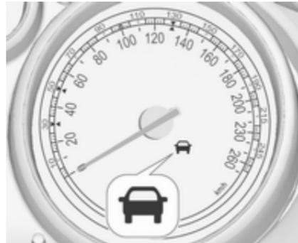
Wenn das System ein vorausfahrendes Fahrzeug in der Fahrspur erkannt hat, leuchtet die Kontrollleuchte für ein erkanntes vorausfahrendes Fahrzeug
