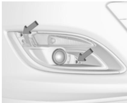
2. Beide Schrauben ausdrehen und den Blinkerleuchtenzusammenbau vom Stoßfänger abnehmen.
