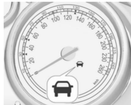
Ein vorausfahrendes Fahrzeug wird durch die Kontrollleuchte
