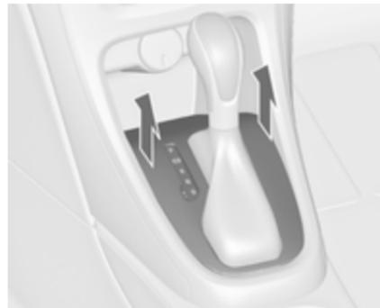
2. Die Wählhebelverkleidung vorn von der Mittelkonsole lösen, nach oben klappen und linksherum drehen.
