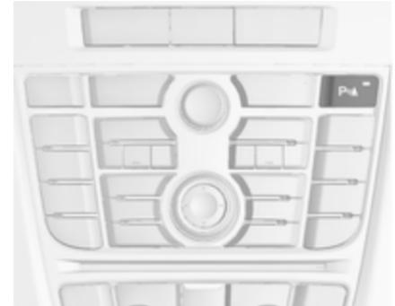
Die Front-Heck-Einparkhilfe wird mit **P** mit einem Dreieckssymbol betätigt. Wenn das Fahrzeug zusätzlich mit der erweiterten Einparkhilfe ausgestattet ist (siehe nachfolgende Beschreibung), enthält das System **P** mit einem Dreieckssymbol. Beide Systeme werden durch Drücken von **P** mit einem Dreieckssymbol betrieben.
