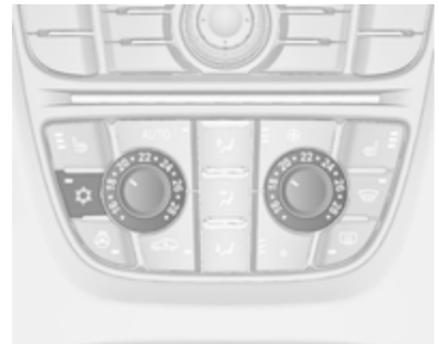
☼ drücken, um die Kühlung einzuschalten. Die LED in der Taste leuchtet auf, um die Aktivierung anzuzeigen. Die Kühlung ist nur bei laufendem Motor und eingeschaltetem Gebläse der Klimatisierung funktionsfähig.
