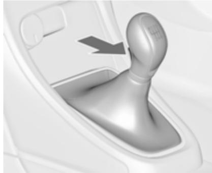
Zum Einlegen des Rückwärtsgangs bei stehendem Fahrzeug das Kupplungspedal treten, den Entriegelungsknopf am Wählhebel drücken und Gang einlegen.
