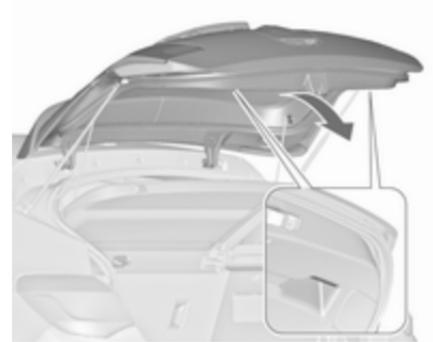
Einen der Innengriffe verwenden. Während die Hecktür zugeklappt wird, nicht auf den Touchpad-Schalter oder das Markenzeichen drücken, da sonst die Hecktür wieder entriegelt wird.
