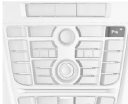
Nach Herausnehmen des Rückwärtsgangs wird das System automatisch ausgeschaltet.
