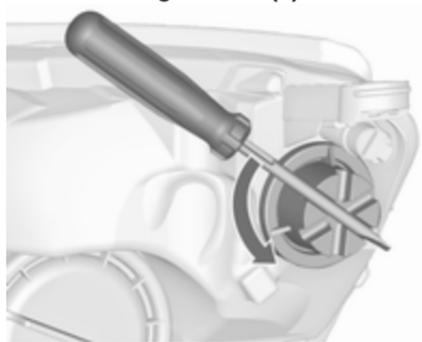
1. Die Kappe (3) linksherum drehen und abnehmen. Den Schraubendreher zum Drehen der Kappe verwenden.
