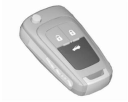
🚗 auf der Fernbedienung mindestens zwei Sekunden gedrückt halten; der Kofferraumdeckel öffnet sich leicht.
