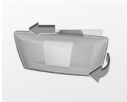
1. Lampe nach links schieben und am rechten Ende entfernen.
