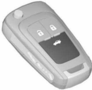
Durch Drücken auf
