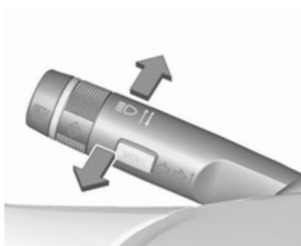
Zum Umschalten von Abblendlicht auf Fernlicht Hebel nach vorne drücken.
