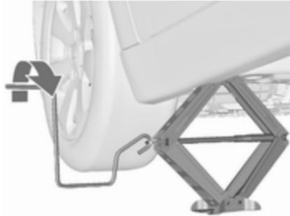
Wagenhebergriff anbringen und bei korrekt ausgerichtetem Wagenheber am Griff drehen, bis das Rad nicht mehr den Boden berührt.
