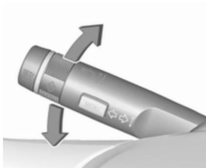
Hebel nach oben : Blinker rechts
