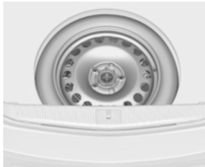
Das Reserverad befindet sich im Laderaum unter der Abdeckung des Laderaumbodens. Es ist mit einer Flügelmutter befestigt.
