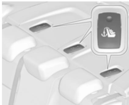
Beim Stufenheck im Bereich hinter den Kopfstützen die Klappe der gewünschten Befestigungsöse öffnen. Die Klappe ist mit dem Symbol eines Kindersitzes versehen.
