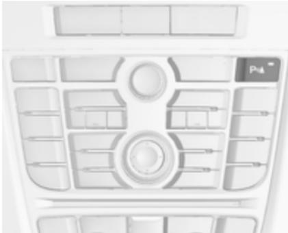
Durch kurzes Drücken auf **P** mit einem Dreieckssymbol oder **P** mit einem Dreieckssymbol und einem A kann die Funktion manuell deaktiviert werden.
