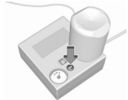
Wird der vorgeschriebene Reifendruck nicht innerhalb von zehn Minuten erreicht, das Reifenreparaturset entfernen. Das Fahrzeug um eine Reifenumdrehung bewegen. Das Reifenreparaturset wieder anbringen und den Füllvorgang 10 Minuten fortsetzen. Wird der vorgeschriebene Reifendruck danach immer noch nicht erreicht, ist der Reifen zu stark beschädigt. Hilfe einer Werkstatt in Anspruch nehmen.
