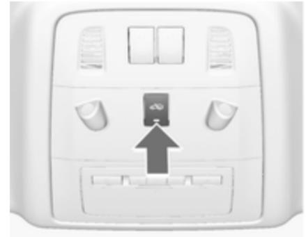
Die Überwachung der Fahrgastzelle und der Fahrzeugneigung abschalten, wenn Haustiere im Fahrzeug zurückbleiben, da der Alarm durch laute Ultraschallsignale oder Bewegungen ausgelöst werden kann. Auch ausschalten, wenn das Fahrzeug auf einer Fähre oder einem Zug transportiert wird.
