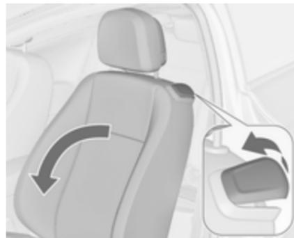
Entriegelungshebel anheben und Rückenlehne vorklappen, danach Sitz bis zum Anschlag nach vorne schieben.
