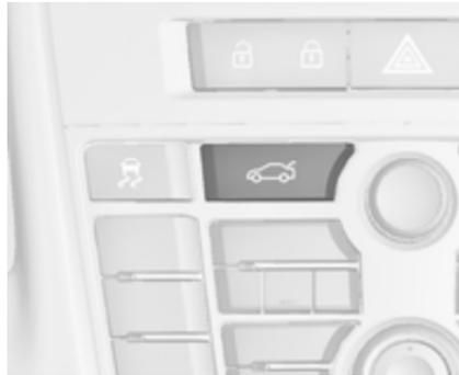
Wenn die Türen über die Zentralverriegelung verriegelt sind, kann der Kofferraumdeckel nicht durch Drücken auf
