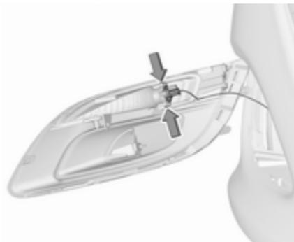
3. Die Lampenfassung durch Drücken der beiden Haltenasen vom Reflektorgehäuse lösen.
