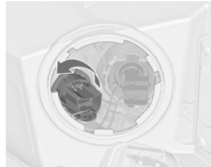
2. Lampenfassung linksherum drehen, um sie auszurasen und aus dem Reflektorgehäuse zu entnehmen.
