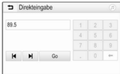
Geben Sie die gewünschte Frequenz ein. Mit ← können Sie die eingegebenen Ziffern löschen. Über ◀ oder ▶ können Sie falls nötig einzelne Ziffern ändern.
