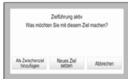
**Als Zwischenziel hinzufügen** wählen. Die Route wird neu berechnet und das neue Ziel wird als Wegpunkt zur aktuellen Route hinzugefügt.
