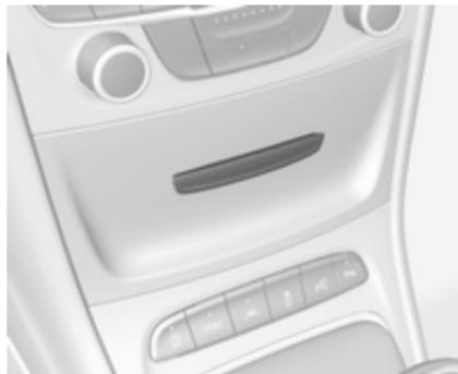
Der Telefonhalter ist mit einer elektrischen Steckleiste (PowerFlex Buchse) verbunden.
