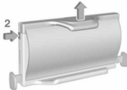
2. Drücken Sie auf die Taste (2) links oben, um den Schieber für die Höhenverstellung zu lösen.
