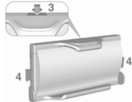
1. Drücken Sie auf die Entriegelungstaste (3), um die Verriegelungen (4) zu lösen.
