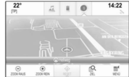
Die aktuelle Position wird durch einen Kreis mit einem in Fahrtrichtung zeigenden Pfeil angegeben.
