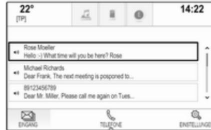
Wenn Sie eine neue Textnachricht empfangen, wird eine Meldung angezeigt. Eine der Schaltflächen wählen, um die Anwendung **SMS** zu öffnen.
