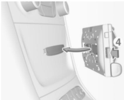
2. Setzen Sie den Telefonhalter an die elektrische Steckleiste an und drücken Sie auf beide Verriegelungen (4), bis sie einrasten.
