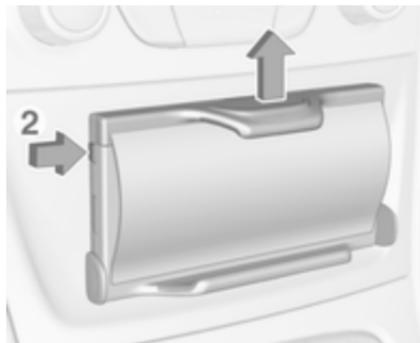
1. Drücken Sie auf die Taste (2), um den Schieber zu lösen.
