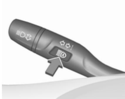
Den Fernlichtassistenten durch einmaliges Drücken auf
