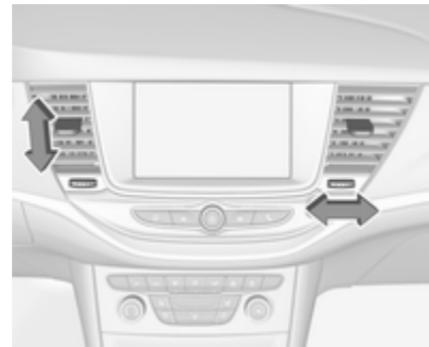
Zum Öffnen der Düse das Einstellrädchen zum größeren Symbol
