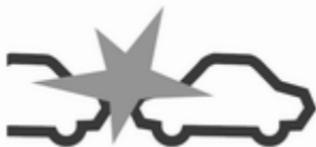
Wenn die Zeit für einen potentiellen Aufprall auf ein vorausfahrendes Fahrzeug zu kurz ist und eine Kollision droht, wird das Aufprallwarnsymbol im Driver Information Center eingeblendet und der Fahrer anhand eines rot blinkenden LED-Streifens gewarnt, der im Sichtfeld des Fahrers auf die Windschutzscheibe projiziert wird.
