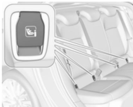
Für das Fahrzeug zugelassene ISOFIX Kindersicherheitsysteme an den ISOFIX-Befestigungshalterungen befestigen. Die speziellen Positionen für ISOFIX Kindersicherheitsysteme sind aus der ISOFIX-Tabelle ersichtlich ⇨ 69.
