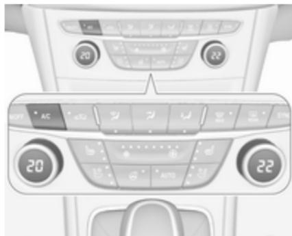
**A/C** drücken, um die Kühlung einzuschalten. Die LED in der Taste leuchtet auf, um die Aktivierung anzuzeigen. Die Kühlung ist nur bei laufendem Motor und eingeschaltetem Gebläse der Klimatisierung funktionsfähig.
