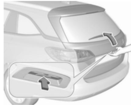
Nach dem Entriegeln den Touchpad-Schalter unter der Hecktürliste drücken und die Hecktür manuell öffnen.
