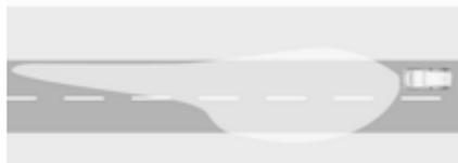
Wird beim Fahren in ländlichen Gebieten automatisch bei Geschwindigkeiten über ca. 55 km/h aktiviert. Die aktuell befahrene Straße und deren Rand werden besser ausgeleuchtet. Entgegenkommende und vorausfahrende Fahrzeuge werden nicht geblendet.
