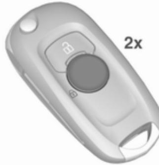
☰ auf der Funkfernbedienung zweimal innerhalb von fünf Sekunden drücken.
