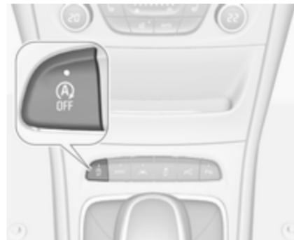
Deaktivieren Sie das Stopp-Start-System manuell durch Drücken auf **A OFF**. Die Deaktivierung wird angezeigt, wenn die LED in der Taste leuchtet.
