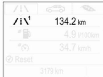
/i\1 durch Drücken auf **Menu** am Blinkerhebel auswählen. Das Einstellrädchen am Blinkerhebel drehen und /i\1 oder /i\2 auswählen. Jede Tageskilometerzählerseite kann separat zurückgesetzt werden, indem während der Anzeige des entsprechenden Menüs einige Sekunden lang **SET/CLR** am Blinkerhebel gedrückt wird.
