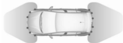
Die erweiterte Einparkhilfe ist immer mit der Front-Heck-Einparkhilfe kombiniert. Beide Systeme nutzen dieselben Sensoren im vorderen und hinteren Stoßfänger.
