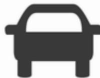
Die grüne Kontrollleuchte („Fahrzeug voraus“) wird angezeigt, wenn das System ein Fahrzeug in der Fahrspur erkennt, das sich in einer Entfernung von bis zu ca. 150 Meter befindet.
