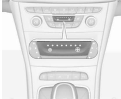
Linke Taste zum Herabsetzen oder rechte Taste zum Erhöhen der Gebläsegeschwindigkeit drücken. Die Gebläsegeschwindigkeit wird durch die Anzahl der LED in der Taste angezeigt.
