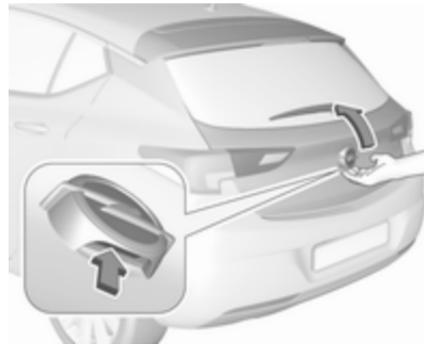
Nach dem Entriegeln den Touchpad-Schalter unter dem Markenemblem betätigen und die Hecktür öffnen.
