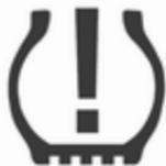
Wenn niedriger Reifendruck erkannt wird, wird dies durch die Kontrollleuchte (⚠) gemeldet ⇨ 114.
