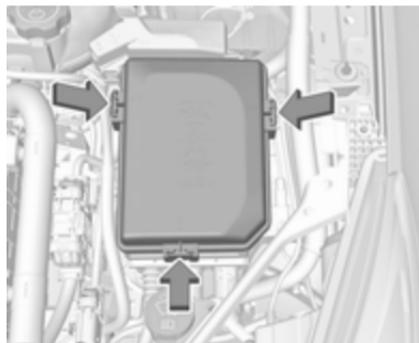
Der Sicherungskasten befindet sich im vorderen linken Bereich des Motorraums.
