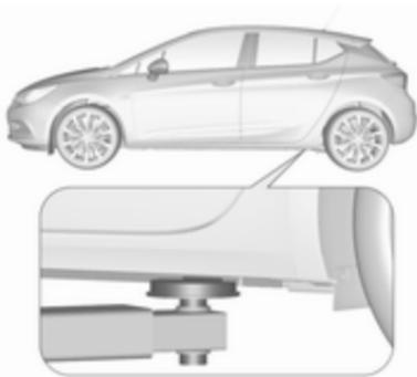
Position des hinteren Arms der Hebebühne unter der hinteren Aussparung im Schweller.
