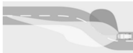
Je nach Lenkwinkel und Geschwindigkeit werden spezielle LED zusätzlich eingeschaltet, um in Kurven das Scheinwerferlicht zu verbessern. Diese Funktion wird bei Geschwindigkeiten zwischen 40 und 70 km/h aktiviert und reagiert auf den Lenkwinkel.
