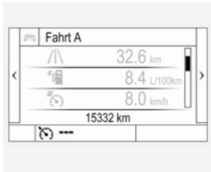
Die erfasste Gesamtfahrstrecke wird in km angezeigt.
