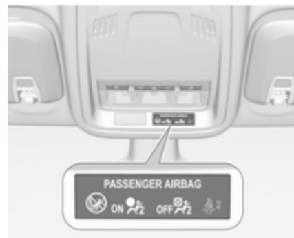
Wenn die Kontrollleuchte
