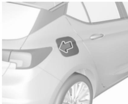
Die Tankklappe lässt sich nur bei entriegeltem Fahrzeug öffnen. Tankklappe durch Drücken der Klappe lösen.
