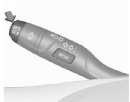
Drücken Sie zum Bestätigen einer Meldung im Midlevel-Display auf **SET/CLR** am Blinkerhebel.
