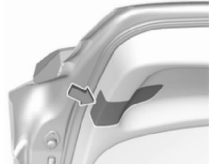
1. Die Abdeckung an der Hecktür lösen und abnehmen.
