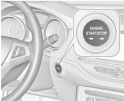
Schaltgetriebe: Kupplung und Bremspedal betätigen.
