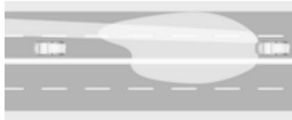
Der Fernlichtassistent beinhaltet einen speziellen Autobahnmodus. Wird auf Autobahnen schneller als 115 km/h gefahren, verkleinert sich der Lichtstrahl, damit der entgegenkommende Verkehr nicht geblendet wird. Beim Fahren hinter Fahrzeugen bzw. Überholen wird die Spiegelblendwirkung in diesen Fahrzeugen verringert.
