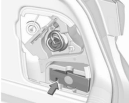
Beim 5-türigen Schrägheck befindet sich das Reifenreparaturset auf der rechten Seite im Laderaum hinter einer Abdeckung.
