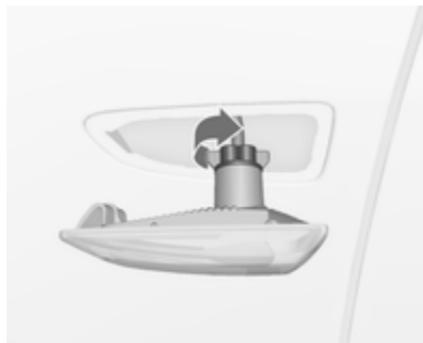
2. Lampenfassung linksherum drehen, um sie aus dem Gehäuse zu entfernen.
