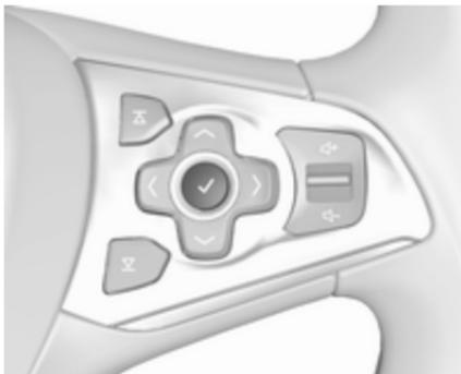
Drücken Sie zum Bestätigen einer Meldung im Uplevel-Display auf ✓ am Lenkrad.
