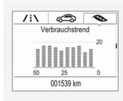
Zeigt die Entwicklung des Durchschnittsverbrauchs über eine Entfernung von 50 km an. Gefüllte Segmente zeigen den Kraftstoffverbrauch in 5-km-Schritten und den Einfluss von Gelände und Fahrverhalten auf den Kraftstoffverbrauch.
