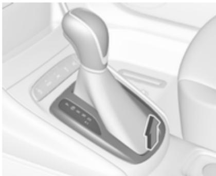
2. Lösen Sie die Wählhebel-Verkleidung von der Mittelkonsole. Stecken Sie einen Finger in die Ledermanschette unter dem Wählhebel und drücken Sie die Verkleidung nach oben. Die Verkleidung linksherum drehen.
