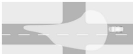
Wird automatisch bei Geschwindigkeiten bis ca. 55 km/h und in Situationen mit Außenumgebungslicht aktiviert. Das Licht ist weit und symmetrisch. Eine spezielle Lichtverteilung sorgt dafür, dass andere Straßenbenutzer nicht geblendet werden.
