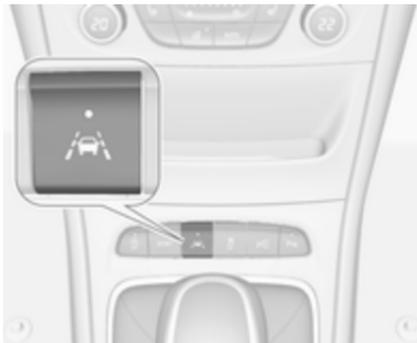
Der Spurhalteassistent wird durch Drücken auf
