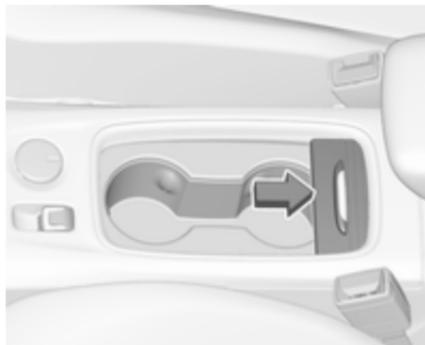
Je nach Version befinden sich Getränkehalter unter einer Abdeckung in der Mittelkonsole. Abdeckung nach hinten schieben.
