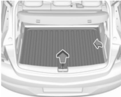
Die Kofferraumbodenabdeckung kann entfernt werden. Die Abdeckung hinten anheben und vor dem Entfernen auf einer Seite leicht drehen.
