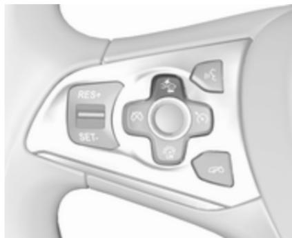
Beim ersten Drücken der Taste wird die aktuelle Einstellung im Driver Information Center angezeigt. Durch erneutes Drücken der Taste wird die Einstellung geändert. Die ausgewählte Einstellung bleibt aktiv, bis sie erneut geändert wird. Der Zeitpunkt
