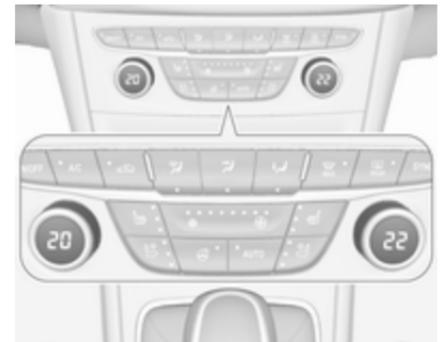
Temperatur auf den gewünschten Wert einstellen. Über den Knopf auf der Beifahrerseite lässt sich die Temperatur für die Beifahrerseite ändern. Mit dem Knopf auf der Fahrerseite kann die Temperatur sowohl für die Fahrerseite als auch beide Seiten in Abhängigkeit von der Aktivierung der Synchronisation **SYNC** geändert werden.
