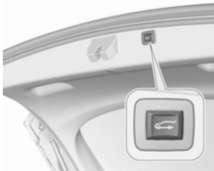
Zum Schließen auf
