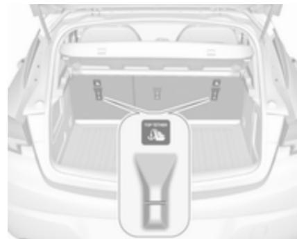
Zusätzlich zu den ISOFIX-Befestigungshalterungen den Top-Tether-Gurt an den Top-Tether Befestigungsösen befestigen. Der Gurt muss zwischen den beiden Führungsstangen der Kopfstütze verlaufen.
