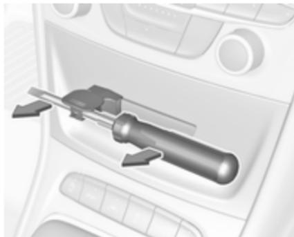
Drücken Sie den Schraubendreher durch die Aussparung im Adapter. Entfernen Sie den Deckel, indem Sie den Schraubendreher ziehen.
