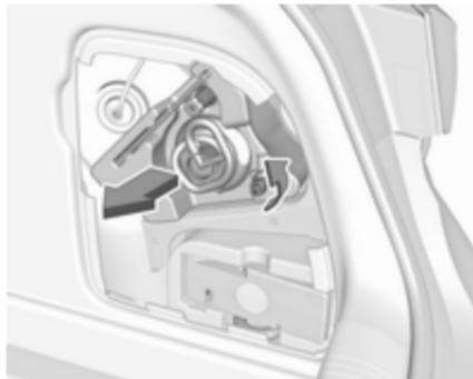
2. Fahrzeuge mit Reifenreparaturset: Zum Austauschen der Glühlampen auf der rechten Seite zuerst die Plastik-Mutter abschrauben und den Einsatz mit der Dichtmittel-Flasche herausnehmen.
