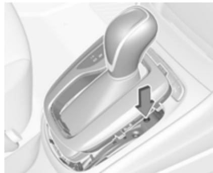
3. Setzen Sie einen kleinen Stab (z. B. Stift oder Schraubendreher) in die Öffnung neben dem Wählhebel ein. Drücken Sie den Stab senkrecht nach unten und schieben Sie den Wählhebel aus **P** heraus. Wenn diese Stellung wieder erreicht ist, wird der Wählhebel wieder arretiert. Ursache für die Stromunterbrechung von einer Werkstatt beheben lassen.
