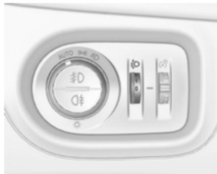
Zur Anpassung der Leuchtweite an die Fahrzeuglast, um Blendwirkung zu reduzieren: Daumenrädchen
