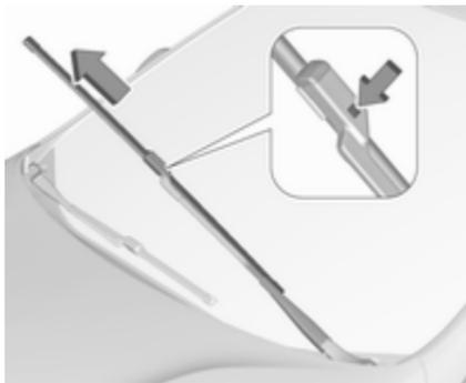
Wischarm anheben, bis er von selbst steht, Taste zum Lösen des Wischerblattes drücken und Wischerblatt abnehmen.
