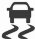
Die elektronische Stabilitätsregelung ist nach jedem Motorstart funktionsfähig, sobald die Kontrollleuchte
