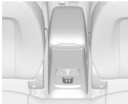
Zwei USB-Anschlüsse ausschließlich zum Laden von Geräten befinden sich an der Rückseite der Mittelkonsole.
