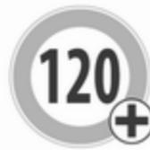
Zudem werden in der unteren Zeile des Driver Information Centers permanent die aktuell gültigen Geschwindigkeitsbegrenzungen angezeigt. Wenn eine Geschwindigkeitsbegrenzung mit zusätzlichem Verkehrsschild verfügbar ist, wird in diesem Bereich ein + Symbol angezeigt.
