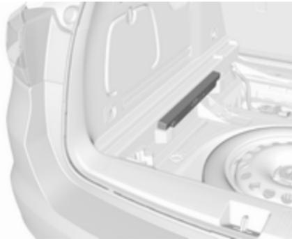
Das Warndreieck in der Aussparung unter der hinteren Bodenabdeckung auf der rechten oder linken Seite verstauen.
