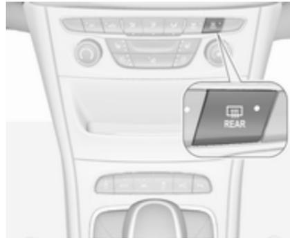
Die Heizung wird durch Drücken von
