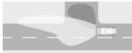
Beim Abbiegen werden je nach Lenkwinkel und Blinklicht spezielle LED eingeschaltet, um die Fahrtrichtung auszuleuchten. Er wird bei Geschwindigkeiten von bis zu 40 km/h aktiviert.
