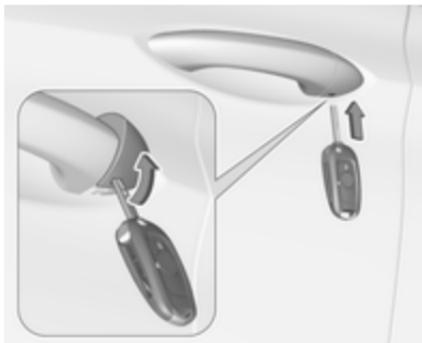
**Fernbedienung:** Zum Entfernen der Kappe den Schlüssel in die Aussparung am unteren Rand der Kappe stecken und den Schlüssel nach oben drücken.
