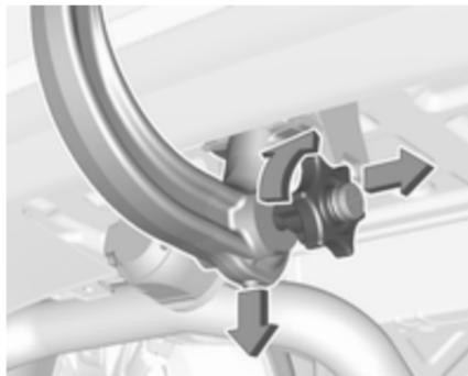
Die Schutzklappe öffnen und zum Entriegeln der Kugelstange den Schlüssel in Position
