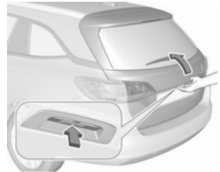
Zum Öffnen der Heckklappe den Touchpad-Schalter unter der Heckklappenleiste drücken, bis die Klappe geöffnet wird. Wenn das Fahrzeug
