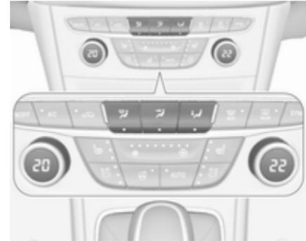
Drücken Sie die entsprechende Taste für die gewünschte Korrektur. Die LED in der Taste leuchtet auf, um die Aktivierung anzuzeigen.
