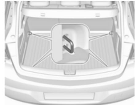
In Fahrzeugen mit Reserverad sind die vorderen Verzurrösen an den Seitenwänden angeordnet.
