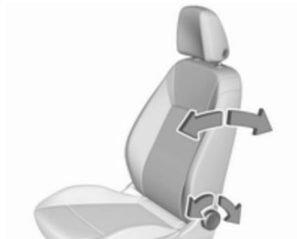
Handrad drehen. Zum Einstellen Rückenlehne entlasten.
