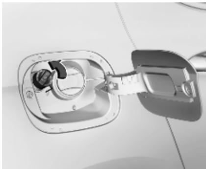
4. Die Schutzkappe vom Einfüllstutzen abschrauben.
