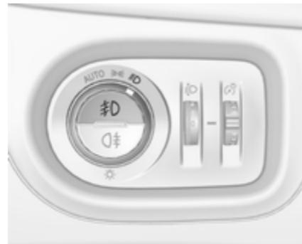
Wird durch Drücken von  $\text{D}$  bedient.
