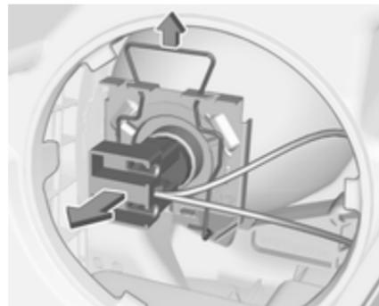
2. Den Federclip durch Ziehen aus der Halterung lösen. Die Lampenfassung aus dem Reflektorgehäuse ziehen.
