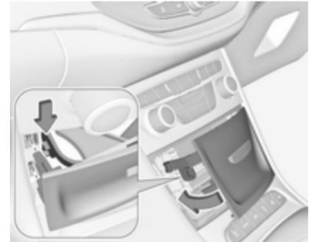
2. Die linke Seite des Deckels nach vorn klappen. Darauf achten, dass die Sicherungsklammer wie abgebildet angeordnet wird.
