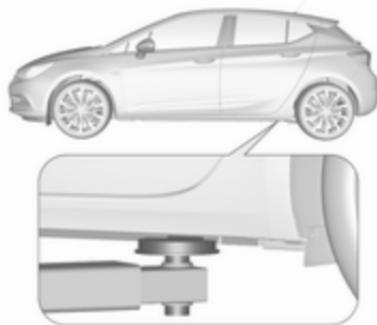
Position des hinteren Arms der Hebebühne mittig unter der hinteren Aussparung im Schweller.
