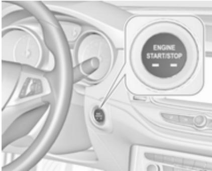
Schaltgetriebe: Kupplung und Bremspedal betätigen.
