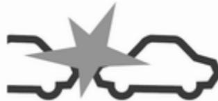
Wenn die Zeit für einen potentiellen Aufprall auf ein vorausfahrendes Fahrzeug zu kurz ist und eine Kollision droht, wird das Aufprallwarnsymbol im Driver Information Center eingblendet und der Fahrer anhand eines rot blinkenden LED-Streifens gewarnt, der im Sichtfeld des Fahrers auf die Windschutzscheibe projiziert wird.
