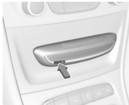
2. Zum Aktivieren bzw. Deaktivieren des Duftspenders die Taste an der Vorderseite drücken. Aktivierung wird durch LED angezeigt.
