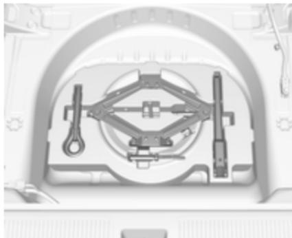
Der Wagenheber, die Abschleppöse und das Wagenwerkzeug befinden sich im Werkzeugkasten unter dem Reserverad. Reserverad ↗ 290.
