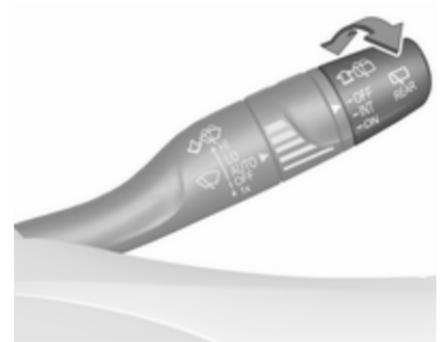
Zum Einschalten des Heckscheibenwischers die äußere Kappe drehen:
