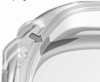
1. Die Abdeckung an der Hecktür lösen und abnehmen.
