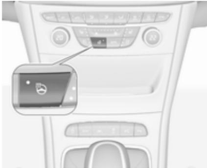
Die Heizung durch Drücken von
