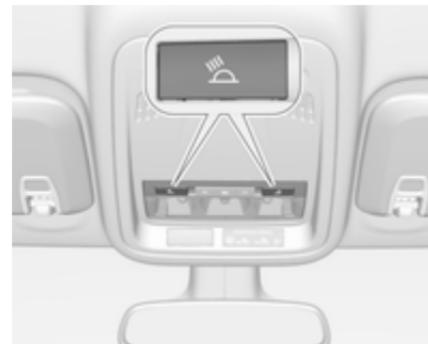
Wird durch Drücken von  $\Rightarrow$  und  $\Leftarrow$  in der Innenbeleuchtung bedient.
