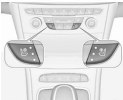
Je nach gewünschter Lüftungseinstellung
