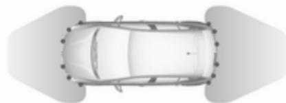
Die erweiterte Einparkhilfe ist immer mit der Front-Heck-Einparkhilfe kombiniert. Beide Systeme nutzen dieselben Sensoren im vorderen und hinteren Stoßfänger.
