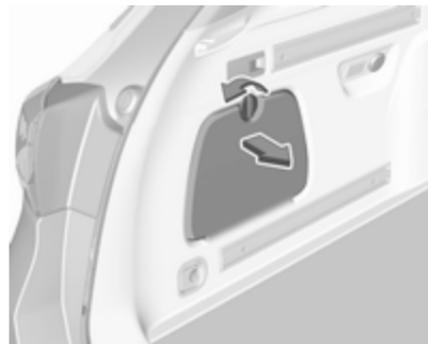
1. Die Abdeckung auf der entsprechenden Seite lösen und öffnen.
