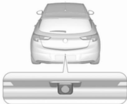
Am Schrägheck, 5-türig, ist die Kamera zwischen den Kennzeichenleuchten montiert.
