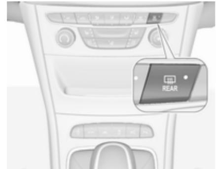
Wird durch Drücken von
