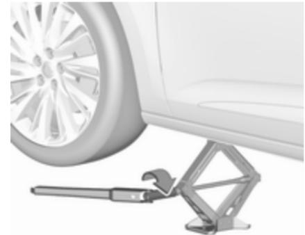
Radschlüssel ansetzen und den korrekt ausgerichteten Wagenheber hochkurbeln, bis das Rad vom Boden abhebt. Den Wagenheber nicht weiter anheben.
