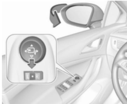
Steuerung auf ● stellen, dann die Steuerung ∇ nach unten drücken. Beide Außenspiegel werden eingeklappt.
