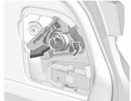
2. Fahrzeuge mit Reifenreparaturset: Zum Austauschen der Glühlampen auf der rechten Seite zuerst die Plastik-Mutter abschrauben und den Einsatz mit der Dichtmittel-Flasche herausnehmen.
