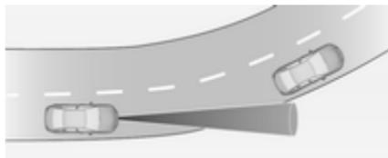
Ausgehend von der Zentrifugalkraft berechnet der adaptive Geschwindigkeitsregler einen voraussichtlichen Weg. Der berechnete Weg berücksichtigt die aktuellen Kurveneigen-
