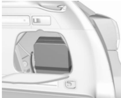
Beim Sports Tourer befindet sich das Reifenreparaturset in einem Koffer hinter einer Abdeckung rechts im Laderaum. Der Koffer ist mit einem Gurt gesichert.
