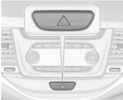
Wird durch Drücken von
