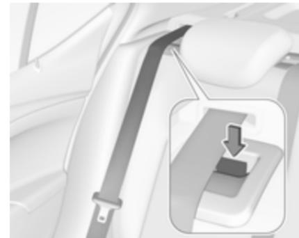
Die Rückenlehnen sind korrekt eingerastet, wenn die roten Markierungen auf beiden Seiten neben dem Entriegelungsgriff nicht mehr sichtbar sind.
