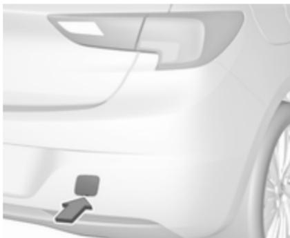
Die Spitze eines Schlitzschraubendrehers mit einem Tuch umwickeln, um den Lack zu schützen. Mit einem Schraubendreher in den Schlitz an der unteren Beuge der Abdeckung fahren. Abdeckung durch vorsichtiges Abwärtsbewegen des Schraubendrehers lösen.
