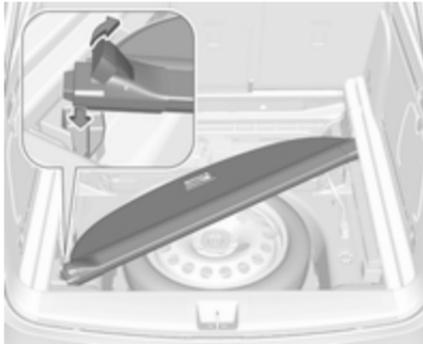
Alle Motorversionen außer CNG: Das entfernte Sonnenrollo kann wie in der Abbildung gezeigt unter der Bodenabdeckung im Heck verstaut werden. Zuerst die linke Seite der aufgerollten Abdeckung in die vordere rechte Aussparung einsetzen, den Freigabehebel nach oben ziehen und die rechte Seite in die vordere linke Aussparung einsetzen.
