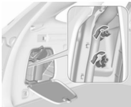
2. Beide Kunststoff-Befestigungsmuttern von innen mit der Hand abschrauben.
