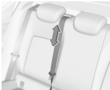
Der Sicherheitsgurt des Mittelsitzes könnte blockiert werden, wenn die Rückenlehne zu schnell hochgeklappt wird. Um den Aufroller zu entsperren, Sicherheitsgurt ca. 20 mm hineindrücken oder herausziehen und dann loslassen.
