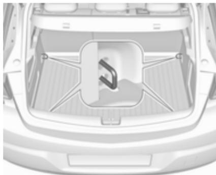
In Fahrzeugen mit Reserverad sind die vorderen Verzurrösen an den Seitenwänden angeordnet.
