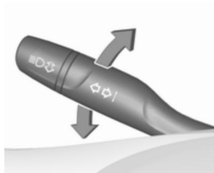
Hebel nach oben : Blinker rechts
