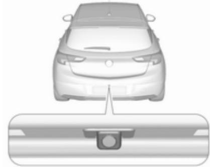
Am 5-Türer-Schrägheck ist die Kamera zwischen den Kennzeichenleuchten montiert.
