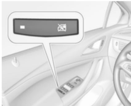
Zur Deaktivierung der elektrischen Fensterheber der hinteren Türen
