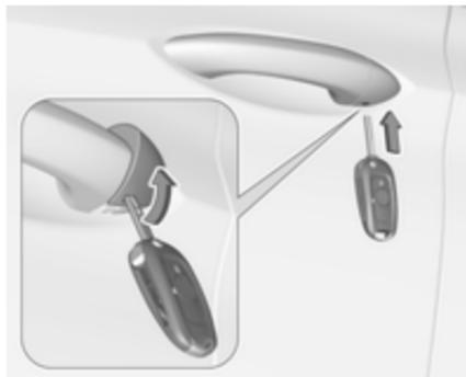
**Fernsteuerung:** Zum Entfernen der Kappe den Schlüssel in die Aussparung unten an der Kappe einsetzen und den Schlüssel nach oben schwenken.
