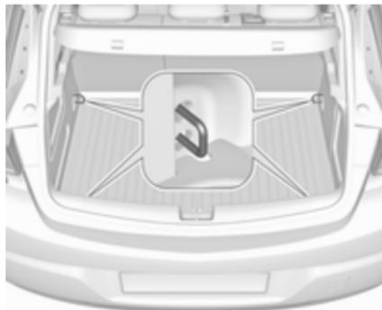
An Fahrzeugen mit Reserverad befinden sich die vorderen Verzurrösen an den Seitenwänden.
