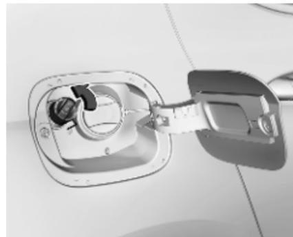
4. Die Schutzkappe vom Einfüllstutzen abschrauben.
