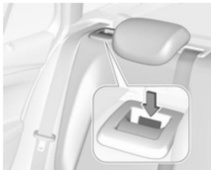
Die Rückenlehnen sind korrekt eingerastet, wenn die roten Markierungen auf beiden Seiten neben dem Griff nicht mehr sichtbar sind.
