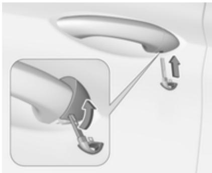
**Elektronischer Schlüssel:** Zum Entfernen der Kappe den Knopf an der Rückseite drücken und das Schlüsselblatt aus dem Gehäuse ziehen. Den Schlüssel in die Aussparung am unteren Rand der Kappe stecken und den Schlüssel nach oben schwenken.
