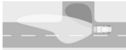
Beim Abbiegen werden je nach Lenkwinkel und Blinker spezielle LED eingeschaltet, um die Fahrtrichtung auszuleuchten. Er wird bei Geschwindigkeiten von bis zu 40 km/h aktiviert.
