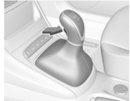
Zum Einlegen des Rückwärtsgangs das Kupplungspedal und dann den Knopf am Wählhebel betätigen und den Gang einlegen.
