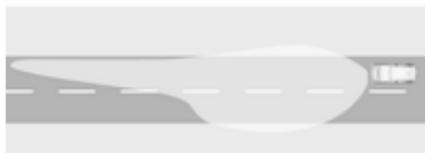
Wird beim Fahren in ländlichen Gebieten automatisch bei Geschwindigkeiten über ca. 55 km/h aktiviert. Die eigene Fahrbahn und deren Rand werden besser ausgeleuchtet. Entgegenkommende und vorausfahrende Fahrzeuge werden nicht geblendet.
