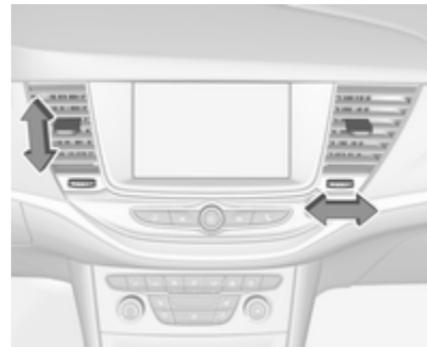
Zum Öffnen der Düse das Einstellrädchen zum größeren Symbol
