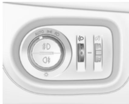
Zur Anpassung der Leuchtweite an die Fahrzeuglast, um die Blendwirkung zu reduzieren: Daumenrädchen
