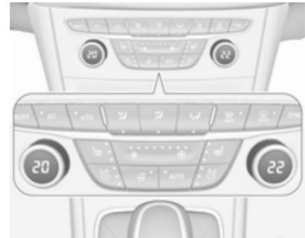
Die gewünschten Temperaturwerte einstellen. Über den Knopf auf der Beifahrerseite lässt sich die Temperatur für die Beifahrerseite ändern. Mit dem Knopf auf der Fahrerseite kann die Temperatur sowohl für die Fahrerseite als auch beide Seiten in Abhängigkeit von der Aktivierung der Synchronisation **SYNC** geändert werden.
