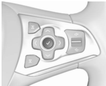
Bei Uplevel-Display **✓** am Lenkrad drücken, um eine Meldung zu bestätigen.
