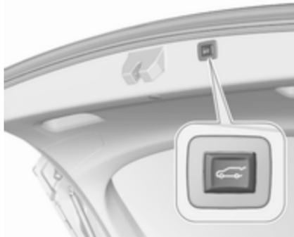
4. Die Taste
