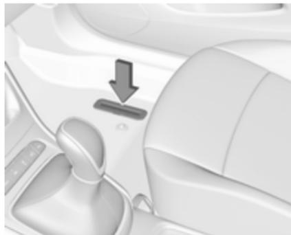
Die Fahrzeug-Identifizierungsnummer kann auf dem Typschild und im Bodenblech, unter der Bodenmatte sichtbar unter einer Abdeckung eingestanzt sein.
