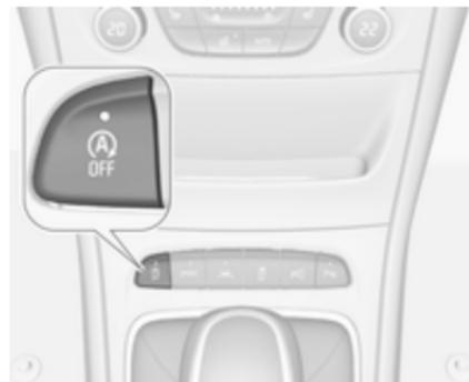
Die Stopp-Start-Automatik lässt sich durch Drücken von
