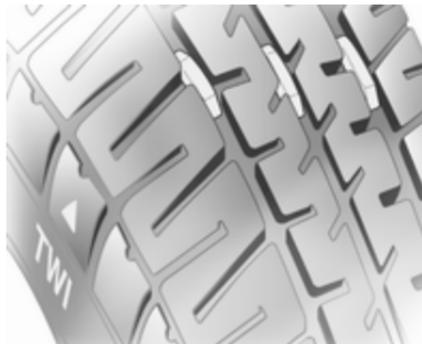
Die gesetzlich zulässige Mindestprofiltiefe (1,6 mm) ist erreicht, wenn das Profil bis zu einem Verschleißanzeiger (TWI = Tread Wear Indicator) abgefahren ist. Seine Lage wird durch Markierungen an der Reifenflanke angezeigt.
