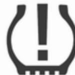
Wenn niedriger Reifendruck erkannt wird, wird dies durch die Kontrollleuchte
