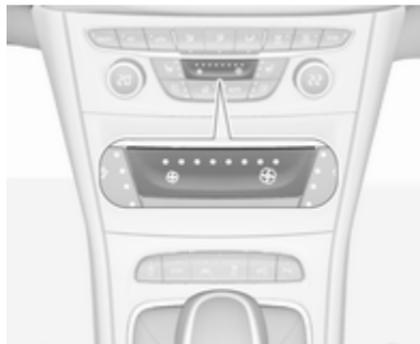
Zum Verringern der Gebläsedrehzahl die linke Taste drücken, zum Erhöhen die rechte Taste. Die Gebläsedrehzahl wird durch die Anzahl der LEDs in der Taste angezeigt.
