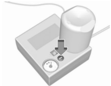
Wird der vorgeschriebene Reifendruck nicht innerhalb von 10 Minuten erreicht, das Reifenreparaturset abnehmen. Das Fahrzeug um eine Reifenumdrehung bewegen. Das
