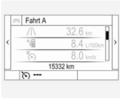
Die erfasste Gesamtfahrstrecke wird in km angezeigt.
