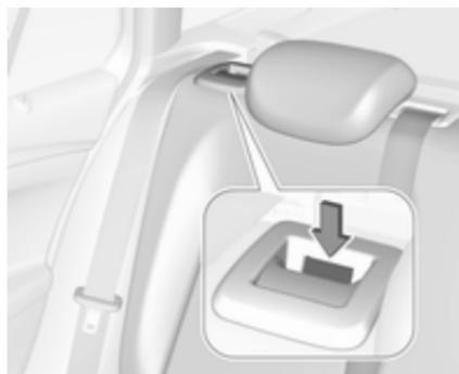
Die Rückenlehnen sind korrekt eingerastet, wenn die roten Markierungen an den Hebeln auf beiden Seiten nicht mehr sichtbar sind.
