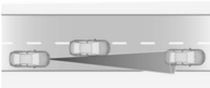
Wechselt ein anderes Fahrzeug auf die von Ihnen verwendete Spur, berücksichtigt der adaptive Geschwindigkeitsregler das Fahrzeug erst nach dem vollständigen
