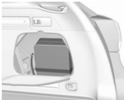
Am Sports Tourer befindet sich das Reifenreparaturset in einem Koffer hinter einer Abdeckung auf der rechten Seite im Laderaum. Der Koffer ist mit einem Gurt gesichert.
