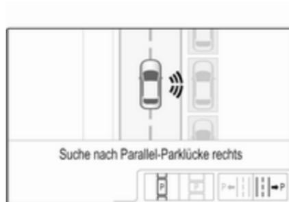
Längs- oder Querparklücke durch Antippen des entsprechenden Symbols im Display auswählen. Parkseite durch Antippen des entsprechenden Symbols im Display auswählen.
