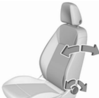
Handrad drehen. Zum Einstellen Rückenlehne entlasten.
