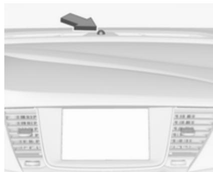
Die Status-LED ist in den Sensor oben auf der Instrumententafel integriert.
