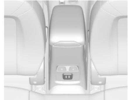
Zwei USB-Anschlüsse ausschließlich zum Laden von Geräten befinden sich an der Rückseite der Mittelkonsole.
