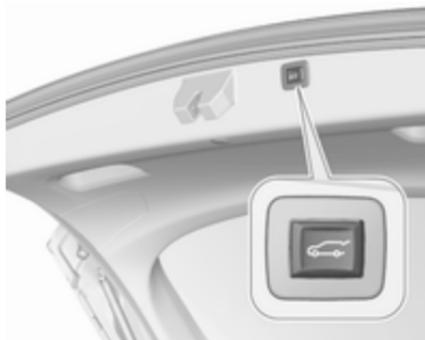
Zum Schließen auf
