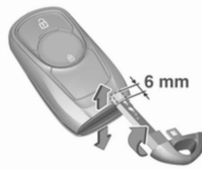
2. Das Schlüsselblatt wieder etwa 6 mm weit einführen und den Schlüssel drehen, um das Gehäuse zu öffnen. Wenn das Schlüsselblatt zu weit eingeführt wird, kann dies das Gehäuse beschädigen.
