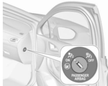
Das Beifahrer-Airbag-System kann mit dem Schlüssel über einen Schalter auf der Beifahrerseite der Instrumententafel deaktiviert werden.
