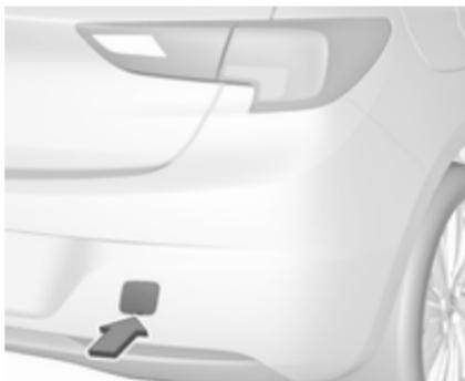
Den Schraubendreher in den Schlitz an der Kante der Abdeckung stecken. Die Kappe vorsichtig abhebeln und lösen.
