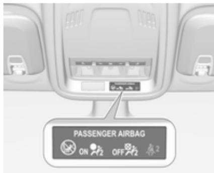
Wenn die Kontrollleuchte
