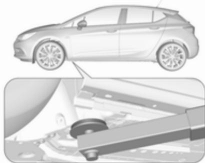
Vordere Arme der Hebebühne mittig unter den entsprechenden Wagenheberaufnahmen positionieren.
