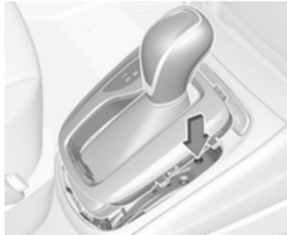
3. Einen kleinen, länglichen Gegenstand (z. B. Stift oder Schraubendreher) in die Öffnung neben dem Wählhebel einführen. Den Stab senkrecht nach unten drücken und den Wählhebel aus P schalten. Wenn diese Stellung wieder erreicht ist, wird der Wählhebel wieder arretiert. Ursache für die Stromunterbrechung von einer Werkstatt beheben lassen.
