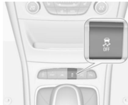
Die Traktionskontrolle kann ausgeschaltet werden, wenn ein Durchdrehen der Antriebsräder erwünscht ist:
