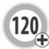
Zudem werden in der unteren Zeile des Fahrerinfodisplays permanent die aktuell gültigen Geschwindigkeitsbegrenzungen angezeigt. Wenn eine Geschwindigkeitsbegrenzung mit zusätzlichem Verkehrschild verfügbar ist, wird in diesem Bereich ein + Symbol angezeigt.
