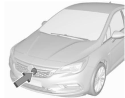
Das Radargerät ist hinter dem Kühlergrill hinter dem Markenemblem oder unterhalb des Markenemblems montiert.
