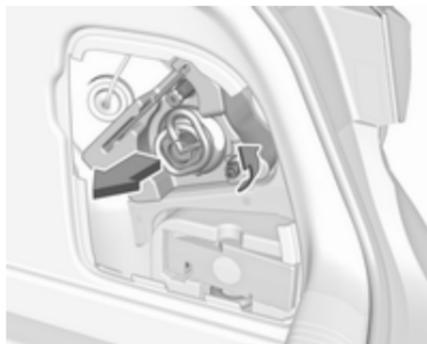
2. Fahrzeuge mit Reifenreparaturset: Zum Ersetzen von Leuchtmitteln auf der rechten Seite zuerst die Kunststoffmutter abschrauben und den Einsatz mit der Dichtmittelflasche herausnehmen.
