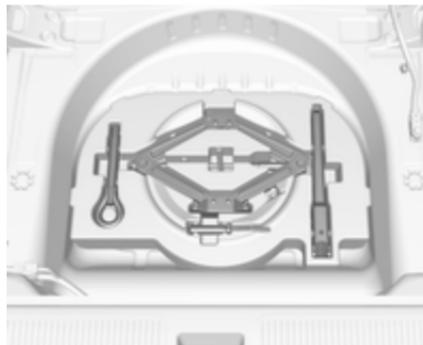
Der Wagenheber, die Abschleppöse und das Wagenwerkzeug befinden sich im Wagenwerkzeugkasten unter dem Reserverad.
