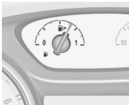
Zeigt je nach aktuellem Betriebsmodus den Kraftstoffstand oder den Gasinhalt (CNG) im Tank an.
