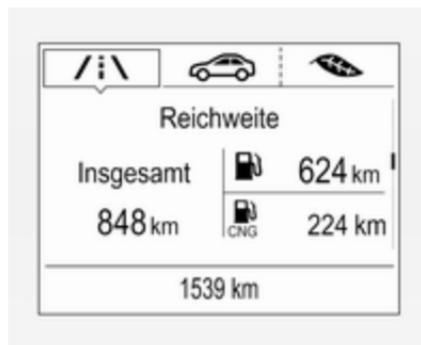
Anzeige der ungefähren Kraftstoffreichweite je Tank (CNG und Benzin). Ein niedriger Kraftstoffstand in einem beliebigen Tank wird durch **Niedrig** im entsprechenden Bereich angezeigt.
