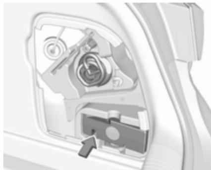
Am 5-Türer-Schrägheck befindet sich das Reifenreparaturset im Laderaum hinter einer Abdeckung.
