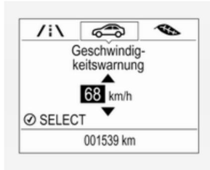
Die Geschwindigkeitswarnfunktion warnt den Fahrer, wenn eine eingestellte Geschwindigkeit überschritten wird.
