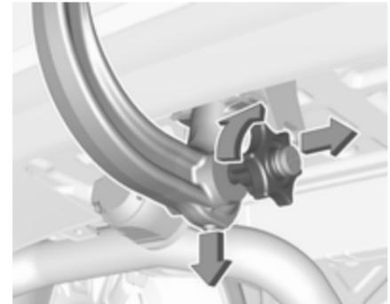
Die Schutzklappe öffnen und zum Entriegeln der Kugelstange den Schlüssel in Position
