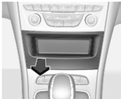
An der linken Seite der Abdeckung ziehen, um sie zu entfernen.
