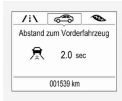
Beim Uplevel-Display das **Info**-Menü über die Lenkradtasten auswählen und zum Anzeigen der Abstandswarnung auf
