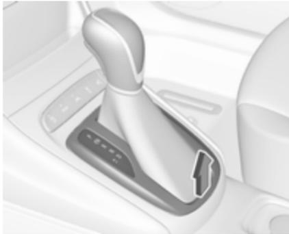
2. Die Wählhebel-Verkleidung von der Mittelkonsole lösen. Mit einem Finger in die Lederbasis unter dem Wählhebel stechen und die Verkleidung nach oben drücken. Die Verkleidung nach links drehen.
