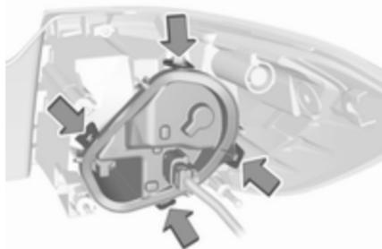
Die Haltetaschen lösen und den Lampenträger aus der Leuchteneinheit entfernen.
