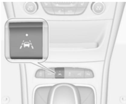
Der Spurhalteassistent wird durch Drücken auf
