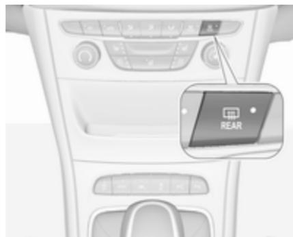
Wird durch Drücken von
