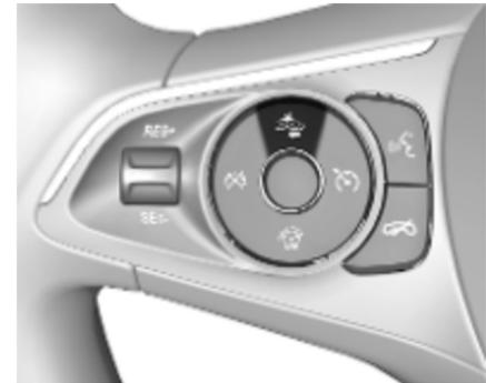
Beim ersten Drücken der Taste wird die aktuelle Einstellung im Fahrerinfodisplay angezeigt. Durch erneutes Drücken der Taste wird die Einstellung geändert. Die ausgewählte Einstellung bleibt aktiv, bis sie erneut
