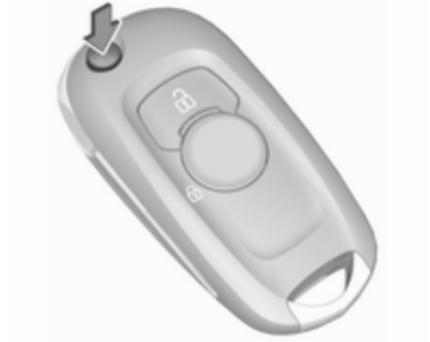
Zum Ausklappen auf den Knopf drücken. Zum Einklappen des Schlüssels zuerst auf den Knopf drücken.
