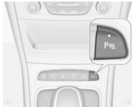
Zum Deaktivieren die Einparkhilfe-Taste **P** mit einem Dreieck drücken. Die LED in der Taste erlischt.
