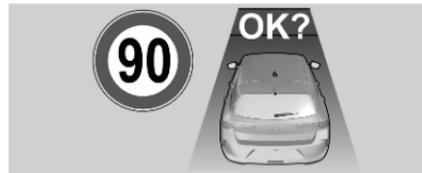
**OK** drücken, um die aktuelle Fahrzeuggeschwindigkeit zu speichern und den Geschwindigkeitsregler zu aktivieren. Auf dem Bildschirm des adaptiven Geschwindigkeitsreglers
