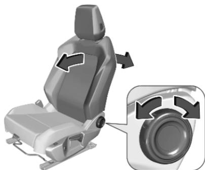
Handrad drehen. Zum Einstellen Rückenlehne entlasten.
