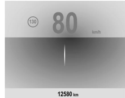
Die erfasste Gesamtfahrstrecke wird in km angezeigt.
