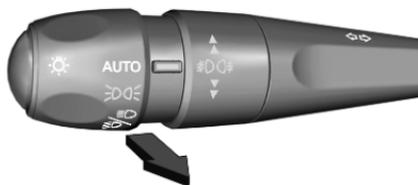
Um die Lichthupe zu aktivieren, den Hebel kurz bis zum Widerstandspunkt ziehen.
