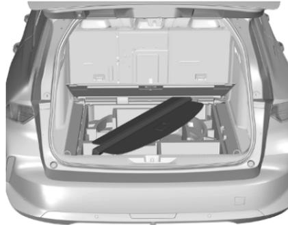
Das entfernte Sonnenrollo kann wie in der Abbildung gezeigt unter der Laderaumbodenabdeckung verstaut werden.
