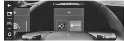
Im Fahrerinfodisplay können zwei Widgets angezeigt werden, im Head-up-Display ein Widget. Im Info-Display können mehrere Widgets angezeigt werden.
