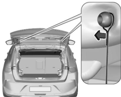
Die Haltegurte an der Heckklappe aushaken.
