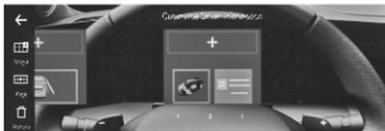
Durch Auswählen der anzuzeigenden Widgets können mehrere Seiten erstellt werden. Es können bis zu fünf Seiten mit je ein bis zwei Widgets gespeichert werden.
