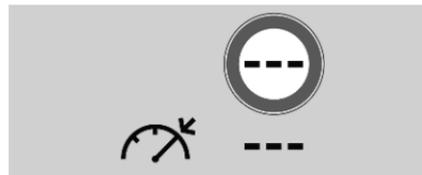
Der Geschwindigkeitsreglerbildschirm wird angezeigt. ↖ wird grau angezeigt, um darauf hinzuweisen, dass das System noch nicht aktiv ist.
