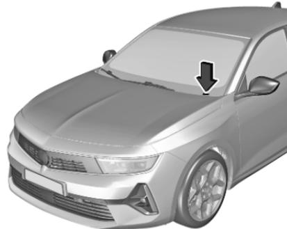
Die Fahrzeug-Identifizierungsnummer kann in der Instrumententafel, durch die Windschutzscheibe sichtbar, oder im Motorraum am rechten Karosserieblech eingestanz sein.
