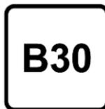
Kraftstoff B20 oder B30 gemäß der Norm EN16709 kann bei Dieselmotoren ebenfalls getankt werden. Hierfür sind jedoch auch bei gelegentlicher
