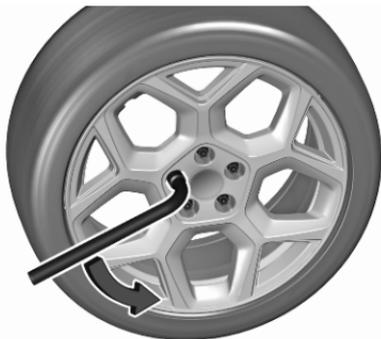
2. Radschlüssel anbringen und jede Radschraube um eine halbe Umdrehung lockern.
