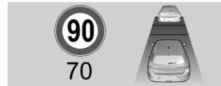
Wenn das System ein Fahrzeug in Fahrtrichtung erkennt, ändert sich der Bildschirm des adaptiven Geschwindigkeitsreglers entsprechend.
