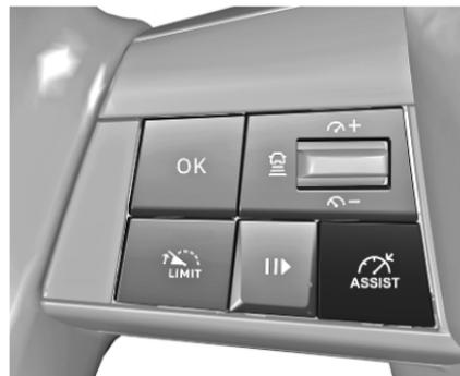
Mehrmals **ASSIST** am Lenkrad drücken, bis der Modus **Drive Assist** ausgewählt ist.
