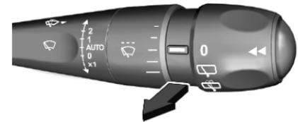
Hebel ziehen. Waschflüssigkeit spritzt auf die Windschutzscheibe und der Wischer wird für einige Wischbewegungen eingeschaltet.
