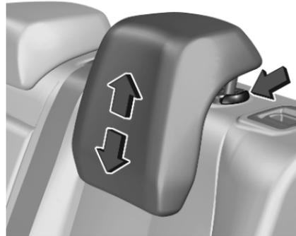
Kopfstütze nach oben ziehen bzw. Rastfedern durch Drücken entriegeln und Kopfstütze nach unten schieben.
