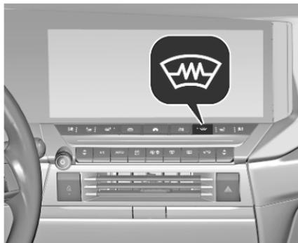
Betätigung durch Berühren von
