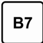
Dieselmotorenkraftstoff gemäß der Norm EN590, gemischt mit einem Biokraftstoff gemäß der Norm EN14214 (mit bis zu 7 % Fettsäuremethylester).
