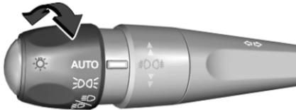
Bei aktivierter automatischer Lichtsteuerung schaltet das System abhängig von den äußeren Lichtverhältnissen und den Informationen des Wischersystems automatisch zwischen Tagfahrlicht und Scheinwerfern um.
