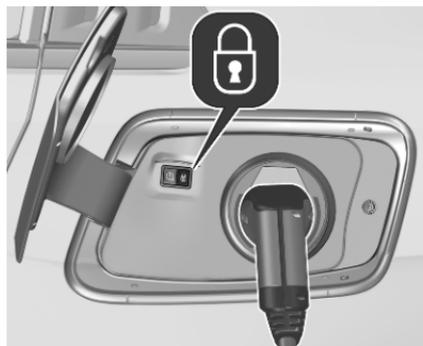
Nach dem Beginn des Ladevorgangs wird der Fahrzeugstecker am Ladeanschluss verriegelt und kann während des aktiven Ladens nicht getrennt werden.
