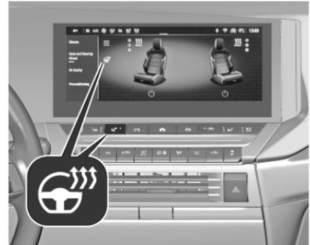
Die Heizung durch Drücken von
