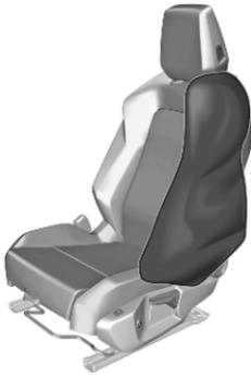
Der aufgeblähte Airbag dämpft den Aufprall, wodurch die Verletzungsgefahr für Oberkörper und Becken bei einem Seitenaufprall deutlich verringert wird.
