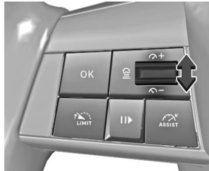
Die eingestellte Geschwindigkeit kann durch Bewegen des Daumenrädchens auf ↻+ erhöht bzw. auf ↻- gesenkt werden. Daumenrädchen mehrmals kurz schieben, um die Geschwindigkeit in kleinen Schritten zu ändern, länger schieben, um sie in großen Schritten zu ändern.
