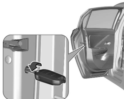
Kindersicherung in der Hintertür mit einem Schlüssel nach außen in die waagerechte Stellung drehen. Die Tür lässt sich dann von innen nicht öffnen.
