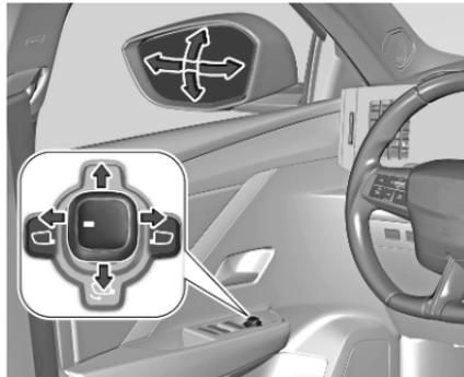
Durch Drehen des Bedienelements den gewünschten Außenspiegel auswählen.
