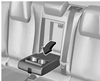
In der hinteren Armlehne befindet sich ein kombinierter Stauraum mit Getränkehaltern und Ablagemöglichkeit für mobile Geräte. Die Armlehne nach unten klappen.
