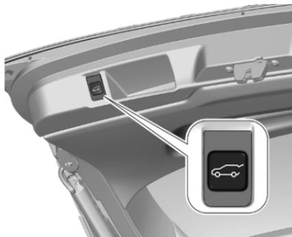
Zum Schließen auf
