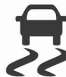
Die elektronische Stabilitätsregelung und die Traktionskontrolle sind nach jedem Motorstart funktionsfähig, sobald die Kontrollleuchte
