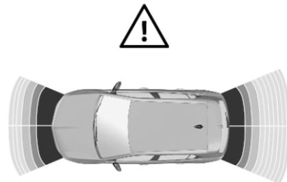
Je näher das Fahrzeug dem Hindernis in Fahrtrichtung kommt, desto kürzer das Intervall zwischen den Tönen. Bei einem Abstand unter ca. 30 cm wird ein Dauersignal ausgegeben.
