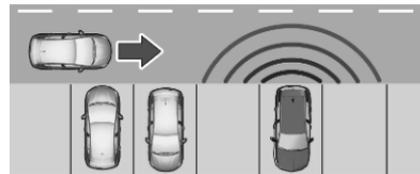
Das System erkennt Objekte, die sich mit einer Geschwindigkeit über 3 km/h in einer Entfernung von bis zu 40 m bewegen.
