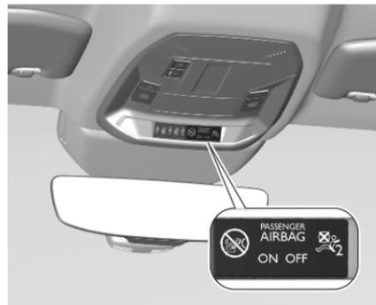
Wenn die Kontrollleuchte
