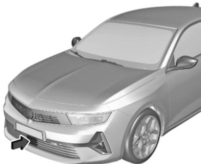
Die Radareinheit befindet sich in der Mitte des Frontstoßfängers.
