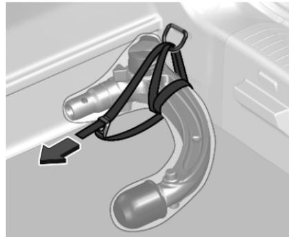
Der Beutel mit der Kugelstange wird auf der hinteren Bodenabdeckung im Laderaum verstaut.
