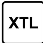
Paraffinischer Dieselmotorenkraftstoff gemäß der Norm EN15940, gemischt mit einem Biokraftstoff gemäß der Norm EN14214 (mit bis zu 7 % Fettsäuremethylester).
