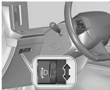
Zur manuellen Anpassung der Leuchtweite an die Fahrzeuglast, um die Blendwirkung zu reduzieren: Daumenrädchen
