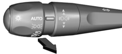
Zum Aktivieren bzw. Deaktivieren des Fernlichts den Hebel über den Widerstandspunkt hinaus ziehen.
