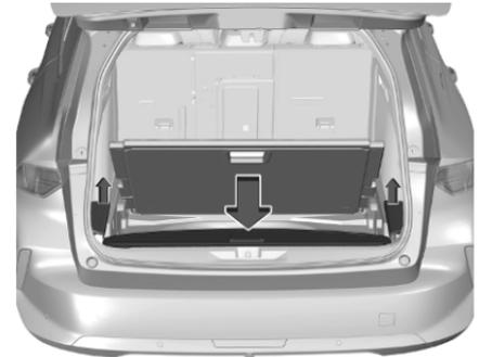
Die Laderaumbodenabdeckung anheben und die Abdeckungen an beiden Laderaumseiten entfernen, um Zugang zu den Aussparungen zu erhalten.
