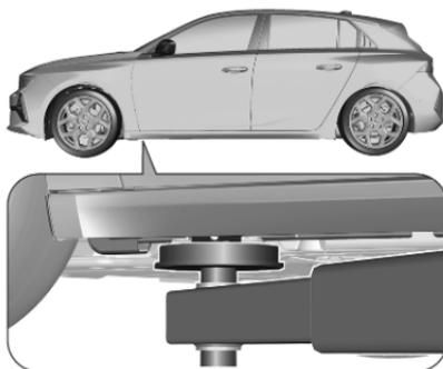
Der vordere Arm der Hebebühne muss mittig unter der entsprechenden Wagenheberaufnahme positioniert sein.
