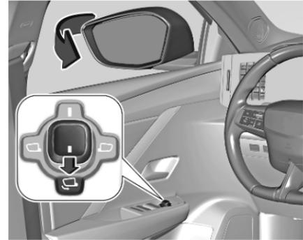
Zum Ein- und Ausklappen beider Außenspiegel das Bedienelement auf
