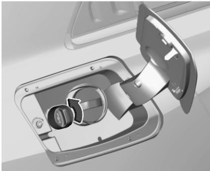
4. Die Schutzkappe vom Einfüllstutzen abschrauben.
