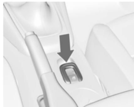
Schalter gedrückt halten, bis das Verdeck und die Verdeckabdeckung vollständig geschlossen sind. Wenn die Fensterbewegung gestartet wird, den Schalter loslassen. Die Fenster werden automatisch geschlossen.
