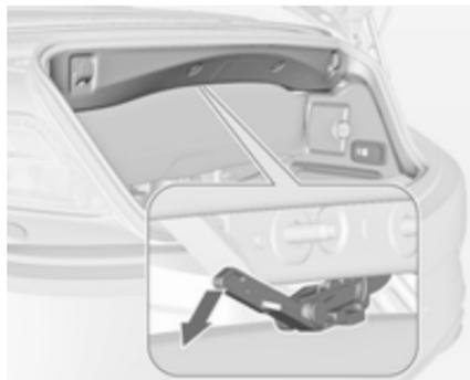
3. Auf der Innenseite des oberen Kofferraumdeckelrahmens befindet sich ein Hebel zum Lösen der Verdeckabdeckung. Zum Entriegeln den Hebel nach unten schwenken.
