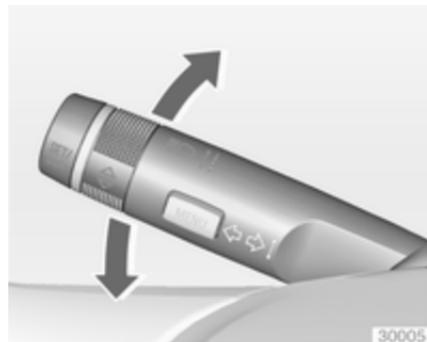
Hebel nach oben = Blinker rechts
