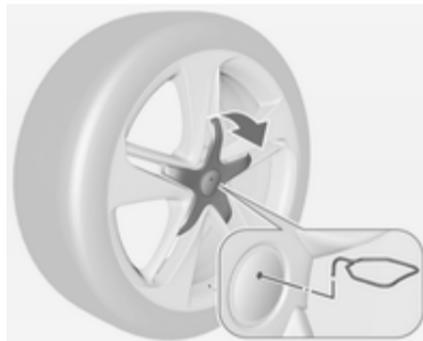
Leichtmetallräder mit Radzierkappen in der Mitte: Radzierkappe lösen. Dazu Abzieher ⇨ 210 in die Aussparung des Markenemblems stecken und daran ziehen.
