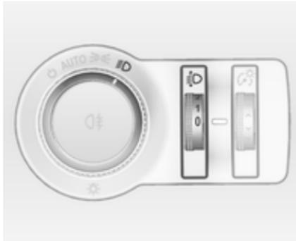
Zur Anpassung der Leuchtweite an die Fahrzeugbeladung, um Blendwirkung zu reduzieren: Daumenrad
