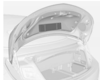
Das Warndreieck ist an der Innenseite des Kofferraumdeckels verstaut und mit Bändern gesichert.
