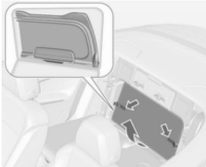
In einer Tasche hinter den Rücksitzlehnen befinden sich zwei Windschotts. Die Rücksitzlehnen herunterklappen ⇨ 74, die Klettverschlüsse öffnen und die Tasche aus der Vertiefung entnehmen.
