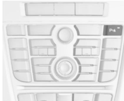
Die Front-Heck-Einparkhilfe wird mit der Taste **P** mit einem Dreieck betätigt. Wenn das Fahrzeug zusätzlich mit der erweiterten Einparkhilfe ausgestattet ist (siehe nachfolgende Beschreibung), umfasst das System die Taste **P** mit einem Dreieck und einem Quadrat. In diesem Fall werden beide Systeme über die Taste **P** mit einem Dreieck und einem Quadrat bedient.
