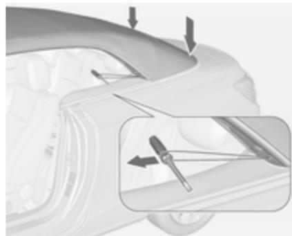
18. Den Spannbügel auf beiden Seiten fest nach unten drücken. Gleichzeitig die Schnur mit einem Schraubendreher in der Schlaufe langsam und stetig nach vorne ziehen. Sich gegebenenfalls mit der anderen Hand am Türrahmen abstützen. Diesen Vorgang auf beiden Seiten ausführen, um das Verdeck hinten zu verriegeln.
