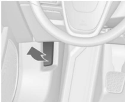
Entriegelungshebel ziehen und in die Ausgangsposition zurückführen.
