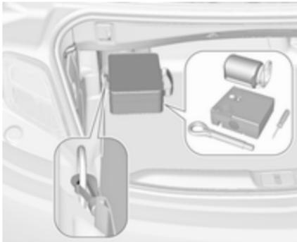
Einige Werkzeuge und die Abschleppöse sind zusammen mit dem Reifenreparaturset in einer Tasche verstaut, die an der linken Verzurröse im Laderaum befestigt ist.
