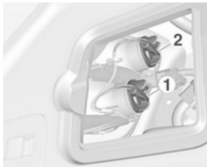
3. Die Glühlampenfassung gegen den Uhrzeigersinn drehen, um sie zu entfernen.
