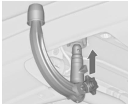
Gespannte Kugelstange in die Aufnahmeöffnung einführen und kräftig bis zum hörbaren Einrasten nach oben drücken.
