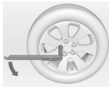
2. Radschraubenschlüssel ansetzen und sicherstellen, dass er gut sitzt. Jede Radmutter um eine halbe Drehung lösen.
