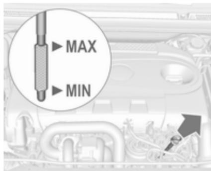
Wir empfehlen die Verwendung der gleichen Motorölviskosität wie beim letzten Ölwechsel.
