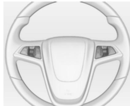
Das Infotainment-System, bestimmte Fahrerassistenzsysteme und ein angeschlossenes Mobiltelefon können mit den Lenkradelementen bedient werden.
