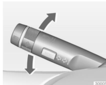
Hebel nach oben = Blinker rechts
