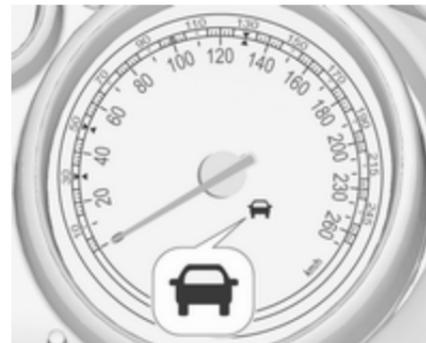
Ein vorausfahrendes Fahrzeug wird durch die Kontrollleuchte
