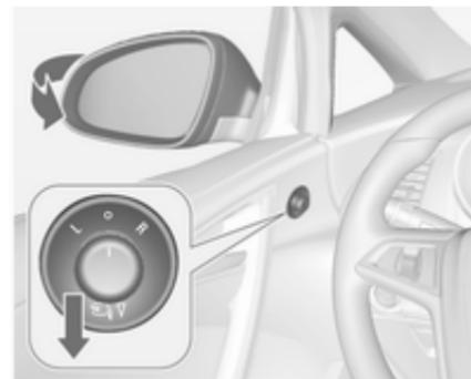
Bedienelement auf **0** drehen und dann hinterdrücken. Beide Außenspiegel werden eingeklappt.
