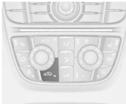
Zum Einschalten des Umluftbetriebs Taste
