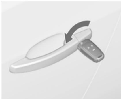
Die Fahrertür durch Drehen des Schlüssels im Schloss von Hand entriegeln. Zündung einschalten und Zentralverriegelungstaste
