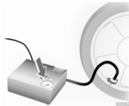
Wenn der Reifendruck mehr als 1,3 bar beträgt, auf den vorgeschriebenen Wert korrigieren. Vorgang wiederholen, bis kein Druckverlust mehr entsteht.
