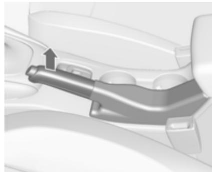
Die Parkbremse ohne Betätigung des Entriegelungsknopfes immer fest anziehen, im Gefälle oder an einer Steigung so fest wie möglich.
