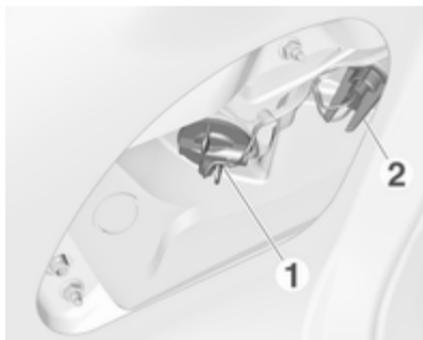
Die Glühlampenfassung gegen den Uhrzeigersinn drehen, um sie zu entfernen.
