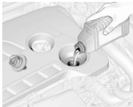
Wenn der Motorölstand in den Bereich der Nachfüllmarke **MIN** abgesunken ist, Motoröl nachfüllen.
