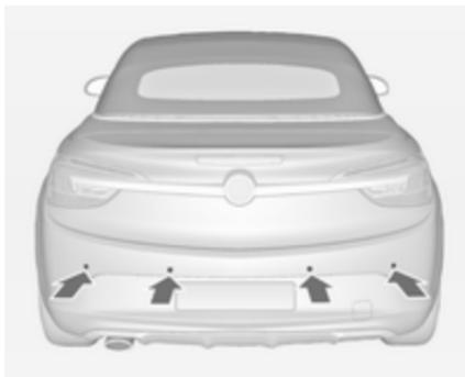
Das System besteht aus vier Ultraschall-Parkensensoren im hinteren Stoßfänger.
