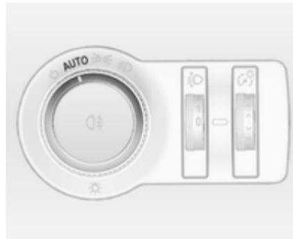
Bei aktiviertem automatischem Fahrlicht und laufendem Motor schaltet das System abhängig von den Lichtverhältnissen und den Informationen des Regensensors zwischen Tagfahrlicht und Scheinwerfern automatisch um.
