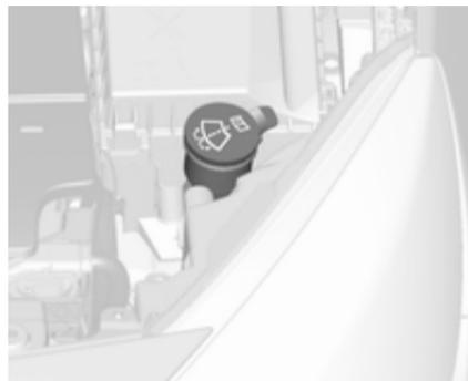
Mit einem Gemisch aus sauberem Wasser und einer geeigneten Menge Frostschutzmittelhaltiger Scheibenwaschflüssigkeit auffüllen.
