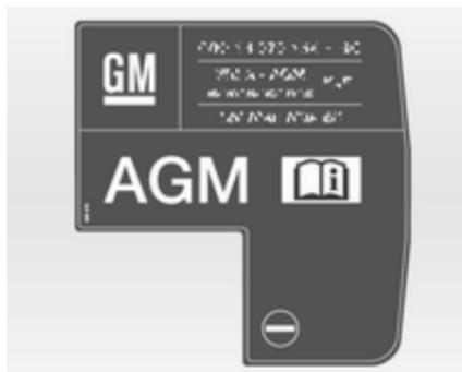
AGM-Batterien sind am entsprechenden Batterieschild zu erkennen. Wir empfehlen den Einsatz einer original Opel-Fahrzeuggatterie.
