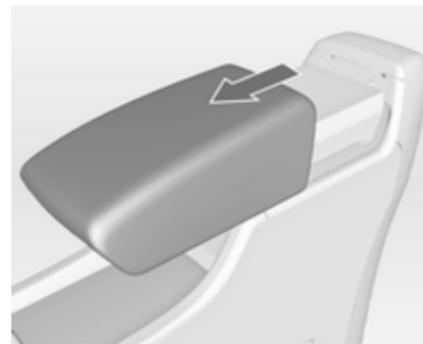
Die Armlehne kann um 10 cm nach vorn verschoben werden. Unter der Armlehne befindet sich ein Staufach. Armlehnenfach ⇨ 73.
