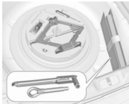
Laderaumbodenabdeckung öffnen. Wagenheber, Wagenwerkzeug und ein Gurt zur Befestigung eines beschädigten Rades befinden sich im Werkzeugkasten unter dem Reserverad im Laderaum. Der Radschlüssel und die Abschleppöse befinden sich in der Werkzeutasche, die in der Nähe des Werkzeugkastens in der Reserveradaufnahme verstaut ist. Reserverad ⇨ 223.
