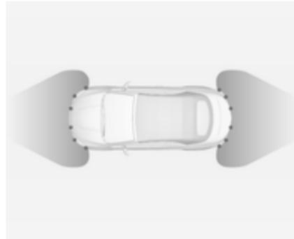
Die erweiterte Einparkhilfe führt den Fahrer durch Anweisungen im Fahrerinformationszentrum und akustische Signale in eine Parklücke. Der Fahrer ist verantwortlich für die Beschleunigung, das Bremsen, das Lenken und das Schalten.
