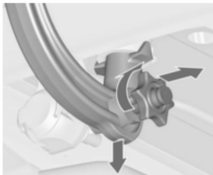
Die Schutzklappe öffnen und zum Entriegeln der Kugelstange den Schlüssel in Position
