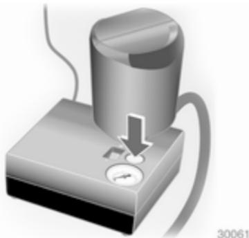
Wird der vorgeschriebene Reifendruck nicht innerhalb von 10 Minuten erreicht, Reifenreparaturset entfernen. Das Fahrzeug um eine Reifenumdrehung bewegen. Das Reifenreparaturset wie-
