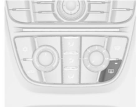
Die Heizung wird durch Drücken der Taste
