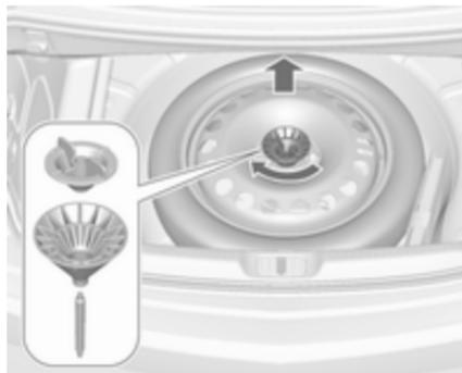
5. Den Kegel in die Öffnung des Reserverades einführen und drehen, so dass das Reserverad so weit vorne wie möglich positioniert ist. Die Flügelmutter im Uhrzeigersinn drehen, um das Rad zu sichern.
