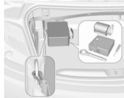
Bei einer anderen Ausführung ist das Reifenreparaturset in einer Tasche verstaut, die an der linken hinteren Verzurröse im Laderaum gesichert ist.
