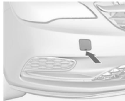
Mit einem Schraubendreher in den Schlitz unten an der Abdeckung fahren. Abdeckung durch vorsichtiges Abwärtsbewegen des Schraubendrehers lösen.
