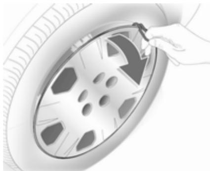
1. Radmutternkappen mit Schraubendreher lösen und abnehmen. Radabdeckung mit dem Haken abziehen. Wagenwerkzeug ⇨ 210.
