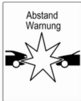
Wenn der Abstand zu einem vorausfahrenden Fahrzeug zu gering wird oder Sie sich einem anderen Fahrzeug zu schnell nähern, wird im Driver Information Center das Kollisionswarnsymbol angezeigt.
