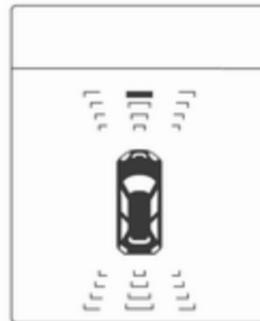
Die Abstandsanzeige im Driver Information Center kann von Fahrzeugmeldungen mit höherer Priorität überschrieben werden. Nachdem die Meldung durch Drücken der Taste **SET/CLR** auf dem Blinkerhebel bestätigt wurde, wird der Abstand wieder angezeigt.
