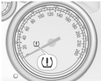
Wenn niedriger Reifendruck erkannt wird, wird dies durch die Kontrollleuchte
