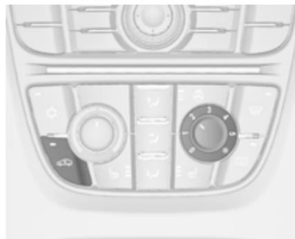
Zum Einschalten des Umluftbetriebs Taste
