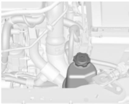
Der Stand der Lenkunterstützungsflüssigkeit muss im Allgemeinen nicht geprüft werden. Wenn beim Lenken ungewöhnliche Geräusche auftreten oder die Lenkunterstützung eine unerwartete Reaktion aufweist, die Hilfe einer Werkstatt in Anspruch nehmen.
