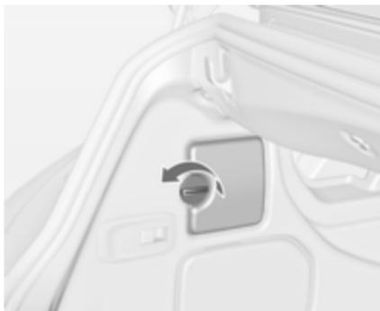
2. Abdeckung in Seitenverkleidung lösen und herausnehmen.
