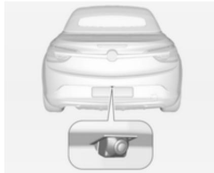
Die Kamera ist zwischen den Kennzeichenleuchten integriert und verfügt über einen Blickwinkel von 130°.
