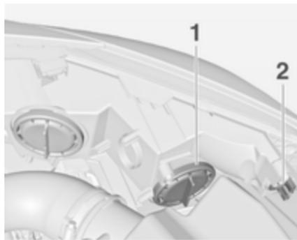
**Bi-Halogen-Scheinwerfer (1)** mit einer Lampe für Abblend- und Fernlicht
