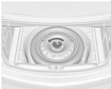
3. Das Reserverad ist mit einer Flügelmutter in der Radmulde gesichert. Mutter aufdrehen, Kegel abnehmen und Reserverad herausnehmen.
