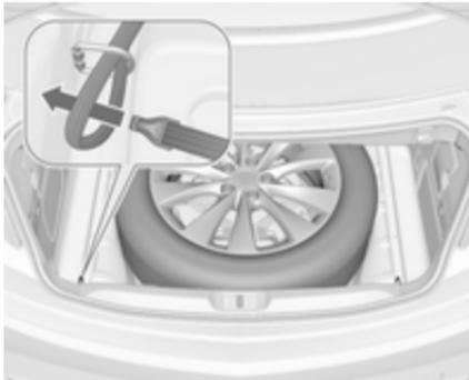
7. Das Schlaufenende des Gurtes durch die linke hintere Verzurrröse führen.
