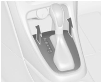
2. Die Wählhebelverkleidung vorn von der Mittelkonsole lösen, nach oben klappen und nach links drehen.
