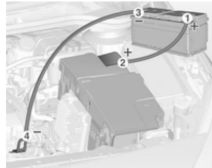
Reihenfolge für das Anschließen der Kabel:
