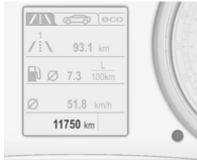
Anzeige der gefahrenen Entfernung in km in der unteren Zeile.
