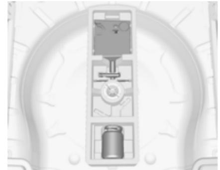
Wagenwerkzeug und die Abschleppöse sind zusammen mit dem Reifenreparaturset in einem Werkzeugkasten untergebracht, der sich unter der Bodenabdeckung im Laderaum befindet.
