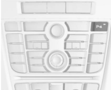
Die Front-Heck-Einparkhilfe wird mit **P** betätigt. Wenn das Fahrzeug zusätzlich mit der erweiterten Einparkhilfe ausgestattet ist (siehe nachfolgende Beschreibung), enthält das System **P**. Beide Systeme werden durch Drücken von **P** betrieben.
