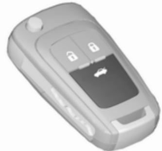
Durch Drücken auf
