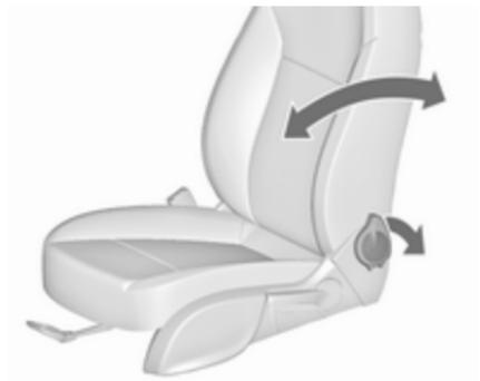
Hebel nach hinten bewegen, Neigung einstellen und Hebel loslassen. Die Rückenlehne muss hörbar einrasten.
