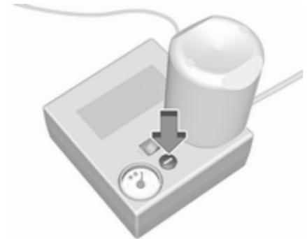
Wird der vorgeschriebene Reifendruck nicht innerhalb von 10 Minuten erreicht, Reifenreparaturset entfernen. Das Fahrzeug um eine Reifenumdrehung bewegen. Das Reifenreparaturset wieder anschließen und Füllvorgang 10 Minuten fortsetzen. Wird der vorgeschriebene Reifendruck danach immer noch nicht erreicht, ist der Reifen zu stark beschädigt. Hilfe einer Werkstatt in Anspruch nehmen.
