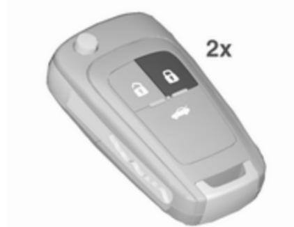
🔒 auf der Funkfernbedienung zweimal innerhalb von 15 Sekunden kurz drücken. Durch ein langes Drücken wird das Schließen des Verdecks aktiviert.
