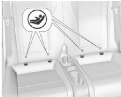
Vor dem Einbau eines Kinderrückhaltesystems das Windschott ↗ 43 und je nach Bedarf die hintere Kopfstütze entfernen ↗ 66.
