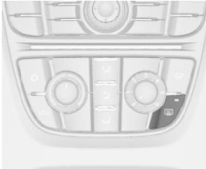
Wird durch Drücken von
