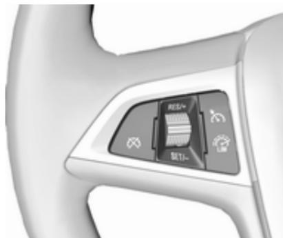
🗲 drücken. Wenn zuvor der Geschwindigkeitsregler aktiv war, wird dieser beim Aktivieren des Geschwindigkeitsbegrenzers ausgeschaltet. Die Kontrollleuchte ☹️ erlischt.
