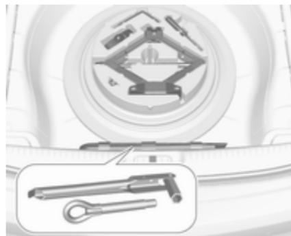
Unter dem Reserverad befinden sich ein Kasten und eine Tasche mit Wagenwerkzeug. Die Werkzeughülle ist mit einem Halteband an der Stange der Radaufnahme befestigt. Den Werkzeugkasten und das Halteband der Werkzeughülle von der Stange der Radaufnahme entfernen, um auf das Werkzeug in der Tasche zuzugreifen. Wagenwerkzeug
