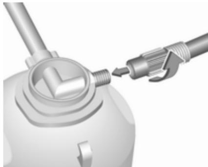
4. Kompressor-Luftschnlauch an den Anschluss der Dichtmittelflasche schrauben.
