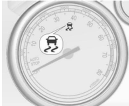
Die elektronische Stabilitätsregelung ist nach jedem Motorstart funktionsfähig, sobald die Kontrollleuchte
