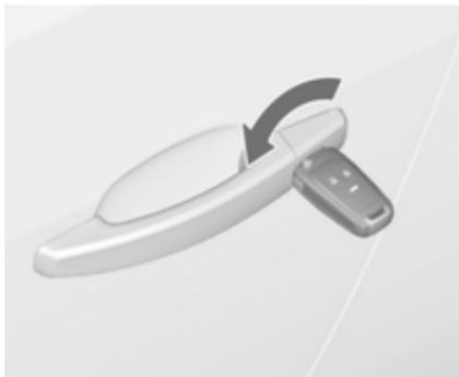
Die Fahrtür durch Drehen des Schlüssels im Schloss von Hand entriegeln. Zündung einschalten und Zentralverriegelungstaste ☒ drücken, um Beifahrertür, Laderaum und Tankklappe zu entriegeln.
