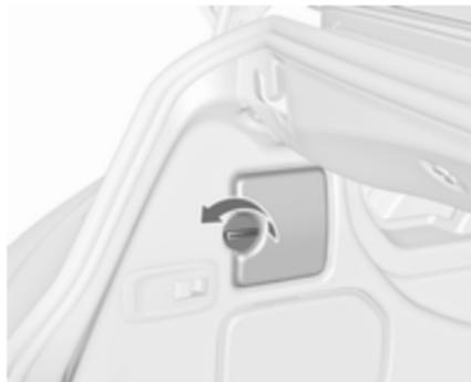
2. Abdeckung in Seitenverkleidung lösen und herausnehmen.
