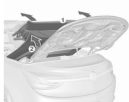
12. Verdeck am vorderen Bügel (1) anheben und gleichzeitig mit dem Spannbügel (2) auf der anderen Seite herausziehen.
