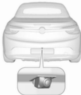
Die Kamera ist zwischen den Kennzeichenleuchten integriert und verfügt über einen Blickwinkel von 130°.
