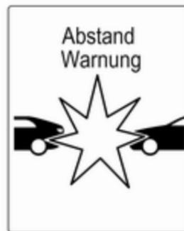
Wenn der Abstand zu einem vorausfahrenden Fahrzeug zu gering wird oder Sie sich einem anderen Fahrzeug zu schnell nähern, wird im Driver Information Center das Kollisionswarnsymbol angezeigt.
