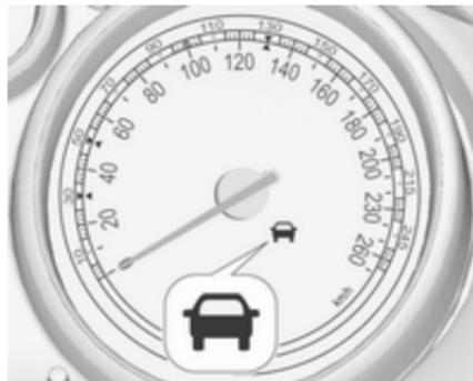
Ein vorausfahrendes Fahrzeug wird durch die Kontrollleuchte
