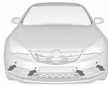
Das System besteht aus jeweils vier Ultraschall-Parksensoren im vorderen und hinteren Stoßfänger.
