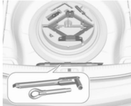
Laderaumbodenabdeckung öffnen. Wagenheber, Wagenwerkzeug und ein Gurt zur Befestigung eines beschädigten Rades befinden sich im Werkzeugkasten unter dem Reserverad im Laderaum.
