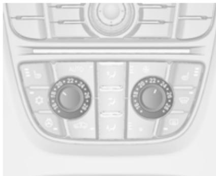
Ist die Mindesttemperatur **Lo** eingestellt, läuft die Klimaanlage mit maximaler Kühlung, sofern die Kühlung
