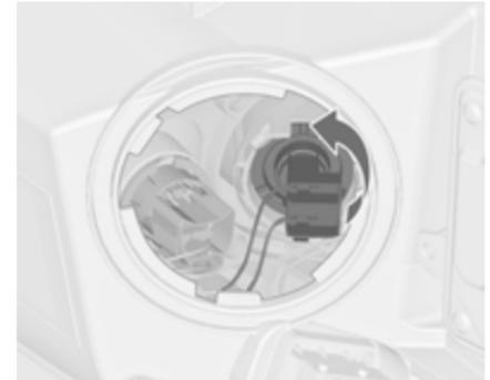
2. Die Lampenfassung durch Drehen nach links lösen. Lampenfassung aus dem Reflektor ziehen.
