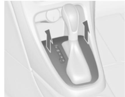
2. Die Wählhebelverkleidung vorn von der Mittelkonsole lösen, nach oben klappen und nach links drehen.
