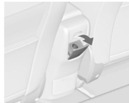
Eine weitere 12-Volt-Zubehörsteckdose befindet sich in der hinteren Konsole. Die Abdeckung nach unten klappen.
