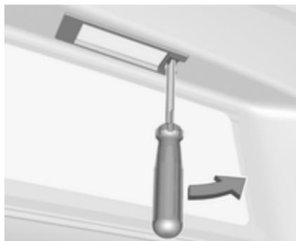
1. Schraubendreher in die Aussparung der Abdeckung einführen, zur Seite drücken und die Feder lösen.
