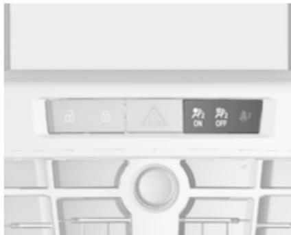
Wenn die Kontrollleuchte
