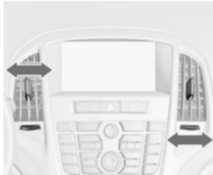
Zum Öffnen der Düse das Einstellrädchen zum größeren Symbol
