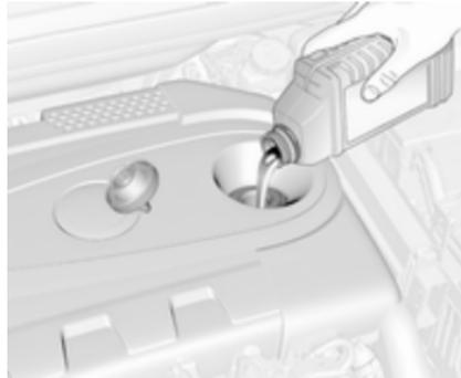
Der Motorölstand darf die obere Marke **MAX** am Messstab nicht überschreiten.
