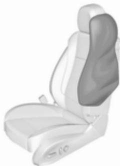
Der aufgeblähte Airbag dämpft den Aufprall, wodurch die Verletzungsgefahr für Kopf und Oberkörper bei einem Seitenaufprall deutlich verringert wird.
