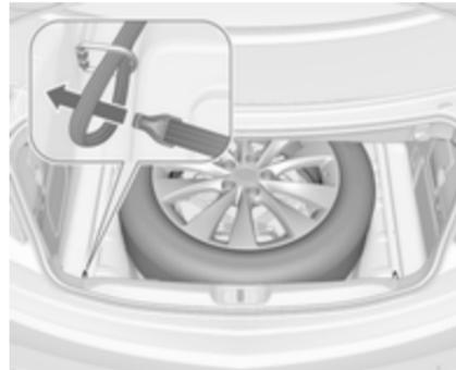
7. Das Schlaufenende des Gurtes durch die linke hintere Verzurröse führen.
