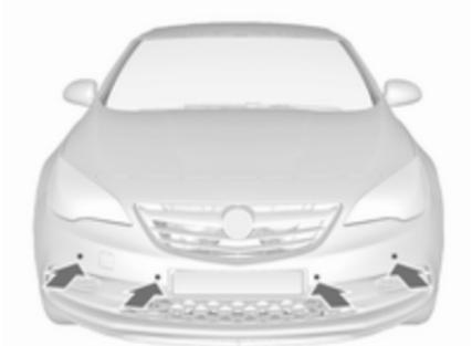
Das System besteht aus jeweils vier Ultraschall-Parksensoren im vorderen und hinteren Stoßfänger.
