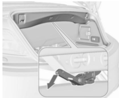
3. Auf der Innenseite der oberen Laderaumkante befindet sich ein Hebel zum Lösen der Verdeckabdeckung. Zum Entriegeln den Hebel nach unten schwenken.
