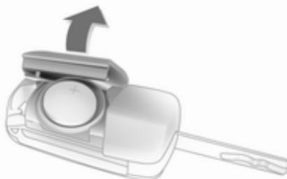
Schlüsselbart ausklappen und die Funkfernbedienung seitlich öffnen. Batterie austauschen (Batterietyp CR 2032). Die neue Batterie richtig einsetzen. Funkfernbedienung schließen und synchronisieren.
