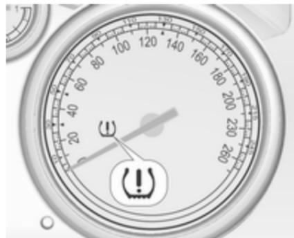
Wenn niedriger Reifendruck erkannt wird, wird dies durch das Aufleuchten der Kontrollleuchte
