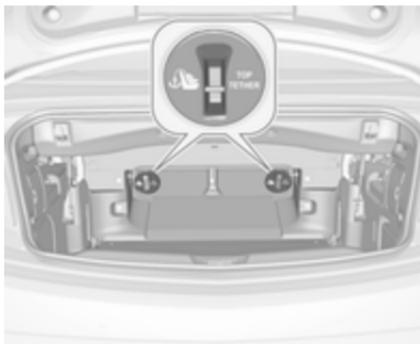
Zusätzlich zur ISOFIX-Befestigung das Top-Tether-Befestigungsband an den Top-Tether-Befestigungsösen sichern, die sich hinten an den Rücksitzlehnen befinden. Rücksitzlehnen umklappen ↗ 74.
