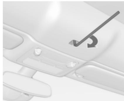
15. Den 6-mm-Inbusschlüssel in den Verschluss einführen und die Rastung verriegeln. Dazu den Inbusschlüssel bis zum Anschlag rechtsherum drehen.
