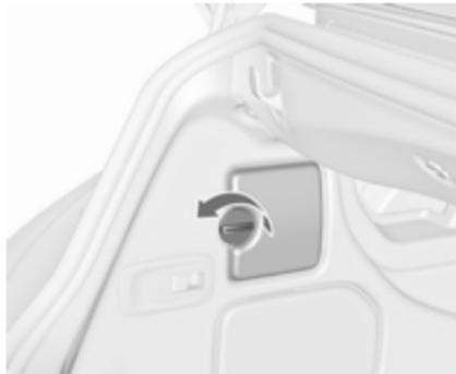
2. Abdeckung in Seitenverkleidung lösen und herausnehmen.
