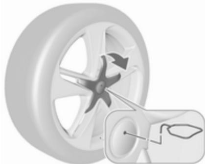
Leichtmetallräder mit Radzierkappen in der Mitte: Radzierkappe lösen. Dazu Abzieher ↪ 219 in die Aussparung des Markenemblems stecken und daran ziehen.
