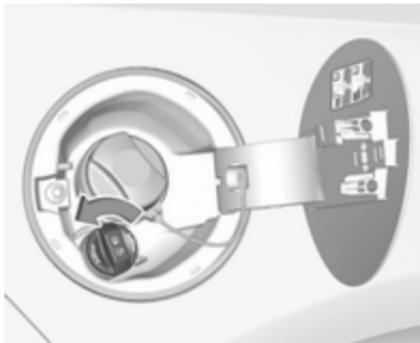
4. Die Schutzkappe vom Einfüllstutzen abschrauben.
