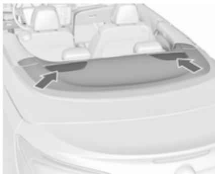
Bei einem Überschlag des Fahrzeugs, einem Frontalaufprall oder einem seitlichem Aufprall fahren die Überrollbügel innerhalb von Millise-
