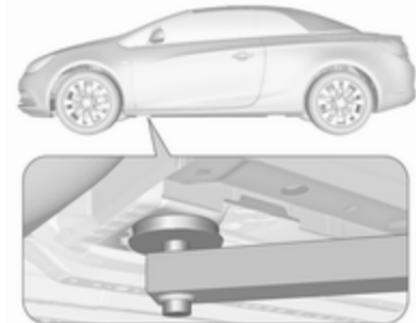
Position des vorderen Arms der Hebebühne am Unterboden.
