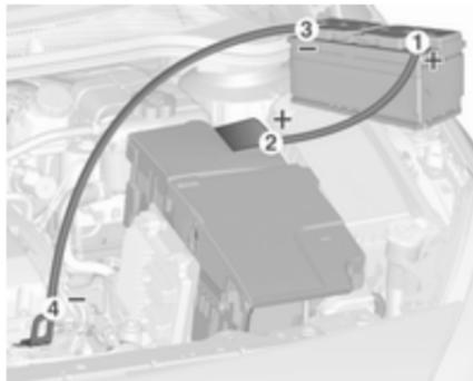
Reihenfolge für das Anschließen der Kabel:
