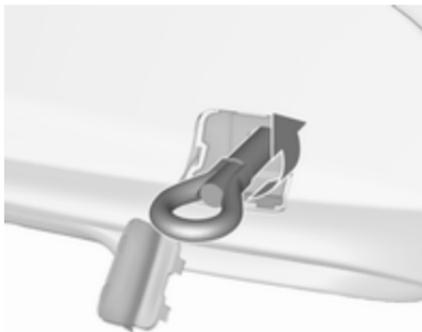
Abschleppöse gegen den Uhrzeigersinn bis zum Anschlag und mit waagerechter Endposition einschrauben.
