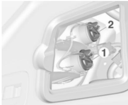
3. Die Glühlampenfassung nach links drehen, um sie zu entfernen.
