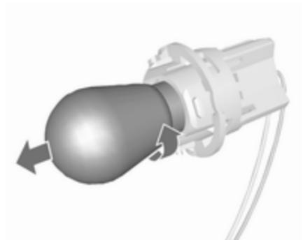
3. Lampe durch Drehen gegen den Uhrzeigersinn aus der Lampenfassung nehmen.
