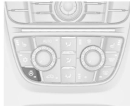
Die Heizung durch Drücken von
