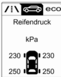
Reifendruck-Kontrollsystem durch Drehen des Einstellrädchens wählen. Systemstatus und Druckwarnungen werden mittels einer Meldung zum betreffenden Reifen im Driver Information Center angezeigt.
