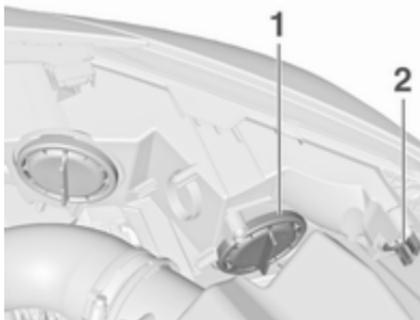
**Bi-Halogen-Scheinwerfer (1)** mit einer Lampe für Ablend- und Fernlicht.
