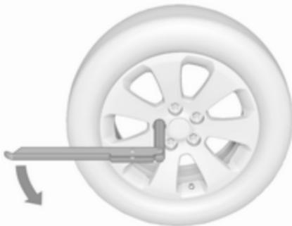
2. Radschraubenschlüssel ansetzen und sicherstellen, dass er gut sitzt. Jede Radmutter um eine halbe Drehung lösen.
