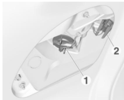
Die Glühlampenfassung nach links drehen, um sie zu entfernen.
