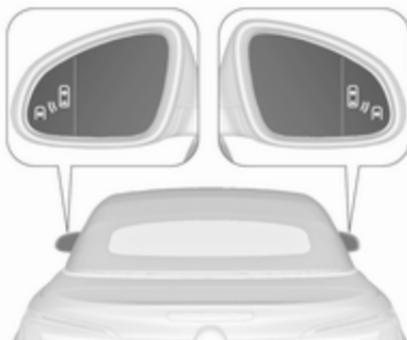
Die Funktion „Toter-Winkel-Warnung“ ist bei Geschwindigkeiten zwischen 10 km/h und 140 km/h aktiv. Bei Geschwindigkeiten über 140 km/h wird das System deaktiviert. Dies wird in beiden Außenspiegeln durch die Warnsymbole  $\text{a}^{\text{b}}$  angezeigt. Wird die Geschwindigkeit erneut reduziert, erlöschen die Warnsymbole. Wird daraufhin ein Fahrzeug im toten Winkel erkannt, leuchtet das Warnsymbol  $\text{a}^{\text{b}}$  wie üblich auf der entsprechenden Seite auf.
