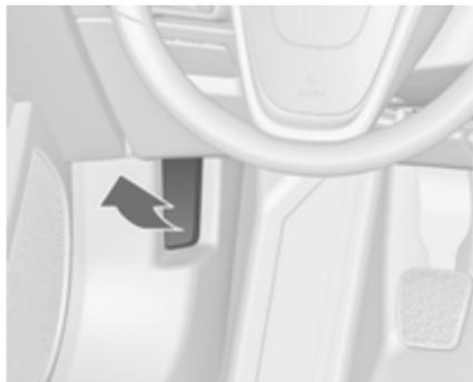
Entriegelungshebel ziehen und in die Ausgangsposition zurückführen.
