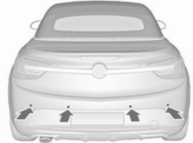
Das System besteht aus vier Ultraschall-Parksensoren im hinteren Stoßfänger.
