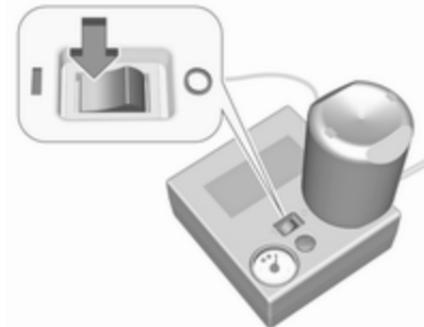
10. Wippschalter auf dem Kompressor auf I stellen. Der Reifen wird mit Dichtmittel gefüllt.
