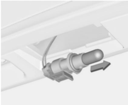
4. Die Lampe aus der Fassung ziehen und ersetzen.
