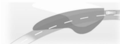
Der Lichtstrahl wird auf Basis des Lenkradwinkels und der Geschwindigkeit geschwenkt, was die Ausleuchtung von Kurven verbessert. Kontrollleuchte  $\text{☞} \text{↻} 97$ .
