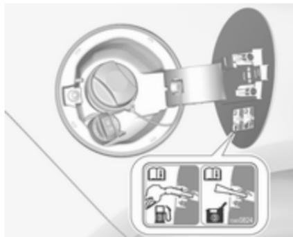
Der Fehlbetankungsschutz garantiert, dass die Klappe des Einfüllstutzens nur mit einer Tankdüse für Dieselkraftstoff oder einem Trichter für eine Notfallbetankung geöffnet werden kann.
