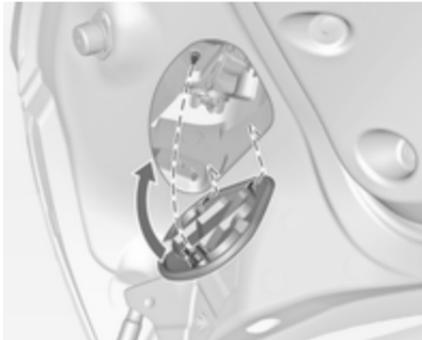
5. Die Abdeckung schließen, indem sie zuerst die Befestigungsclips einsetzen. Mit einer Münze die Schraube im Uhrzeigersinn drehen, um die Abdeckung zu verriegeln.
