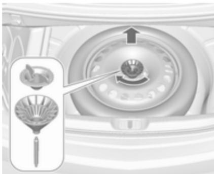
5. Den Kegel in die Öffnung des Reserverades einführen und drehen, so dass das Reserverad so weit vorne wie möglich positioniert ist. Die Flügelmutter rechts herum drehen, um das Rad zu sichern.
