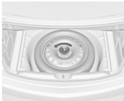
3. Das Reserverad ist mit einer Flügelmutter in der Radmulde gesichert. Die Mutter lösen, den
