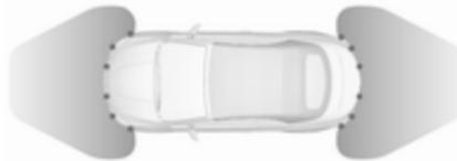
Die erweiterte Einparkhilfe führt den Fahrer durch Anweisungen im Driver Information Center und akustische
