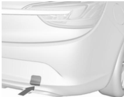
Mit einem Schraubendreher in den Schlitz an der unteren Beuge der Abdeckung fahren. Abdeckung durch vorsichtiges Abwärtsbewegen des Schraubendrehers lösen.
