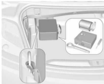
Bei einer anderen Ausführung ist das Reifenreparaturset in einer Tasche verstaut, die an der linken hinteren Verzurröse im Laderaum gesichert ist.
