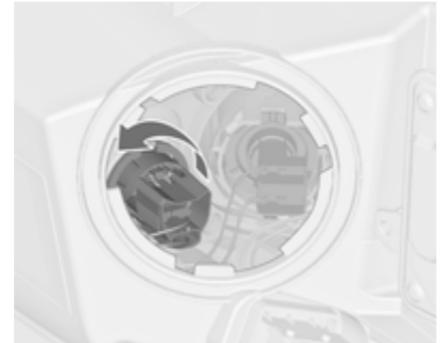
Die Abbildung zeigt die Ausführung mit adaptivem Fahrlicht. Lampenfassung gegen den Uhrzeigersinn drehen, um sie auszurasen und aus dem Reflektor zu entnehmen.
