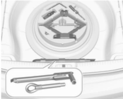
Unter dem Reserverad befinden sich ein Kasten und eine Tasche mit Wagenwerkzeug. Die Werkzeugtasche ist mit einem Halteband an der Stange der Radaufnahme gesichert. Den Werkzeugkasten und das Halteband der Werkzeugtasche von der Stange der Radaufnahme entfernen, um auf das Werkzeug in der Tasche zuzugreifen. Wagenwerkzeug ↪ 219.
