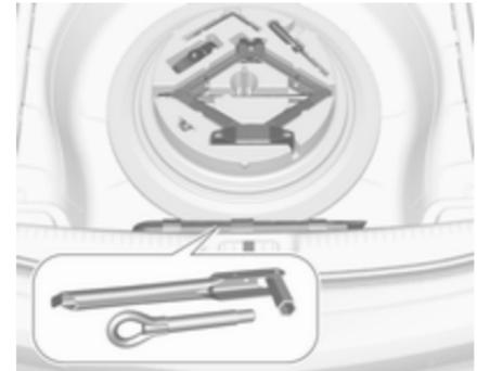
Laderaumbodenabdeckung öffnen. Wagenheber, Wagenwerkzeug und ein Gurt zur Befestigung eines beschädigten Rades befinden sich im Werkzeugkasten unter dem Reserverad im Laderaum.
