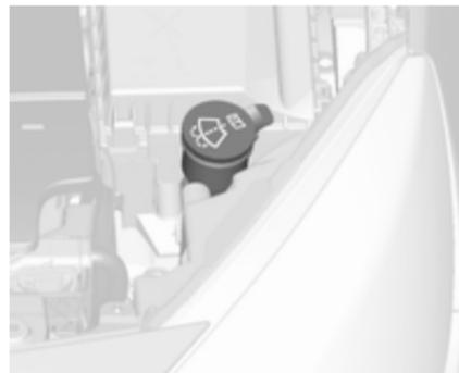
Mit einem Gemisch aus sauberem Wasser und einer geeigneten Menge zugelassener frostschutzmittelhaltiger Scheibenwaschflüssigkeit auffüllen.
