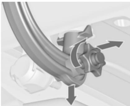
Die Schutzklappe öffnen und zum Entriegeln der Kugelstange den Schlüssel in Position
