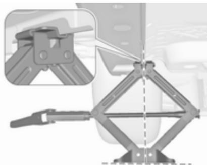
4. Wagenheber auf die erforderliche Höhe einstellen. Den Heber unmittelbar unter den Ansatzpunkt stellen und sicherstellen, dass er nicht rutschen kann.
