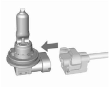
2. Die Lampenfassung durch Drücken der Haltnase vom Stecker lösen.
