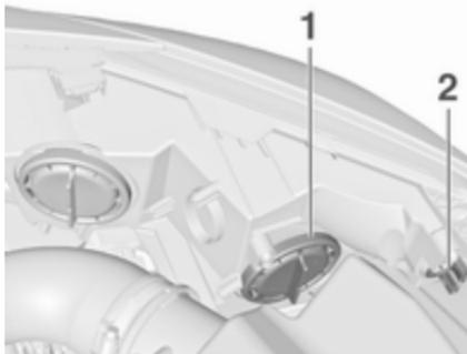
**Bi-Halogen-Scheinwerfer (1)** mit einer Lampe für Ablend- und Fernlicht.
