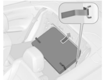
Rücksitzlehnen herunterklappen. Die feste Taschenabdeckung mit dem Laderaum ausrichten. Die Tasche von unten her an der seitlichen Führung in der Vertiefung des oberen Rahmens positionieren. Die Tasche
