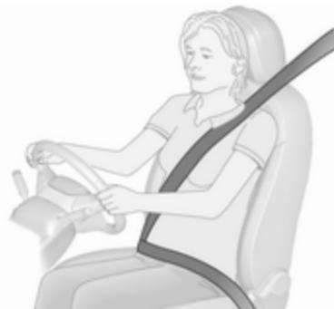
Bei starker Beschleunigung oder Verzögerung des Fahrzeugs blockieren die Sicherheitsgurte, um die Insassen in ihrer Sitzposition zu halten. Dadurch wird die Verletzungsgefahr deutlich verringert.
