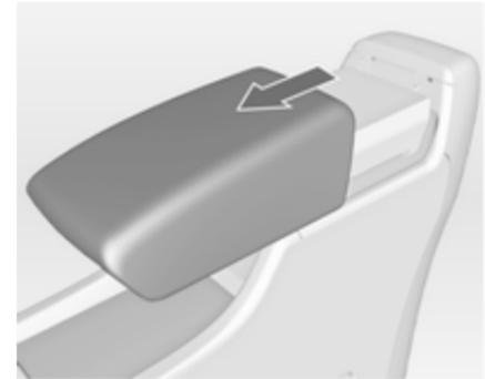
Die Armlehne kann um 10 cm nach vorn verschoben werden. Unter der Armlehne befindet sich ein Staufach. Ablagefach in der Armlehne ⇨ 74.
