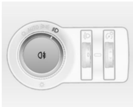
Wird durch Drücken von
