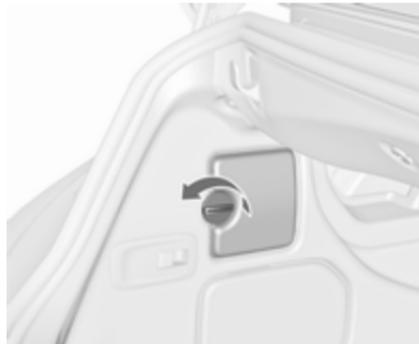
2. Abdeckung in Seitenverkleidung lösen und herausnehmen.
