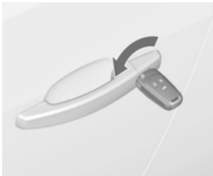
Die Fahrertür durch Drehen des Schlüssels im Schloss von Hand entriegeln. Zündung einschalten und Zentralverriegelungstaste ☒ drücken, um Beifahrertür, Laderaum und Tankklappe zu entriegeln.
