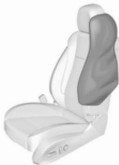
Der aufgeblähte Airbag dämpft den Aufprall, wodurch die Verletzungsgefahr für Kopf und Oberkörper bei einem Seitenaufprall deutlich verringert wird.
