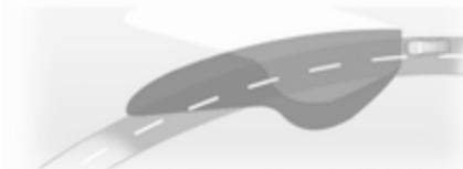
Der Lichtstrahl wird auf Basis des Lenkradwinkels und der Geschwindigkeit geschwenkt, was die Ausleuchtung von Kurven verbessert. Kontrollleuchte ☞ ↻ 98.
