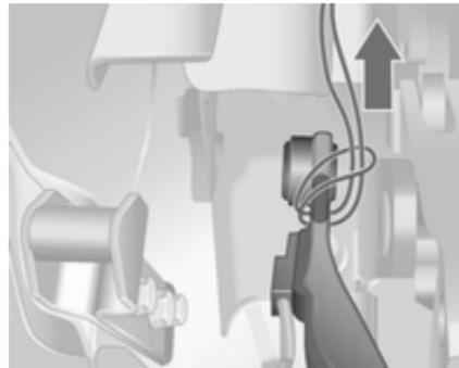
10. Die befestigten Schnüre um die markierten Positionen am Scharnier auf beiden Seiten festziehen und das Schnurende durch die Schlaufe ziehen. Siehe Abbildung.
