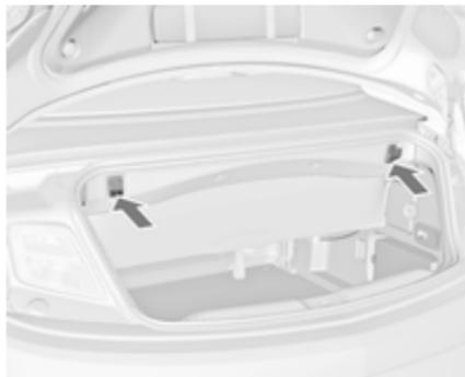
Die Haken am oberen Rand des Laderaums können für Tragetaschen verwendet werden. Maximales Tragvermögen: 5 kg.
