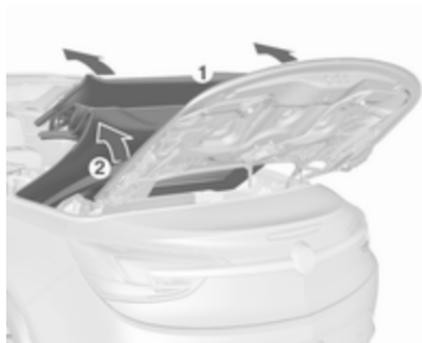
12. Verdeck am vorderen Bügel (1) anheben und gleichzeitig mit dem Spannbügel (2) auf der anderen Seite herausziehen.
