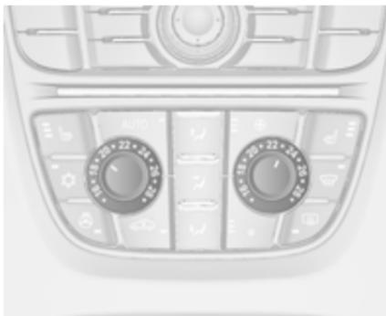
Ist die Mindesttemperatur **Lo** eingestellt, läuft die Klimaanlage mit maximaler Kühlung, sofern die Kühlung
