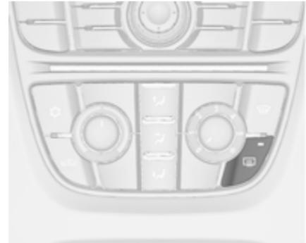
Wird durch Drücken von
