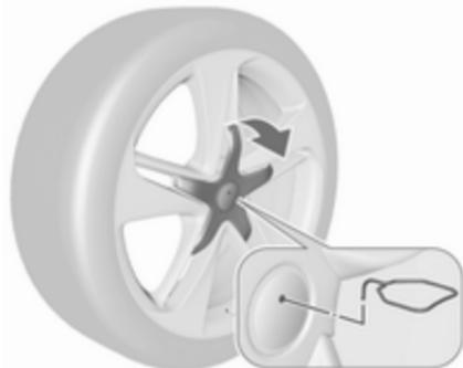
Leichtmetallräder mit Radzierkappen in der Mitte: Radzierkappe lösen. Dazu Abzieher ↪ 221 in die Aussparung des Markenemblems stecken und daran ziehen.
