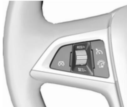
☺ drücken. Wenn zuvor der Geschwindigkeitsregler aktiv war, wird dieser beim Aktivieren des Geschwindigkeitsbegrenzers ausgeschaltet. Die Kontrollleuchte ☺ erlischt.
