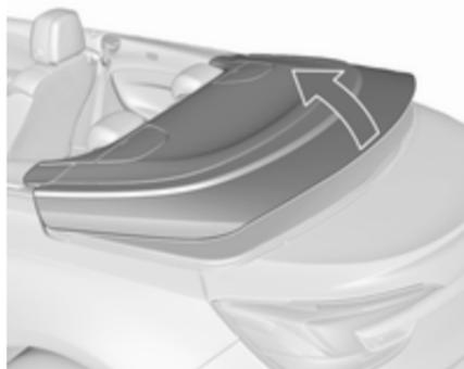
5. Verdeckabdeckung gleichzeitig an beiden Seiten etwa bis in die mittlere Stellung anheben.
