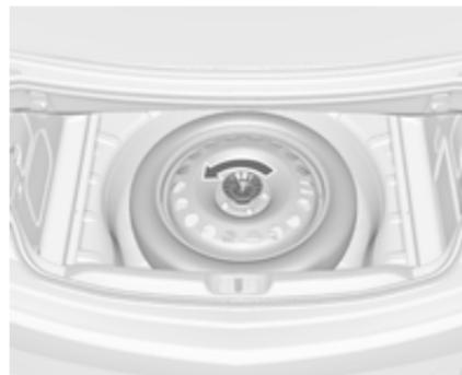
3. Das Reserverad ist mit einer Flügelmutter in der Radmulde gesichert. Die Mutter lösen, den Kegel entfernen und das Reserverad entfernen.
