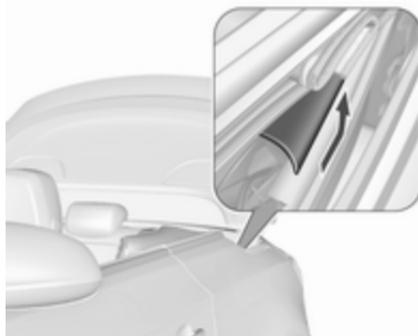
8. Kunststoffabdeckungen an beiden Seiten drücken und nach hinten schieben, um sie zu entfernen. Siehe Abbildung.
