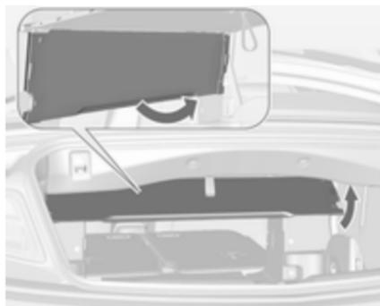
Für den Transport von langen Gegenständen kann die Durchreichklappe zwischen Laderaum und Fahrgastraum geöffnet werden:
