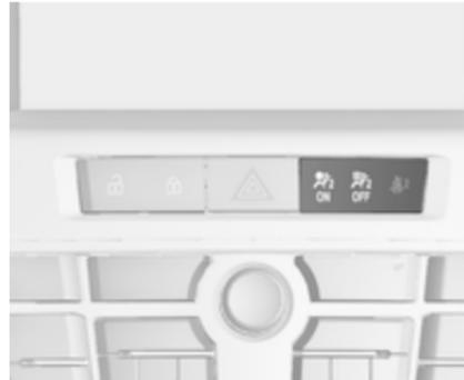
Wenn die Kontrollleuchte
