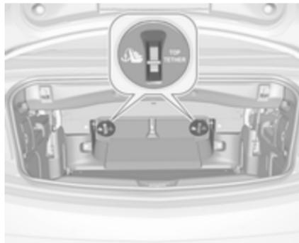
Zusätzlich zur ISOFIX-Befestigung das Top-Tether-Befestigungsband an den Top-Tether-Befestigungsösen sichern, die sich hinten an den Rücksitzlehnen befinden. Rücksitzlehnen umklappen ↷ 75.
