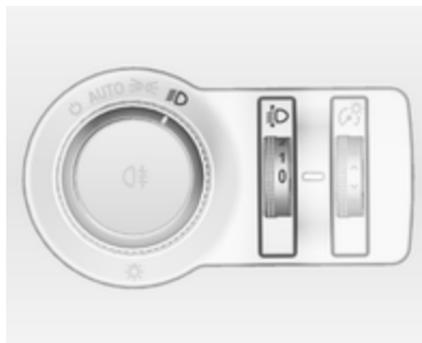
Zur Anpassung der Leuchtweite an die Fahrzeugbeladung, um Blendwirkung zu reduzieren: Daumenrad
