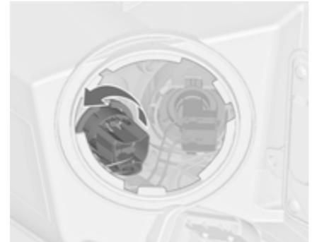
Die Abbildung zeigt die Ausführung mit adaptivem Fahrlicht. Lampenfassung gegen den Uhrzeigersinn drehen, um sie auszurasten und aus dem Reflektor zu entnehmen.
