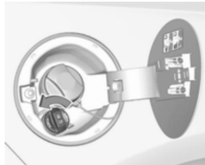
4. Die Schutzkappe vom Einfüllstutzen abschrauben.
