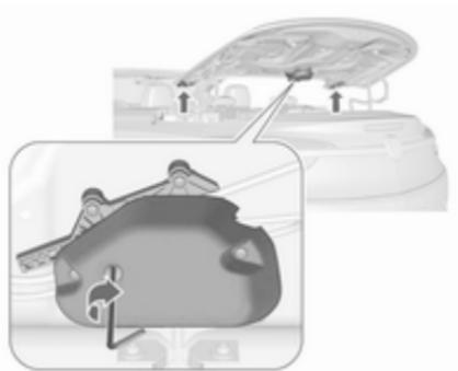
6. Den 4-mm-Inbusschlüssel in die markierte Position an der Klappenantriebseinheit einführen. Den Inbusschlüssel bis zum Anschlag rechtsherum drehen, bis die seitlichen Klappen eingeschwenkt sind.
