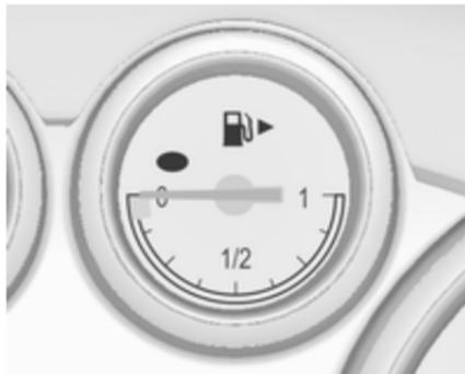
Zeigt den Kraftstoffstand im Tank an. Bei geringem Füllstand leuchtet die Kontrollleuchte ●. Bei blinkender Kontrollleuchte umgehend tanken. Tank nie leer fahren.
