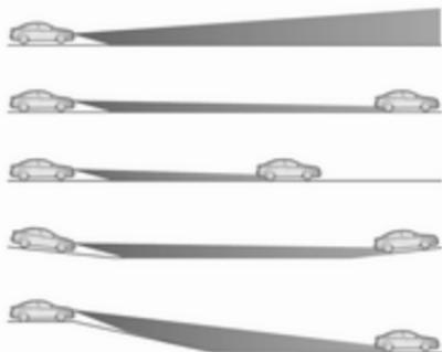
Eine spezielle topografische Bewertungsfunktion erkennt vorausfahrende Fahrzeuge an Steigungen oder Gefällen, indem es die Bewegung der Rückleuchten auswertet. Das System passt die Leuchtweithöhe so an, dass die Straße optimal ausgeleuchtet wird, ohne andere Verkehrsteilnehmer zu blenden.
