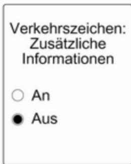
Wenn die Einstellungsseite angezeigt wird, **Aus** auswählen, um die Warnfunktion zu deaktivieren. Durch Auswahl von **An** wird sie wieder eingeschaltet.
