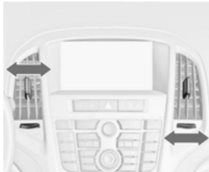
Zum Öffnen der Düse das Einstellrädchen zum größeren Symbol ■ drehen. Die Einstellung der Luftmenge am Düsenausgang erfolgt durch Drehen des Einstellrädchens.
