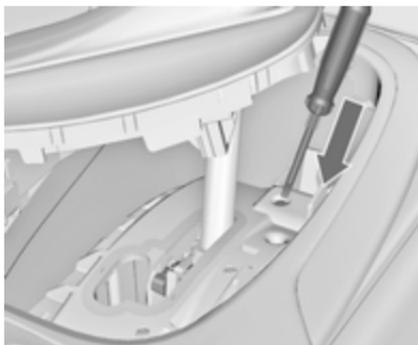
3. Schraubendreher so weit wie möglich in die Öffnung einführen und den Wählhebel aus der Stellung **P** bzw. **N** bewegen. Wenn **P** bzw. **N** wieder eingelegt wird, wird der Wählhebel wieder in dieser Stellung gesperrt. Ursache der Stromunterbrechung von einer Werkstatt beheben lassen.
