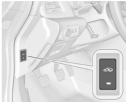
Die Überwachung der Fahrgastzelle und der Fahrzeugneigung ausschalten, wenn z. B. Haustiere im Fahrzeug zurückbleiben, weil der Alarm mit starken Ultraschallsignalen arbeitet und Bewegungen den Alarm auslösen können. Auch ausschalten, wenn das Fahrzeug auf einer Fähre oder einem Zug transportiert wird.
