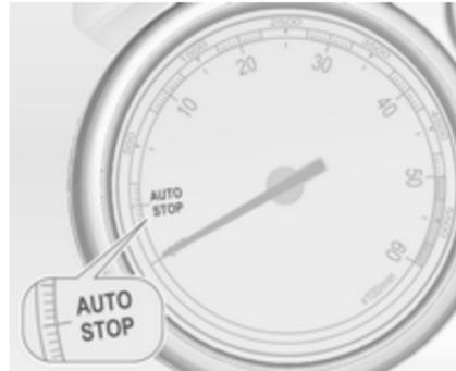
Ein Autostopp wird auf dem Drehzahlmesser angezeigt, indem die Nadel auf der Position **AUTOSTOP** steht.
