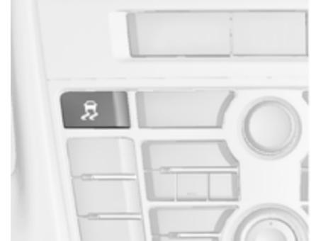
Die Traktionskontrolle kann ausgeschaltet werden, wenn ein Durchdrehen der Antriebsräder erwünscht ist:
