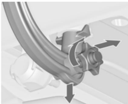
Die Schutzklappe öffnen und zum Entriegeln der Kugelstange den Schlüssel in Position
