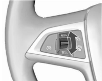
Bei aktiviertem Geschwindigkeitsbegrenzer das Daumenrad auf Position **RES/+** gedreht halten oder wiederholt auf Position **RES/+** drehen, bis die gewünschte Höchstgeschwindigkeit im Fahrerinformationszentrum angezeigt wird.
