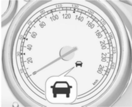
Ein vorausfahrendes Fahrzeug wird durch die Kontrollleuchte
