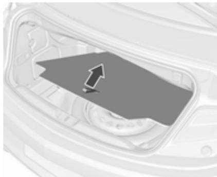
Die hintere Bodenabdeckung kann angehoben und entfernt werden. Unter der Abdeckung befinden sich das Reserverad, das Wagenwerkzeug oder das Reifenreparaturset.
