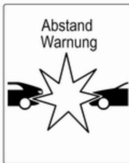
Wenn der Abstand zu einem vorausfahrenden Fahrzeug zu gering wird oder Sie sich einem anderen Fahrzeug zu schnell nähern, wird im Driver Information Center das Kollisionssymbol angezeigt.
