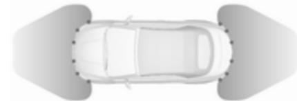
Die erweiterte Einparkhilfe führt den Fahrer durch Anweisungen im Driver Information Center und akustische
