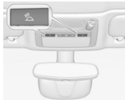
Wird durch Drücken von ☀ und ☀/ in der Innenbeleuchtung bedient.
