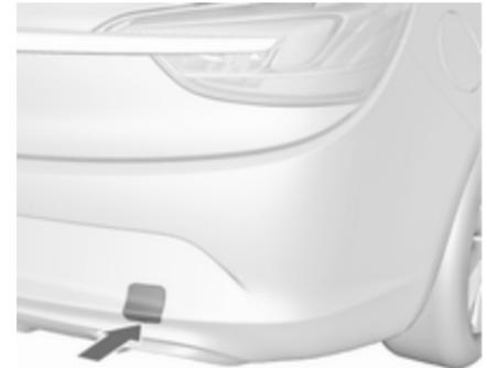
Mit einem Schraubendreher in den Schlitz an der unteren Beuge der Abdeckung fahren. Abdeckung durch vorsichtiges Abwärtsbewegen des Schraubendrehers lösen.
