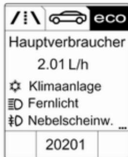
derzeit eingeschalteten Komfortfunktionen in absteigender Reihenfolge auf. Die mögliche Kraftstoffersparnis wird angezeigt. Wird ein Verbraucher ausgeschaltet, so wird er aus der Liste gelöscht und der Verbrauchswert wird aktualisiert.
