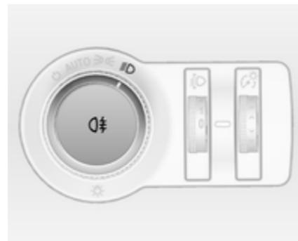
Wird durch Drücken von  $\text{D☞}$  bedient.
