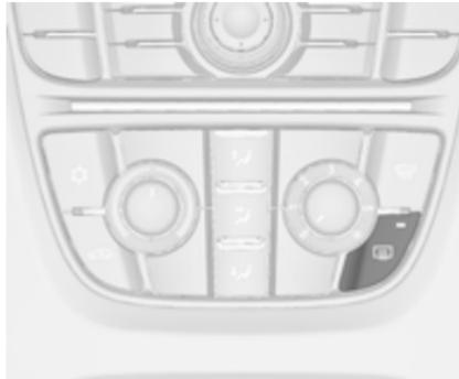
Die Heizung wird durch Drücken von
