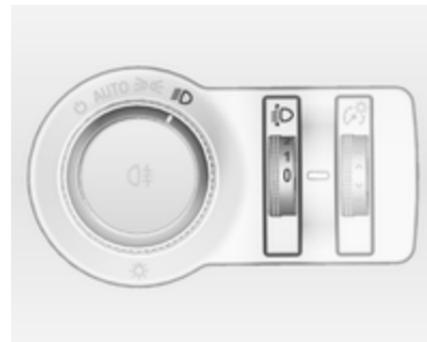
Zur Anpassung der Leuchtweite an die Fahrzeugbeladung, um Blendwirkung zu reduzieren: Daumenrad
