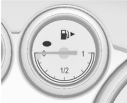
Zeigt den Kraftstoffstand im Tank an. Bei geringem Füllstand leuchtet die Kontrollleuchte
