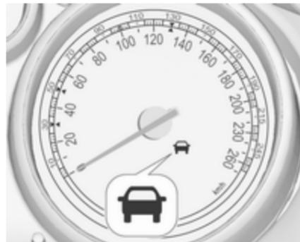
Ein vorausfahrendes Fahrzeug wird durch die Kontrollleuchte
