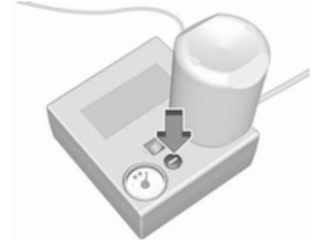
Wird der vorgeschriebene Reifendruck nicht innerhalb von 10 Minuten erreicht, Reifenreparaturset entfernen. Das Fahrzeug um eine Reifenumdrehung bewegen. Das Reifenreparaturset
