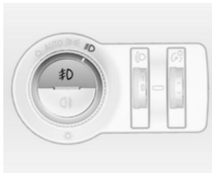
Wird durch Drücken von  $\text{☞D}$  bedient.
