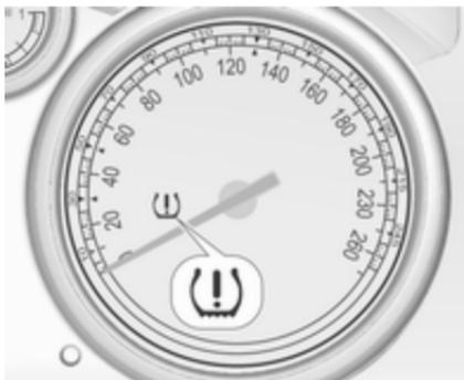
Wenn niedriger Reifendruck erkannt wird, wird dies durch das Aufleuchten der Kontrollleuchte (⚠) gemeldet ⇨ 96.
