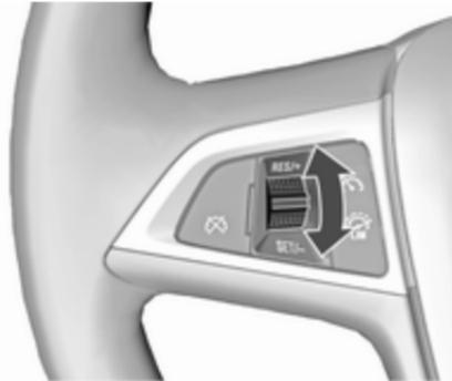
Bei aktiviertem Geschwindigkeitsbegrenzer das Daumenrad auf Position **RES/+** gedreht halten oder wiederholt auf Position **RES/+** drehen, bis die gewünschte Höchstgeschwindigkeit im Fahrerinformationszentrum angezeigt wird.
