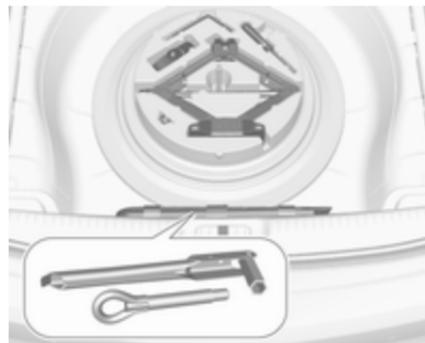
Unter dem Reserverad befinden sich ein Kasten und eine Tasche mit Wagenwerkzeug. Die Werkzeugtasche ist mit einem Halteband an der Stange der Radaufnahme gesichert. Den Werkzeugkasten und das Halteband der Werkzeugtasche von der Stange der Radaufnahme entfernen, um auf das Werkzeug in der Tasche zuzugreifen. Wagenwerkzeug ↻ 221.
