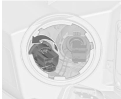
Die Abbildung zeigt die Ausführung mit adaptivem Fahrlicht. Lampenfassung gegen den Uhrzeigersinn drehen, um sie auszurasen und aus dem Reflektor zu entnehmen.
