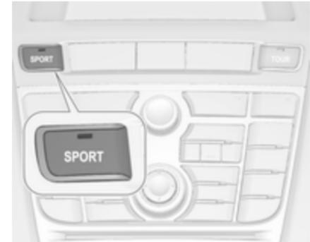
Die Systemeinstellungen werden an einen sportlicheren Fahrstil angepasst.
