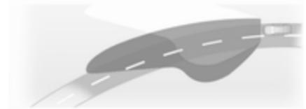
Der Lichtstrahl wird auf Basis des Lenkradwinkels und der Geschwindigkeit geschwenkt, was die Ausleuchtung von Kurven verbessert. Kontrollleuchte  $\text{⌘}$   $\text{↻}$  97.
