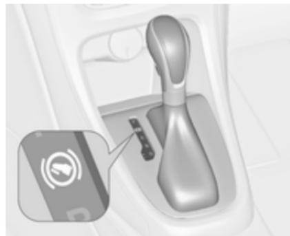
Bei nicht betätigtem Bremspedal leuchtet die Kontrollleuchte
