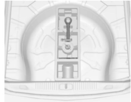
Wagenwerkzeug und die Abschleppöse sind in einem Werkzeugkasten untergebracht, der sich unter der Bodenabdeckung im Laderaum befindet.
