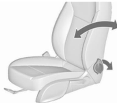
Hebel nach hinten bewegen, Neigung einstellen und Hebel loslassen. Die Rückenlehne muss hörbar einrasten.
