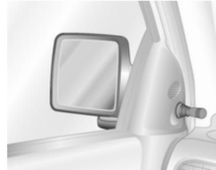
Spiegel durch Schwenken des Hebels in die gewünschte Richtung einstellen.
