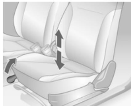
Hebel nach oben ziehen und Sitzfläche entlasten bzw. Sitz durch das Körpergewicht nach unten drücken.
