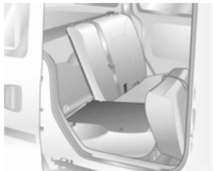
Zum Umklappen einer oder beider Rücksitzlehnen diese durch Druck auf die Taste oben an der Sitzlehne entriegeln und nach vorne klappen.
