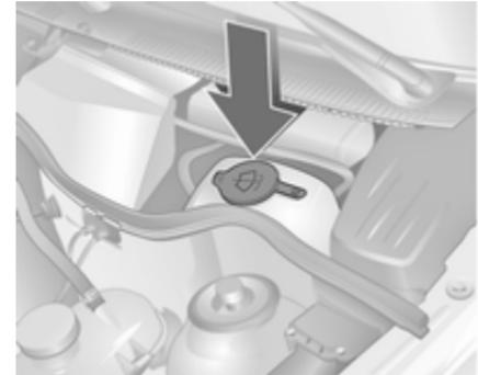
Mit einem Gemisch aus sauberem Wasser und einer geeigneten Menge frostschutzmittelhaltiger Waschflüssigkeit auffüllen. Das richtige Mischverhältnis ist auf dem Waschflüssigkeitsbehälter angegeben.
