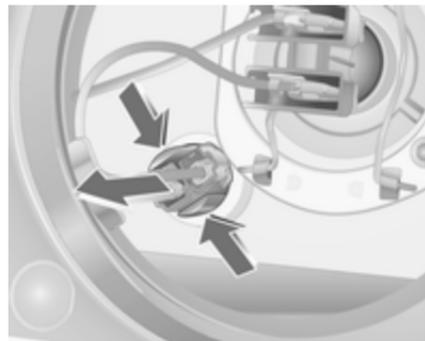
3. Glühlampe aus dem Reflektor nehmen und neue Glühlampe einsetzen.
