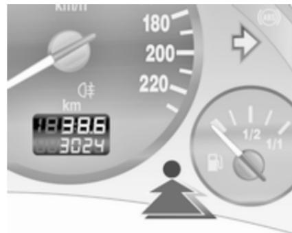
Bei ausgeschalteter Zündung wird der Kilometerstand nach kurzem Druck auf den Stellknopf ca. 15 Sekunden lang angezeigt.
