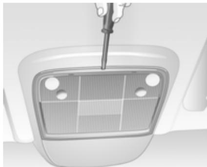
1. Streuscheibe mit einem Schraubenzieher lösen und abnehmen.
