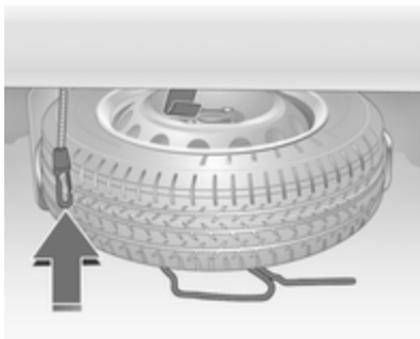
Bei Unterbringung eines vollwertigen Rades darf der Abstandsring nicht zwischen Rad und Fahrzeugboden gelegt werden.
