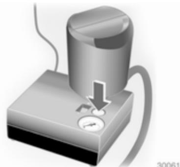
Wird der vorgeschriebene Reifendruck nicht innerhalb von 10 Minuten erreicht, das Reifenreparaturset entfernen. Das Fahrzeug um eine Reifenumdrehung bewegen. Das Reifenreparaturset wieder anschließen und den Füllvorgang für 10 Minuten fortsetzen. Wird der vorgeschriebene Reifendruck danach immer noch nicht erreicht, ist der Reifen zu stark beschädigt. Hilfe einer Werkstatt in Anspruch nehmen. Zu hohen Reifendruck mit der Taste über der Druckanzeige ablassen.
