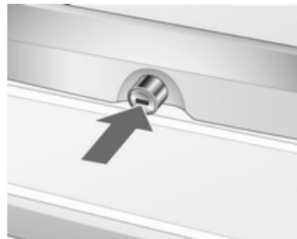
Zum Entriegeln der Hecktür den Schlüssel in waagerechte Stellung drehen oder Taste
