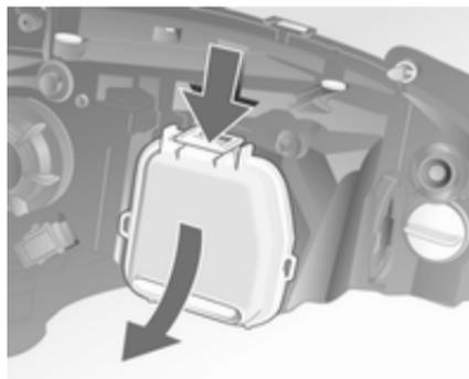
3. Federklammer zum Lösen zur Seite schwenken.
