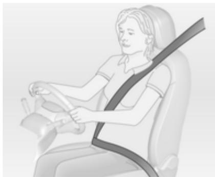
Bei starkem Beschleunigen oder Bremsen des Fahrzeugs blockieren die Sicherheitsgurte aus Gründen der Sicherheit für die Insassen.
