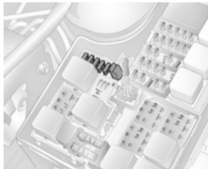
Ersatzsicherungen in dem dafür vorgesehenen Bereich im Sicherungskasten unterbringen. Rechts dane-
