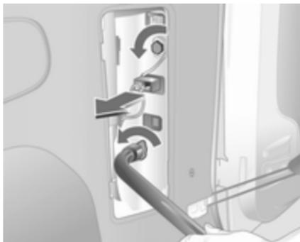
2. Kabelstecker von Lampenträger abziehen.
