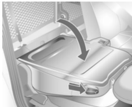
Zur Vergrößerung des Laderaumes kann das Gitter auf der Beifahrerseite vorgeschwenkt werden.
