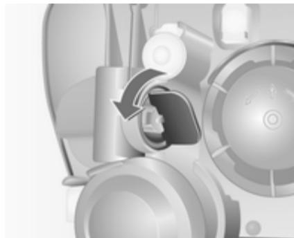
1. Lampenträger links herumdrehen und ausrasten.
