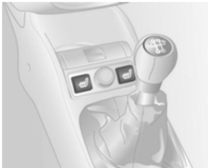
Bei eingeschalteter Zündung Sitzheizung durch Drücken der entsprechenden Taste
