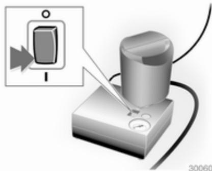
11. Wippschalter auf dem Kompressor auf **I** stellen. Der Reifen wird mit Dichtmittel gefüllt.
