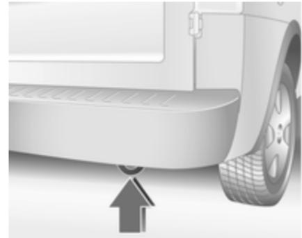
Abschleppseil oder besser Abschleppstange an der hinteren Abschleppöse rechts am Fahrzeugunterbau befestigen, keinesfalls an der Hinterachse.
