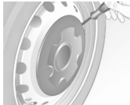
Radabdeckung mit dem Haken abziehen. Wagenwerkzeug ↷ 121.
