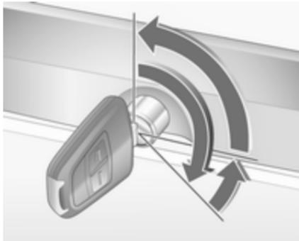
Schlüssel aus der Senkrechten oder Waagerechten soweit wie möglich über den Widerstand hinaus nach rechts drehen. Zum Schutz gegen Aussperren lässt sich der Schlüssel in dieser Stellung nicht abziehen.
