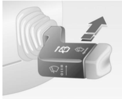
Hebel nach vorn drücken. Der Heckscheibenwischer wischt im Intervallbetrieb. Durch Ziehen des Hebels ausschalten.
