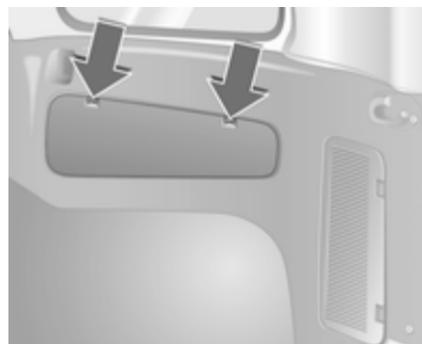
Wagenheber und Wagenwerkzeug befinden sich im Staufach rechts in der Seitenverkleidung.
