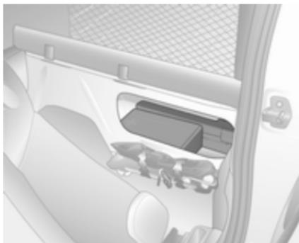
Die Verbandstasche (Kissen) befindet sich im Fach hinter dem Fahrersitz. Beim Beladen des Fahrzeugs darauf achten, dass nichts über die Unterkante der Öffnung hinausragt. Abdeckklappe durch Drücken der Sperrzunge ausrasten und abnehmen.
