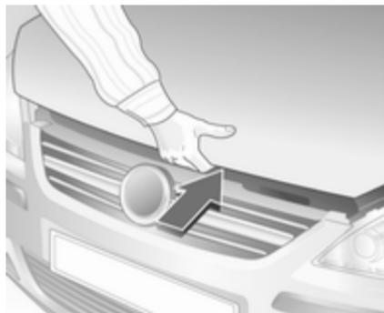
Sicherungsgriff hochdrücken und Motorhaube öffnen.
