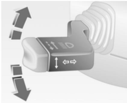
Hebel nach oben = Blinker rechts
