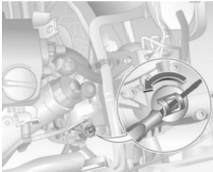
Muss das Fahrzeug aus dem fließenden Verkehr entfernt werden, wie folgt auskuppeln:
