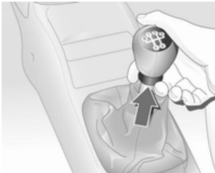
Rückwärtsgang: Nach dem Treten des Kupplungspedals bei stehendem Fahrzeug 3 Sekunden warten, dann den Ring unter dem Wählhebel hochziehen und den Gang einlegen.
