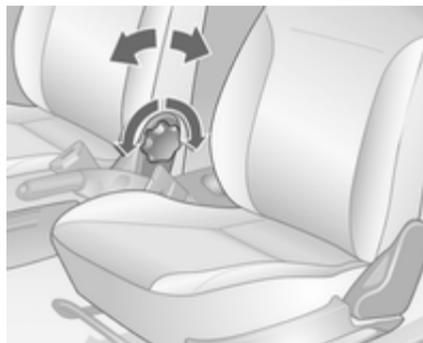
Handrad drehen. Zum Einstellen Rückenlehne entlasten.
