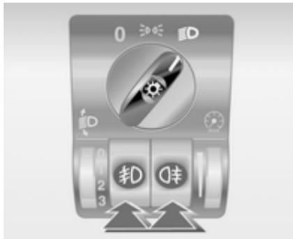
Die Nebelscheinwerfer lassen sich nur bei eingeschalteter Zündung und eingeschalteten Scheinwerfern oder Seitenleuchten einschalten.
