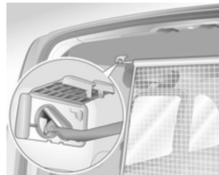
Im Dachrahmen befinden sich zwei Einbauöffnungen: Abdeckung öffnen. Eine Seite der oberen Netzstange auf
