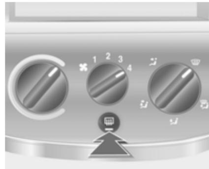
Wird durch Drücken der Taste
