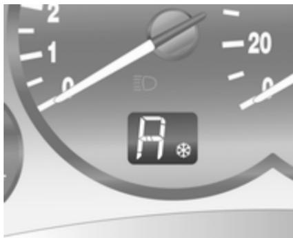
Im Getriebe-Display werden Modus oder gewählter Gang angezeigt.
