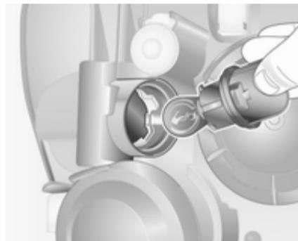
2. Glühlampe etwas in die Fassung hineindrücken, links herumdrehen und herausnehmen. Neue Glühlampe einsetzen.
