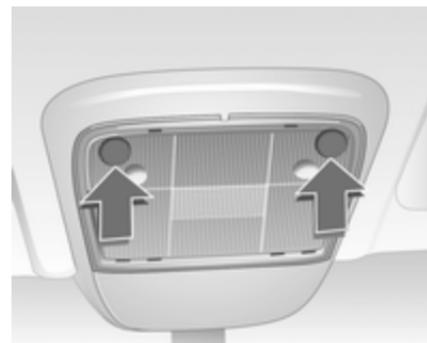
Betätigung mit Taste bei eingeschalteter Zündung.
