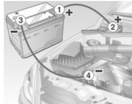
Reihenfolge für das Anschließen der Kabel:
