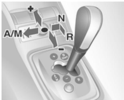
Den Wählhebel immer bis zum Anschlag in die entsprechende Richtung führen.
