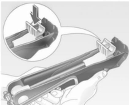
Die Kante des Wagenheberfußes muss senkrecht unter dem Ansatzpunkt rutschfest auf dem Boden stehen. Kurbel drehen, bis das Rad vom Boden abhebt.
