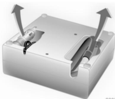
3. Stromkabel und Luftschlauch aus den Staufächern auf der Unterseite des Kompressors herausnehmen.
