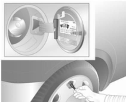
Reifendruck ⇨ 152 und auf dem Aufkleber an der Innenseite der Tankklappe.
