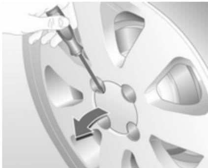
Diebstahlgesicherte Leichtmetallräder: Radschraubenabdeckung mit Sicherungsschlüssel abschrauben und abnehmen. Wagenwerkzeug ↷ 121.
