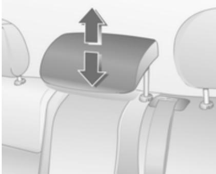
Zum Umlegen der Rücksitzlehne Kopfstütze ganz nach unten schieben. Dazu die Rastfedern an den Führungshülsen durch Drücken entriegeln.
