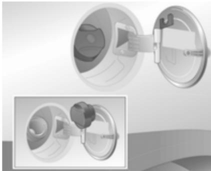
Tankdeckel mit Zündschlüssel aufschließen, aufdrehen und abnehmen. Der Tankdeckel kann in die Halterung auf der Tankklappe eingehängt werden.
