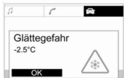
Bei Fahrzeugen mit Graphic-Info-Display wird zur Warnung vor vereister Fahrbahn eine Warnmeldung im Display angezeigt. Unter  $-5\text{ }^{\circ}\text{C}$  erscheint keine Meldung.
