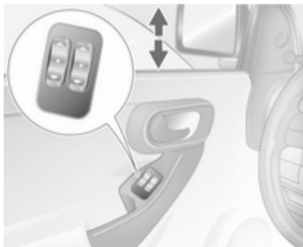
Zum stufenweisen Bewegen des Fensters Wippschalter betätigen. Zum automatischen Öffnen oder Schließen den Schalter etwas länger gedrückt halten; zum Stoppen der Fensterbewegung Wippschalter erneut betätigen.
