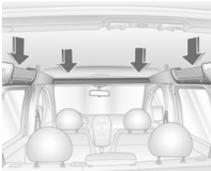
Das Ablagefach über den Vordersitzen nur mit maximal 15 kg belasten.
