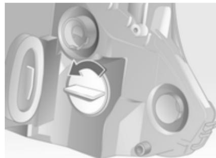
1. Lampenträger links herumdrehen und ausrasten.
