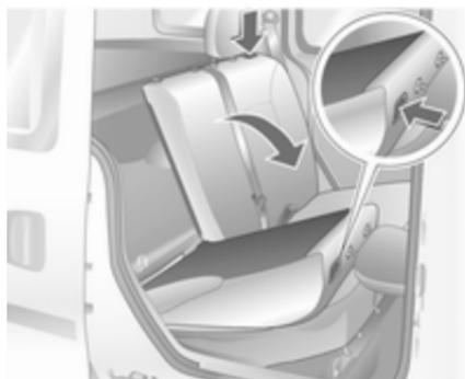
Hintere äußere Kopfstütze ganz nach unten schieben oder ausbauen. Hintere mittlere Kopfstütze ganz nach unten schieben ↻ 34.
