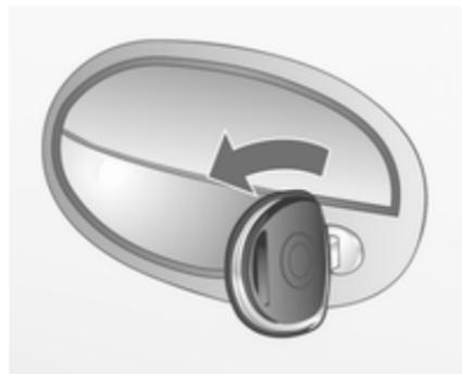
Schlüssel im Fahrtürschloss in Richtung Fahrzeugvorderseite drehen.
