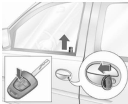
Schlüssel im Fahrertürschloss nach vorn drehen oder die Taste
