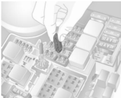
Eine defekte Sicherung ist am durchgebrannten Schmelzfaden erkennbar. Sicherung nur dann ersetzen, wenn die Ursache für die Störung behoben wurde.
