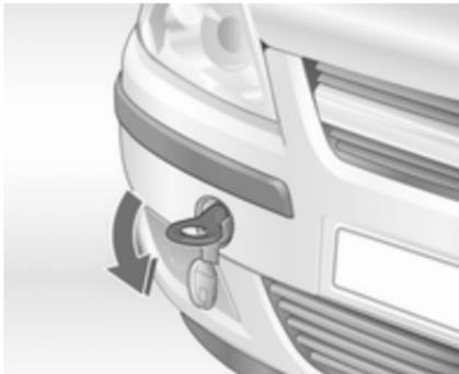
Abschleppseil – besser Abschleppstange – an der Abschleppöse befestigen.
