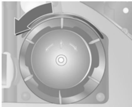
1. Den Fernlicht-Schutzdeckel nach links drehen und abnehmen.
