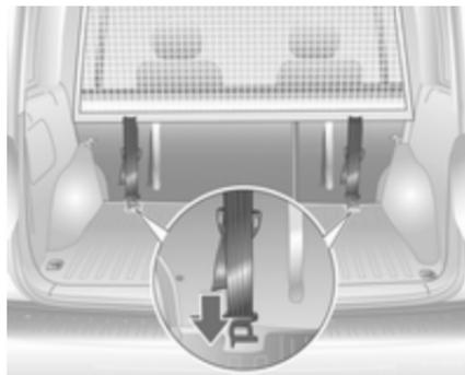
Beide Rücksitzlehnen vorklappen. Spanngurte in Verzurrösen am Boden einhängen und durch Zug am losen Ende des Bandes spannen. Rücksitzlehnen aufrichten und einrasten.
