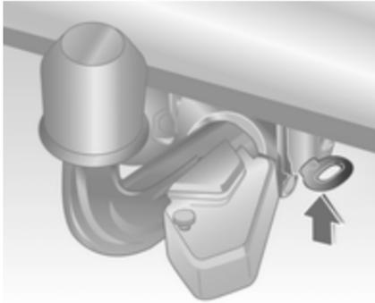
Vor Montage eines Anhängers die Kugel der Anhängerkupplung schmieren. Nicht jedoch, wenn zur Verringerung der Schlingerbewegung des Anhängers ein Stabilisator verwendet wird, der auf den Kugelkopf wirkt.
