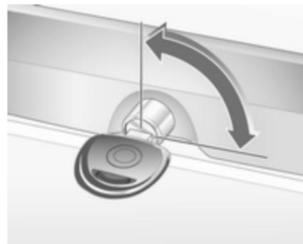
Die Zentralverriegelung und die Diebstahlsicherung der Türen lassen sich nicht über das Schloss der Hecktür betätigen.
