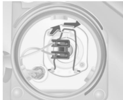
3. Federklammer nach vorn schieben und zur Seite schwenken, um sie aus der Halterung zu lösen.
