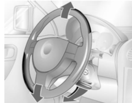
Griff entriegeln, Höhe einstellen, Griff einrasten und darauf achten, dass er richtig verriegelt ist. Lenkrad nur bei stehendem Fahrzeug und gelöster Lenkradsperre einstellen.
