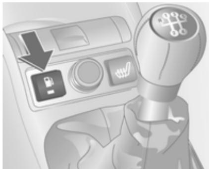
Durch Drücken der Taste
