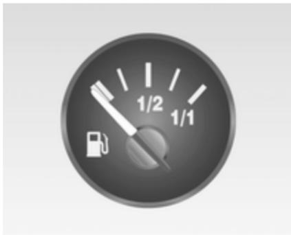
Das Anzeigeelement zeigt je nach Betriebsart den Tankdruck bzw. den Benzinfüllstand an.
