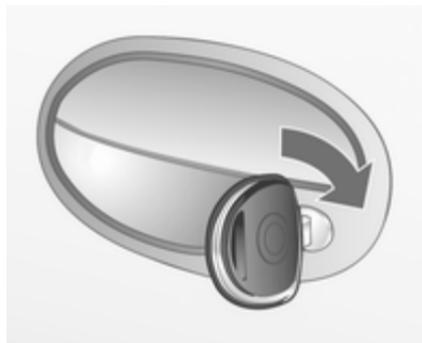
Schlüssel im Fahrertürschloss in Richtung Fahrzeugheck drehen.
