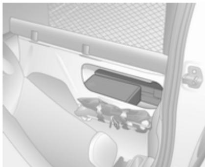
Das Warndreieck befindet sich im Fach hinter dem Fahrersitz. Beim Beladen des Fahrzeugs darauf achten, dass nichts über die Unterkante der Öffnung hinausragt. Abdeckklappe durch Drücken der Sperrzunge ausrasten und abnehmen.
