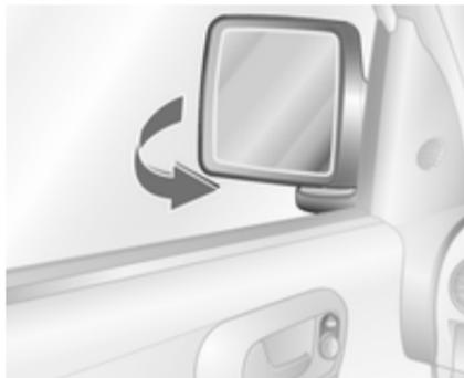
Zur Sicherheit von Fußgängern klappen die Außenspiegel bei Anstoßen aus ihrer Ausgangslage. Spiegel durch leichten Druck auf das Spiegelgehäuse wieder einrasten.
