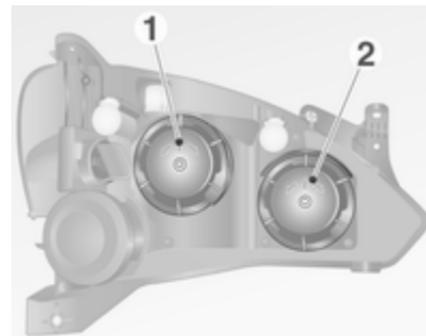
Scheinwerfer haben getrennte Systeme für Abblendlicht **1** (äußere Lampen) und Fernlicht **2** (innere Lampen).
