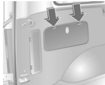
Das Warndreieck befindet sich in einem Fach in der linken Seitenverkleidung.
