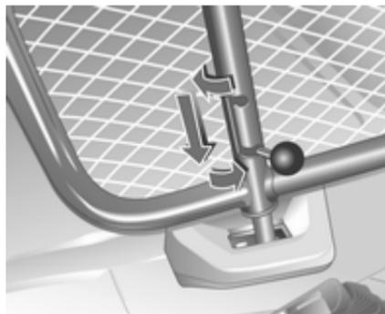
Laderaumgitter in Aufnahme verriegeln. Dazu Hebel in unterer Stellung einrasten.
