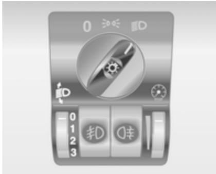
Leuchtweite bei eingeschaltetem Abblendlicht der Fahrzeugbelastung zur Vermeidung von Blendung anpassen: Rändelrad auf gewünschte Position drehen.
