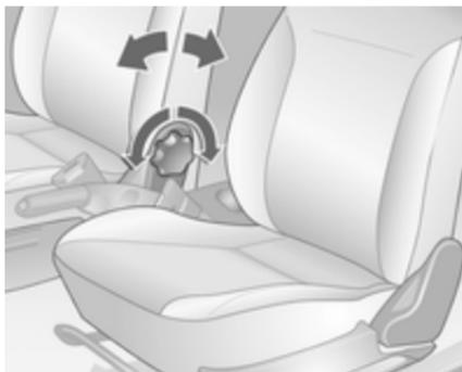
Handrad drehen. Zum Einstellen Rückenlehne entlasten.
