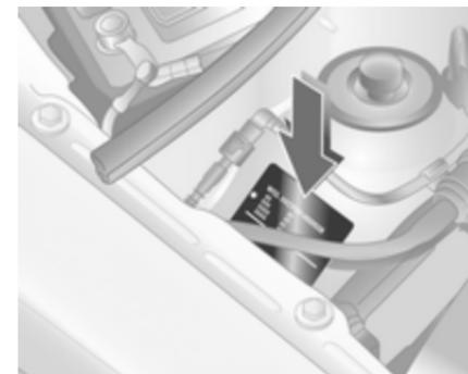
Bei einer anderen Ausführung ist das Typschild am rechten Federbeindom im Motorraum angebracht.
