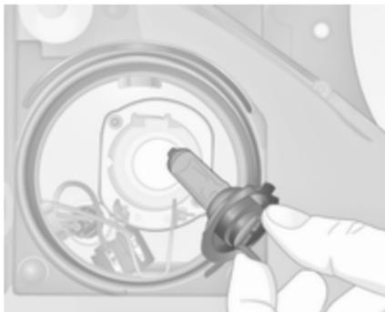
5. Beim Einbau der neuen Glühlampe Fixiernasen in die Aussparungen des Reflektors setzen.
