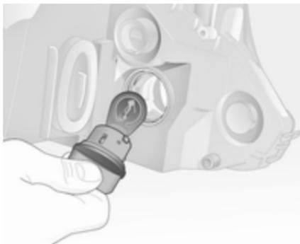
3. Lampenträger in den Reflektor einsetzen, rechts herumdrehen und einrasten.
