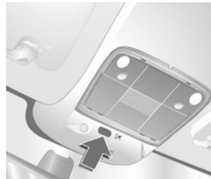
Wenn Tiere im Fahrzeug zurückgelassen werden, muss die Überwachung des Fahrzeuginnenraums und der Fahrzeugneigung abgeschaltet werden, weil laute Ultraschallsignale oder Bewegungen den Alarm auslösen. Auch ausschalten, wenn sich das Fahrzeug auf einer Fähre oder einem Zug befindet oder der Innenraum des abgestellten Fahrzeugs beheizt wird.
