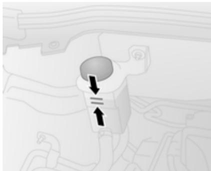
Wenn der Flüssigkeitsstand im Vorratsbehälter unter die Markierung **MIN** absinkt, Hilfe einer Werkstatt in Anspruch nehmen.
