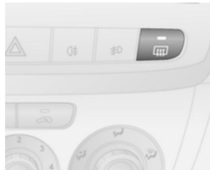
Wird durch Drücken der Taste
