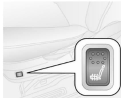
Bei eingeschalteter Zündung Sitzheizung durch Drücken der entsprechenden Taste
