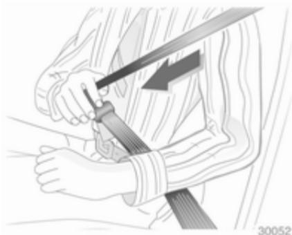
Den Gurt aus dem Aufroller herausziehen, unverdreht über den Körper legen und die Schlosszunge in das Gurtschloss einstecken, bis sie einrastet. Den Beckengurt während der Fahrt durch Ziehen am Schultergurt regelmäßig spannen. Sicherheitsgurt anlegen
