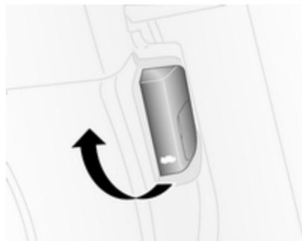
Entriegelungshebel ziehen und in die Ausgangsposition zurückführen.
