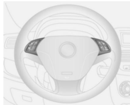
Mit den Bedienelementen am Lenkrad können Sie als Infotainment-System steuern und ein angeschlossenes Mobiltelefon betreiben.
