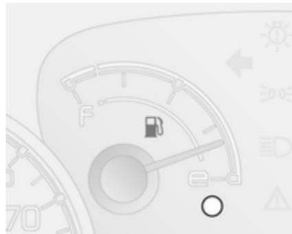
Zeigt den Kraftstoffstand im Tank an. Bei geringem Füllstand leuchtet die Kontrollleuchte
