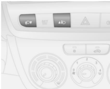
Leuchtweite der Fahrzeugbelastung anpassen, um das Blenden anderer zu vermeiden: Drücken Sie so lange auf die Tasten bzw. , bis die gewünschte Einstellung im Driver Information Center angezeigt wird.
