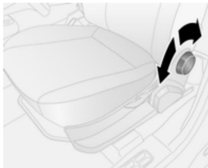
Handrad drehen. Zum Einstellen Rückenlehne entlasten.
