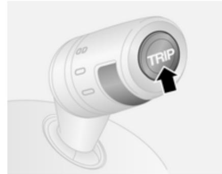
Je nach Fahrzeug können die folgenden Funktionen durch Drücken einer der Tasten am Ende des Wischerhebels ausgewählt werden:
