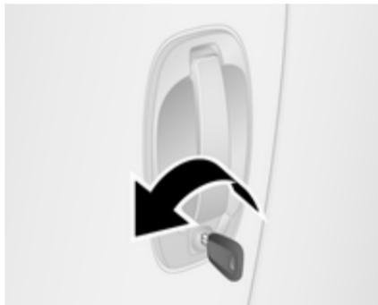
Schlüssel im Fahrtürschloss in Richtung Fahrzeugvorderseite drehen.
