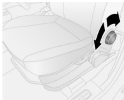
Handrad drehen. Zum Einstellen Rückenlehne entlasten.
