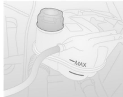
Bei kaltem Kühlsystem muss sich das Kühlmittel zwischen den Markierungen **MIN** und **MAX** bewegen. Bei zu niedrigem Füllstand auffüllen.
