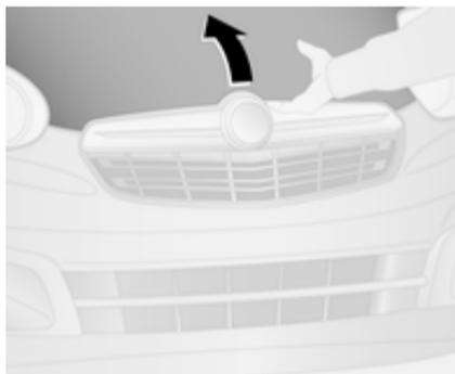
Gegen den Sicherungshebel drücken und die Motorhaube öffnen.
