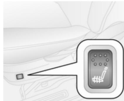
Bei eingeschalteter Zündung Sitzheizung durch Drücken der entsprechenden Taste
