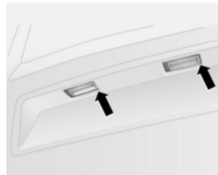
1. Den Schraubendreher wie mit den Pfeilen angezeigt einsetzen, nach links drücken und das Glühlampengehäuse lösen.
