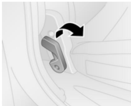
Zum Lösen am Hebel ziehen. Das Sitzgestell wird gespannt und automatisch angehoben.
