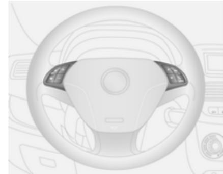
Mit den Bedienelementen am Lenkrad können Sie als Infotainment-System steuern und ein angeschlossenes Mobiltelefon betreiben.
