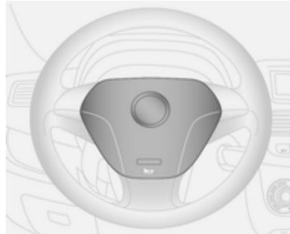
Das Front-Airbag-System wird bei einem Frontalaufprall ab einer bestimmten Unfallschwere ausgelöst. Die Zündung muss eingeschaltet sein.
