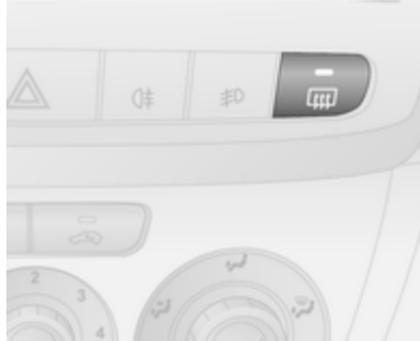
Wird durch Drücken der Taste
