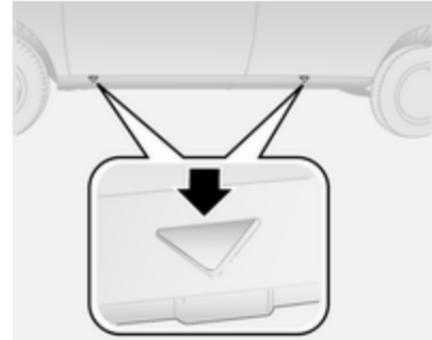
3. Die Ansetzpunkte für den Wagenheber befinden sich vorn und hinten am Fahrzeug.
