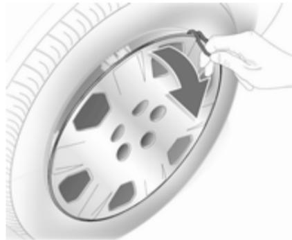
1. Radmutternkappen mit Schraubendreher lösen und abnehmen. Mit einem geeigneten Werkzeug die Radkappe abheben.
