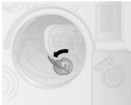
2. Die Fassung der Standlicht-Glühlampe durch Linksdrehung abziehen.
