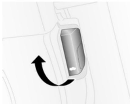
Entriegelungshebel ziehen und in die Ausgangsposition zurückführen.
