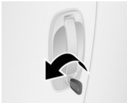
Schlüssel im Fahrertürschloss in Richtung Fahrzeugfront drehen.
