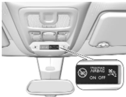
Wenn die Kontrollleuchte ☹ nach Einschalten der Zündung für ca. 60 Sekunden aufleuchtet, löst der Beifahrer-Airbag bei einem Unfall aus.
