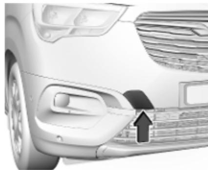
Beispielsweise die Spitze eines Schlitzschraubendrehers mit einem Tuch umwickeln, um den Lack zu schützen. Mit dem Schraubendreher in den Schlitz unten an der Abdeckung fahren. Die Abdeckung vorsichtig lösen.
