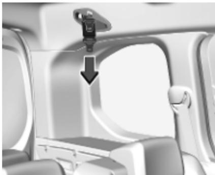
Die Gurtzungen mit dem Gurt aus der Gurthalterung am Dach herausziehen.
