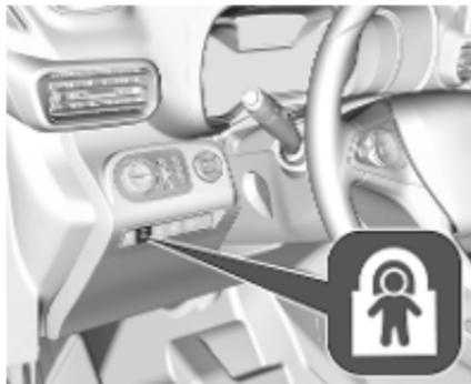
Fernbedientes System, mit dem das Öffnen der hinteren Türen über die Innentürgriffe und die Verwendung der elektrischen Betätigung der hinteren Fenster verhindert werden können.
