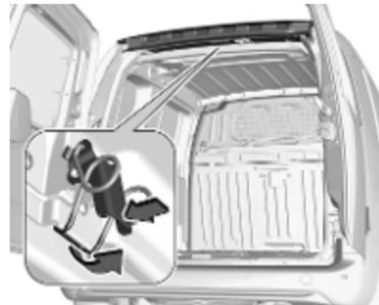
1. Den Hebel drücken und die Federklammer von der Halterung abziehen.
