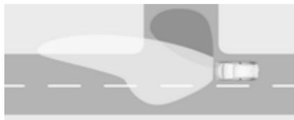
Wird bei einer Geschwindigkeit bis zu 40 km/h beim Abbiegen aktiviert. Je nach Lenkwinkel oder Aktivierung der Blinker leuchten die Nebelleuchten in Fahrtrichtung aus.
