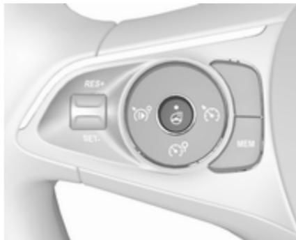
Die Heizung durch Drücken von
