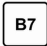
Dieselmotoren gemäß der Norm EN590, mit Beimischung eines Biokraftstoffs gemäß der Norm EN14214 (der bis zu 7 % Fettsäuremethylester enthalten darf)
