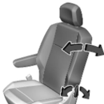
Den Hebel drücken und die Neigung anpassen. Zum Einstellen Rückenlehne entlasten.
