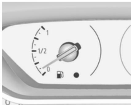
Zeigt den Füllstand im Kraftstofftank an.
