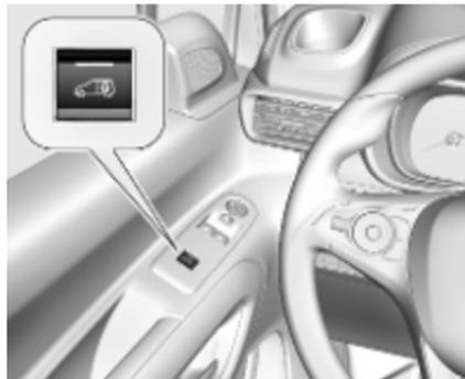
Zum Entriegeln der Heckklappe je nach Version ↪ 10 drücken.
