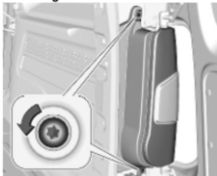
1. Die zwei Schrauben lösen und abnehmen.
