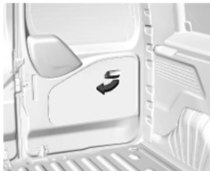
Die Tür wird vom Fahrzeuginnenraum aus durch Ziehen des Innengriffs geöffnet.
