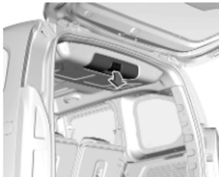
Auf die Dachbox kann aus dem Laderaum aus gegriffen werden. Zum Öffnen der Dachbox am Griff ziehen. Beim Fahren sollten die Klappen geschlossen bleiben. Die maximal zulässige Last beträgt 10 kg.
