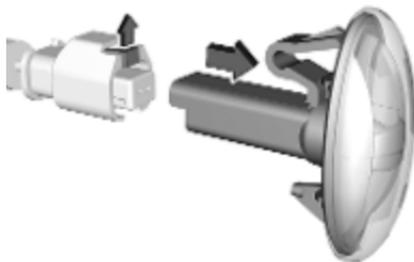
2. Die Halteöse nach oben drücken und die Leuchtmittelfassung aus der Steckverbindung entfernen.
