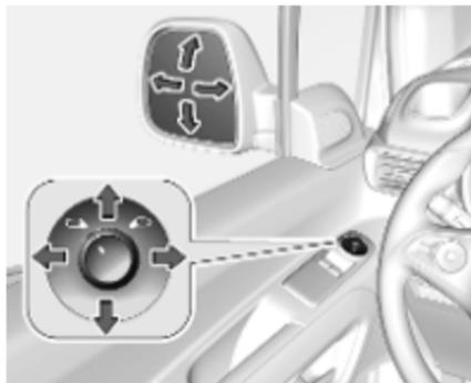
Den entsprechenden Außenspiegel durch Drehen des Schalters zum Symbol für den linken
