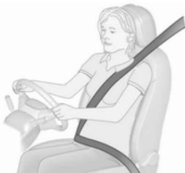
Sicherheitsgurt herausziehen und im Gurtschloss einrasten. Der Sicherheitsgurt muss unverdreht und eng am Körper anliegen. Die Rückenlehne darf nicht zu weit nach hinten geneigt sein (maximal ca. 25°). Zum Lösen rote Taste am Gurtschloss drücken.
