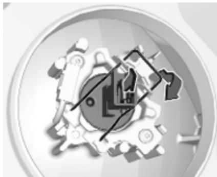
2. Die Federklammer durch Bewegen nach rechts aus der Halterung lösen. Die Federklammer nach unten schwenken. Die Lampenfassung aus dem Reflektorgehäuse ziehen.
