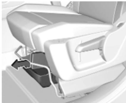
Das Fahrzeug kann mit Schubfächern unter den Vordersitzen ausgestattet sein. Zum Öffnen das Schubfach leicht anheben und dann ziehen.
