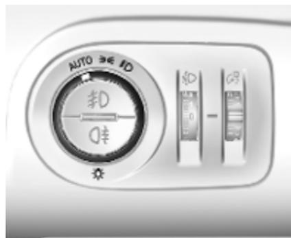
**AUTO** : Automatisches Fahrlicht, schaltet automatisch zwischen Tagfahr- und Scheinwerferlicht um
