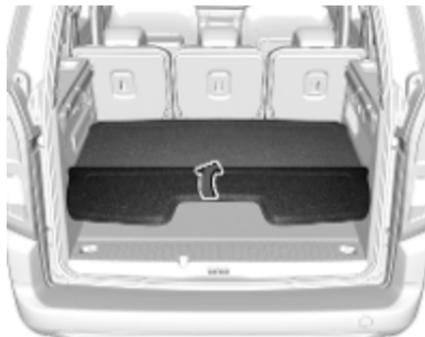
Die Hutablage kann von hinten nach oben geklappt werden, damit der Laderaum flexibler verwendet werden kann.
