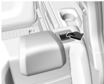
3. Den Entriegelungsgriff an einer oder beiden Außenseiten ziehen und die Rückenlehnen auf die Sitzfläche umklappen.
