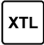
Paraffin-Dieselmotoren gemäß der Norm EN15940, mit Beimischung eines Biokraftstoffs gemäß der Norm EN14214 (der bis zu 7 % Fettsäuremethylester enthalten darf)
