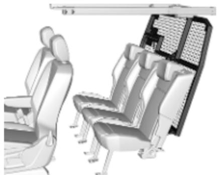
Zum Transportieren langer Gegenstände kann eine Klappe in der Trennwand geöffnet werden. Zum sicheren Transport befindet sich im Fahrzeug eine Schutzabdeckung.
