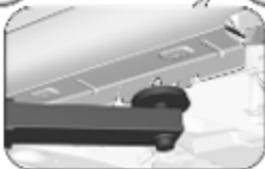
Die Arme der Hebebühne müssen hinten mittig unter den entsprechenden Wagenheberaufnahmen positioniert werden.
