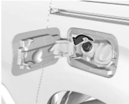
4. Die Schutzkappe vom Einfüllstutzen abschrauben.
