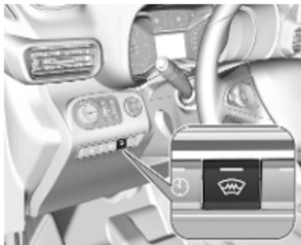
Die Heizung wird durch Drücken auf ☀ eingeschaltet. Die LED in der Taste leuchtet auf.
