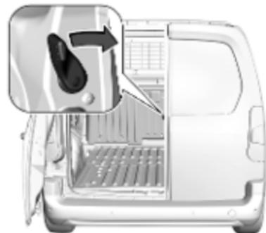
Die rechte Tür wird mit dem Hebel entriegelt.
