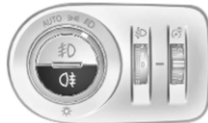
Wird durch Drücken von  $Q\#$  bedient. Lichtschalter auf **AUTO**: Beim Einschalten der Nebelschlussleuchte werden die Scheinwerfer automatisch eingeschaltet.
