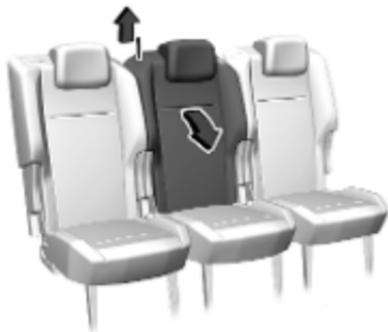
4. Je nach Version die Rückenlehne am mittleren Sitz durch Ziehen an der Schlaufe umklappen.
