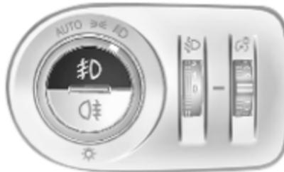
Wird durch Drücken von  $\#D$  bedient. Lichtschalter auf **AUTO**: Beim Einschalten der Nebelleuchten werden die Scheinwerfer automatisch eingeschaltet.
