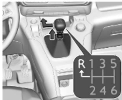
Zum Einlegen des Rückwärtsgangs beim 6-Gang-Getriebe das Kuppelpedal betätigen, den Ring unter dem Wählhebel nach oben ziehen und den Wählhebel nach links und nach vorne bewegen.
