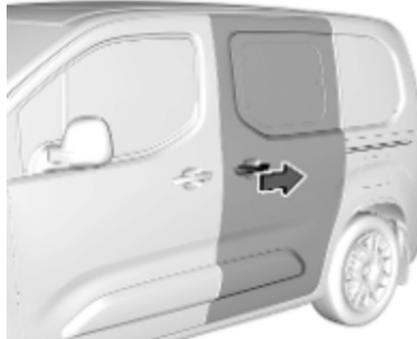
Nach dem Entriegeln den Außentürgriff ziehen und die Tür über den Widerstandspunkt hinaus nach hinten ziehen.
