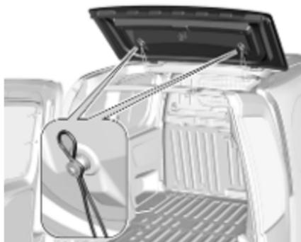
3. Den Widerstandspunkt überschreiten, um die Leiterklappe mit den Stützen zu verriegeln.
