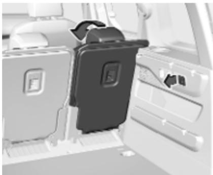
5. Alternativ die Rückenlehnen vom Laderaum aus umklappen: Den Hebel an der linken oder rechten Seitenwand des Laderaums ziehen, um die Rückenlehnen umzuklappen.
