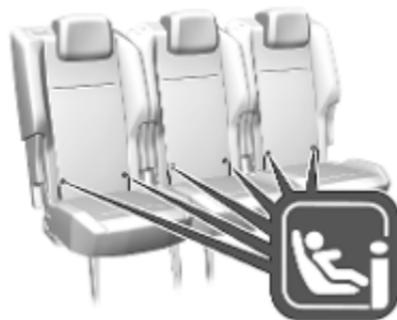
Für das Fahrzeug zugelassene ISOFIX-Kindersicherheitsysteme an den ISOFIX-Befestigungshalterungen befestigen. Die Befestigungshalterungen befinden sich unter dem Symbol i-size im Sitzbezug. Die
