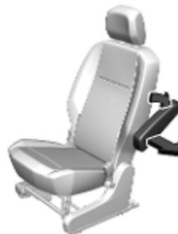
Die Armlehne zum Entfernen nach oben klappen und durch Drücken und Drehen in die abgebildete Position bringen. Dann die Armlehne von der Rückenlehne abziehen.
