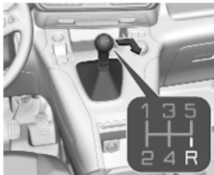
Zum Einlegen des Rückwärtsgangs beim 5-Gang-Getriebe das Kuppelungs pedal betätigen und dann den Wählhebel nach rechts und nach hinten bewegen.
