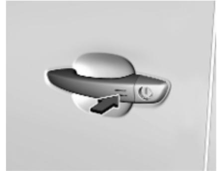
Mit einem Finger oder dem Daumen auf die Markierung an einem der Außentürgriffe oder auf die Taste an der Heckklappe drücken.
