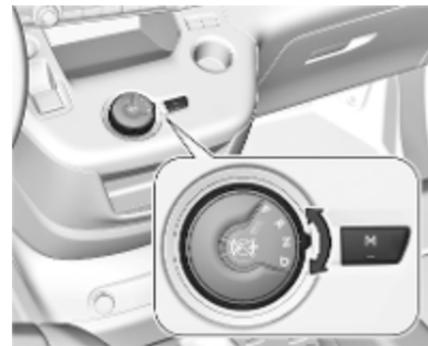
**P** : Parkstellung, Vorderräder sind blockiert; nur bei stillstehendem Fahrzeug und betätigter Parkbremse einlegen
