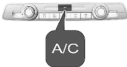
**A/C** drücken, um die Kühlung einzuschalten. Die LED in der Taste leuchtet auf, um die Aktivierung anzuzeigen. Die Kühlung ist nur bei laufendem Motor und eingeschaltetem Gebläse funktionsfähig.
