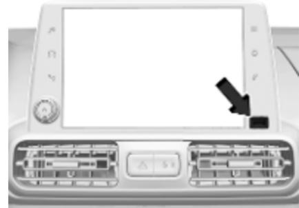
Im Instrument neben dem Info-Display befindet sich ein USB-Anschluss.
