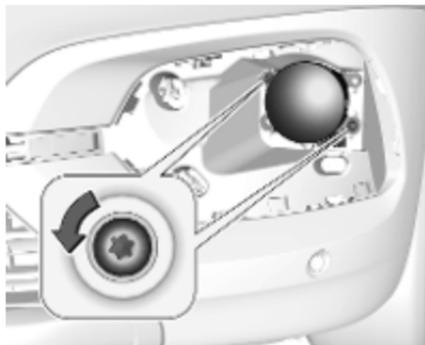
2. Die zwei Schrauben lösen und entfernen und den Leuchtenzusammenbau von vorne entfernen.
