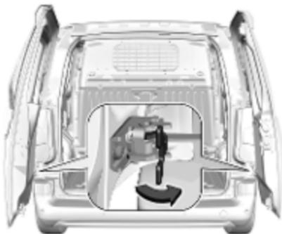
Die Türen werden von Feststellern in der 90°-Stellung gehalten. Wenn die Türen 180° geöffnet werden sollen, auf den Riegel drücken und die Tür in die gewünschte Öffnungsposition schwenken. Vor dem Schließen der Türen die Feststeller in der 90°-Stellung fixieren.
