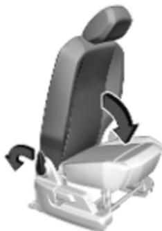
Den Hebel drücken, die Rückenlehne vollständig nach vorne klappen und den Hebel loslassen. Dann die Sitzlehne weiter nach unten drücken, bis sie komplett flach liegt.
