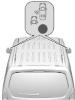
Wenn das System beim Vorwärtsfahren ein Fahrzeug im toten Winkel erkennt, leuchtet im entsprechenden Außenspiegel eine LED.
