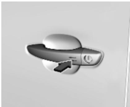
**Elektronisches Schlüsselsystem:** Beim Entriegeln des Fahrzeugs durch Drücken auf die Markierung an einem der Außentürgriffe wird auch die Diebstahlwarnanlage deaktiviert.
