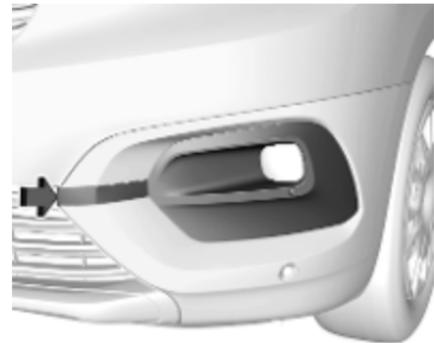
1. Die Spitze eines Schlitzschraubendrehers mit einem Tuch umwickeln, um den Lack zu schützen. Den Schraubendreher in die Aussparung an der Kante der Abdeckung stecken. Die Abdeckung vorsichtig abhebeln und lösen.
