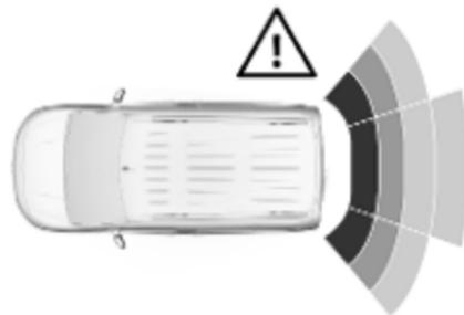
Außerdem wird die Entfernung zu Hindernissen hinter dem Fahrzeug durch veränderliche Abstandslinien im Info-Display  $\hookrightarrow$  119 angezeigt. Wenn der Abstand zum Hindernis sehr klein ist, wird das Gefahrensymbol  $\triangle$  angezeigt.
