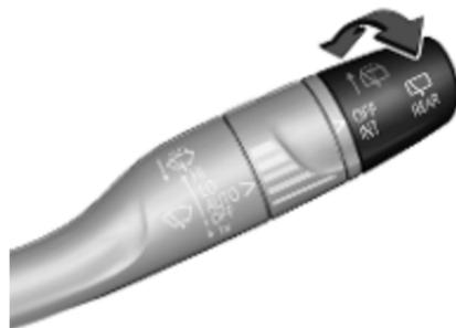
Zum Einschalten des Heckscheibenwischers die äußere Kappe drehen:
