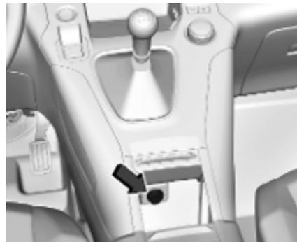
Hinter der Stauraumabdeckung befindet sich eine 12-V-Zubehörsteckdose. Abdeckung zum Öffnen nach oben drücken.
