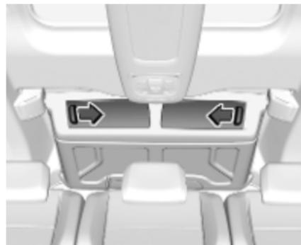
Von den Rücksitzen aus kann auf die Dachbox zugegriffen werden. Zum Öffnen die Klappen verschieben.
