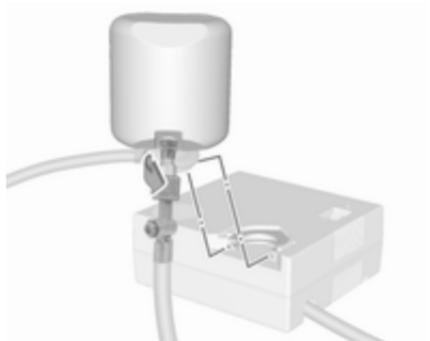
4. Luftschlauch des Kompressors an den Anschluss der Dichtmittelflasche schrauben.
