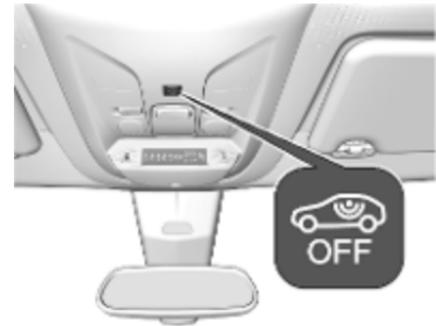
Wenn Tiere im Fahrzeug zurückgelassen werden, muss die Überwachung des Fahrzeuginnenraums abgeschaltet werden, weil laute Ultraschallsignale oder Bewegungen den
