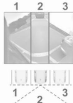
Die 180°-Ansicht erleichtert das Ausparken aus einer Parklücke, indem sie sich nähernde Fahrzeuge, Fußgänger und Radfahrer anzeigt. Für ein vollständiges Einparkmanöver wird diese Ansicht nicht empfohlen. Die Ansicht setzt sich aus drei Bereichen zusammen: links (1), Mitte (2) und rechts (3). Die Ansicht ist nur über das Menü zur Auswahl der Ansicht verfügbar.
