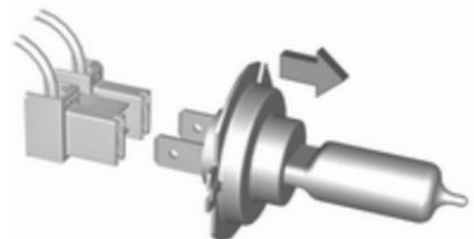
3. Die Lampe aus der Lampenfassung lösen und ersetzen.
