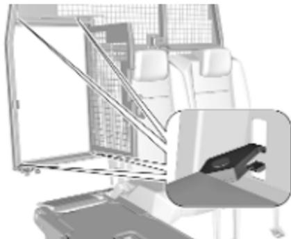
1. Die vier Karabiner an der Abdeckung an den entsprechenden Verzurösen befestigen.
