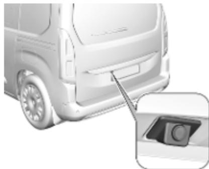
Die Kamera ist in der Heckklappe oder in der linken Hecktür montiert.
