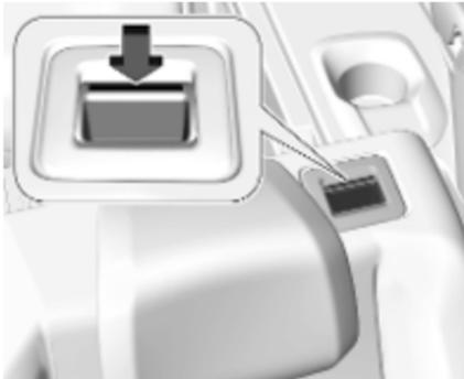
Die Rückenlehnen sind korrekt eingerastet, wenn die rote Markierungen neben dem Entriegelungsgriff nicht mehr sichtbar ist.
