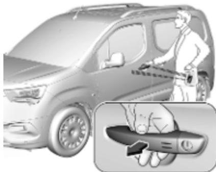
Der elektronische Schlüssel muss sich außerhalb des Fahrzeugs in einem Umkreis von ca. einem Meter um die entsprechende Türseite befinden.
