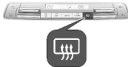
Die Heizung wird durch Drücken von
