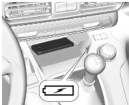
Das zu ladende mobile Gerät muss mit dem Qi-Standard kompatibel sein, entweder konstruktionsbedingt oder mit Verwendung eines kompatiblen Halters/einer kompatiblen Schale. Die Ladezone ist durch das Qi-Symbol gekennzeichnet.
