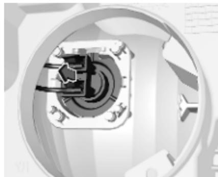
2. Die Lampenfassung aus dem Reflektorgehäuse ziehen.
