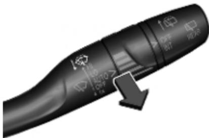
Hebel ziehen. Waschflüssigkeit spritzt auf die Windschutzscheibe und der Wischer wird für einige Wischbewegungen eingeschaltet.
