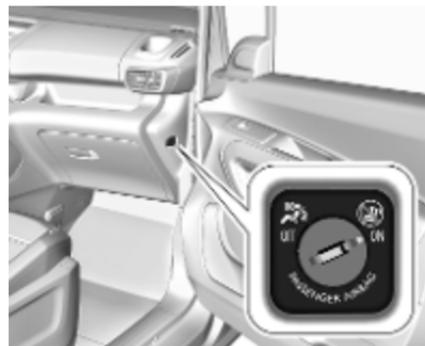
Das Beifahrer-Airbag-System kann mit dem Schlüssel über einen Schalter auf der Beifahrerseite der Instrumententafel deaktiviert werden.
