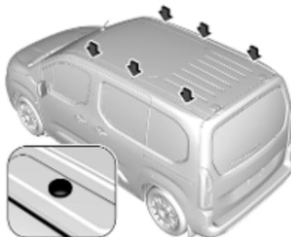
Zur Befestigung eines Dachgepäckträgers die Kappen in den Dachleisten öffnen. Die Montagevorrichtungen wie angewiesen in die Halterung einsetzen.
