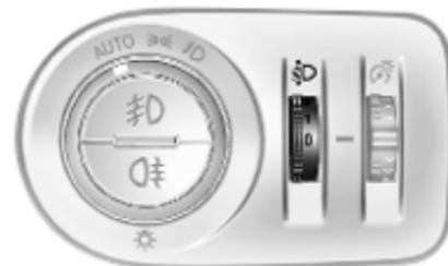
Zur Anpassung der Leuchtweite an die Fahrzeuglast, um Blendwirkung zu reduzieren: Daumenrädchen
