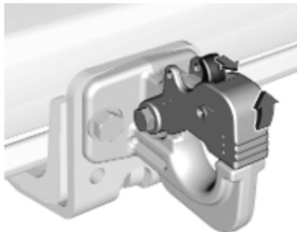
2. Am Hebel ziehen und die Abschleppöse öffnen.
