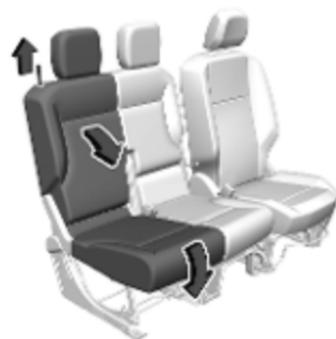
Die äußere Rückenlehne durch Ziehen an der Schlaufe umklappen. Die Rückenlehne nach vorne klappen, bis der Sitz auf den Fahrzeugboden abgesenkt ist.
