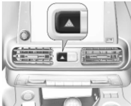
Wird durch Drücken von ▲ bedient.
