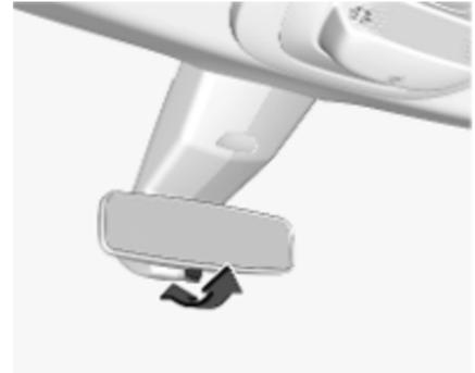
Zur Reduzierung der Blendwirkung Hebel an der Unterseite des Spiegelgehäuses verstellen.
