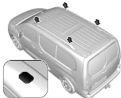
Zum Befestigen eines Dachgepäckträgers die in der Abbildung gezeigten Kappen im Dach öffnen. Die Montagevorrichtungen wie angewiesen in die Halterung einsetzen.
