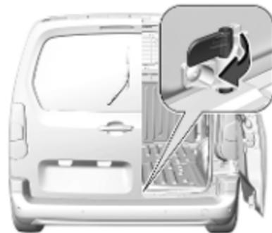
In Ausnahmefällen kann mit geöffneter rechter hinterer Tür gefahren werden, beispielsweise zum Transportieren langer Gegenstände. Die linke und dann die rechte hintere Tür öffnen, dann die linke Tür schließen und verriegeln.
