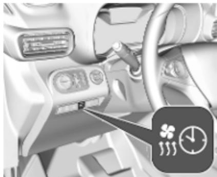
Der Betriebsstatus der Standheizung wird durch eine Taste mit LED angezeigt.
