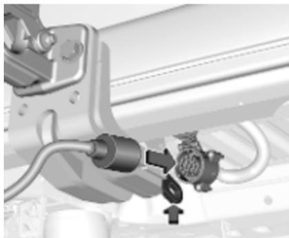
4. Den Anhängerstecker in die Steckdose stecken und das Abreißseil an der Öse am Träger befestigen.
