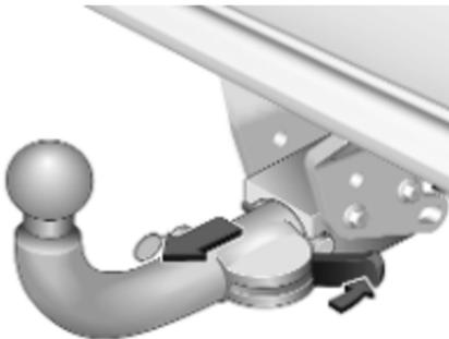
4. Den Hebel der Kupplungskugelstange in die hintere Position bewegen. Die Kupplungskugelstange abziehen.
