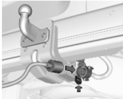
1. Den Anhängerstecker in die Steckdose stecken und das Abreißseil an der Öse am Träger befestigen.
