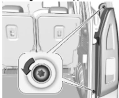
1. Die beiden Schrauben losschrauben und abnehmen.
