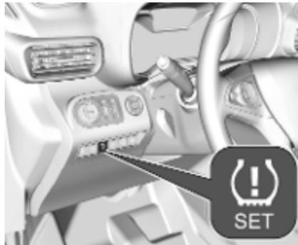
3. Das Reifendruckverlust-Überwachungssystem initialisieren: Bei Fahrzeugen mit Graphic-Info-Display drei Sekunden lang
