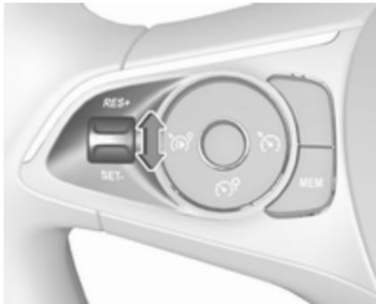
Auf die gewünschte Geschwindigkeit beschleunigen und das Daumenrädchen einmal kurz in Stellung **RES/+** oder **SET/-** bringen. Die aktuelle Geschwindigkeit wird gespeichert und beibehalten. Gaspedal kann gelöst werden.
