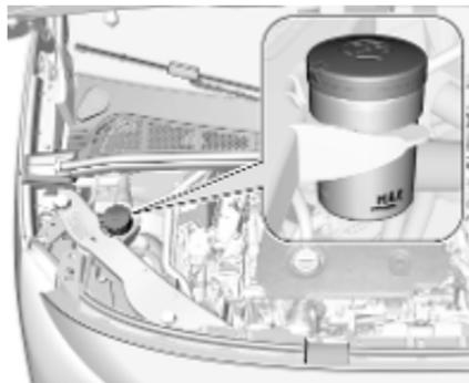
Mit einem Gemisch aus sauberem Wasser und einer geeigneten Menge zugelassener Scheibenwaschlösung mit Frostschutzmittel füllen.
