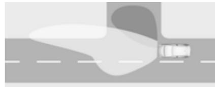
Wird bei einer Geschwindigkeit bis zu 40 km/h beim Abbiegen aktiviert. Je nach Lenkwinkel oder Aktivierung der Blinker leuchten die Nebelscheinwerfer in Fahrtrichtung aus.
