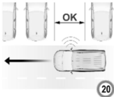
Wenn eine freie Parklücke erkannt wird, wird im Info-Display eine optische Rückmeldung gegeben und es ertönt ein Signalton. Das Fahrzeug anhalten, den Rückwärtsgang einlegen, das Lenkrad loslassen und langsam mit einer Geschwindigkeit von maximal 7 km/h anfahren.
