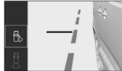
Die Linie markiert eine Entfernung von etwa 4 m zum Rand des Heckstoßfängers.
