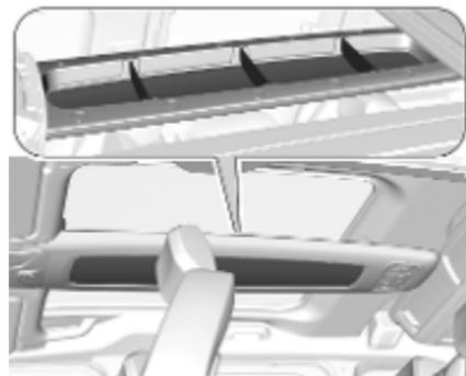
Die Unterteilung der vier Ablagefächer kann entfernt werden.
