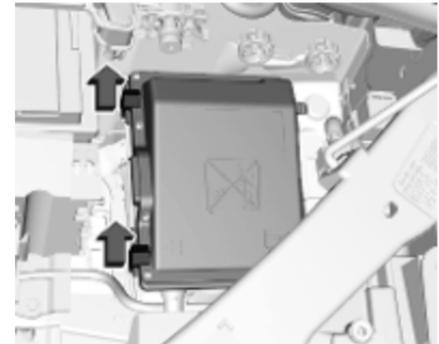
Der Sicherungskasten befindet sich im vorderen linken Bereich des Motorraums.
