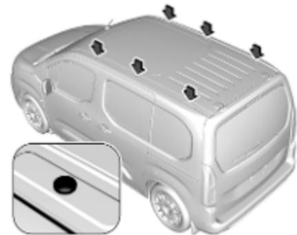
Zur Befestigung eines Dachgepäckträgers die Kappen in den Dachleisten abschrauben. Die Montagevorrichtungen wie angewiesen in die Halterung einsetzen.
