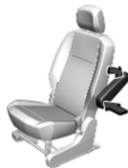
Die Armlehne zum Entfernen nach oben klappen und durch Drücken und Drehen in die abgebildete Position bringen.
