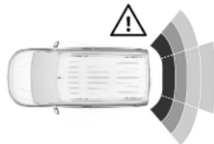
Außerdem wird der Abstand zu Hindernissen hinter dem Fahrzeug durch sich ändernde Abstandslinien im Info-Display angezeigt ↪ 116. Bei einem sehr geringen Abstand wird das Warnsymbol ⚠ angezeigt.
