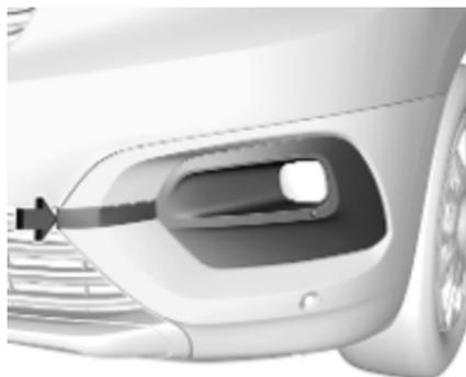
1. Die Spitze eines Schlitzschraubendrehers mit einem Tuch umwickeln, um den Lack zu schützen. Den Schraubendreher in die Aussparung an der Kante der Abdeckung stecken. Die Abdeckung vorsichtig abhebeln und lösen.
