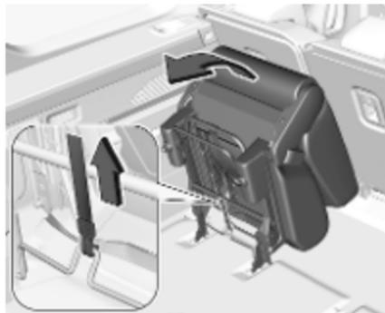
1. Die vorderen Sitzstützen an den vorderen Verankerungspunkten befestigen.
