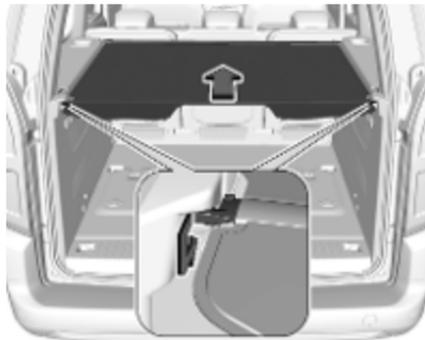
Laderaumabdeckung aus den seitlichen Halterungen nehmen. Die Abdeckung führen, bis sie vollständig aufgerollt ist.
