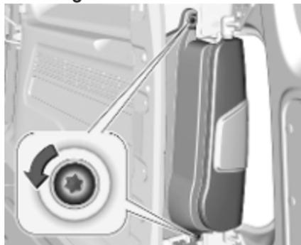
1. Die beiden Schrauben losschrauben und abnehmen.
