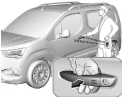
Der elektronische Schlüssel muss sich außerhalb des Fahrzeugs in einem Umkreis von ca. einem Meter um die entsprechende Türseite befinden.
