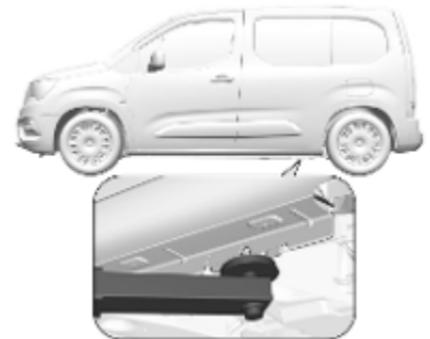
Die Arme der Hehebühne müssen hinten mittig unter den entsprechenden Wagenheberaufnahmen positioniert werden.
