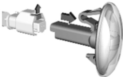
2. Die Halteöse nach oben drücken und die Lampenfassung aus der Steckverbindung entfernen.
