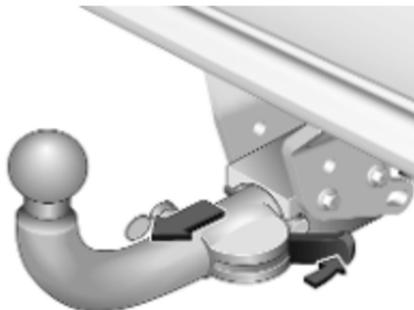
5. Den Hebel der Kugelstange in die hintere Position bewegen. Die Kugelstange durch Ziehen abnehmen.
