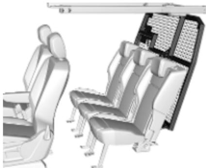
Zum Transport langer Gegenstände kann eine Klappe in der Trennwand geöffnet werden. Im Fahrzeug befindet sich eine Schutzabdeckung, die einen sicheren Transport ermöglicht.
