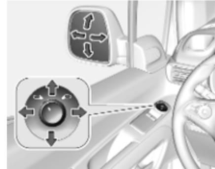
Den entsprechenden Außenspiegel durch Drehen des Schalters zum Symbol für den linken
