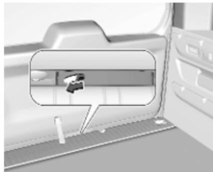
Über eine Zugangsöffnung zwischen der Tür und dem Boden kann der Heckklappenriegel mit einem geeigneten Werkzeug freigegeben werden. Hebel nach links drücken, um die Heckklappe zu entriegeln und zu öffnen.
