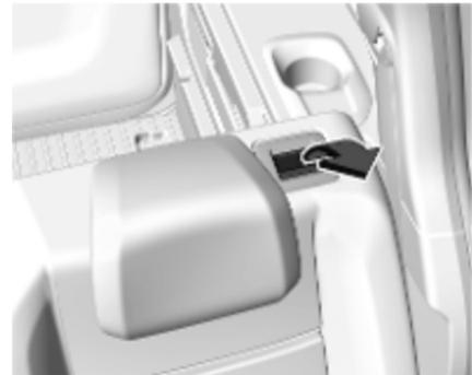
3. Den Entriegelungsgriff an einer oder beiden Außenseiten ziehen und die Rückenlehnen auf die Sitzfläche umklappen.
