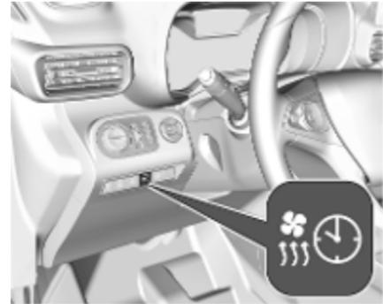
Der Betriebsstatus der Standheizung wird durch eine Anzeige mit LED angezeigt.
