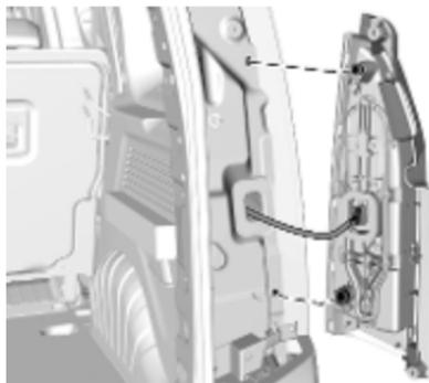
2. Die Leuchteneinheit vorsichtig aus der Aussparung herausziehen. Aufpassen, dass der Kabelkanal nicht verschoben wird.
