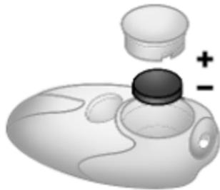
1. Kappe an der Fernsteuerung mit einer Münze losschrauben und Batterie herausnehmen.
