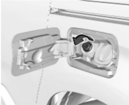
4. Die Schutzkappe vom Einfüllstutzen abschrauben.
