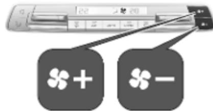
Drücken auf **☼+** oder **☼-** erhöht bzw. reduziert den Luftstrom.
