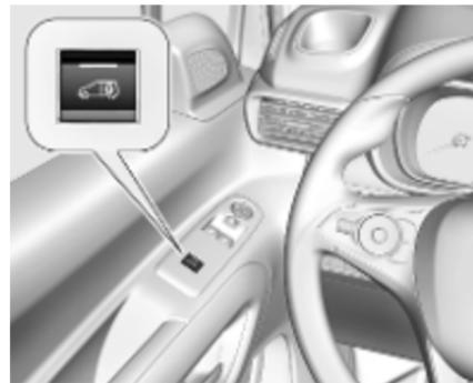
Zum Entriegeln der Heckklappe je nach Version
