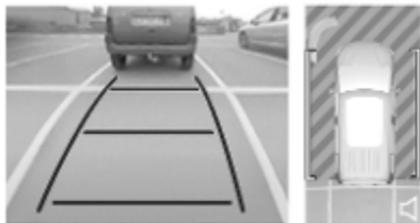
Der Bildschirm des Info-Displays ist in zwei Bereiche unterteilt. Auf der rechten Seite wird eine Ansicht des Fahrzeugs von oben und im linken Bereich eine Ansicht des Fahrzeugs von
