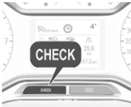
Die aktuellen Serviceinformationen können jederzeit durch Drücken der Taste **CHECK** abgerufen werden. Die Serviceinformationen werden einige Sekunden lang angezeigt.
