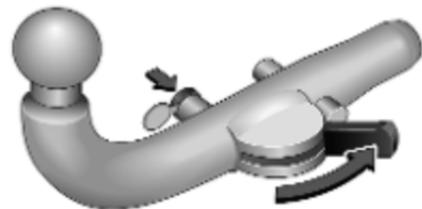
1. Den Schlüssel in das Schloss einführen und die Kupplungskugelstange entriegeln. Den Hebel in die hintere Position bewegen.
