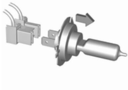
3. Die Lampe aus der Lampenfassung lösen und ersetzen.
