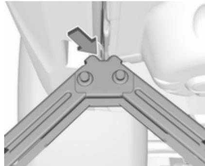
Sicherstellen, dass die Karosseriekante in die Kerbe am Wagenheber passt.
