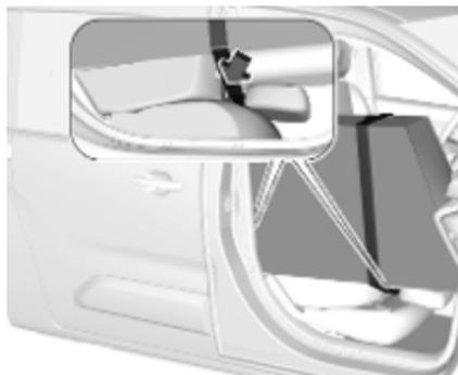
Wenn die Ladung auf dem vorderen und hinteren Sitz auf der Beifahrerseite verstaut wird, ein Halteband um jede Kopfstütze führen.
