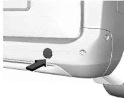
Beispielsweise die Spitze eines Schlitzschraubendrehers mit einem Tuch umwickeln, um den Lack zu schützen. Mit dem Schraubendreher in den Schlitz unten an der Abdeckung fahren. Die Abdeckung vorsichtig lösen.
