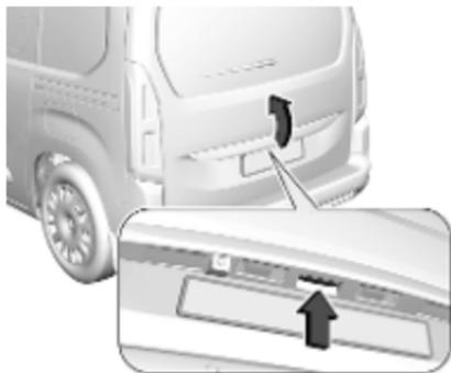
Nach dem Entriegeln die mittlere Heckklappentaste drücken und die Heckklappe öffnen.
