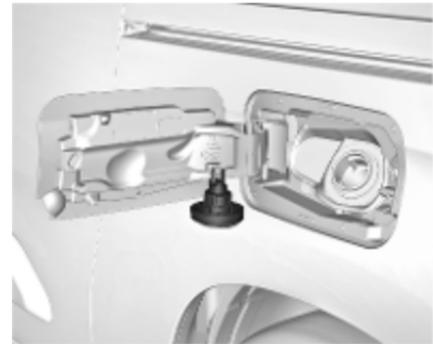
Der Tankdeckel kann am Haken an der Tankklappe eingehängt werden.
