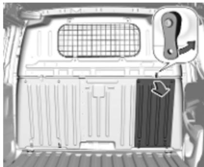
1. Die Sperrvorrichtung lösen und die Klappe absenken und entfernen.
