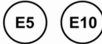
Otto-Kraftstoff gemäß der Norm EN228, mit Beimischung eines Biokraftstoffs gemäß der Norm EN15376.
