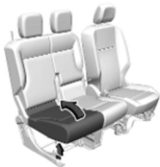
Zum Anheben der Sitzfläche den Hebel ziehen und die Sitzfläche zur Rückenlehne hin anheben, bis sie einrastet.
