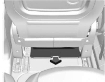
Die Abdeckung des Ablagefachs im Fußraum öffnen ⇨ 77.
