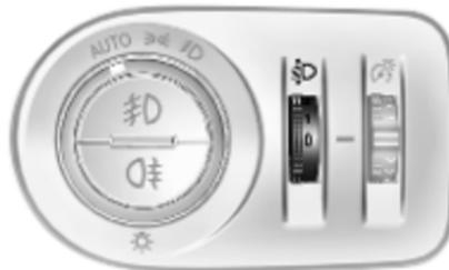
Zur Anpassung der Leuchtweite an die Fahrzeuglast, um Blendwirkung zu reduzieren: Daumenrädchen  $\text{D}$  in die gewünschte Stellung drehen.
