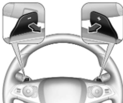
Zum manuellen Schalten an den Lenkrad-Schaltwippen ziehen.
