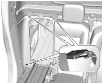
2. Die vier Karabiner an der Abdeckung an den entsprechenden Verzurrösen befestigen.
