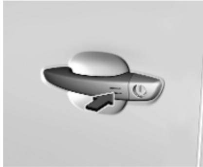
Mit einem Finger oder dem Daumen (an der Markierung) auf einen der Türgriffe oder die Taste an der Heckklappe drücken.
