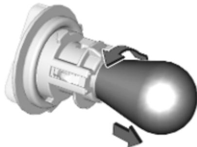
2. Das Leuchtmittel leicht nach unten drücken, linksherum drehen und aus der Fassung entfernen.
