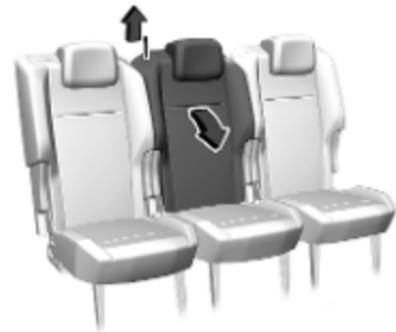
4. Je nach Version die Rückenlehne am mittleren Sitz durch Ziehen an der Schlaufe umklappen.
