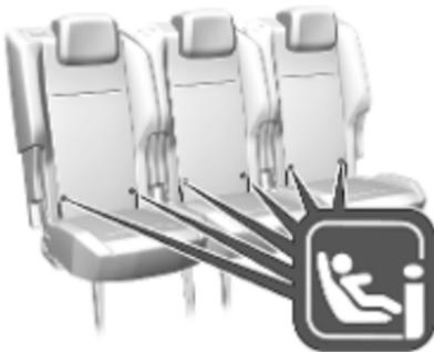
Für das Fahrzeug zugelassene ISOFIX-Kindersicherheitsysteme an den ISOFIX-Befestigungen befestigen. Die speziellen Positionen für ISOFIX-Kindersicherheitsysteme sind in der Tabelle mit ISOFIX gekennzeichnet ⇨ 70.
