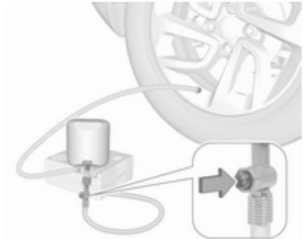
Zu hohen Reifendruck mithilfe der Taste am Luftschlauch korrigieren.
