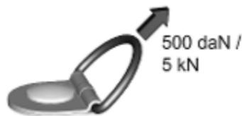
Die maximale auf die Verzurrösen einwirkende Kraft darf 500 daN/5 kN/ 5000 N nicht übersteigen.
