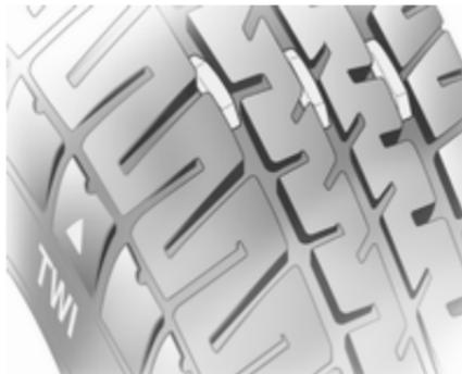
Die gesetzlich zulässige Mindestprofiltiefe (1,6 mm) ist erreicht, wenn das Profil bis zu einem Verschleißanzeiger (TWI = Tread Wear Indicator)
