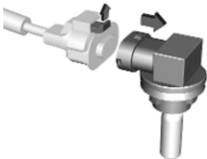
4. Den Stecker durch Ziehen der Haltetasche lösen.
