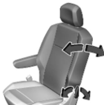
Hebel drücken und Neigung einstellen. Zum Einstellen Rückenlehne entlasten.
