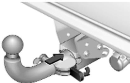
3. Die Kupplungskugelstange in die Öffnung einsetzen und fest bis zum Anschlag drücken.
