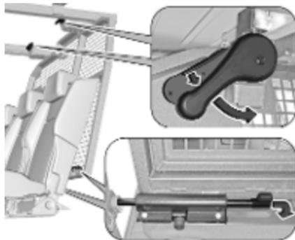
1. Die vier Arretierungen oben und unten an der Trennwand lösen.
