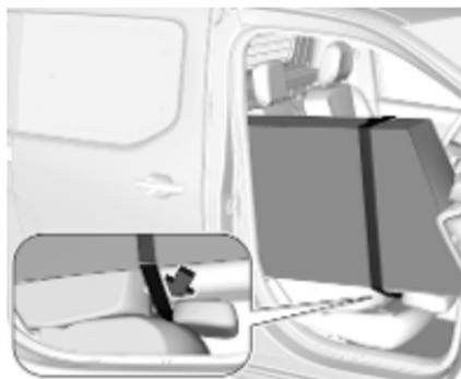
4. Das Halteband der Abdeckung um die Kopfstütze führen. Das Halteband durch Ziehen am losen Ende spannen.
