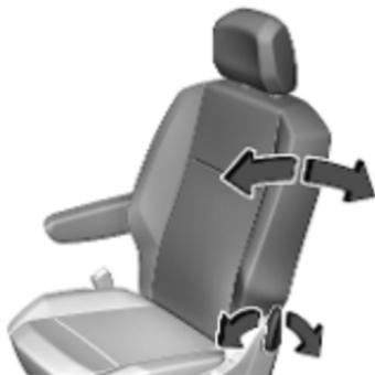
Den Hebel drücken, die Neigung einstellen und den Hebel loslassen. Zum Einstellen Rückenlehne entlasten.
