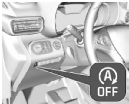
Die Stopp-Start-Automatik lässt sich durch Drücken von
