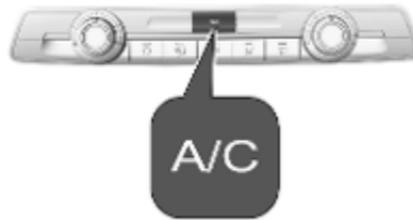
**A/C** drücken, um die Kühlung einzuschalten. Die LED in der Taste leuchtet auf, um die Aktivierung anzuzeigen. Die Kühlung funktioniert nur bei laufendem Motor und eingeschaltetem Gebläse.
