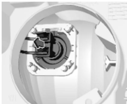
2. Die Lampenfassung aus dem Reflektorgehäuse ziehen.
