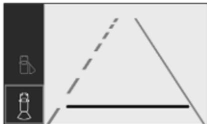
Die horizontale Linie markiert eine Entfernung von etwa 4 m zum Rand des Heckstoßfängers.
