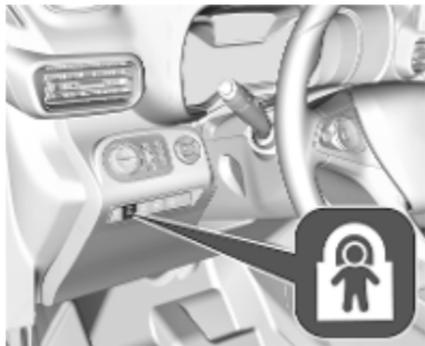
Fernbedientes System, mit dem ein Öffnen der hinteren Türen mit den Innentürgriffen und die Verwendung der elektrischen Betätigung der hinteren Fenster verhindert werden können.
