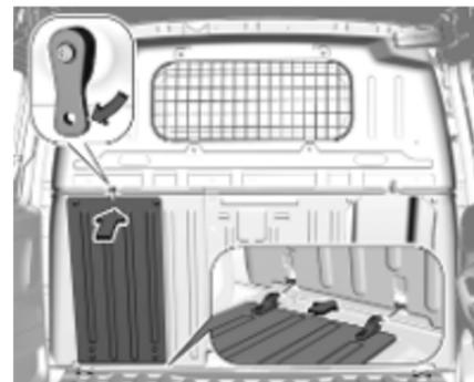
Die Sperrvorrichtung nach oben drehen. An den Scharnieren der Klappe im Gehäuse ziehen, die Klappe anheben und die Sperrvorrichtung schließen.
