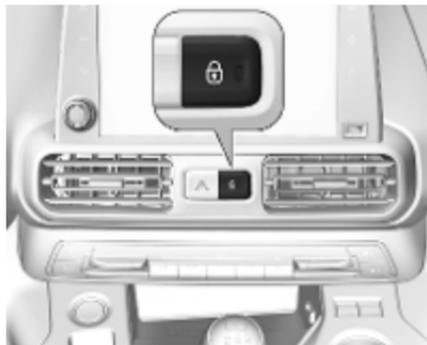
Diese Funktion kann jederzeit aktiviert oder deaktiviert werden. Bei eingeschalteter Zündung  $\Delta$  drücken, bis ein akustisches Signal ertönt und eine entsprechende Meldung angezeigt wird.
