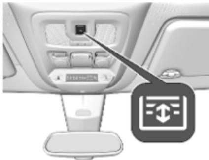
Drücken hinten auf ☰: Das Sonnenrollo wird geöffnet, solange der Schalter betätigt wird.
