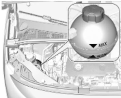
Bei kaltem Kühlsystem muss der Kühlmittelspiegel über der Markierung **MIN** liegen. Bei zu niedrigem Füllstand auffüllen.
