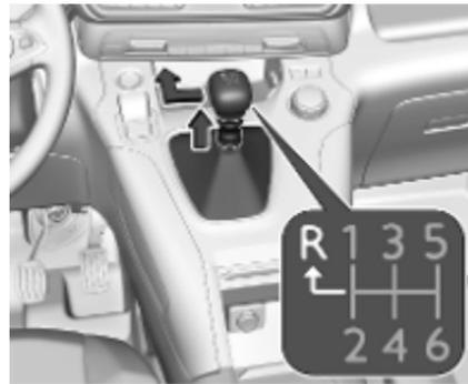
Beim 6-Gang-Getriebe zum Einlegen des Rückwärtsgangs das Kupplungspedal betätigen, den Ring unter dem Wählhebelknopf nach oben ziehen und den Wählhebel nach links vorne bewegen.
