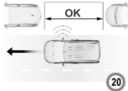
Wenn eine freie Parklücke erkannt wird, wird im Info-Display eine optische Rückmeldung gegeben und es ertönt ein erster Signalton. Langsam vorwärts fahren. Wenn der zweite Signalton ertönt, das Fahrzeug anhalten, den Rückwärtsgang einlegen, das Lenkrad loslassen und langsam anfahren. Im Info-Display wird eine optische Rückmeldung gegeben.
