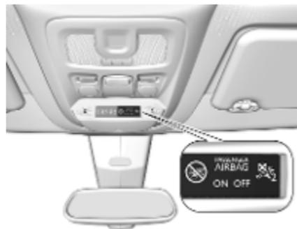
Wenn die Kontrollleuchte
