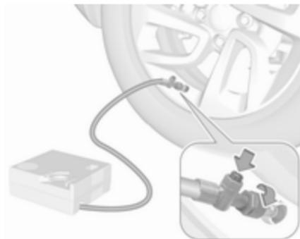
16. Fahrt unverzüglich fortsetzen, damit sich das Dichtmittel im Reifen gleichmäßig verteilt. Nach ca. 5 km Fahrtstrecke spätestens jedoch nach zehn Minuten anhalten und Reifendruck kontrollieren. Hierzu den Luftschlauch des Kompressors direkt auf das Reifenventil schrauben. Den Reifen wie zuvor beschrieben mit Luft befüllen. Zu hohen Reifendruck mithilfe der Taste am Luftschlauch korrigieren.
