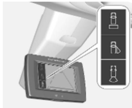
Die Standardansicht nach hinten oder die Sicht auf die Beifahrerseite durch Drücken auf
