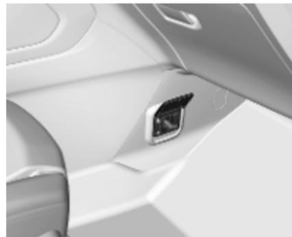
Versionsabhängig befindet sich im unteren Bereich der Mittelkonsole im vorderen Fahrgastraum eine 230-V-Zubehörsteckdose.
