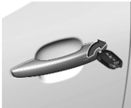
Die Türen, die Heckklappe und die Tankklappe durch Einführen des Schlüssels in den Schließzylinder an der Fahrertür und Drehen manuell verriegeln.
