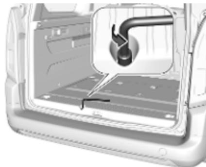
2. Den Radschlüssel auf eine der Sechskantbolzen aufsetzen. Linksherum drehen, bis die Reserveradhalterung niedrig genug ist, um die Arretierung auszuhaken.
