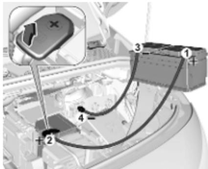
Die Pluspolenschutzkappen an beiden Fahrzeugbatterien öffnen.
