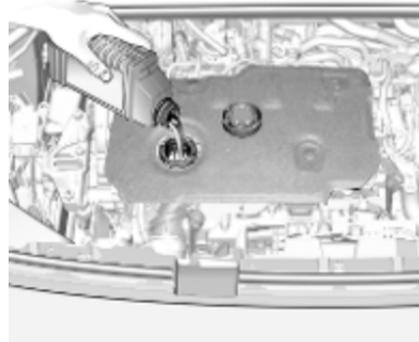
Wenn der Motorölstand in den Bereich der Markierung **MIN** abgesunken ist, Motoröl nachfüllen.
