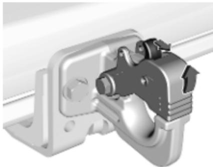
2. Hebel ziehen und den Schlepphaken öffnen.
