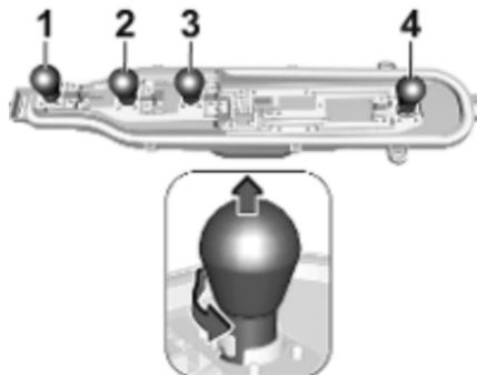
5. Leuchte leicht nach unten drücken, drehen und aus der Leuchtmittelfassung ausbauen. Leuchtmittel wechseln:
