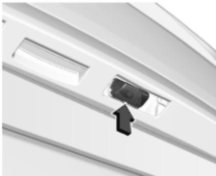
1. In die Aussparung der Abdeckung beispielsweise einen Schraubendreher einsetzen und die Abdeckung entfernen.
