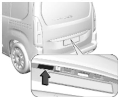
Während sich der elektronische Schlüssel außerhalb des Fahrzeugs in einem Abstand von ca. einem Meter zur Heckklappe befindet, die linke Heckklappentaste drücken, um das Fahrzeug verriegeln.
