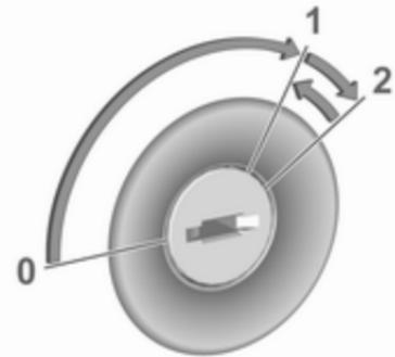
Den Schlüssel in die Stellung 1 drehen, um das Lenkradschloss zu lösen.
