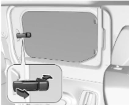
Zum teilweisen Öffnen der hinteren Fenster den Hebel kippen und bis zum Anschlag drücken, um die Fenster in der geöffneten Position zu arretieren.
