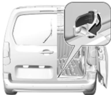
In Ausnahmefällen kann mit geöffneter rechter hinterer Tür gefahren werden, z. B. zum Transportieren langer Gegenstände. Die linke und dann die rechte hintere Tür öffnen. Dann die linke Tür schließen und verriegeln.
