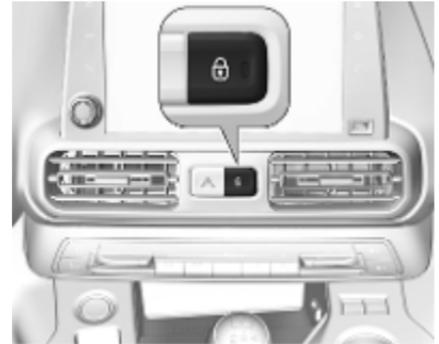
Zum Verriegeln auf
