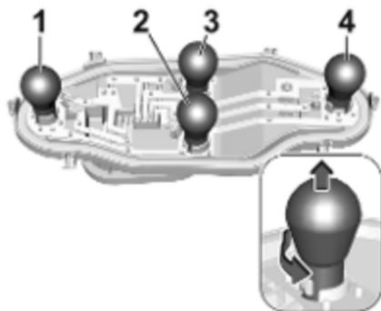
5. Leuchte leicht nach unten drücken, drehen und aus dem Lampenträger ausbauen. Leuchtmittel wechseln:
