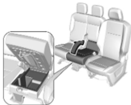
Das Fahrzeug kann mit einem Staufach unter dem mittleren Sitz der Sitzbank ausgestattet sein. Die Sitzfläche durch Ziehen am Griff anheben. Das Staufach kann mit einem Vorhängeschloss gesichert werden.
