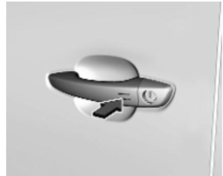
Elektronisches Schlüsselsystem: Beim Entriegeln des Fahrzeugs durch Drücken auf die Markierung an einem der Vordertürgriffe wird die Diebstahlwarnanlage deaktiviert.
