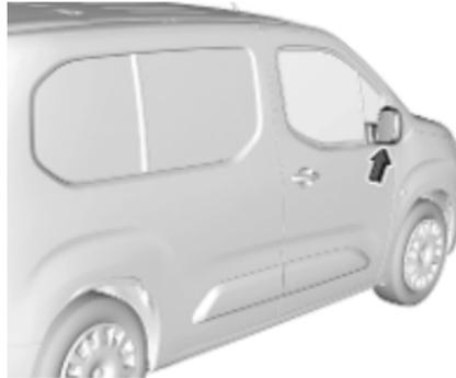
Die Kamera ist unten am Außenspiegel auf der Beifahrerseite montiert.
