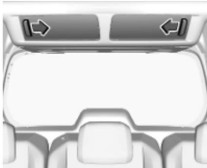
Zum Öffnen die Klappen verschieben.
