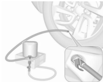
7. Einfüllschlauch an Reifenventil anschrauben.
