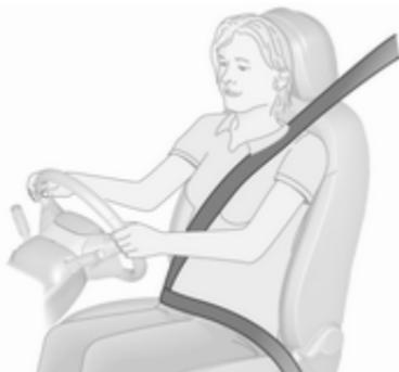
Sicherheitsgurt herausziehen und im Gurtschloss einrasten. Der Sicherheitsgurt muss unverdreht und eng am Körper anliegen. Die Rückenlehne darf nicht zu weit nach hinten geneigt sein (maximal ca. 25°).
