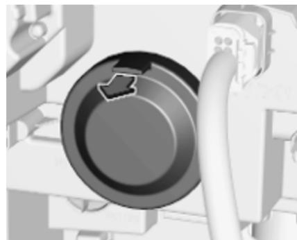
1. Die Schutzabdeckung durch Ziehen entfernen.
