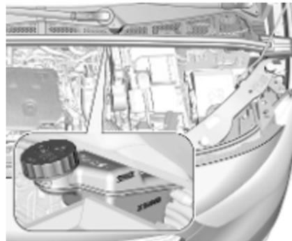
Der Bremsflüssigkeitsstand muss zwischen **DANGER** und **MAX** liegen. Wenn der Flüssigkeitsstand unter die **DANGER**-Markierung gefallen ist, die Hilfe einer Werkstatt in Anspruch nehmen.
