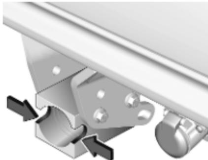
2. Die Kontaktpunkte mit einem weichen, sauberen Tuch reinigen.
