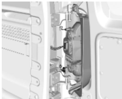
2. Die Leuchteinheit vorsichtig aus der Aussparung herausziehen. Aufpassen, dass der Kabelkanal nicht verschoben wird.
