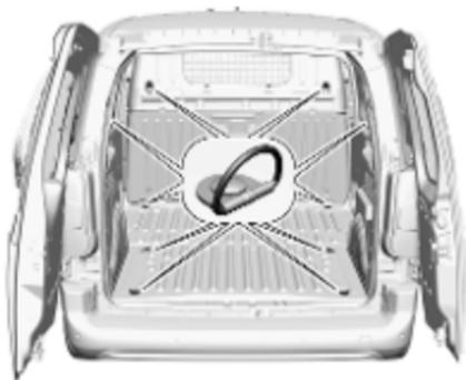
Am Fahrzeugboden und / oder an der Seitenwand können sich Verzurrösen befinden. Die Anzahl und der Anbringungsort der Verzurrösen können je nach Fahrzeug unterschiedlich sein.
