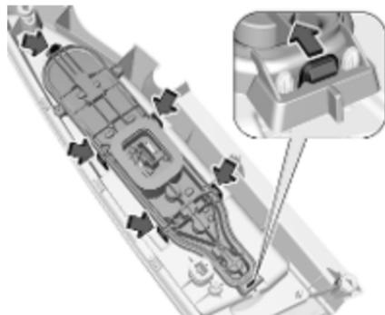
4. Die Halteöse nach hinten drücken, an der Leuchtmittelfassung ziehen und die übrigen Halteösen ausrasten.
