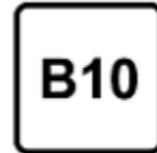
Dieselmotorenkraftstoff gemäß der Norm EN16734, mit Beimischung eines Biokraftstoffs gemäß der Norm EN14214 (der bis zu 10 % Fettsäuremethylester enthalten darf)
