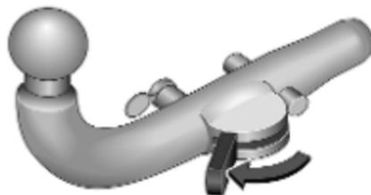
6. Den Hebel der Kugelstange in die vordere Position bewegen.
