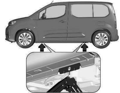
3. Sicherstellen, dass der Wagenheber richtig unter dem entsprechenden Aufnahmepunkt ausgerichtet ist.
