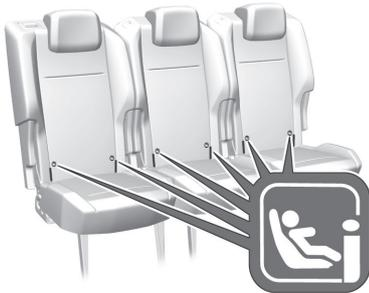
Für das Fahrzeug zugelassene ISOFIX-Kinderrückhaltesysteme an den ISOFIX-Befestigungen befestigen. Die speziellen Positionen für ISOFIX-Kindersicherheitssysteme sind in der Tabelle mit ISOFIX gekennzeichnet. Die ISOFIX-Befestigungshalterungen befinden sich unter dem i-Size-Symbol im Sitzbezug.
