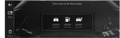
Im Fahrerinfodisplay kann ein Widget pro Seite angezeigt werden, während das Info-Display die Anzeige mehrerer Widgets unterstützt.
