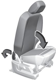
1. Den Hebel drücken, die Rückenlehne vollständig nach vorne klappen und den Hebel loslassen. Dann die Rückenlehne weiter nach unten drücken, bis sie komplett flach liegt.
