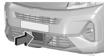
Die Radareinheit befindet sich in der Mitte des Frontstoßfängers.
