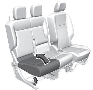
4. Zum Anheben der Sitzfläche den Hebel ziehen und die Sitzfläche zur Rückenlehne hin anheben, bis sie einrastet.
