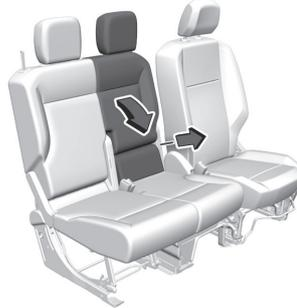
1. Die Rückenlehne am mittleren Sitz durch Ziehen an der Schlaufe umklappen.
