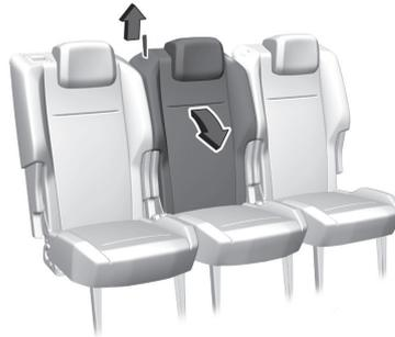
4. Je nach Version, muss die Rückenlehne am mittleren Sitz durch Ziehen an der Schlaufe umgeklappt werden.
