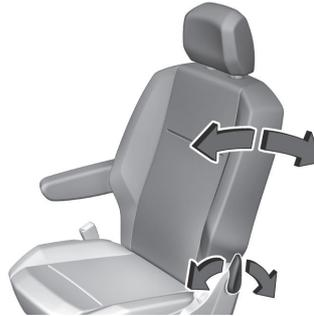
1. Über den Hebel, die Neigung einstellen und den Hebel loslassen.
