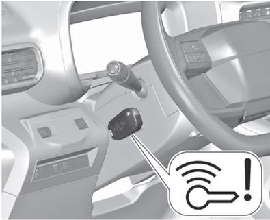
Elektronischen Schlüssel wie in der Abbildung gezeigt mit den Tasten nach außen an die Markierung an der Lenksäulenabdeckung halten. Bei Fahrzeugen mit Schaltgetriebe in den Leerlauf schalten, das Kupplungspedal betätigen, das Bremspedal betätigen und **Start/Stop** drücken.
