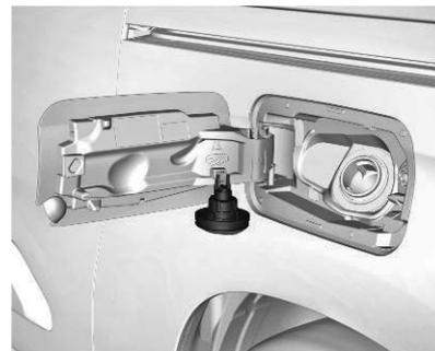
Der Deckel kann am Haken an der Tankklappe eingehängt werden. Die Tankdüse gerade am Einfüllstutzen ansetzen und mit geringem Kraftaufwand einstecken. Zum Tanken die Zapfpistole betätigen. Nach dem automatischen Abschalten des Tankvorgangs darf die Zapfpistole noch maximal zweimal erneut betätigt werden, um den Tank vollständig aufzufüllen.
