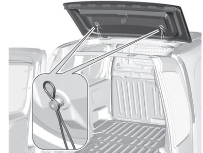
3. Über den Widerstandspunkt hinaus drücken, um die Leiterklappe mit den Stützen zu verriegeln.
