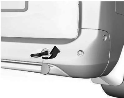
Abschleppöse bis zum Anschlag in waagrechtener Stellung einschrauben.
