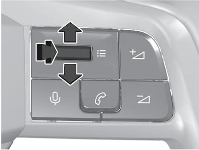
Kurzes Drücken: Anzeige der Einstellungen des Fahrzeugs. Schalten Sie nach oben oder unten und wählen Sie das Menü Klimaeinstellungen. Drücken Sie das Einstellrad, um die Auswahl zu bestätigen.
