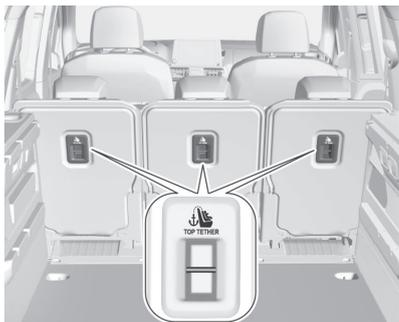
Zusätzlich zu den ISOFIX-Befestigungen, den Top-Tether-Befestigungsgurt an den Top-Tether-Befestigungsösen verankern. Die Positionen für ISOFIX-Kindersicherheitssysteme der
