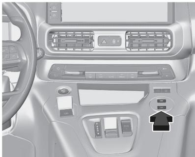
Die USB-Anschlüsse können zum Laden externer Geräte verwendet werden. Je nach Version kann ein USB-Anschluss für den Datenaustausch verwendet werden.
