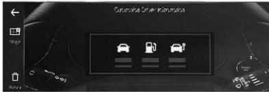
Im Fahrerinfodisplay kann ein Widget pro Seite angezeigt werden, während das Info-Display die Anzeige mehrerer Widgets unterstützt.
