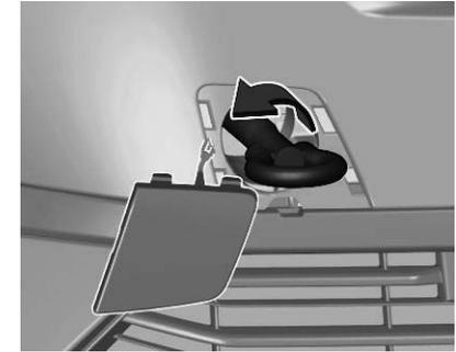
Abschleppöse bis zum Anschlag in waagerechter Stellung einschrauben. Abschleppseil - besser Abschleppstange - an der Abschleppöse befestigen. Die Abschleppöse darf nur zum Abschleppen und nicht zum Bergen des Fahrzeugs verwendet werden. Die Zündung einschalten, um die Lenksperre zu lösen und Bremsleuchten, Hupe und Scheibenwischer betätigen zu können.
