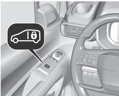
Je nach Version auf
