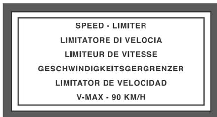
Wenn Ihr Fahrzeug mit einem solchen Geschwindigkeitsbegrenzer ausgerüstet ist, kann die Geschwindigkeit auf ein festes Tempolimit eingestellt werden. Auf einem Aufkleber im Fahrzeuginnenraum ist diese Höchstgeschwindigkeit angegeben.
