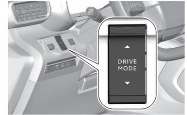
1. Drücken Sie die Taste **DRIVE MODE**; die verschiedenen Modi werden auf dem Kombiinstrument angezeigt.
