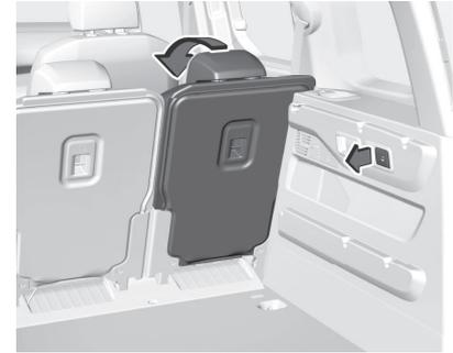
5. Alternativ die Sitzlehnen vom Laderaum umklappen: Den Hebel an der linken oder rechten Seitenwand des Laderaums ziehen, um die Rücksitzlehne umzuklappen.
