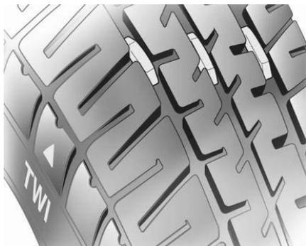
Die gesetzlich zulässige Mindestprofiltiefe (1,6 mm) ist erreicht, wenn das Profil bis zu einem Verschleißanzeiger (TWI = Tread Wear Indicator) abgefahren ist. Seine Lage wird durch Markierungen an der Reifenflanke angezeigt. Sollte der Verschleiß vorn größer sein als hinten, Vorderräder regelmäßig gegen Hinterräder tauschen. Sicherstellen, dass die Richtung der Raddrehung unverändert ist. Reifen altern, auch wenn sie nicht gefahren werden. Wir empfehlen, die Reifen alle sechs Jahre zu ersetzen.
