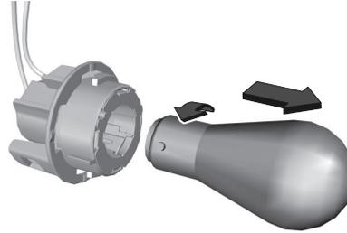
3. Die untere Lampenfassung zum Lösen gegen den Uhrzeigersinn drehen und die Lampe entfernen.
