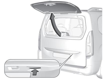
Nach dem Entriegeln die rechte Heckklappentaste drücken und die Heckscheibe öffnen.
