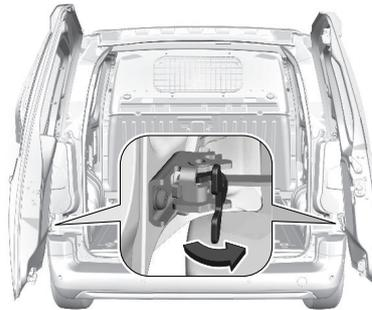
Die Türen werden durch Streben in der 90°-Position gehalten. Um die Türen bis 180° zu öffnen, auf die Arretierung drücken und die Türen in die gewünschte Position schwenken.
