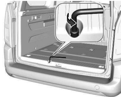
2. Radschlüssel an einer Sechskantschraube ansetzen. Linksherum drehen, bis der Reserveradhalter so weit abgesenkt ist, dass die Befestigung gelöst werden kann.
