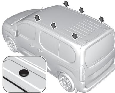
Um einen Dachträger zu befestigen, schrauben Sie die Kappen in den Dachleisten ab. Setzen Sie die Montagevorrichtungen wie vorgeschrieben in die Halterung ein.
