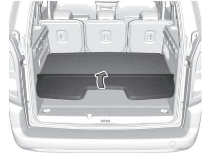
Die Laderaumabdeckung kann von hinten hochgeklappt werden, was eine größere Flexibilität im Laderaum ermöglicht.
