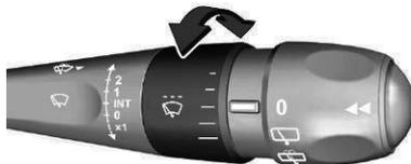
Bei Wischerhebel in Position INT kann durch Drehen des Rings eine von fünf Intervallstufen ausgewählt werden.
