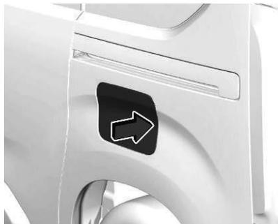
Bei Fahrzeugen mit elektronischem Schlüsselsystem kann die Tankklappe nur bei entriegeltem Fahrzeug geöffnet werden. Tankdeckel je nach Version durch Drücken oder Ziehen an der rechten unteren Ecke öffnen.
