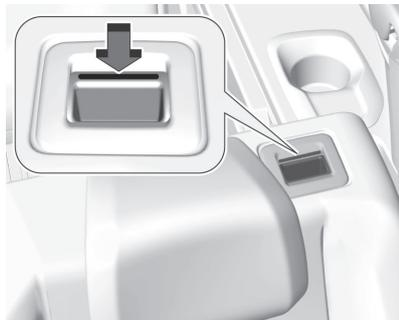
Die Rückenlehnen sind korrekt eingerastet, wenn die roten Markierungen neben dem Entriegelungsgriff nicht mehr sichtbar sind.
