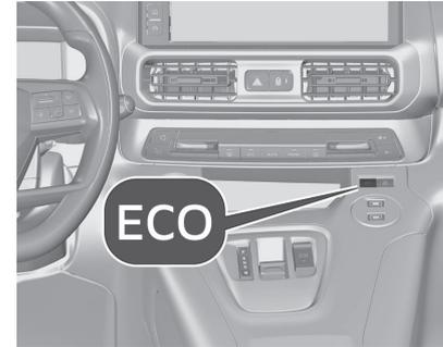
Dieser Modus passt die Einstellungen der Systeme an, um den Kraftstoffverbrauch zu reduzieren, zum Beispiel durch Optimieren der Schaltpunkte des Automatikgetriebes und Anpassen der Empfindlichkeit des Fahrpedals.
