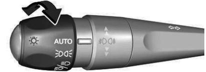
Bei aktivierter automatischer Lichtsteuerung schaltet das System abhängig von den äußeren Lichtverhältnissen und den Informationen des Wischersystems automatisch zwischen Tagfahrlicht und Scheinwerfern um.
