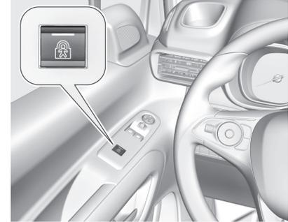
Je nach Version befindet sich die Taste
