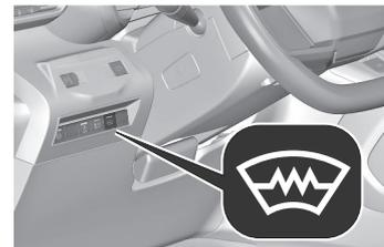
Die Heizung wird durch Drücken der Taste
