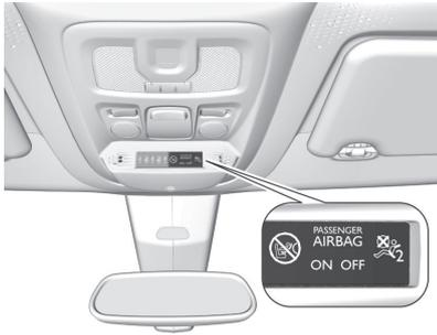
Wenn die Kontrollleuchte
