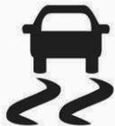
ESC und TC sind nach jedem Motorstart funktionsfähig, sobald die Kontrollleuchte
