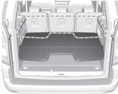
Die Laderaumabdeckung kann in zwei Positionen angebracht werden. Montieren Sie die Laderaumabdeckung, indem Sie die Halterungen auf beiden Seiten einrasten lassen.
