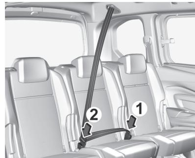
Untere Schließzunge in das linke Gurtschloss (1) am mittleren Sitz einstecken. Obere Schließzunge mit dem Sicherheitsgurt über das Becken und die Schulter ziehen, ohne ihn zu verdrehen, und in das rechte Gurtschloss (2) am mittleren Sitz einstecken. Zum Lösen des Sicherheitsgurts zuerst die Lösetaste der oberen Schließzunge am rechten Gurtschloss (2) drücken. Danach die Lösetaste der unteren Schließzunge am linken Gurtschloss (1) drücken. Der Sicherheitsgurt wird automatisch eingezogen.
