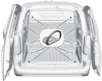
Die Verzurrösen können am Fahrzeugboden und / oder in der Seitenwand angebracht sein. Anzahl und Position der Verzurrösen kann je nach Fahrzeug variieren.
