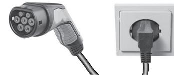
Die Hochvoltbatterie des Fahrzeugs kann an einer Haushaltssteckdose
