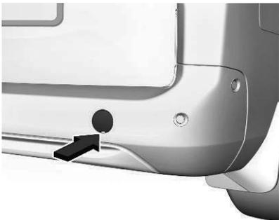
Die Spitze eines Schlitzschraubendrehers mit einem Tuch umwickeln, um den Lack zu schützen. Den Schraubendreher in den Schlitz am unteren Bereich der Abdeckung stecken. Die Kappe vorsichtig lösen. Die Abschleppöse befindet sich beim Wagenwerkzeug.
