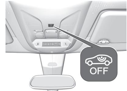
Wenn Tiere im Fahrzeug zurückgelassen werden, muss die Überwachung des Fahrzeuginnenraums abgeschaltet werden, weil laute Ultraschallsignale oder Bewegungen den Alarm auslösen. Auch ausschalten, wenn das Fahrzeug auf
