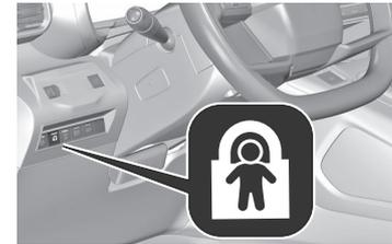
Fernbedientes System, mit dem das Öffnen der hinteren Türen über die Türinnengriffe und die Bedienung der hinteren Fensterheber verhindert werden können.
