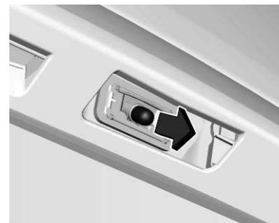
3. Die Lampe aus der Fassung ziehen und wechseln.
