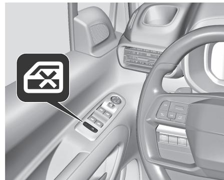
1. Zur Deaktivierung der elektrischen Fensterheber der hinteren Türen
