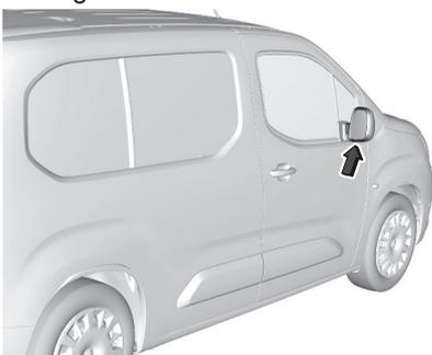
Die Kamera ist unten am Außenspiegel auf der Beifahrerseite montiert. Es wird ein begrenzter Bereich auf dem Display angezeigt. Die auf dem Display angezeigten Abstände weichen von den tatsächlichen Abständen ab.
