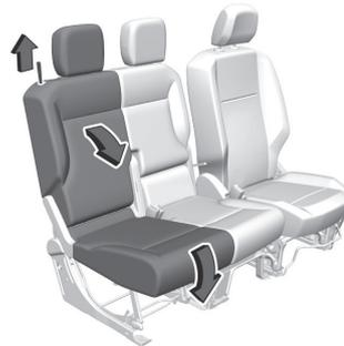
2. Die äußere Rückenlehne durch Ziehen an der Schlaufe umklappen.
