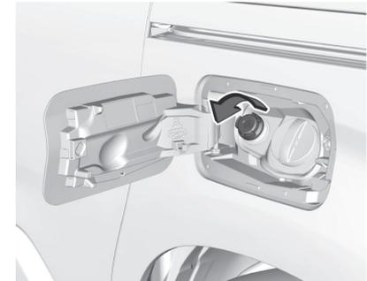
4. Die Schutzkappe vom Einfüllstutzen abschrauben.
