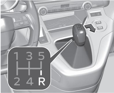
Bei Ausstattung mit 5-Gang-Getriebe zum Einlegen des Rückwärtsgangs bei stehendem Fahrzeug und Motor im Leerlauf das Kupplungspedal drücken und den Wählhebel nach rechts und nach hinten bewegen.
