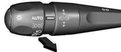
Um die Lichthupe zu aktivieren, den Hebel kurz bis zum Widerstandspunkt ziehen.
