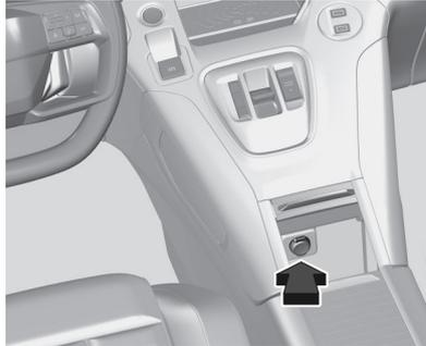
Hinter der Abdeckung des Ablagefachs befindet sich eine 12-V-Steckdose. Abdeckung zum Öffnen nach oben drücken. Je nach Version kann die 12-V-Zubehörsteckdose frei zugänglich sein.
