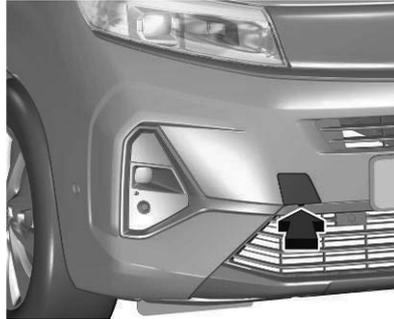
Die Spitze eines Schlitzschraubendrehers mit einem Tuch umwickeln, um den Lack zu schützen. Den Schraubendreher in den Schlitz am unteren Bereich der Abdeckung stecken. Die Kappe vorsichtig lösen. Die Abschleppöse befindet sich beim Wagenwerkzeug.
