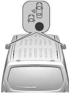
Erkennt das System bei Vorwärtsfahrt ein Fahrzeug im toten Winkel, leuchtet im entsprechenden Seitenspiegel eine LED auf.
