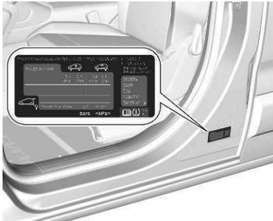
Das Reifendruckhinweisschild am linken vorderen Türrahmen gibt die Originalreifen und die entsprechenden Reifendrücke an.
