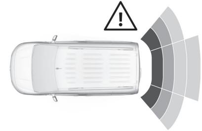
Außerdem wird der Abstand zu Hindernissen hinter dem Fahrzeug durch sich ändernde Abstandslinien im Info-Display angezeigt. Bei einem sehr geringen Abstand wird ⚠ angezeigt.
