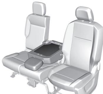
Die Lehne des mittleren Beifahrersitzes ist mit einer Dokumentenablage versehen.
