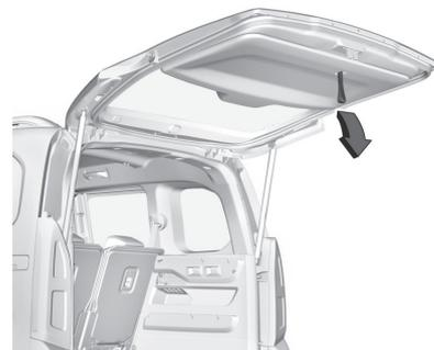
Griff auf der Innenseite verwenden. Beim Schließen nicht die mittlere Heckklappentaste drücken, da dadurch die Heckklappe erneut entriegelt wird.
