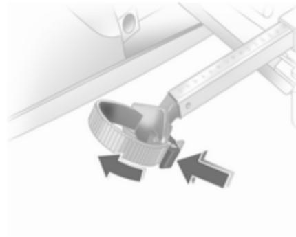
Entriegelungshebel am Spannband drücken und Spannband herausziehen.
