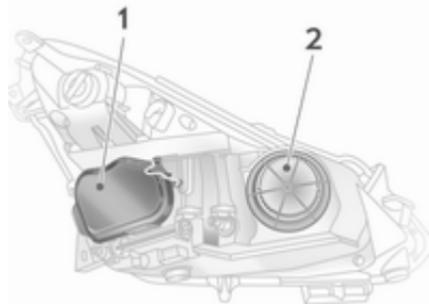
Scheinwerfer haben getrennte Systeme für Abblendlicht 1 (äußere Lampen) und Fernlicht 2 (innere Lampen). Hinter der Kappe für das Fernlicht befindet sich auch das Abbiegelicht.
