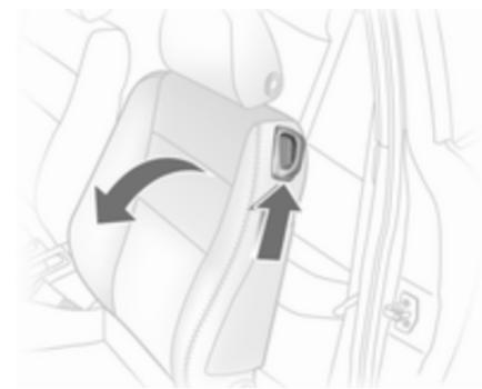
Entriegelungshebel anheben und Sitzlehne nach vorn klappen. Entriegelungshebel absenken, die Lehne rastet in nach vorn geklappter Lage ein. Sitz nach vorn schieben.
