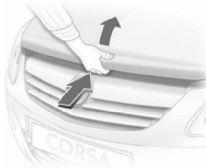
Sicherungsgriff hochdrücken und Motorhaube öffnen.
