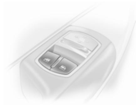
Zum Öffnen oder Schließen des Fensters Schalter betätigen.
