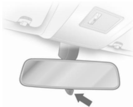
Hebel an der Unterseite schwenken, um Blendwirkung zu reduzieren.
