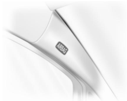
Das Kopf-Airbag-System besteht aus je einem Airbag an jeder Seite des Dachrahmens. Diese Stellen sind durch das Wort **AIRBAG** an den Dachsäulen gekennzeichnet.
