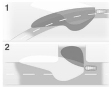
Der Lichtstrahl schwenkt in Abhängigkeit von der Lenkradstellung und der Geschwindigkeit.
