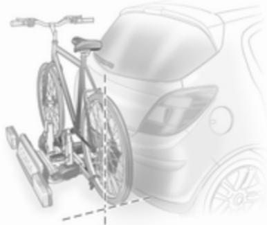
Fahrrad in Fahrzeuginnenrichtung ausrichten: Tretlagerfixierung etwas lösen.
