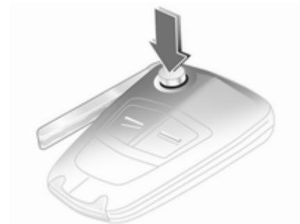
Zum Ausklappen auf den Knopf drücken. Zum Einklappen zuerst auf den Knopf drücken.
