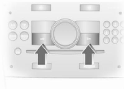
Menüpunkte über Menüs und mit den Tasten auf dem Infotainment System auswählen. Mit OK-Taste markierten Punkt auswählen oder einen Befehl bestätigen.
