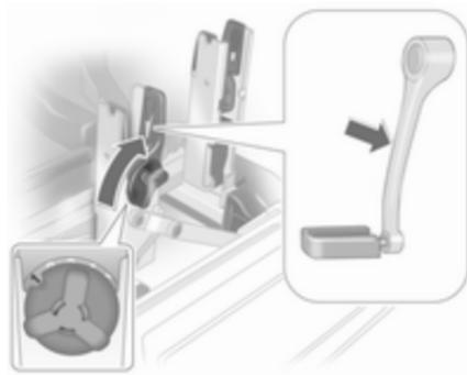
Entriegelungshebel drücken und Radaufnahmen herausziehen.
