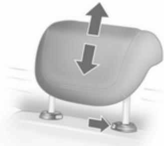
Die Höhe der Kopfstützen lässt sich auf zwei Positionen einstellen. Zum Einstellen in die erste Position Kopfstütze nach oben ziehen. Zum Einstellen in die zweite Position die im Bild markierte Rastfeder drücken und die Kopfstütze ganz nach oben schieben. Zur Verstellung nach unten die
