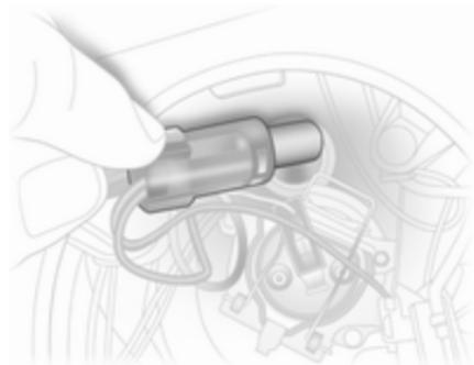
3. Glühlampe aus der Fassung nehmen und neue Glühlampe einsetzen.
