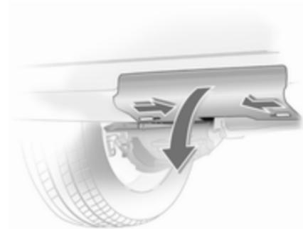
Beide Riegel nach innen schieben und Abdeckung am Stoßfänger abnehmen.
