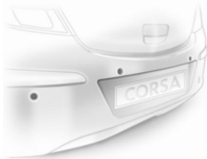
Die Einparkhilfe erleichtert das Einparken durch Messen des Abstands zwischen Fahrzeug und Hindernissen. Dennoch trägt der Fahrer beim Einparken die volle Verantwortung. Das System besteht aus vier Ultraschall-Parksensoren, die sich in den Stoßfängern befinden.
