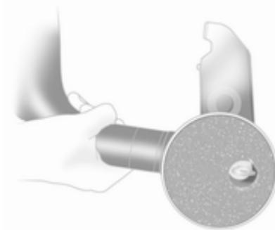
Schutzkappe über den Drehgriff mit Schlüssel stecken.
