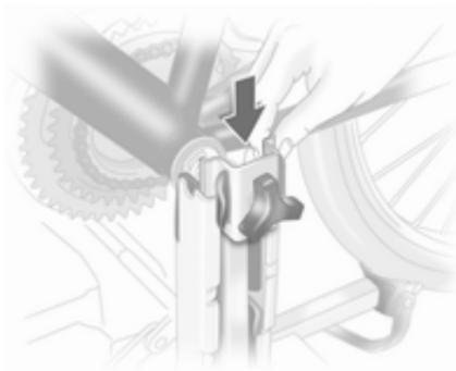
Tretkurbeaufsicherung von oben in die jeweils äußere Schiene der Tretkurbeaufnahme einführen und bis zum Anschlag nach unten schieben.
