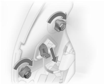
2. Kabelstecker durch Druck auf Latsche von Lampenträger abziehen.
