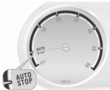
Ein Autostop wird auf dem Drehzahlmesser angezeigt, indem die Nadel auf der Position **AUTOSTOP** ruht.
