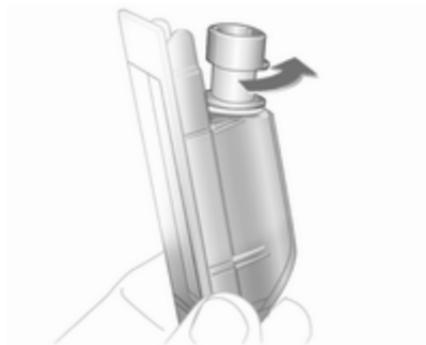
4. Lampenfassung durch Drehen nach links ausrasten.
