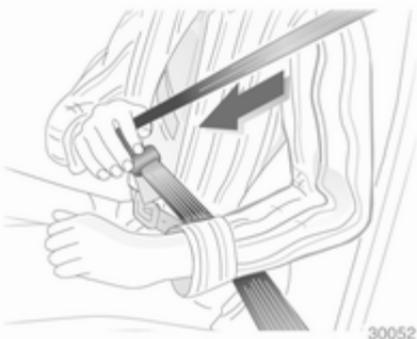
Gurt aus dem Aufroller herausziehen, unverdreht über den Körper legen und die Schlosszunge in das Gurtverschluss einstecken, bis sie einrastet. Den Beckengurt während der Fahrt durch Ziehen am Schultergurt regelmäßig spannen.
