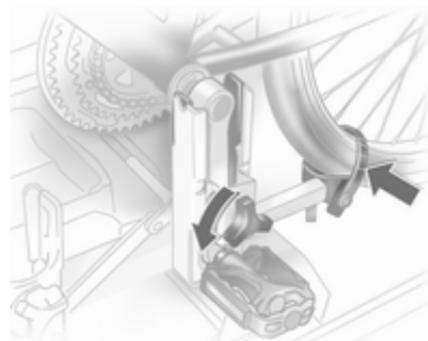
Spannbänder an beiden Fahrradreifen lösen.
