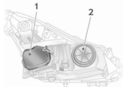
Scheinwerfer haben getrennte Systeme für Abblendlicht **1** (äußere Lampen) und Fernlicht **2** (innere Lampen).
