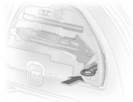
Die Abschleppöse befindet sich beim Wagenwerkzeug ↗ 169. Die Abschleppöse ist in einer Aussparung untergebracht.
