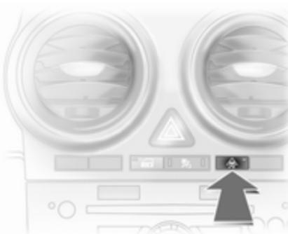
ESP®Plus kann durch Drücken der Taste
