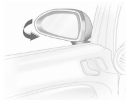
Die Außenspiegel lassen sich durch leichten Druck auf die Außenkante des Gehäuses beklappen.
