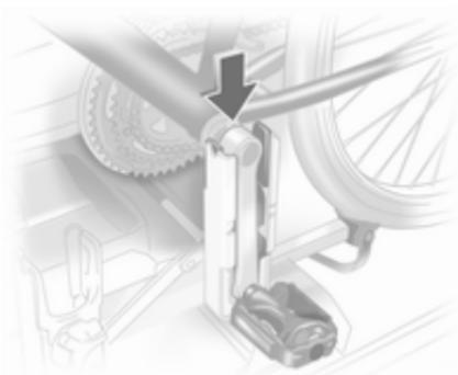
Fahrrad aufsetzen. Dabei muss die Tretkurbel wie in der Abb. dargestellt in den Schacht der Tretkurbeaufnahme gesetzt werden.
