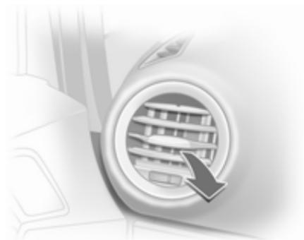
Zum Schließen der Belüftungsdüse das Rändelrad bis zum Anschlag nach rechts oder links drehen.
