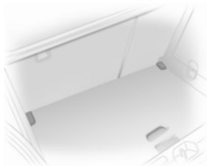
Bei Montage in oberer Position kann der Raum zwischen Ladeboden und Abdeckung der Reserveradmulde als Ablagefach genutzt werden.
