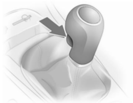
Zum Einlegen des Rückwärtsgangs nach Betätigen des Kupplungspedals bei stehendem Fahrzeug 3 Sekunden warten, anschließend den Entriegelungsknopf am Wählhebel drücken und den Gang einlegen. Lässt sich der Gang nicht einlegen, den Wählhebel in Leerlaufstellung führen, das Kupplungspedal loslassen und wieder betätigen. Nochmals schalten.
