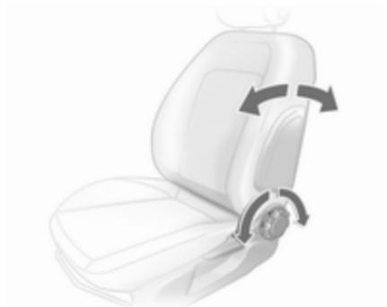
Handrad drehen. Zum Einstellen Rückenlehne entlasten.
