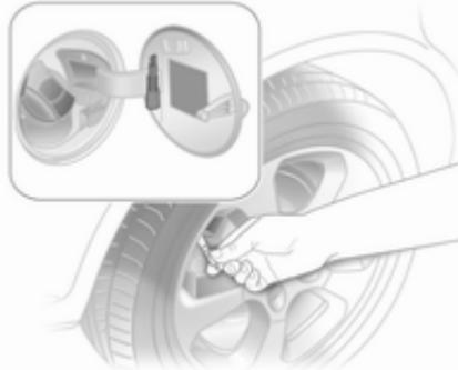
Reifendruck  $\rightarrow$  210 und auf dem Aufkleber an der Innenseite der Tankklappe.
