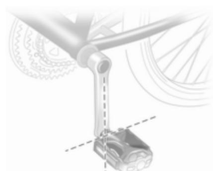
Die linke Tretkurbel (ohne Kettenkranz) senkrecht nach unten drehen. Das Pedal an der linken Tretkurbel muss waagrecht stehen.
