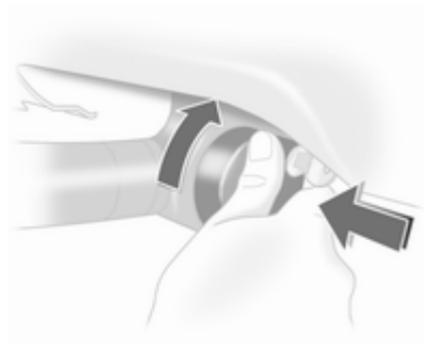
Schlüssel in Schloss stecken und Kugelstange aufschließen.
