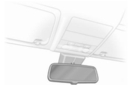
Bei Nacht wird die Blendwirkung durch nachfolgende Fahrzeuge automatisch reduziert.
