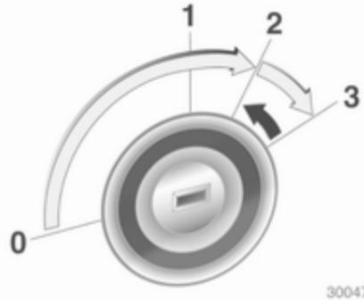
Kupplung und Bremse betätigen, Automatikgetriebe in **P** oder **N**. Gaspedal nicht betätigen.
