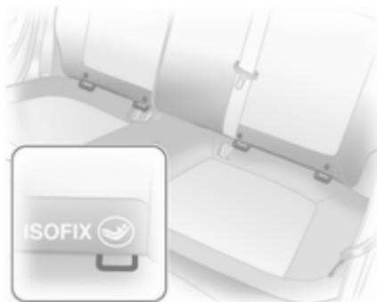
Für das Fahrzeug zugelassene ISOFIX Kindersicherheitssysteme an den Befestigungsbügeln befestigen.
