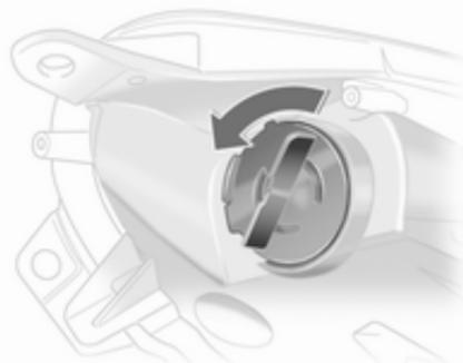
1. Lampenfassung durch Drehen nach links ausrasten.
