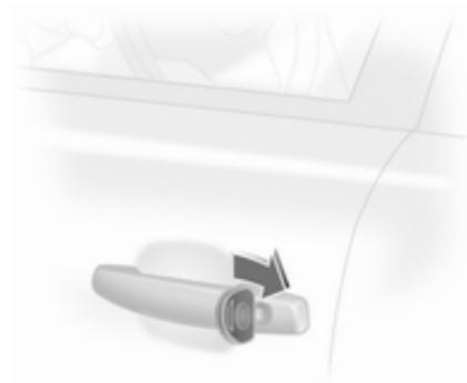
Schlüssel im Fahrertürschloss in Richtung Fahrzeugheck drehen.
