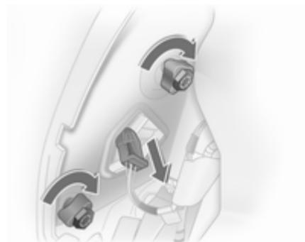
2. Kabelstecker durch Druck auf Lasche von Lampenträger abziehen.
