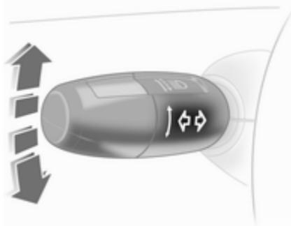
Hebel nach oben = Blinker rechts
