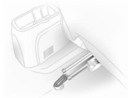
Als Hinweis auf die Befestigungsösen zur Montage des Kindersicherheitssystems befindet sich an der Verkleidung der hinteren Dachsäule und den Befestigungspunkten ein Symbol.
