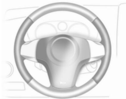
Das Lenkrad wird bei laufendem Motor und bei einem Autostop an den in der Abbildung gezeigten Stellen beheizt.
