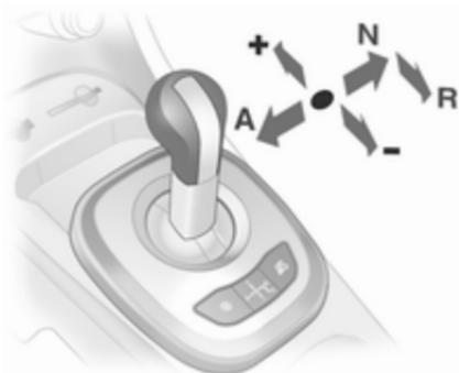
Den Wählhebel immer bis zum Anschlag in die entsprechende Richtung führen. Nach Loslassen kehrt er automatisch in die Mittelstellung zurück.
