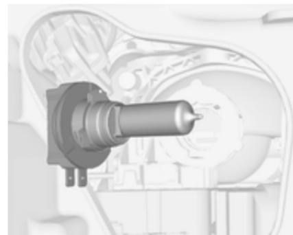
3. Neue Glühlampe so in den Reflektor einsetzen, dass die Fixiernase der Lampenfassung mit der Aussparung des Reflektors übereinstimmt.
