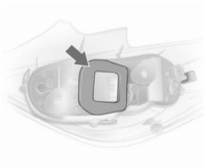
8. Sicherstellen, dass die Dichtung am Lampenträger wie in der Abbildung gezeigt angesetzt ist. Runde Dichtung auf Befestigungsschraube stecken.
