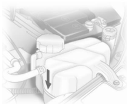
Bei kaltem Kühlsystem sollte der Kühlmittelstand über der **KALT/COLD**-Markierung liegen. Bei zu niedrigem Füllstand auffüllen.
