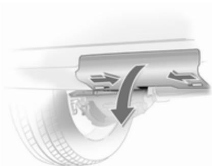
Beide Riegel nach innen schieben und Abdeckung am Stoßfänger abnehmen.
