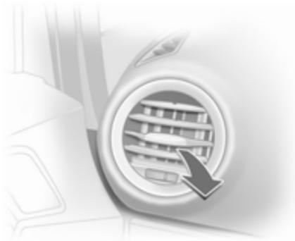
Zum Schließen der Belüftungsdüse das Rändelrad bis zum Anschlag nach rechts oder links drehen.
