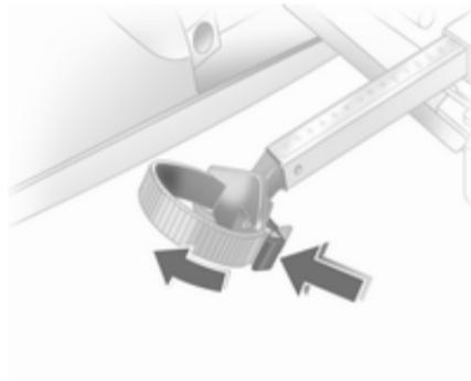
Entriegelungshebel am Spannband drücken und Spannband herausziehen.
