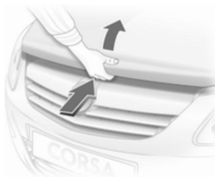
Sicherungsgriff hochdrücken und Motorhaube öffnen.
