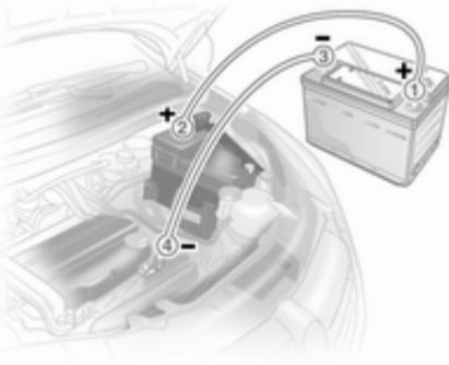
Die Kabel so führen, dass sie nicht von sich drehenden Teilen im Motorraum erfasst werden können.
