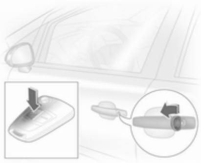
Schlüssel im Fahrertürschloss nach vorn drehen oder die Taste
