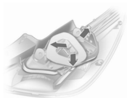
5. Drei Sperrungen an den Außenseiten des Lampenträgers leicht nach außen drücken und Lampenträger herausnehmen.
