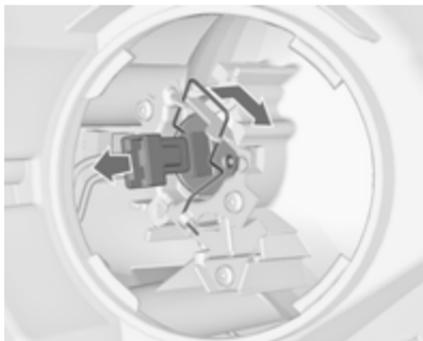
3. Federdrahtbügel aus den Haltenasen austrasten und zur Seite schwenken.
