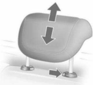
Die Höhe der Kopfstützen lässt sich auf zwei Positionen einstellen. Zum Einstellen in die erste Position Kopfstütze nach oben ziehen. Zum Einstellen in die zweite Position die im Bild markierte Rastfeder drücken und die Kopfstütze ganz nach oben schieben. Zur Verstellung nach unten die im Bild markierte Rastfeder drücken und die Kopfstütze nach unten schieben.
