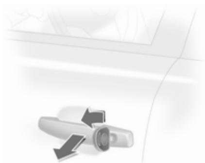
Schlüssel im Fahrertürschloss in Richtung Fahrzeugvorderseite drehen.
