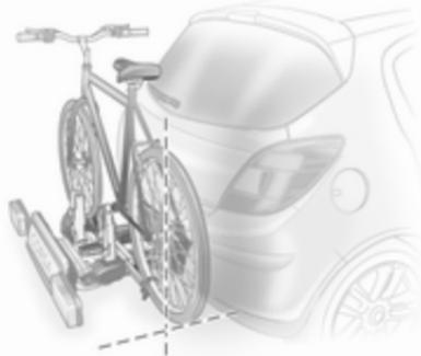
Fahrrad in Fahrzeuggängsrichtung ausrichten: Tretlagerfixierung etwas lösen.
