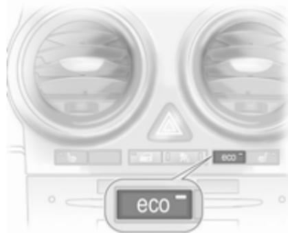
Die Stopp-Start-Automatik lässt sich durch Drücken der Taste **eco** manuell deaktivieren. Die Deaktivierung wird durch das Erlöschen der LED auf der Taste angezeigt.
