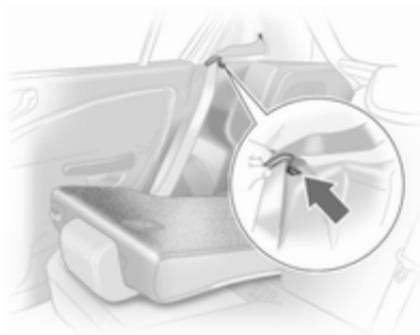
Rücksitzlehnen aufrichten und Verriegelungen auf beiden Seiten hörbar einrasten lassen. Nach der Verriegelung darf die rote Markierung nicht mehr hervorste-
