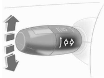
Hebel nach oben = Blinker rechts
