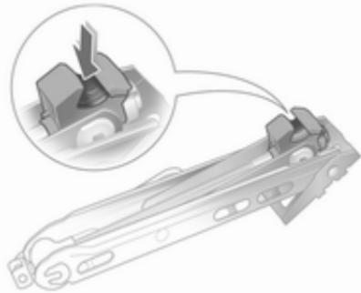
4. Wagenheber auf die erforderliche Höhe einstellen. Direkt unter dem Wagenheberaufnahme punkt so positionieren, dass er nicht abrutschen kann.
