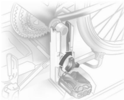
Tretkurbel durch Drehen der Klemmschraube an der Tretkurbeaufsicherung festklemmen.
