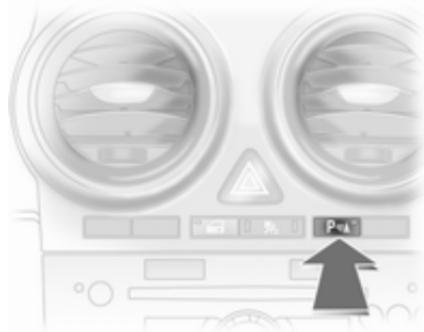
Bei Einlegen des Rückwärtsgangs schaltet sich das System automatisch ein.
