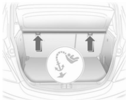
Top-Tether Kindersicherheitssysteme an den Befestigungsösen an der Rückseite der Sitzlehnen der Rücksitze und im hinteren Fußraum an der Sitzschiene des Beifahrersitzes befestigen. Der Gurt muss zwischen den beiden Führungsstangen der Kopfstütze verlaufen.
