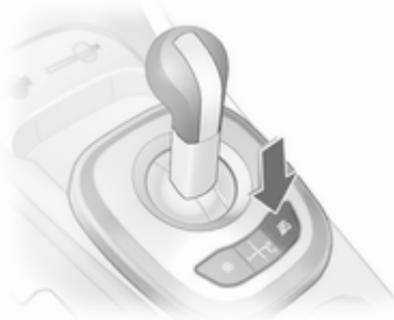
Bei eingeschaltetem Sport-Modus werden die Schaltzeiten verkürzt und die Gänge bei höheren Drehzahlen geschaltet, jedoch nicht bei eingeschaltetem Geschwindigkeitsregler.
