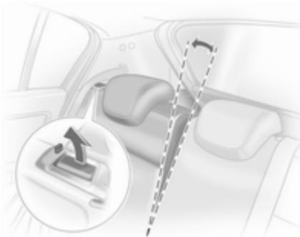
Entriegelungsgriff ziehen, Sitzlehne bis in die senkrechte Position nach vorn ziehen und einrasten lassen.
