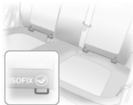
Für das Fahrzeug zugelassene ISOFIX Kindersicherheitssysteme an den Befestigungsbügel befestigen.
