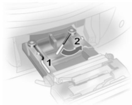
Zuerst den linken Spannhebel (1), danach den rechten Spannhebel (2) bis zum Anschlag schwenken. Beide Spannhebel müssen nach hinten zeigen, weil sonst keine sichere Funktion gewährleistet ist.
