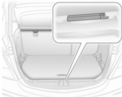
Warndreieck in der hinteren Laderaumwand unterbringen: Warndreieck zuerst links in Aussparung schieben und dann rechts in Führung stecken.
