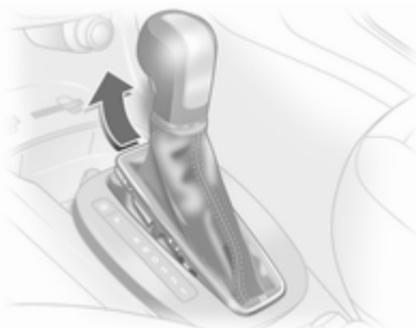
2. Wählhebelverkleidung vorn von der Mittelkonsole lösen, nach oben klappen und nach links drehen.
