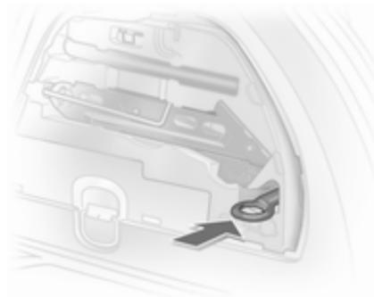
Die Abschleppöse befindet sich beim Wagenwerkzeug ↻ 166. Die Abschleppöse ist in einer Aussparung untergebracht.
