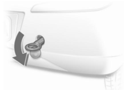
Abschleppöse bis zum Anschlag in waagerechter Stellung einschrauben.
