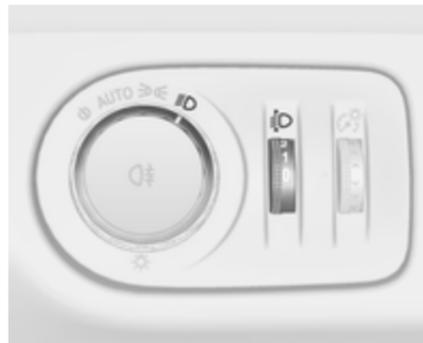
Leuchtweite der Fahrzeugbeladung anpassen, um das Blenden anderer zu vermeiden: Das Rändelrad ⇨ drehen, bis auf der Kilometeranzeige die erforderliche Einstellung angezeigt wird. Die Anzeige erscheint bei Einschalten des Abblendlichts oder bei jeder Veränderung der Leuchtweite 4 Sekunden lang zusammen mit dem Symbol ⇨.
