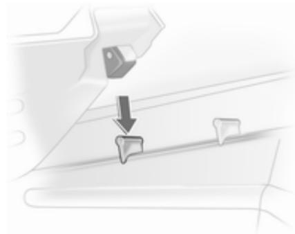
Die drei anderen Segmente zum Ausbau (Reihenfolge 2 bis 4) hinten anheben, ausrasten, verdrehen und herausnehmen.
