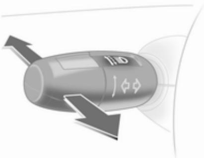
Zum Umschalten von Abblendlicht auf Fernlicht Hebel nach vorne drücken.
