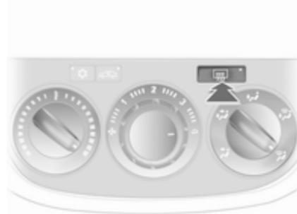
Die Heizung wird durch Drücken der Taste
