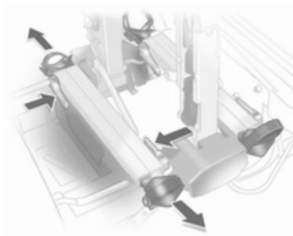
Entriegelungshebel drücken und Radaufnahmen herausziehen.
