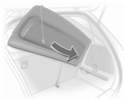
Abdeckung hinten bis zum Ausrasten hochheben, schrägstellen und herausnehmen.
