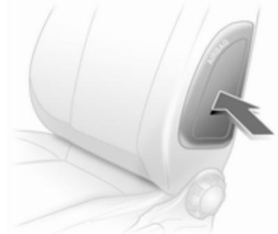
Das Seiten-Airbag-System besteht aus einem Airbag in der Rückenlehne jedes Vordersitzes und in den Rückenlehnen der äußeren Rücksitze. Diese Stellen sind mit dem Wort **AIRBAG** gekennzeichnet.
