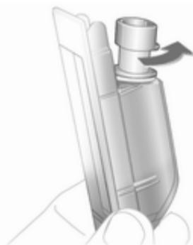
4. Lampenfassung durch Drehen nach links ausrasten.
