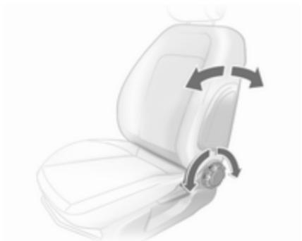
Handrad drehen. Zum Einstellen Rückenlehne entlasten.
