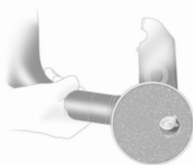
Schutzkappe über den Drehgriff mit Schlüssel stecken.
