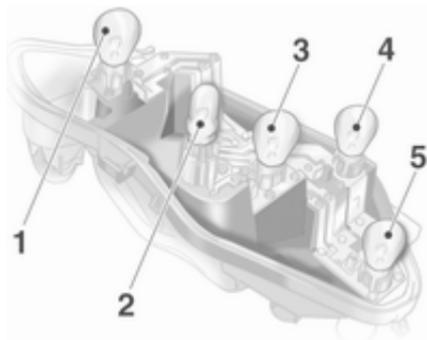
6. Glühlampe etwas in die Fassung hineindrücken, nach links drehen und herausnehmen. Neue Glühlampe einsetzen.
