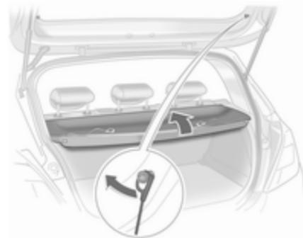
Abdeckung hinten bis zum Ausrasten hochheben und herausnehmen.
