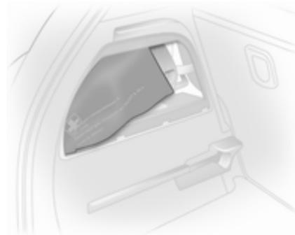
Die Verbandstasche im Fach in der linken Laderaumwand unterbringen. Zum Öffnen des Fachs die Abdeckung ausrasten und öffnen.
