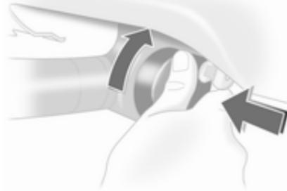
Schlüssel in Schloss stecken und Kugelstange aufschließen.
