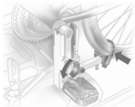
Spannbänder an beiden Fahrradreifen lösen.
