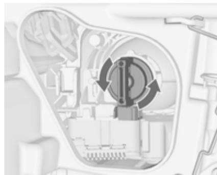
2. Lampenfassung durch Drehen nach links ausrasten.
