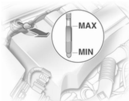
Wenn der Motorölstand in den Bereich der Nachfüllmarke **MIN** abgesunken ist, Motoröl nachfüllen.
