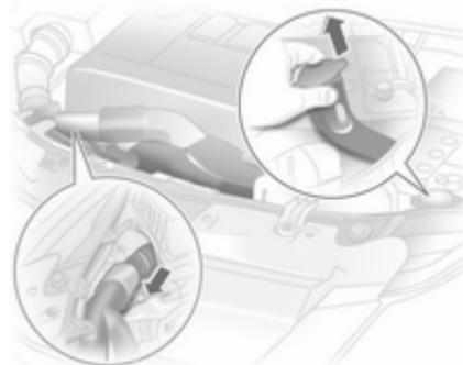
Für den Lampenwechsel vom Motorraum aus auf der rechten Seite Luftschlauch vom Luftfilter abziehen.
