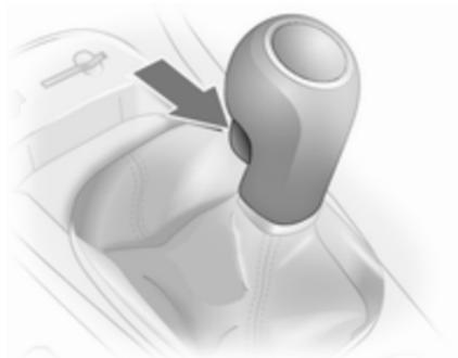
Rückwärtsgang: Nach dem Treten des Kupplungspedals bei stehendem Fahrzeug 3 Sekunden warten, dann den Knopf am Wählhebel drücken und den Gang einlegen.
