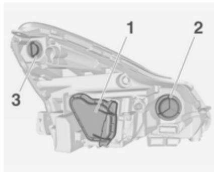
Die Scheinwerfer verfügen über getrennte Vorrichtungen für Abblend- und Fernlicht 1 (äußere Lampe), Abbiegelicht 2 (innere Lampe) und Tagfahrlicht/Standlicht 3.
