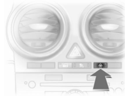
ESP®Plus kann durch Drücken der Taste
