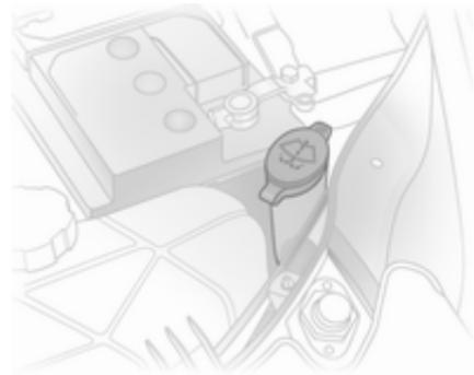
Mit einem Gemisch aus sauberem Wasser und einer geeigneten Menge frostschutzmittelhaltiger Waschflüssigkeit auffüllen. Das richtige Mischungsverhältnis ist auf dem Behälter der Waschflüssigkeit angegeben.
