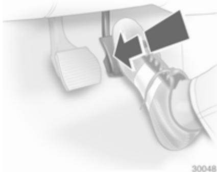
Beim Durchtreten des Gaspedals über den Druckpunkt hinaus wird abhängig von der Motordrehzahl in einen niedrigeren Gang geschaltet.
