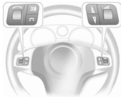
Das Infotainment System und das Info-Display können mit den Stellrädern und Tasten am Lenkrad bedient werden.
