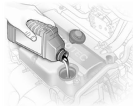
Wir empfehlen, das gleiche Motoröl zu verwenden wie eingefüllt ist.
