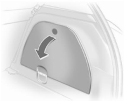
Zum Öffnen des Fachs die Abdeckung ausrasten und aufklappen.
