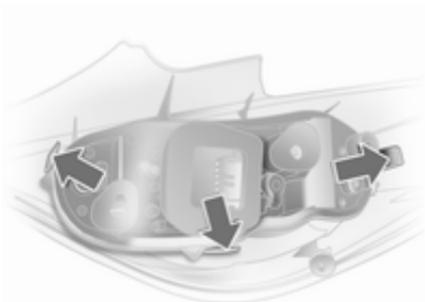
5. Drei Sperrungen an den Außen-seiten des Lampenträgers leicht nach außen drücken und Lampenträger herausnehmen.
