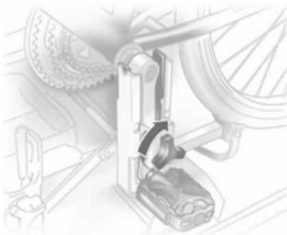
Tretkurbel durch Drehen der Klemmschraube an der Tretkurbelbefixierung festklemmen.
