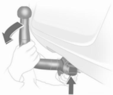
Gespannte Kugelstange in die Aufnahmeöffnung einführen und kräftig bis zum hörbaren Einrasten nach oben drücken.
