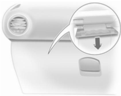
In Rechtslenkern befindet sich der Sicherungskasten hinter einer Abdeckung im Handschuhfach. Handschuhfach öffnen und Abdeckung entfernen. Zum Schließen Abdeckung zuerst ansetzen und dann einrasten.
