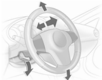
Hebel entriegeln, Lenkrad einstellen, Hebel einrasten und darauf achten, dass er komplett verriegelt ist. Lenkrad nur bei stehendem Fahrzeug und gelöster Lenkradsperre einstellen.
