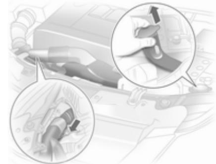
Für den Lampenwechsel vom Motorraum aus auf der rechten Seite Luftschlauch vom Luftfilter abziehen.
