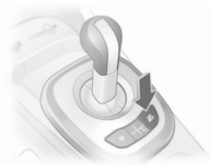
Bei eingeschaltetem Sport-Modus werden die Schaltzeiten verkürzt und die Gänge bei höheren Drehzahlen geschaltet, jedoch nicht bei eingeschaltetem Geschwindigkeitsregler.
