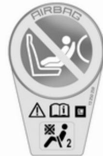
Zusätzlich befindet sich ein Warnaufkleber seitlich an der Instrumententafel, der bei geöffneter Beifahrertür sichtbar ist.
