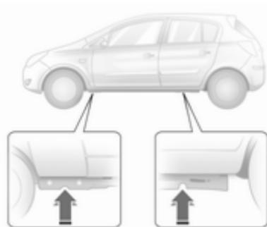
3. Sicherstellen, dass der Wagenheber an den Aufnahmen richtig ausgerichtet ist.
