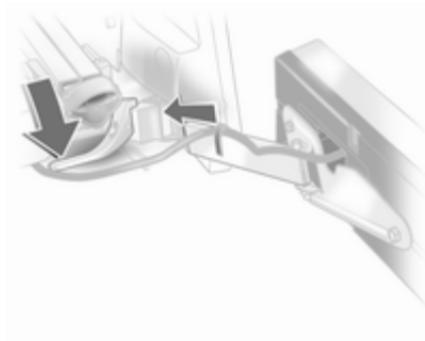
Spannhebel nach unten drücken und Lampenträger in die Halterung drücken, bis er einrastet.
