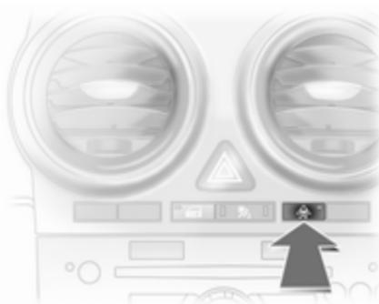
ESP®Plus kann durch Drücken der Taste
