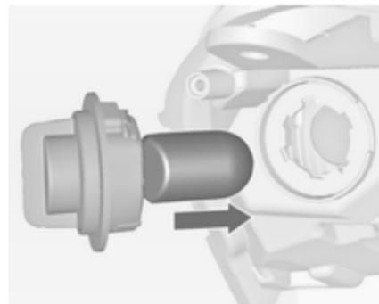
2. Glühlampe aus der Fassung nehmen und neue Glühlampe einsetzen.
