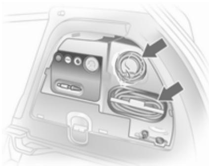
1. Dichtmittelflasche und Halter mit Luftschlauch aus dem Einsatz nehmen.
