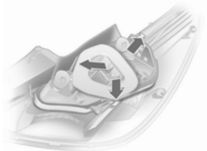
5. Drei Sperrungen an den Außen-seiten des Lampenträgers leicht nach außen drücken und Lampenträger herausnehmen.
