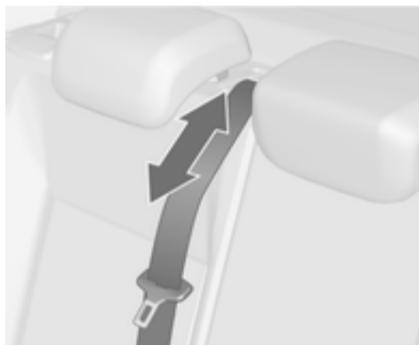
Der Sicherheitsgurt des Mittelsitzes könnte blockiert werden, wenn die Rückenlehne zu schnell hochgeklappt wird. Um den Aufroller zu ent-
