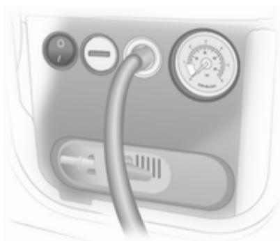
8. Den Ein/Aus-Schalter am Kompressor drücken. Der Reifen wird mit dem Dichtmittel gefüllt.
