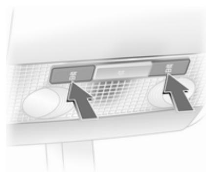
Betätigung mit Tasten
