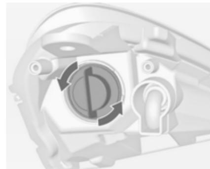
1. Lampenfassung **3** durch Drehen nach links lösen.
