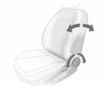
Handrad drehen. Zum Einstellen Rückenlehne entlasten.
