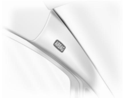
Das Kopf-Airbag-System besteht aus je einem Airbag an jeder Seite des Dachrahmens. Diese Stellen sind durch das Wort **AIRBAG** an den Dachsäulen gekennzeichnet.
