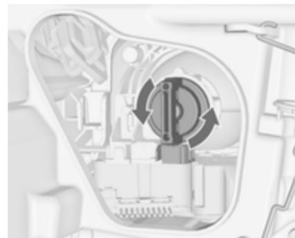
2. Lampenfassung durch Drehen nach links austrasten.
