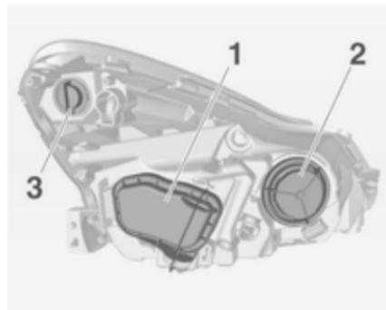
Die Scheinwerfer verfügen über getrennte Vorrichtungen für Abblendlicht **1** (äußere Lampe), Fernlicht **2** (innere Lampe) und Tagfahrlicht/Standlicht **3**.
