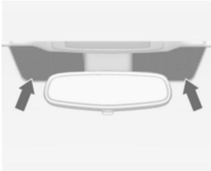
Die gekennzeichneten Bereiche der Windschutzscheibe hinter dem Innenrückspiegel sind nicht beschichtet. Geräte für das Aufzeichnen von elektronischen Daten bzw. für die Gebührenbezahlung müssen in diesen Bereichen befestigt werden. Andernfalls treten möglicherweise Störungen beim Aufzeichnen der Daten auf.
