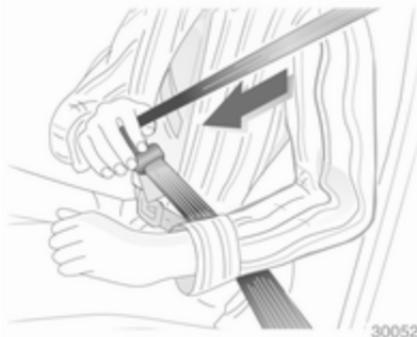
Gurt aus dem Aufroller herausziehen, unverdreht über den Körper legen und die Schlosszunge in das Gurtschloss einstecken, bis sie einrastet. Den Beckengurt während der Fahrt durch Ziehen am Schultergurt regelmäßig spannen.
