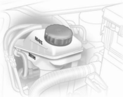
Der Bremsflüssigkeitsstand muss zwischen **MIN** und **MAX** liegen.
