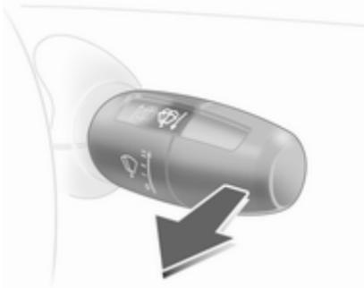
Hebel ziehen. Waschflüssigkeit spritzt auf die Windschutzscheibe und der Wischer wird für einige Wischbewegungen eingeschaltet.
