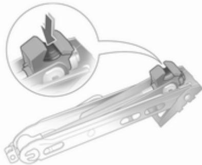
4. Den Wagenheber auf die erforderliche Höhe einstellen. Den Wagenheber direkt unter der Aufnahme positionieren, damit er nicht abrutschen kann.
