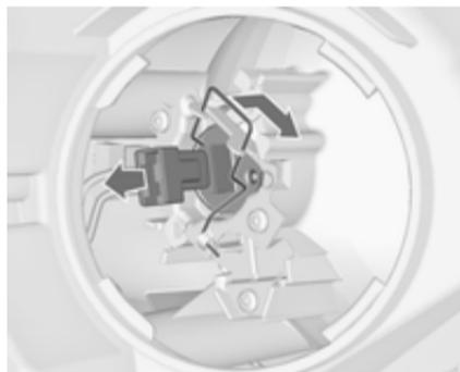
3. Federdrahtbügel aus den Haltenasen ausrasten und zur Seite schwenken.
