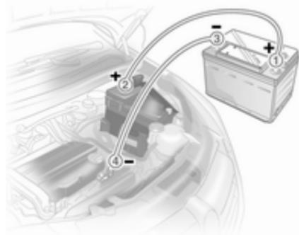
Die Kabel so führen, dass sie nicht von sich drehenden Teilen im Motorraum erfasst werden können.
