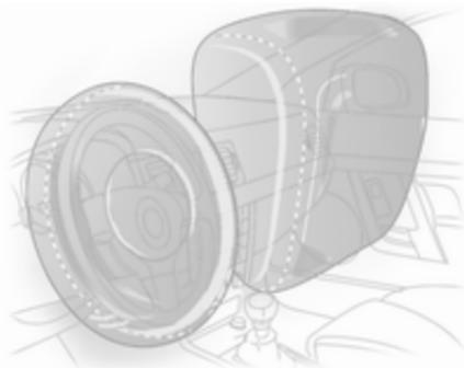
Die Vorwärtsbewegung der Fahrzeuginsassen auf den Vordersitzen wird verzögert. Dadurch sinkt deutlich die Gefahr von Verletzungen an Oberkörper und Kopf.
