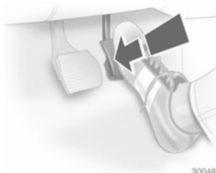
Beim Durchtreten des Gaspedals über den Druckpunkt hinaus wird abhängig von der Motordrehzahl in einen niedrigeren Gang geschaltet.
