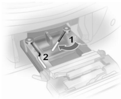
Zuerst den rechten Spannhebel (1), danach den linken Spannhebel (2) nach vorn schwenken, bis sie in ihrer jeweiligen Aufnahme einrasten.
