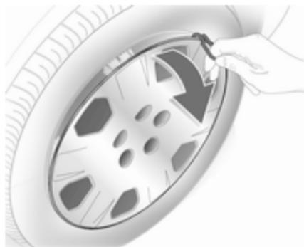
1. Radabdeckung mit dem Haken abziehen. Wagenwerkzeug  $\diamond$  168.
