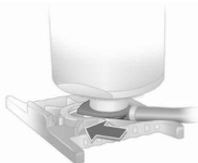
3. Dichtmittelflasche auf Halter stecken. Sicherstellen, dass die Flasche nicht umfällt.
