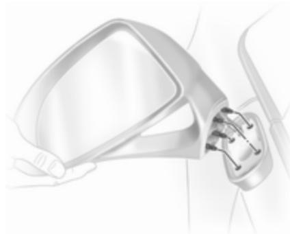
Corsa OPC: Die Außenspiegel rasten zur Sicherheit der Fußgänger aus der Aufnahme, wenn ein Fußgänger dagegenstößt. Spiegelgehäuse mit Rastnasen an Aufnahme ansetzen und durch leichten Schlag einrasten.
