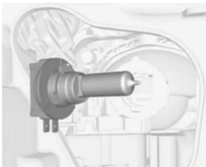
3. Neue Glühlampe so in Reflektor einführen, dass die Fixiernase des Lampenträgers mit der Aussparung des Reflektors übereinstimmt.
