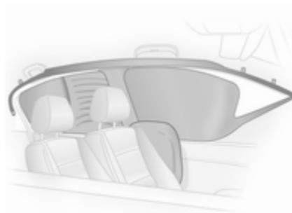
Die Gefahr von Verletzungen am Kopf bei einem Seitenaufprall wird deutlich verringert.
