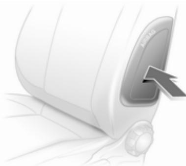
Das Seiten-Airbag-System besteht aus einem Airbag in der Rückenlehne jedes Vordersitzes und in den Rückenlehnen der äußeren Rücksitze. Diese Stellen sind mit dem Wort **AIRBAG** gekennzeichnet.
