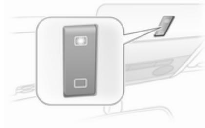
Betätigung mit Wipptaste in der Dachkonsole.
