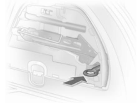
Die Abschleppöse befindet sich beim Wagenwerkzeug ↻ 168. Die Abschleppöse ist in einer Aussparung untergebracht.
