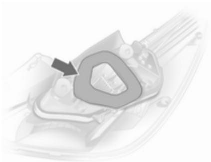
8. Sicherstellen, dass die Dichtung am Lampenträger wie in der Abbildung gezeigt angesetzt ist.
