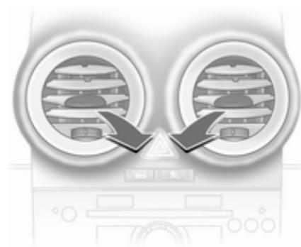
Durch Drehen des Rändelrades zwischen rechtem und linkem Anschlag und Aufrichten bzw. Absenken der waagerechten Lamellen Richtung des Luftstroms einstellen.
