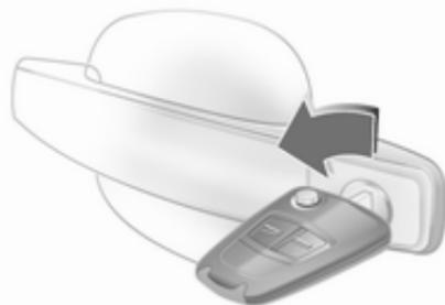
Den Schlüssel im Fahrertürschloss bis zum Anschlag drehen. Bei Öffnen der Fahrertür wird das gesamte Fahrzeug entriegelt. Zum Entriegeln der anderen Türen die Zündung einschalten und die Zentralverriegelungstaste drücken.
