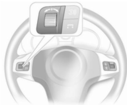
Menüpunkt durch Drehen auswählen. Zum Auswählen Markierung oder zum Bestätigen von Befehlen Stellrad drücken.
