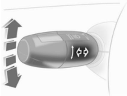
Hebel nach oben = Blinker rechts
