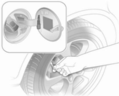
Reifendruck ↻ 217 und auf dem Aufkleber innen am Tankklappendeckel bzw. am vorderen rechten Türrahmen.
