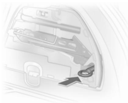
Die Abschleppöse befindet sich beim Wagenwerkzeug ⇨ 174. Die Abschleppöse ist in einer Aussparung untergebracht.
