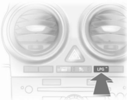
Durch Drücken der Taste **LPG** wird zwischen Benzin- und Flüssiggasbetrieb umgeschaltet, sobald die erforderlichen Parameter (Kühlmitteltemperatur, Gastemperatur und Mindest-drehzahl des Motors) erreicht sind. Die Anforderungen sind normalerweise nach etwa 60 Sekunden (je nach Außentemperatur) und der ers-
