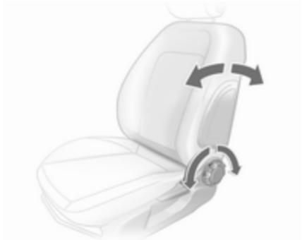
Handrad drehen. Zum Einstellen Rückenlehne entlasten.
