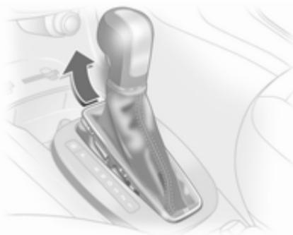
2. Wählhebelverkleidung vorn von der Mittelkonsole lösen, nach oben klappen und nach links drehen.
