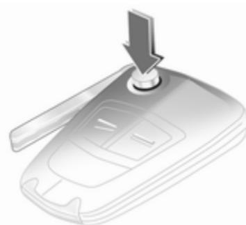
Zum Ausklappen auf den Knopf drücken. Zum Einklappen zuerst auf den Knopf drücken.
