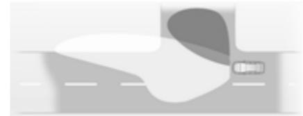
In engen Kurven oder beim Abbiegen wird abhängig vom Lenkwinkel bzw. dem Blinkersignal links oder rechts ein zusätzlicher Reflektor eingeschaltet, der die Straße in Fahrtrichtung beleuchtet. Er wird bei Geschwindigkeiten von bis zu 40 km/h aktiviert.
