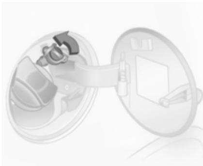
Die Schutzkappe vom Einfüllstutzen abschrauben.
