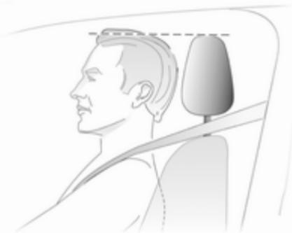
Die Oberkante der Kopfstütze sollte mit der Oberkante des Kopfes abschließen. Ist dies bei sehr großen Personen nicht möglich, höchste Position einstellen, bei sehr kleinen Personen tiefste Position.
