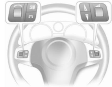
Das Infotainment System und das Info-Display können mit den Stellrädern und Tasten am Lenkrad bedient werden.
