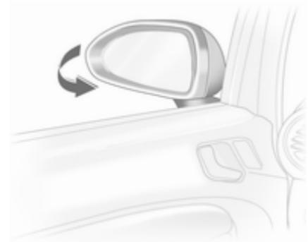
Die Außenspiegel lassen sich durch leichten Druck auf die Außenkante des Gehäuses beiklappen.
