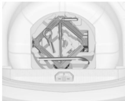
Variante 1: Wagenheber und Wagenwerkzeug befinden sich im Laderaum unterhalb des Reserverads. Ein Aufkleber am Wagenheber gibt an, für welche Fahrzeuge der Wagenheber verwendet werden kann.
