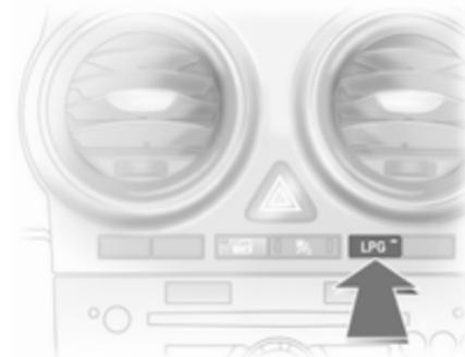
Durch Drücken der Taste **LPG** kann zwischen Benzin- und Flüssiggasbetrieb umgeschaltet werden. Die LED-Leuchte
