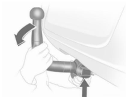
Gespannte Kugelstange in die Aufnahmeöffnung einführen und kräftig bis zum hörbaren Einrasten nach oben drücken.
