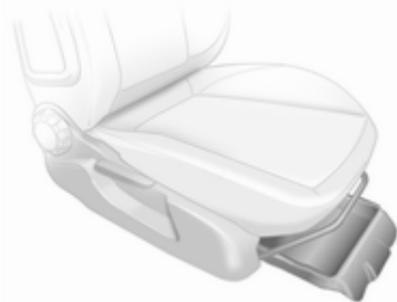
An Griffmulde anheben und herausziehen. Höchstlast: 1,5 kg. Zum Schließen einschieben und einrasten.
