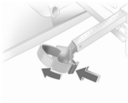
Entriegelungshebel am Spannband drücken und Spannband herausziehen.
