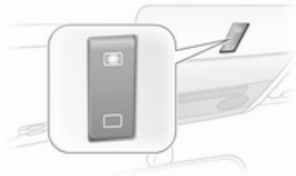
Betätigung mit Wipptaste in der Dachkonsole.
