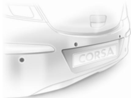
Die Einparkhilfe erleichtert das Einparken durch Messen des Abstands zwischen Fahrzeug und Hindernissen. Dennoch trägt der Fahrer beim Einparken die volle Verantwortung. Das System besteht aus vier Ultraschall-Parksensoren, die sich in den Stoßfängern befinden.
