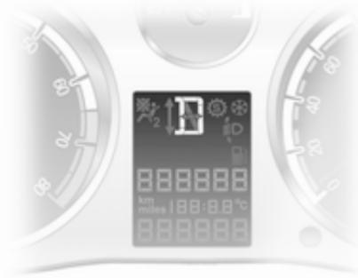
Im Getriebe-Display werden Modus oder gewählter Gang angezeigt.
