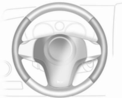
Das Lenkrad wird bei laufendem Motor und bei einem Autostop an den in der Abbildung gezeigten Stellen beheizt.
