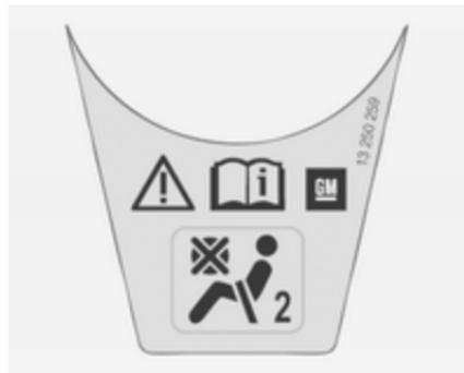
Seitlich an der Instrumententafel befindet sich ein Warnaufkleber, der bei geöffneter Beifahrertür sichtbar ist.
