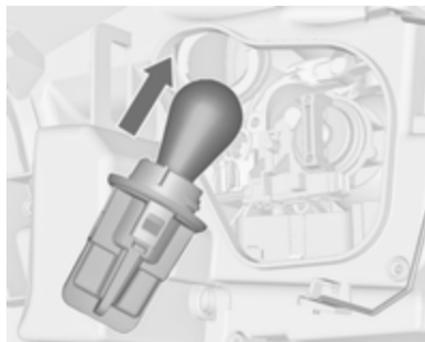
3. Glühlampe etwas in die Fassung hineindrücken, nach links drehen und herausnehmen.
