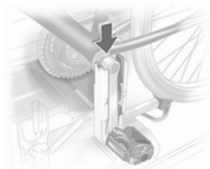
Fahrrad aufsetzen. Dabei muss die Tretkurbel wie in der Abb. dargestellt in den Schacht der Tretkurbelaufnahme gesetzt werden.
