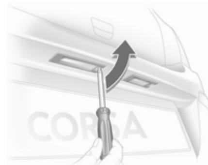
1. Schraubendreher in das Lampengehäuse einstecken, zur Seite drücken und Feder entriegeln.
