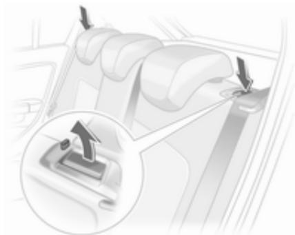
Sicherheitsgurte zum Schutz vor Beschädigung durch seitliche Halterungen führen. Beim Vorklappen der Lehnen die Sicherheitsgurte mit herausziehen.
