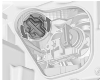
2. Lampenfassung durch Drehen nach links austrasten.
