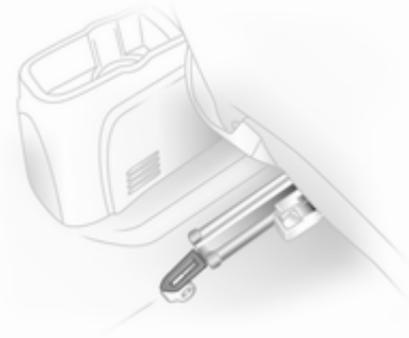
Als Hinweis auf die Befestigungsösen zur Montage des Kindersicherheitsystems befindet sich an der Verkleidung der hinteren Dachsäule und den Befestigungspunkten ein Symbol.
