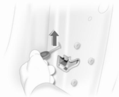
Den Schlüssel an der Innenseite der Tür in die Öffnung oberhalb des Schlosses stecken und die Verriegelung durch Anheben mit dem Schlüssel hörbar betätigen. Dann die Tür schließen. Dieser Vorgang muss für jede Tür wiederholt werden. Die Fahrertür kann auch von außen mit dem Schlüssel verriegelt werden. Tankklappe und Hecktür können nicht verriegelt werden.
