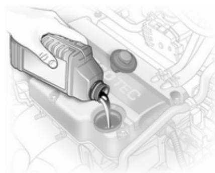
Wir empfehlen, das gleiche Motoröl zu verwenden wie eingefüllt ist.
