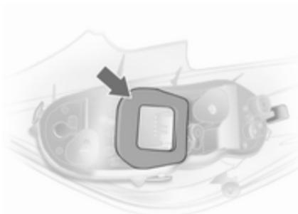
8. Sicherstellen, dass die Dichtung am Lampenträger wie in der Abbildung gezeigt angesetzt ist. Runde Dichtung auf Befestigungsschraube stecken.
