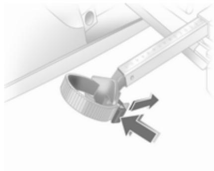
Spannband einführen und soweit wie möglich nach unten festziehen.
