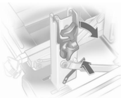
Arretierungshebel an der diagonalen Stütze ausrasten und beide Tretkurbeaufnahmen nach unten klappen.
