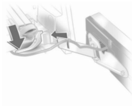
Spannhebel nach unten drücken und Leuchtenhalter in die Halterung drücken, bis er einrastet.
