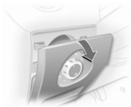
Der Sicherungskasten befindet sich hinter dem Lichtschalter. Blende an oberer Kante ziehen und abklappen.
