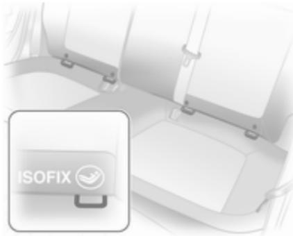
Für das Fahrzeug zugelassene ISOFIX Kindersicherheitsysteme an den Befestigungsbügel befestigen.
