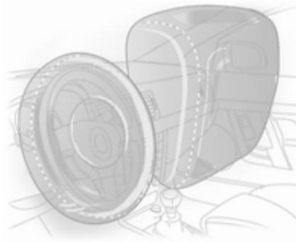
Die Vorwärtsbewegung der Fahrzeuginsassen auf den Vordersitzen wird verzögert. Dadurch sinkt deutlich die Gefahr von Verletzungen an Oberkörper und Kopf.
