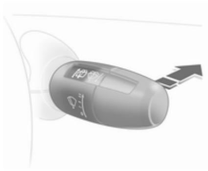
Hebel nach vorn drücken. Der Heckscheibenwischer wischt im Intervallbetrieb. Zum Ausschalten Hebel nochmals nach vorn drücken.
