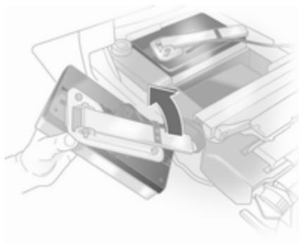
Leuchtenhalter hinten an der Rückleuchte vollständig ausklappen, bis er einrastet.
