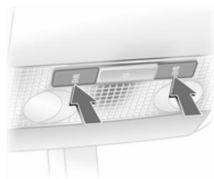
Betätigung mit Tasten
