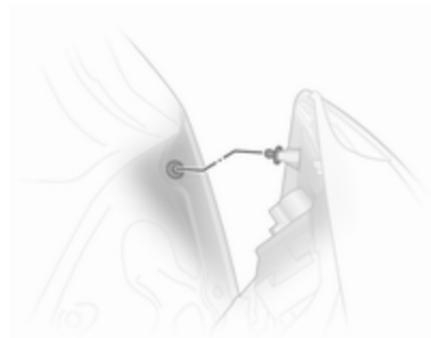
9. Lampengehäuse in Karosserie einsetzen, Befestigungsmuttern von Hand festziehen. Kabelstecker einrasten. Abdeckung schließen.
