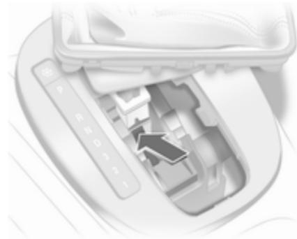
3. Gelbe Sperrklinke mit Schraubendreher nach vorn drücken und Wählhebel aus Stellung **P** bewegen. Beim erneuten Einlegen von **P** wird der Wählhebel wieder verriegelt. Ursache der Stromunterbrechung von einer Werkstatt beheben lassen.
