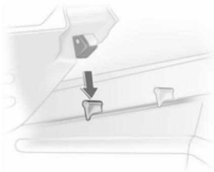
Die drei anderen Segmente zum Ausbau (Reihenfolge 2 bis 4) hinten anheben, austrasten, verdrehen und herausnehmen.
