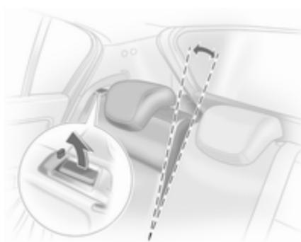
Entriegelungsgriff ziehen, Sitzlehne bis in die senkrechte Position nach vorn ziehen und einrasten lassen.
