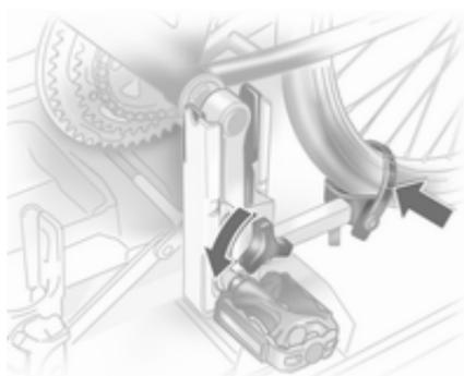
Spannbänder an beiden Fahrradreifen lösen.
