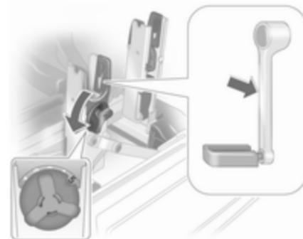
Mit dem Drehgriff an der Tretkurbelaufnahme die verstellbare Tretkurbelanlage grob an die Kröpfung der Tretkurbel anpassen.
