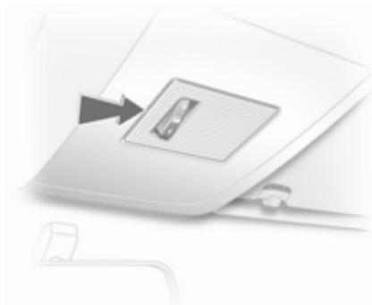
1. Streuscheibe an der in der Abbildung gezeigten Stelle mit dem Schraubendreher ausrasten und abziehen.
