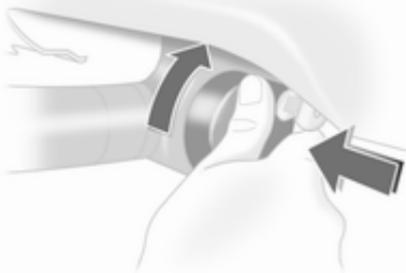
Schlüssel in Schloss stecken und Kugelstange aufschließen.
