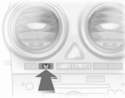
Nach Korrektur des Reifendrucks oder nach einem Radwechsel muss das System initialisiert werden: Zündung einschalten, Taste **DDS** für ca. 4 Sekunden drücken, Kontrollleuchte (⚠) blinkt dreimal.
