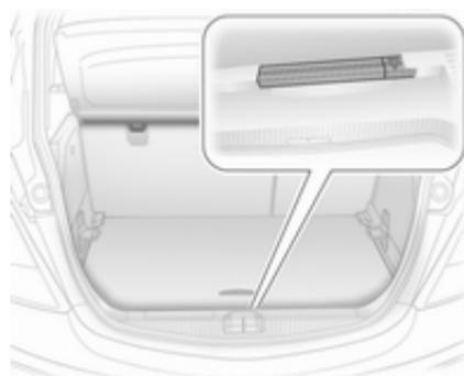
Warndreieck in der hinteren Laderaumwand unterbringen: Warndreieck zuerst links in Aussparung schieben und dann rechts in Führung stecken.
