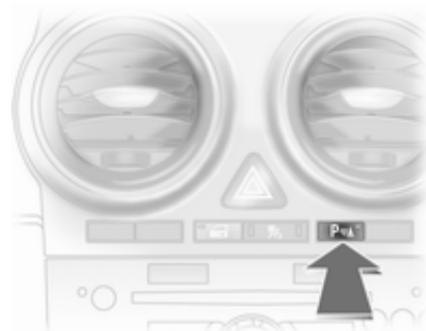
Wenn das Fahrzeug mit der Taste **P**
