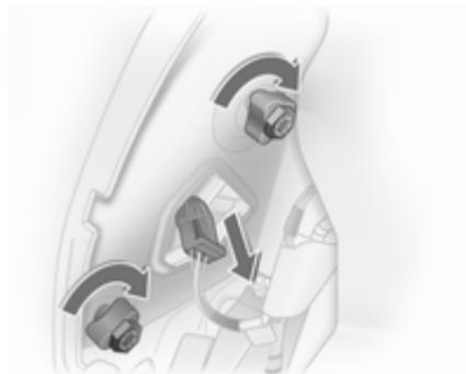
2. Kabelstecker durch Druck auf Lasche von Lampenträger abziehen.
