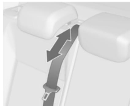
Der Sicherheitsgurt des Mittelsitzes könnte blockiert werden, wenn die Rückenlehne zu schnell hochgeklappt wird. Um den Aufroller zu entsperren, Sicherheitsgurt etwa 20 Millimeter hineinstoßen oder herausziehen, und dann loslassen.
