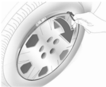
1. Radabdeckung mit dem Haken abziehen. Wagenwerkzeug ⇨ 174.
