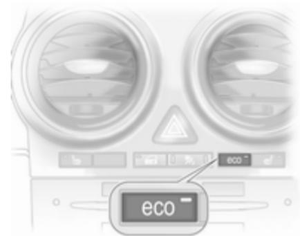
Die Stopp-Start-Automatik lässt sich durch Drücken der Taste **eco** manuell deaktivieren. Die Deaktivierung wird durch das Erlöschen der LED auf der Taste angezeigt.
