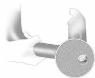
Schutzkappe über den Drehgriff mit Schlüssel stecken.
