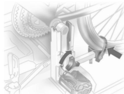
Die Klemmschraube der Tretlagerfixierung von Hand bis zum Maximalpunkt festziehen.
