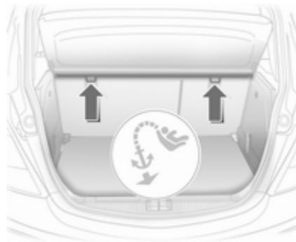
Je nach landesspezifischer Ausrüstung kann das Fahrzeug mit zwei oder drei Befestigungsösen ausgestattet sein.
