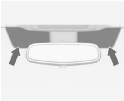
Die auf der Abbildung markierten Bereiche der Windschutzscheibe sind nicht beschichtet. Geräte für das Aufzeichnen von elektronischen Daten bzw. für die Gebührenbezahlung müssen in diesen Bereichen befestigt werden. Andernfalls treten möglicherweise Störungen beim Aufzeichnen der Daten auf.
