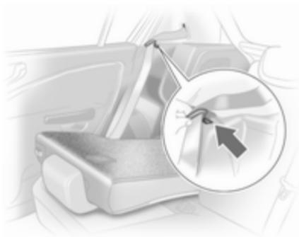
Rücksitzlehnen aufrichten und Verriegelungen auf beiden Seiten hörbar einrasten lassen. Nach der Verriegelung darf die rote Markierung nicht mehr hervorstehen.
