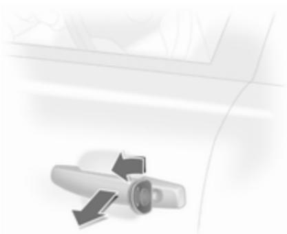
Schlüssel im Fahrertürschloss in Richtung Fahrzeugvorderseite drehen.
