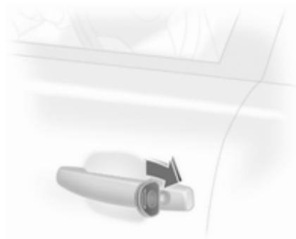
Schlüssel im Fahrertürschloss in Richtung Fahrzeugheck drehen.
