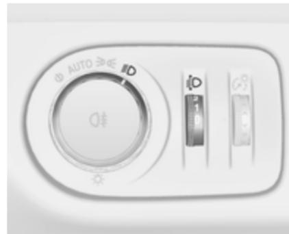
Leuchtweite der Fahrzeugbeladung anpassen, um das Blenden anderer zu vermeiden: Das Rändelrad
