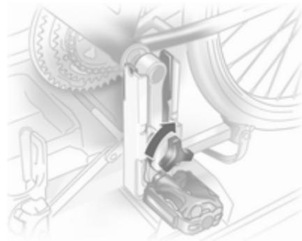
Tretkurbel durch Drehen der Klemmschraube an der Tretkurbelfixierung festklemmen.
