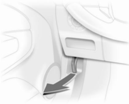
Entriegelungshebel ziehen und in die Ausgangsposition zurückführen.
