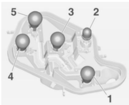
6. Glühlampe etwas in die Fassung hineindrücken, links herumdrehen und herausnehmen. Neue Glühlampe einsetzen.
