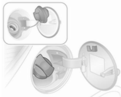
Tankdeckel mit dem Zündschlüssel entriegeln. Zum Öffnen den Deckel langsam nach links drehen. Der Tankdeckel kann in die Halterung auf der Tankklappe eingehängt werden.
