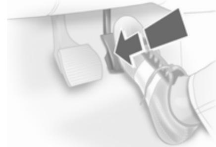
Beim Durchtreten des Gaspedals über den Druckpunkt hinaus wird abhängig von der Motordrehzahl in einen niedrigeren Gang geschaltet.
