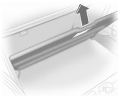
Der doppelte Ladeboden im Laderaum kann in zwei Positionen eingelegt werden:
