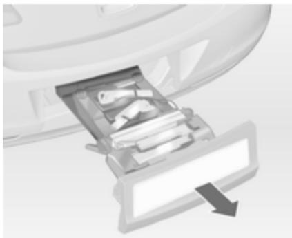
Das Heckträgersystem vollständig bis zum hörbaren Einrasten herausziehen.
