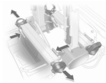
Entriegelungshebel drücken und Radaufnahmen herausziehen.
