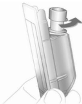
4. Lampenfassung durch Drehen nach links ausrasten.
