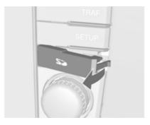
Die Abdeckung lässt sich z. B. mit einer kleinen Büroklammer oder einem ähnlichen Werkzeug abnehmen.
