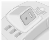
Vor dem Schalthebel in der Mittelkonsole befindet sich eine AUX-Buchse, an die externe Audioquellen angeschlossen werden können.
