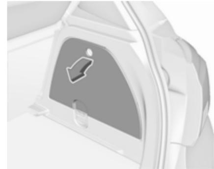
Zum Öffnen des Fachs die Abdeckung ausrasten und aufklappen.
