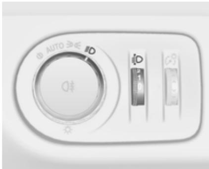
Zur Anpassung der Leuchtweite an die Fahrzeuglast, um Blendwirkung zu reduzieren: Daumenrädchen
