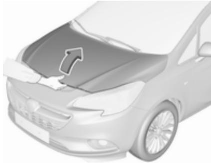
Den Sicherungshebel nach oben drücken und die Motorhaube öffnen.
