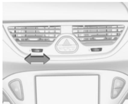
Die Einstellung der Luftmenge am Düsenausgang erfolgt durch Drehen des Einstellrädchens. Die Düse ist geschlossen, wenn das Einstellrädchen ganz nach links oder rechts gedreht ist.
