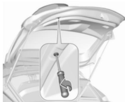
1. Die Schraube in der Hecktür entfernen.
