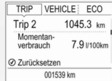
Die Menüseiten des Uplevel-Displays werden durch Drücken auf die Taste **MENU** am Blinkerhebel ausgewählt. Die Symbole des Hauptmenüs sind in der obersten Displayzeile zu sehen:
