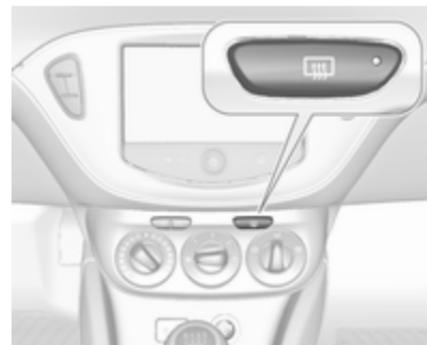
Die Heizung wird durch Drücken der Taste
