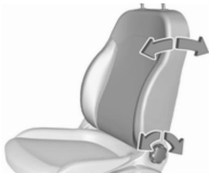
Zur Neigungseinstellung Handrad drehen. Beim Verstellen Rückenlehne entlasten.
