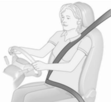
Bei starker Beschleunigung oder Verzögerung des Fahrzeugs blockieren die Sicherheitsgurte, um die Insassen in Sitzposition zu halten. Daher ist die Verletzungsgefahr deutlich geringer.
