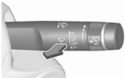
Hebel ziehen. Waschflüssigkeit spritzt auf die Windschutzscheibe und der Wischer wird für einige Wischbewegungen eingeschaltet.
