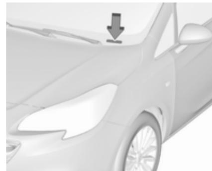
Die Fahrzeug-Identifizierungsnummer kann auch in die Instrumententafel eingestanzt sein, erkennbar durch die Windschutzscheibe, oder im Motorraum am rechten Karosserieblech.
