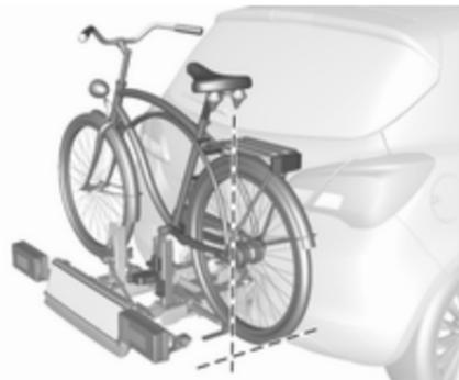
Fahrrad in Fahrzeuginnenrichtung ausrichten: Tretlagerfixierung etwas lösen.
