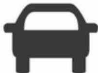
Ein vorausfahrendes Fahrzeug wird durch die Kontrollleuchte
