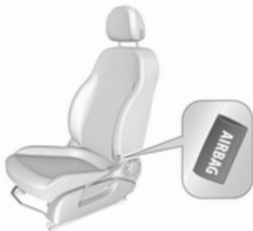
Das Seiten-Airbag-System besteht aus je einem Airbag in den Rückenlehnen der Vordersitze. Diese Stelle ist durch das Wort **AIRBAG** gekennzeichnet.
