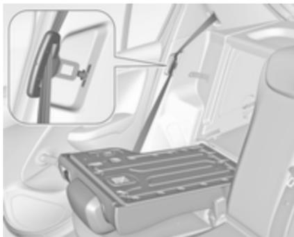
Wenn das Fahrzeug durch eine Hintertür beladen werden soll, den Sicherheitsgurt aus der Führung der Rückenlehne nehmen und die Schlosszunge wie in der Abbildung gezeigt in die Aussparung schieben.
