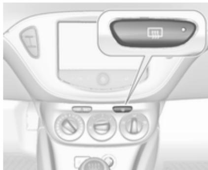
Wird durch Drücken der Taste
