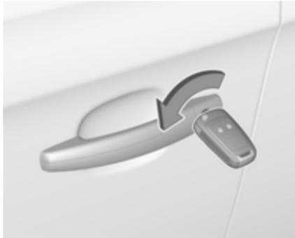
Fahrtür durch Drehen des Schlüssels im Schloss manuell entriegeln. Zündung einschalten und Zentralverriegelungstaste
