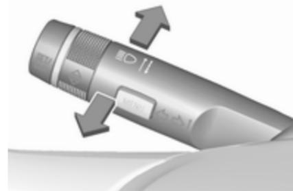
Zum Umschalten von Abblendlicht auf Fernlicht Hebel nach vorne drücken.
