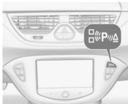
Fahrzeuge mit Front- und Heckeinparkhilfe und erweiterter Einparkhilfe sind an der Taste
