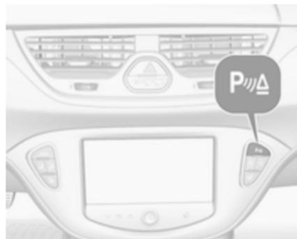
Fahrzeuge mit Heckeinparkhilfe oder mit Front- und Heckeinparkhilfe sind mit der Taste **P** mit einem Dreieckssymbol ausgestattet.
