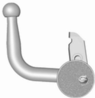
Schutzkappe über den Drehgriff mit Schlüssel stecken.
