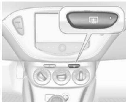
Wird durch Drücken der Taste
