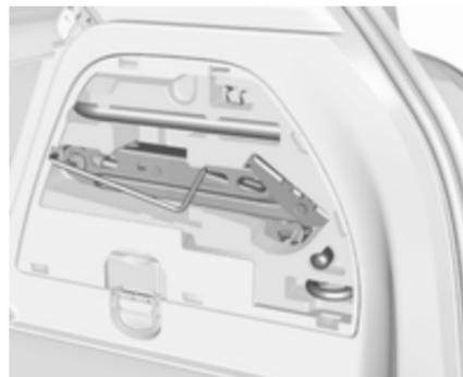
Der Wagenheber, der Radbolzenschlüssel und einige Werkzeuge sind rechts im Laderaum hinter einer Abdeckung verstaut ↪ 72.
