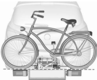
Die Radaufnahmen so positionieren, dass das Fahrrad sich etwa in horizontaler Position befindet. Dabei sollte der Abstand zwischen den Pedalen und der Hecktür mindestens 5 cm betragen.
