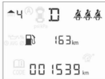
Die Menüseiten des Midlevel-Displays werden durch Drücken auf die Taste **MENU** am Blinkerhebel ausgewählt.
