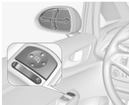
Mit dem Kippschalter den entsprechenden Außenspiegel auswählen und den Spiegel mit dem Bedienelement
