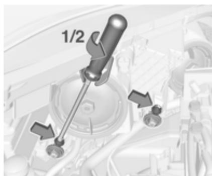
An jedem Scheinwerfergehäuse befinden sich zwei Einstellelemente.
