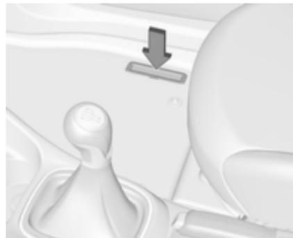
Die Fahrzeug-Identifizierungsnummer ist in das Typschild und das Bodenblech unter der Bodenabdeckung, zu sehen unter einer Abdeckung, eingestanzt.
