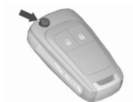
Zum Ausklappen auf den Knopf drücken. Zum Einklappen zuerst auf den Knopf drücken.
