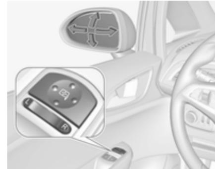
Den gewünschten Außenspiegel durch Drücken des Kippschalters nach links (L) bzw. rechts (R)
