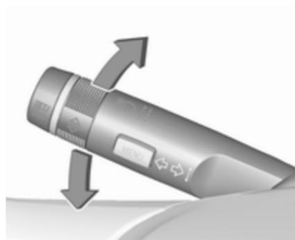
Hebel nach oben = Blinker rechts
