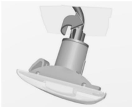
2. Lampenfassung linksherum drehen und aus dem Gehäuse herausnehmen.
