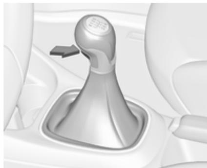
Rückwärtsgang: Bei stehendem Fahrzeug das Kupplungspedal treten, den Entriegelungsknopf am Wählhebel drücken und den Gang einlegen.
