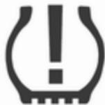
Wenn niedriger Reifendruck erkannt wird, wird dies durch die Kontrollleuchte (⚠) gemeldet ⇨ 94.
