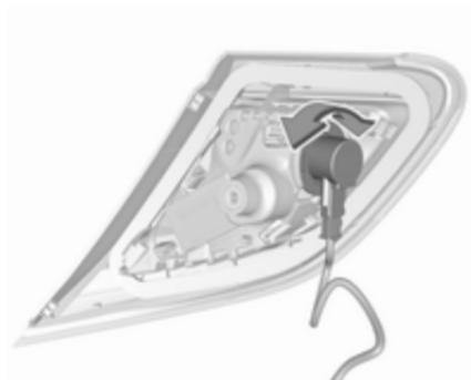
3. Die Lampenfassung drehen und entfernen.
