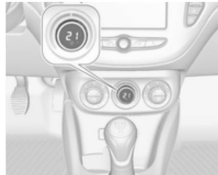
Ist die Mindesttemperatur **Lo** eingestellt, wird die Klimatisierung mit maximaler Kühlleistung betrieben, sofern die Kühlfunktion
