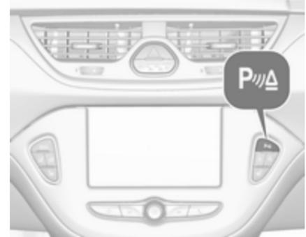
Eine leuchtende LED in der Einparkhilfe-Taste **P** mit einem Dreieckssymbol zeigt an, dass das System betriebsbereit ist.
