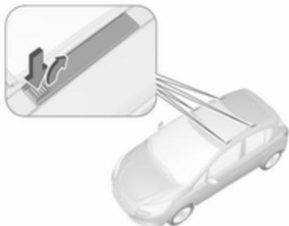
Die Abdeckungen der Montageöffnungen für den Dachgepäckträger durch Drücken der Gleitstücke in Pfeilrichtung austrasten und nach oben herausnehmen. Zum Schließen der Montagöffnungen Abdeckungen erst vorn einsetzen und dann Gleitstücke hinten einrasten lassen.
