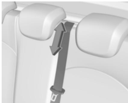
Der Sicherheitsgurt am Mittelsitz kann eingeklemmt werden, wenn die Sitzlehne zu schnell zurückgeklappt wird. Um den Aufroller zu entsperren, Sicherheitsgurt ca. 20 mm hineindrücken oder herausziehen und dann loslassen.
