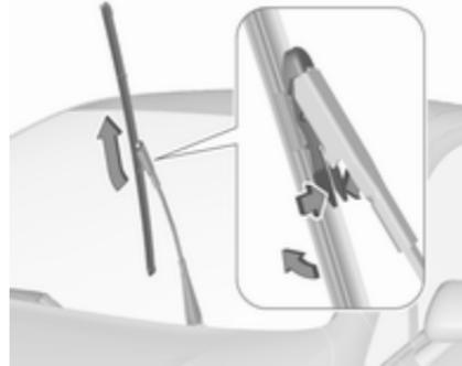
Den Wischerarm anheben, bis er in der angehobenen Stellung bleibt. Die Arretierungen an beiden Seiten drücken, das Wischerblatt in einen Winkel von 90° zum Wischerarm neigen und nach oben abziehen.
