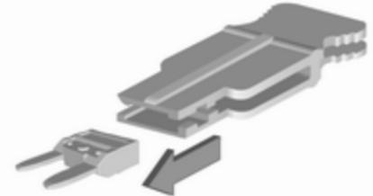
Den Sicherungszieher von oben auf die verschiedenen Arten von Sicherungen stecken und die Sicherung herausziehen.
