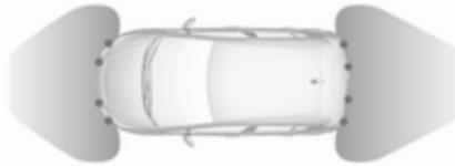
Das System besteht aus jeweils vier Ultraschall-Parksensoren im vorderen und hinteren Stoßfänger.
