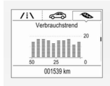
Zeigt die Entwicklung des Durchschnittsverbrauchs über eine Entfernung von 50 km an. Die vollen Balken zeigen den Verbrauch in 5-km-Schritten an und verdeutlichen die Auswirkungen des Geländes oder des Fahrverhaltens auf den Kraftstoffverbrauch.
