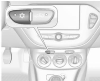
☀ drücken, um die Kühlung einzuschalten. Die LED in der Taste leuchtet auf, um die Aktivierung anzuzeigen. Die Kühlung ist nur bei laufendem Motor und eingeschaltetem Klimatisierungsgebläse funktionsfähig.
