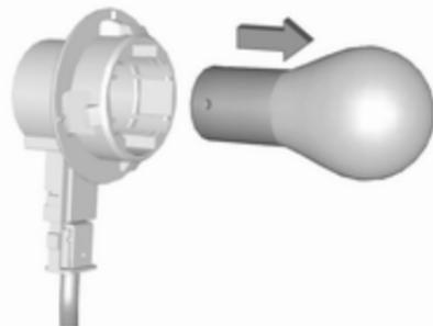
4. Die Lampe ausbauen. Hierzu die Lampe leicht in die Fassung drücken und linksherum drehen. Die Glühlampe ersetzen.
