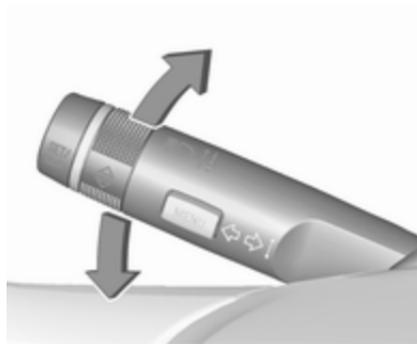
Hebel nach oben : Blinker rechts
