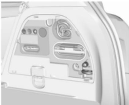
Bei OPC- oder LPG-Ausführungen oder Ausführungen mit Heckträgersystem oder doppeltem Laderaumboden ist das Wagenwerkzeug mit der Abschleppöse und dem Reifenreparaturset rechts im Laderaum hinter einer Abdeckung verstaut.
