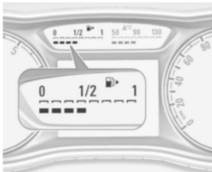
Die Anzahl der LEDs gibt den Füllstand im Kraftstofftank an.
