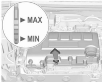
Wir empfehlen, möglichst diejenige Motorölklasse verwenden, die beim vorangegangenen Ölwechsel eingefüllt wurde.
