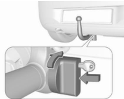
Schlüssel in Schloss stecken und Kugelstange aufschließen.
