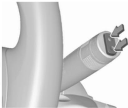
Zur Betätigung des Heckscheibenwischers Wippschalter drücken:
