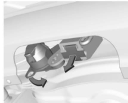
Steckdose austrasten und nach unten klappen. Verschlussstopfen von der Öffnung für die Kugelstange entfernen und verstauen.
