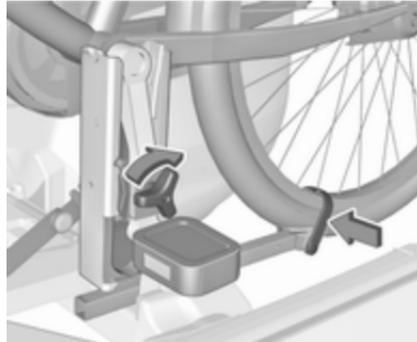
Die Klemmschraube der Tretlagerfixierung von Hand bis zum Maximalpunkt festziehen.
