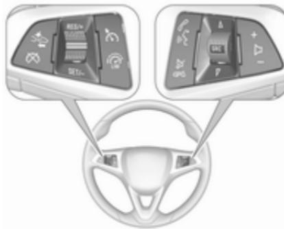
Der Geschwindigkeitsregler, der Geschwindigkeitsbegrenzer, die Einstellungen der Auffahrwarnung, das Infotainment System und ein angeschlossenes Mobiltelefon können über die Bedienelemente am Lenkrad gesteuert werden.
