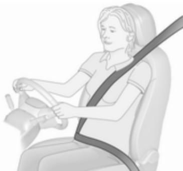
Bei starker Beschleunigung oder Verzögerung des Fahrzeugs blockieren die Sicherheitsgurte, um die Insassen in Sitzposition zu halten. Daher ist die Verletzungsgefahr deutlich geringer.
