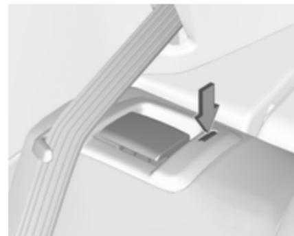
Die Rückenlehne ist korrekt eingerastet, wenn die roten Markierungen auf beiden Seiten neben dem Entriegelungsgriff nicht mehr sichtbar sind.
