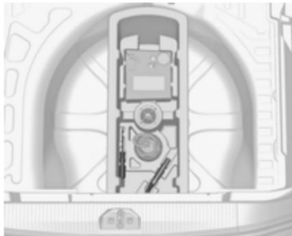
Das Wagenwerkzeug, die Abschleppöse und das Reifenreparaturset befinden sich im Laderaum unter der Bodenabdeckung.
