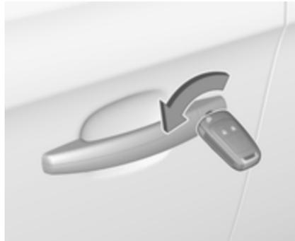
Fahrtür durch Drehen des Schlüssels im Schloss manuell entriegeln. Zündung einschalten und Zentralverriegelungstaste
