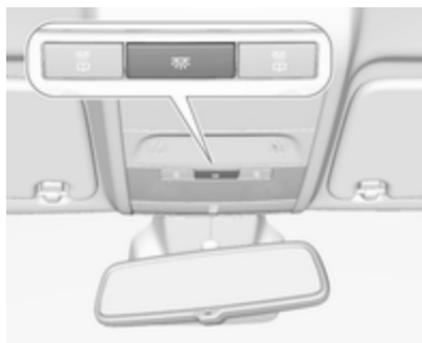
Durch Drücken auf
