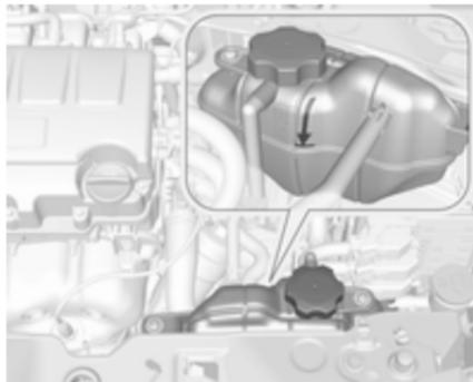
Bei zu niedrigem Füllstand auffüllen.
