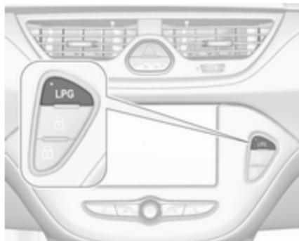
Durch Drücken von **LPG** wird zwischen Benzin- und Flüssiggasbetrieb umgeschaltet, sobald die erforderlichen Parameter (Kühlmitteltemperatur, Gastemperatur und Mindestdrehzahl des Motors) erreicht sind. Die Anforderungen sind normalerweise nach etwa 60 Sekunden (je nach Außentemperatur) und der ersten festen Betätigung des Gaspedals erreicht. Der LED-Status zeigt den aktuellen Betriebsmodus.
