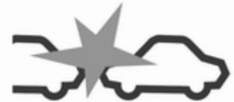
Wenn die Zeit für einen potentiellen Aufprall auf ein vorausfahrendes Fahrzeug zu kurz ist und eine Kollision droht, wird das Aufprallwarnsymbol im Driver Information Center einblendet und der Fahrer anhand eines rot blinkenden LED-Streifens gewarnt, der im Sichtfeld des Fahrers auf die Windschutzscheibe projiziert wird.
