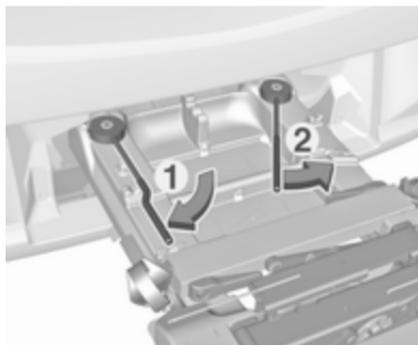
Zuerst den linken Spannhebel (1), danach den rechten Spannhebel (2) bis zum Anschlag schwenken. Beide Spannhebel müssen nach hinten zeigen, weil sonst keine sichere Funktion gewährleistet ist.
