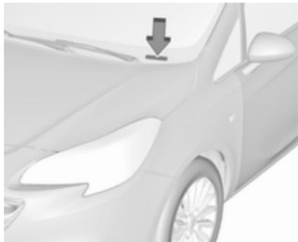
Die Fahrzeug-Identifizierungsnummer kann auch in die Instrumententafel eingestanz sein, erkennbar durch die Windschutzscheibe, oder im Motorraum am rechten Karosserieblech.
