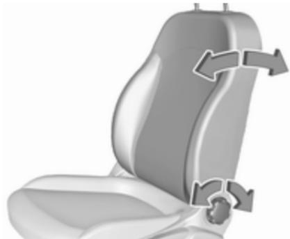
Handrad drehen. Beim Verstellen Rückenlehne entlasten.
