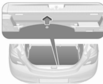
Die hintere Bodenabdeckung anheben, um Zugang zur Notfallausrüstung zu erhalten.
