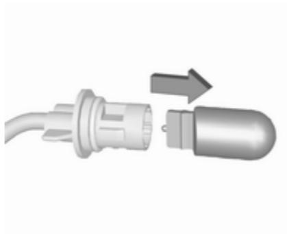
3. Die Glühlampe aus der Fassung herausziehen und auswechseln.
