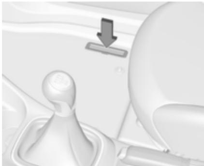
Die Fahrzeug-Identifizierungsnummer ist in das Typschild und das Bodenblech unter der Bodenabdeckung, zu sehen unter einer Abdeckung, eingestanz.
