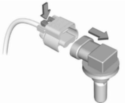
2. Die Lampenfassung durch Drücken der Haltnase vom Stecker lösen.
