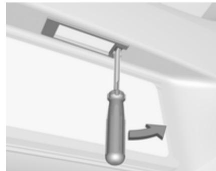
1. Schraubendreher in die Aussparung der Abdeckung einführen, zur Seite drücken und die Feder lösen.
