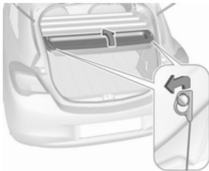
Zum Entfernen der hinteren Abdeckung die Befestigungsgurte von der Hecktür aushaken.
