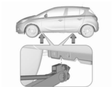
3. Sicherstellen, dass der Wagenheber richtig unter dem entsprechenden Ansatzpunkt ausgerichtet ist.
