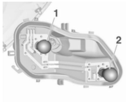
5. Die Lampe ausbauen und ersetzen. Hierzu die Lampe leicht in die Fassung drücken und linksherum drehen:
