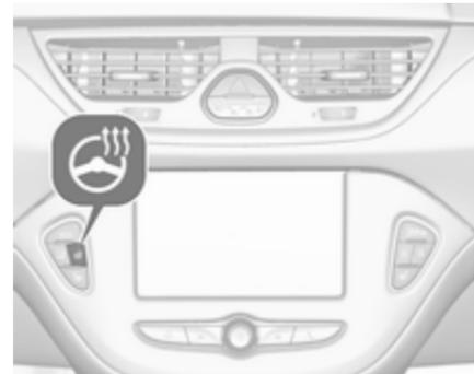
Die Heizung durch Drücken von
