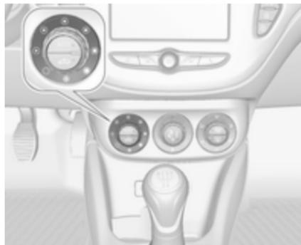
Zum Erhöhen bzw. Verringern der Gebläsegeschwindigkeit den linken Drehknopf drehen. Die Gebläsegeschwindigkeit wird auf dem Info-Display angezeigt.
