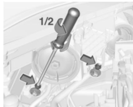
An jedem Scheinwerfergehäuse befinden sich zwei Einstellelemente.
