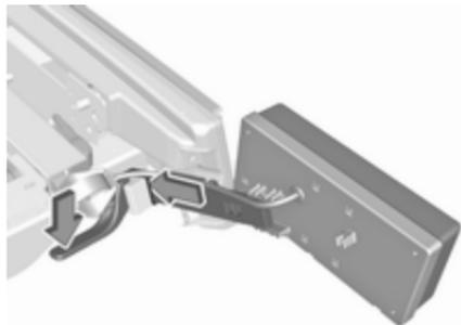
Spannhebel nach unten drücken und Leuchtenhalter in die Halterung drücken, bis er einrastet.
