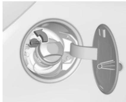
Die Schutzkappe vom Einfüllstutzen abschrauben.
