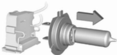
3. Die Lampe aus der Lampenfassung lösen und ersetzen.
