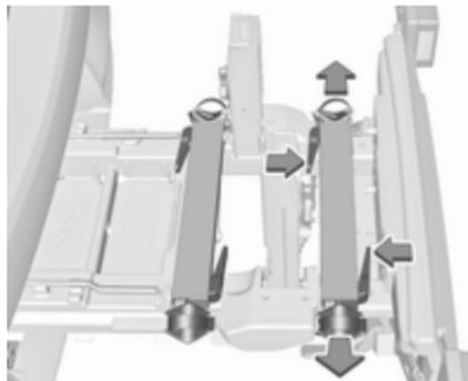
Entriegelungshebel drücken und Radaufnahmen herausziehen.
