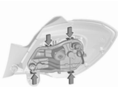
4. Auf die Haltenasen drücken und die Lampenfassung aus dem Leuchtensammenbau herausnehmen.
