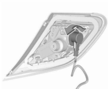
3. Die Lampenfassung drehen und entfernen.
