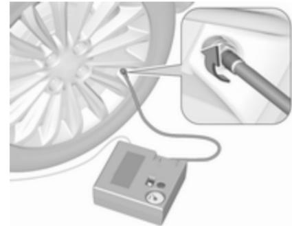
Wenn der Reifendruck mehr als 1,3 bar beträgt, auf den vorgeschriebenen Wert korrigieren. Vorgang wiederholen, bis kein Druckverlust mehr entsteht.
