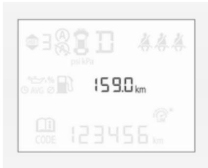
Zum Zurücksetzen **SET/CLR** auf dem Blinkerhebel einige Sekunden lang drücken ↵ 99.
