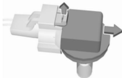
3. Die Lampe durch Ausrasten und Ziehen vom Steckverbinder entfernen.
