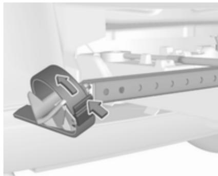
Entriegelungshebel am Spannband drücken und Spannband herausziehen.
