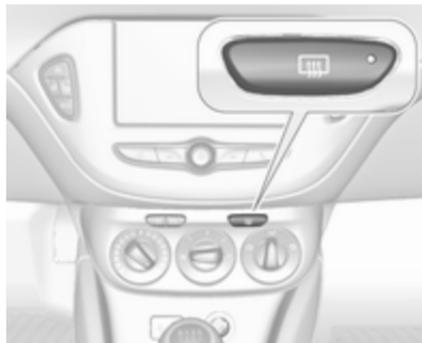
Wird durch Drücken von
