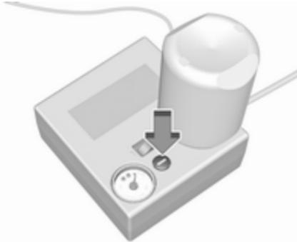
Wird der vorgeschriebene Reifendruck nicht innerhalb von zehn Minuten erreicht, das Reifenreparaturset entfernen. Das Fahrzeug um eine Reifenumdrehung bewegen. Das Reifenreparaturset wieder anbringen und den Füllvor-
