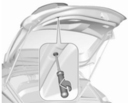
1. Die Schraube von der Hecktür entfernen.
