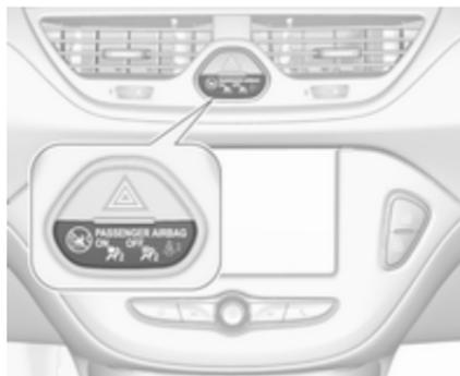
Wenn die Kontrollleuchte
