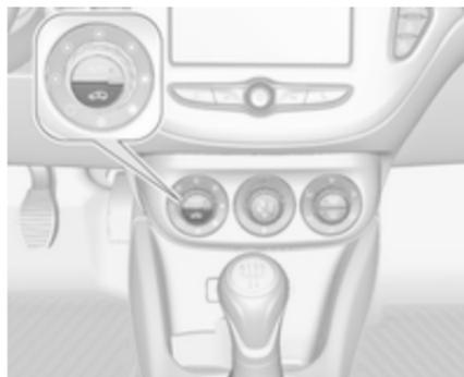
Zum Einschalten des Umluftbetriebs
