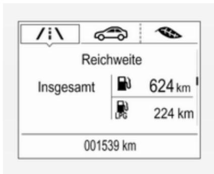
Anzeige der ungefähren Kraftstoffreichweite für jeden Kraftstofftank (LPG und Benzin). Ein niedriger Kraftstoffstand in einem beliebigen Tank wird durch **Niedrig** im entsprechenden Bereich angezeigt.
