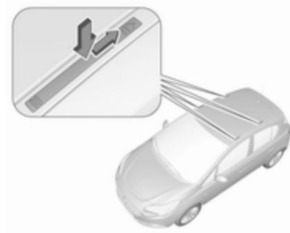
Abdeckungen der Montageöffnungen des Dachgepäckträgers nach unten drücken und mit Ventilkappenschlüssel nach hinten schieben ↗ 222.
