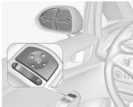
Mit dem Kippschalter den entsprechenden Außenspiegel auswählen und den Spiegel mit dem Bedienelement
