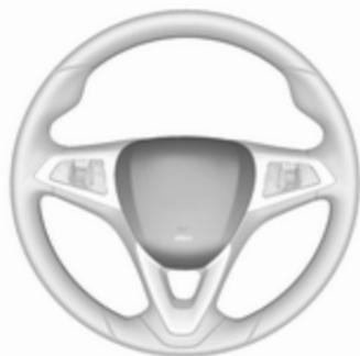
Das Front-Airbag-System wird bei einem Frontalaufprall ab einer bestimmten Unfallschwere ausgelöst. Die Zündung muss eingeschaltet sein.
