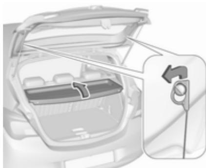
Befestigungsgurte von Hecktür lösen.
