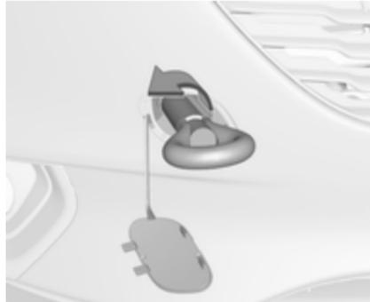
Abschleppöse bis zum Anschlag in waagrecht Stellung einschrauben.
