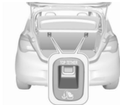
Zusätzlich zu den ISOFIX-Befestigungshalterungen den Top-Tether Befestigungsgurt an den Top-Tether-Befestigungsösen verankern.
