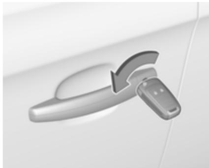
Fahrtür durch Drehen des Schlüssels im Schloss manuell entriegeln. Zündung einschalten und Zentralverriegelungstaste
