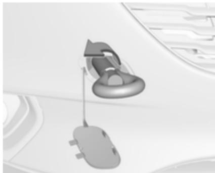
Abschleppöse bis zum Anschlag in waagerechter Stellung einschrauben.
