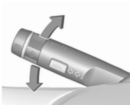
Hebel nach oben : Blinker rechts
