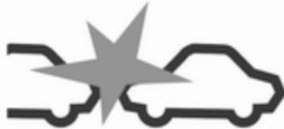
Wenn die Zeit für einen potentiellen Aufprall auf ein vorausfahrendes Fahrzeug zu kurz ist und eine Kollision droht, wird das Aufprallwarnsymbol im Driver Information Center eingeblendet und der Fahrer anhand eines rot blinkenden LED-Streifens gewarnt, der im Sichtfeld des Fahrers auf die Windschutzscheibe projiziert wird.
