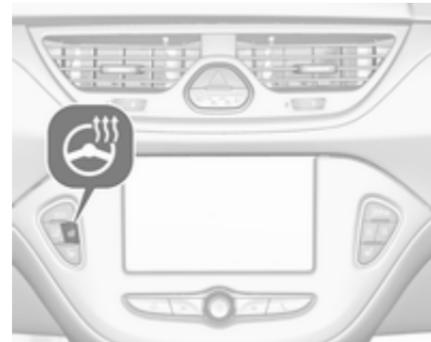
Die Heizung durch Drücken von
