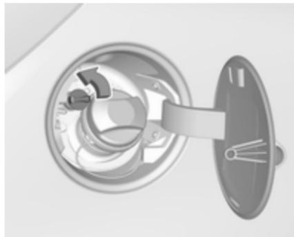
Die Schutzkappe vom Einfüllstutzen abschrauben.
