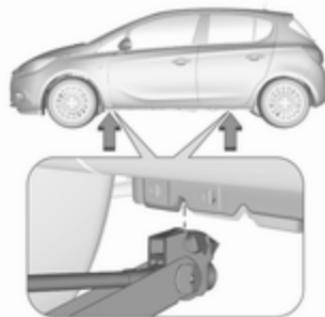
3. Sicherstellen, dass der Wagenheber richtig unter dem entsprechenden Ansatzpunkt ausgerichtet ist.
