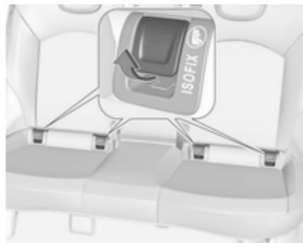
Für das Fahrzeug zugelassene ISOFIX-Kindersicherheitsysteme an ISOFIX-Befestigungshalterungen befestigen. Die speziellen Positionen für ISOFIX-Kindersicherheitsysteme sind in der Tabelle mit IL gekennzeichnet ↻ 53.
