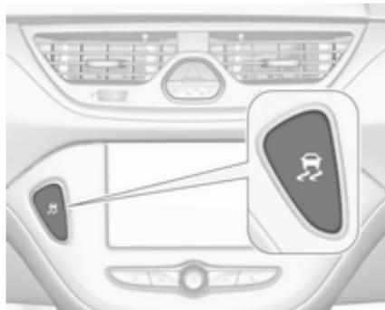
Die Traktionskontrolle kann ausgeschaltet werden, wenn ein Durchdrehen der Antriebsräder erwünscht ist:
