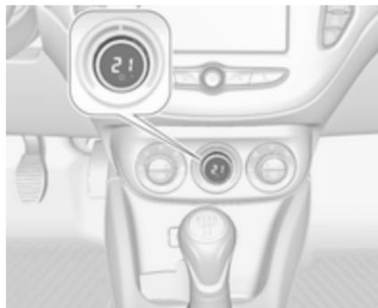
Ist die Mindesttemperatur **Lo** eingestellt, wird die Klimatisierung mit maximaler Kühlleistung betrieben, sofern die Kühlfunktion eingeschaltet ist.
