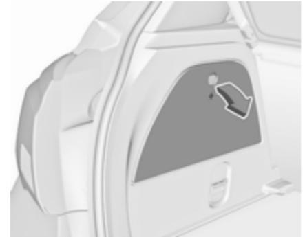
1. Die Abdeckung im Laderaum auf der entsprechenden Seite lösen und entfernen.
