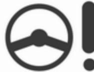
Bei einer Systemstörung leuchtet die Kontrollleuchte ⚠️ auf, während im Driver Information Center eine Meldung angezeigt wird.
