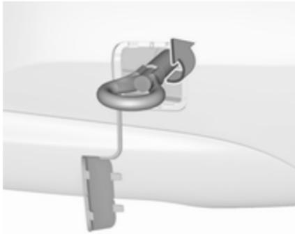
Abschleppöse bis zum Anschlag in waagrechter Stellung einschrauben.
