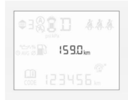
Zum Zurücksetzen **SET/CLR** auf dem Blinkerhebel einige Sekunden lang drücken ⇨ 99.
