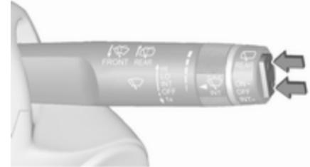
Zur Betätigung des Heckscheibenwischers Wippschalter drücken:
