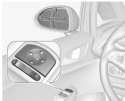
Den gewünschten Außenspiegel durch Drücken des Kippschalters nach links (L) bzw. rechts (R)
