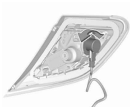
3. Die Lampenfassung drehen und entfernen.
