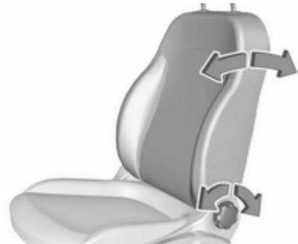
Handrad drehen. Beim Verstellen Rückenlehne entlasten.
