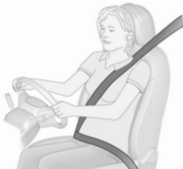
Sicherheitsgurt herausziehen und im Gurtschloss einrasten. Der Sicherheitsgurt muss unverdreht und eng am Körper anliegen. Die Rückenlehne darf nicht zu weit nach hinten geneigt sein (maximal ca. 25°).
