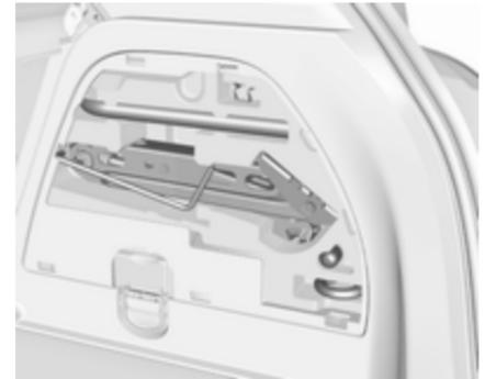
Der Wagenheber, der Radbolzenschlüssel und einige Werkzeuge sind rechts im Laderaum hinter einer Abdeckung verstaut ↻ 70.
