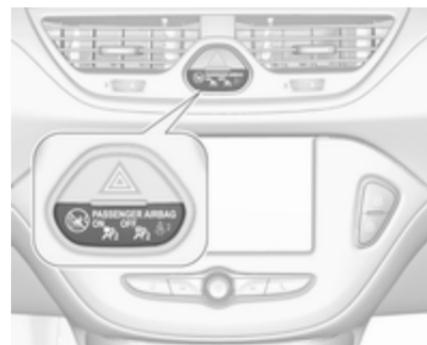
Wenn die Kontrollleuchte
