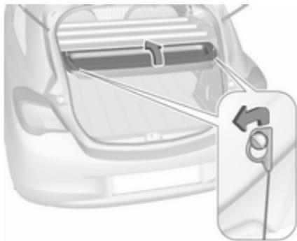
Zum Entfernen der hinteren Abdeckung die Befestigungsschnüre von der Hecktür aushaken.
