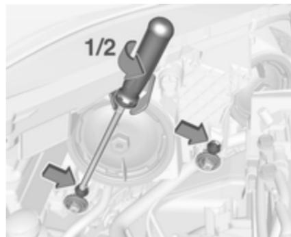
An jedem Scheinwerfergehäuse befinden sich zwei Einstellelemente.
