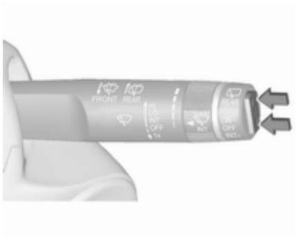
Zur Betätigung des Heckscheibenwischers Wippschalter drücken:
