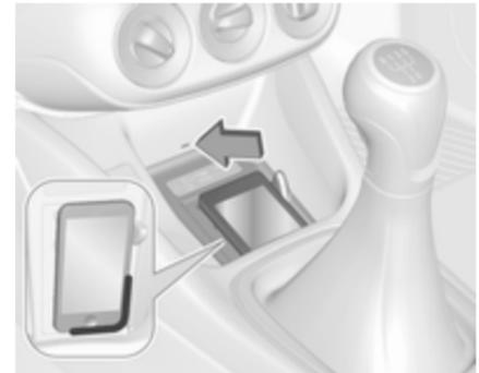
Um ein Gerät zu laden, muss die Zündung eingeschaltet sein.
