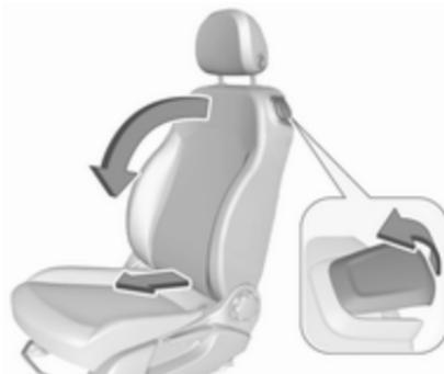
Entriegelungshebel nach vorne ziehen und Rückenlehne nach vorne klappen. Dann den Sitz bis zum Anschlag nach vorne schieben.
