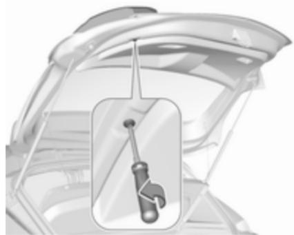
1. Die Schraube von der Hecktür entfernen.
