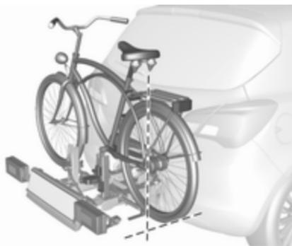
Fahrrad in Fahrzeuglängsrichtung ausrichten: Tretlagerfixierung etwas lösen.
