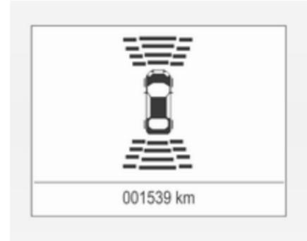
Die Abstandsanzeige kann durch Fahrzeugmeldungen mit höherer Priorität unterdrückt werden. Nach dem Abweisen der Meldung wird wieder die Abstandsanzeige angezeigt.
