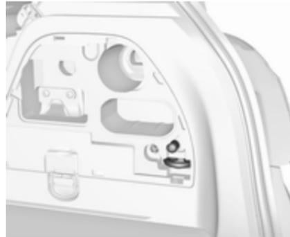
Das Wagenwerkzeug und die Abschleppöse befinden sich auf der rechten Seite des Laderaums hinter einer Abdeckung.
