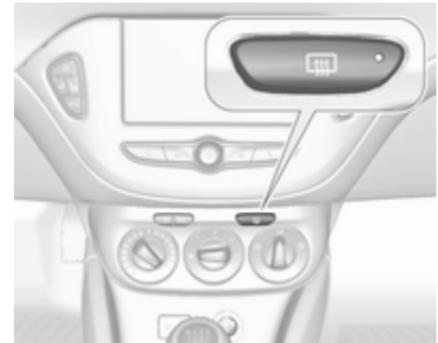
Die Heizung wird durch Drücken von
