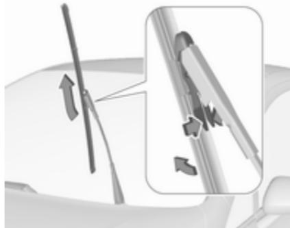
Den Wischerarm anheben, bis er in der angehobenen Stellung bleibt. Die Arretierungen an beiden Seiten drücken, das Wischerblatt in einen Winkel von 90° zum Wischerarm neigen und nach oben abziehen. Einbau in umgekehrter Reihenfolge. Den Wischerarm vorsichtig nach unten lassen.
