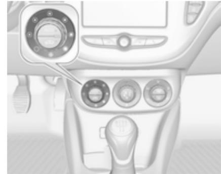
Zum Erhöhen bzw. Verringern der Gebläsegeschwindigkeit den linken Drehknopf drehen. Die Gebläsegeschwindigkeit wird auf dem Info-Display angezeigt.
