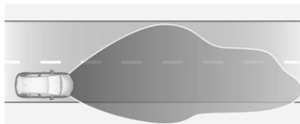
Wird beim Fahren in ländlichen Gebieten automatisch bei Geschwindigkeiten über 50 km/h aktiviert. Die Ausleuchtung der eigenen Fahrbahn und des Fahrbahnrandes wird ange-
