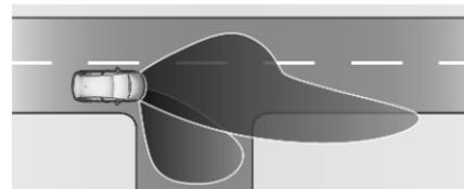
Beim Abbiegen mit bis zu 40 km/h aktiviert. Der Scheinwerfer besteht aus einzelnen LEDs, die den Fahrweg ausleuchten. Diese LEDs
