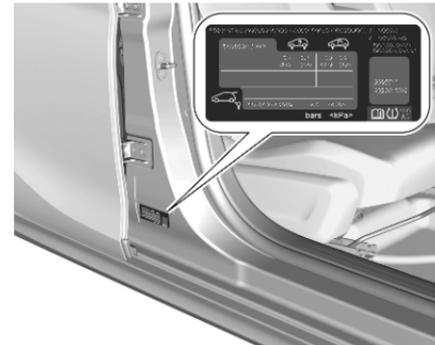
Das Reifendruck-Informationsschild gibt die Reifendrucke für die Originalreifen an.
