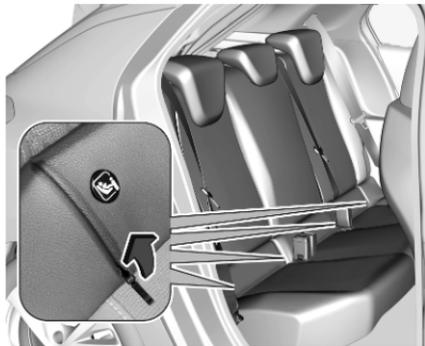
Für das Fahrzeug zugelassene ISOFIX-Kindersicherheitssysteme an den ISOFIX-Befestigungen befestigen. Die speziellen Positionen für ISOFIX-Kindersicherheitssysteme sind in der Tabelle mit ISOFIX gekennzeichnet ↗ 45.
