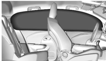
Der aufgeblähte Airbag dämpft den Aufprall, wodurch die Verletzungsgefahr für den Kopf bei einem Seitenaufprall deutlich verringert wird.
