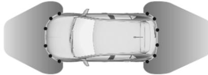
Wenn das Fahrzeug mit je sechs Ultraschall-Parksensoren im Heck- und im Frontstoßfänger ausgestattet ist, warnt das System den Fahrer über Anzeigen im Display und Warntöne.
