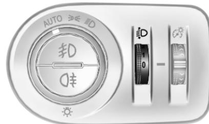
Zur Anpassung der Leuchtweite an die Fahrzeuglast, um die Blendwirkung zu reduzieren, Daumenrädchen
