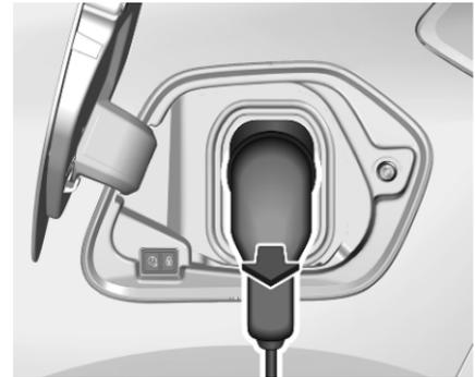
2. Den Fahrzeugstecker des Ladekabels innerhalb von 30 Sekunden nach dem Entriegeln vom Ladeanschluss trennen.
