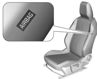
Das Seiten-Airbag-System besteht aus je einem Airbag in der Sitzlehne jedes Vordersitzes. Diese Stellen sind mit dem Wort **AIRBAG** gekennzeichnet.
