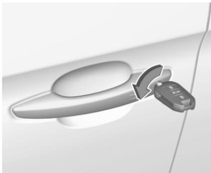
Die Vordertür durch Einsetzen und Drehen des Schlüssels im Schließzylinder von Hand entriegeln.
