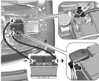
Reihenfolge für das Anschließen der Kabel:
