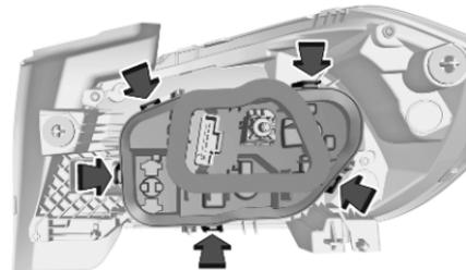
6. Die fünf Haltetaschen zusammendrücken und die Lampenfassung aus der Leuchteneinheit entfernen.
