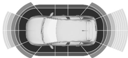
Diese Funktion warnt den Fahrer durch Anzeigen von Hinweisen, wenn Hindernisse seitlich neben dem Fahrzeug erkannt werden. Wenn sich das Hindernis neben dem Fahrzeug und in der Fahrspur des Fahrzeugs befindet und möglicherweise eine Kollision bevorsteht, ertönt ein Warnton. Hindernisse seitlich neben dem Fahrzeug werden nur berücksichtigt, wenn sie zuvor von den Parksensoren erkannt und vom System gespeichert wurden.
