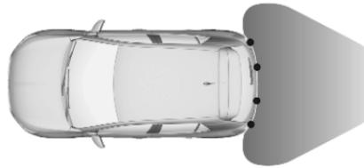
Das System arbeitet mit Ultraschall-Parkensensoren im hinteren Stoßfänger.
