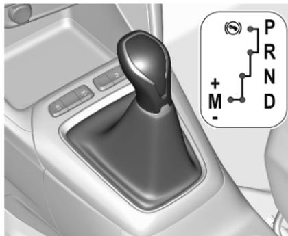
**P** : Parkstellung, die Räder werden blockiert, nur bei stehendem Fahrzeug und betätigter Parkbremse auswählen
