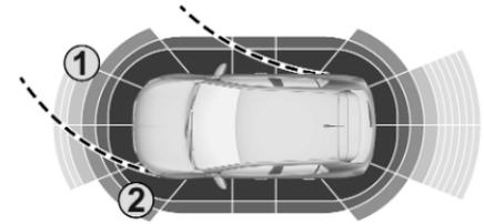
Wenn sich das Hindernis (1) in der Fahrspur des Fahrzeugs befindet und möglicherweise eine Kollision bevorsteht, ertönt ein Warnton.
