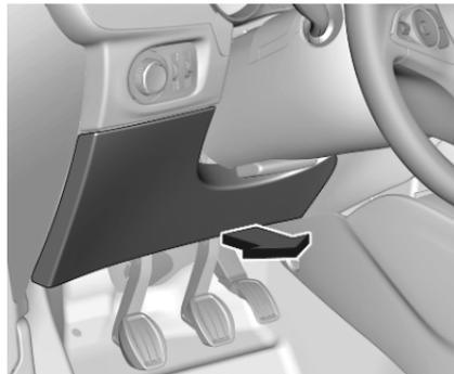
Bei Linkslenkern befindet sich der Sicherungskasten hinter einer Abdeckung in der Instrumententafel. Abdeckung an der Unterseite lösen und abnehmen.
