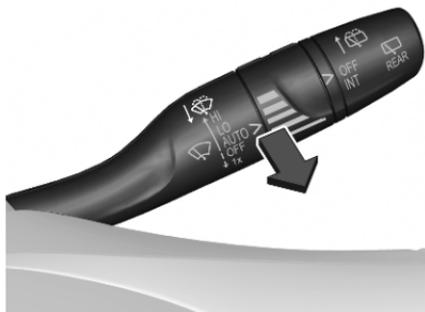
Hebel ziehen. Waschflüssigkeit spritzt auf die Windschutzscheibe und der Wischer wird für einige Wischbewegungen eingeschaltet. Waschflüssigkeit ↪ 207.
