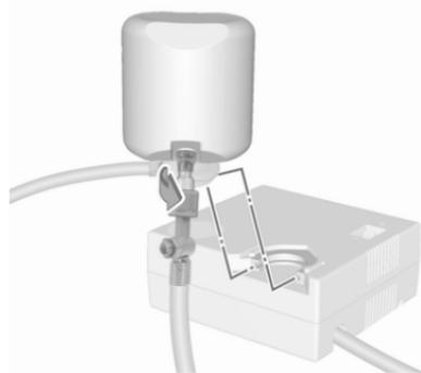
Typ B: Den Kompressorluftschlauch an den Anschluss an der Dichtmittelflasche schrauben.
