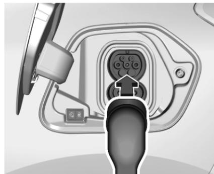
5. Den Fahrzeugstecker des Ladekabels am Ladeanschluss des Fahrzeugs anschließen.
