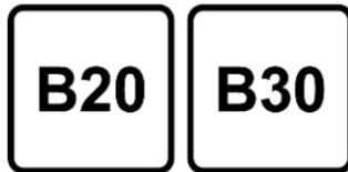
Kraftstoff B20 oder B30 gemäß der Norm EN16709 kann bei Dieselmotoren ebenfalls getankt werden. Hierfür sind jedoch auch bei gelegentlicher
