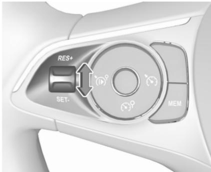
Bis zur gewünschten Geschwindigkeit beschleunigen und das Daumenrädchen kurz auf **SET/-** drehen. Die aktuelle Geschwindigkeit wird gespeichert und beibehalten. Gaspedal kann gelöst werden.
