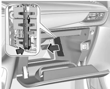
Bei Linkslenkern befindet sich der Sicherungskasten hinter einer Abdeckung im Handschuhfach. Handschuhfach öffnen und Abdeckung entfernen. Halterung entfernen.
