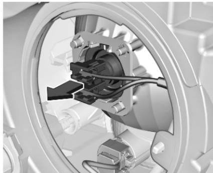
2. Die Lampenfassung aus dem Reflektorgehäuse ziehen.
