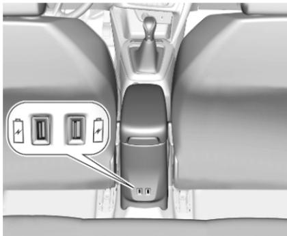
Der Schlitz unter den USB-Anschlüssen an der Rückseite des Stauraums dient dem Befestigen eines Zubehöretränkhalters.
