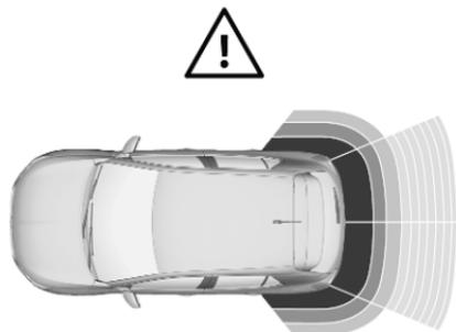
Außerdem wird der Abstand zu Hindernissen hinter dem Fahrzeug durch sich ändernde Abstandslinien im Info-Display angezeigt ⇨ 83. Bei einem sehr geringen Abstand wird das Warnsymbol angezeigt.
