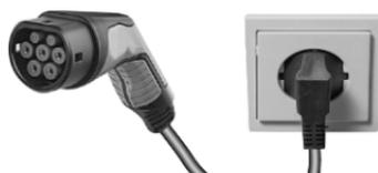
Die Hochvoltbatterie des Fahrzeugs kann an einer Haushaltssteckdose geladen werden. Das Kabel am Ladeanschluss des Fahrzeugs und an der Haushaltssteckdose anschließen.
