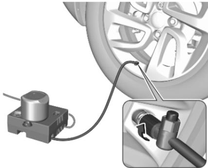
9. Den Einfüllschlauch am Reifenventil anschrauben.
