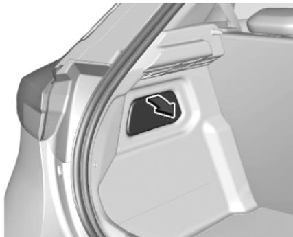
1. Die Heckklappe öffnen und die Zugangsabdeckung auf der betreffenden Seite entfernen.
