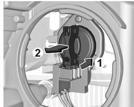
2. Die Lampenfassung zum Lösen linksherum drehen und aus dem Reflektor ziehen.
