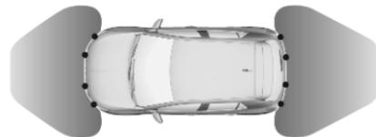
Wenn das Fahrzeug mit je vier Ultraschall-Parksensoren im Heck- und im Frontstoßfänger ausgestattet ist, misst die Front-Heck-Einparkhilfe den Abstand zwischen dem Fahrzeug und Hindernissen vor und hinter dem Fahrzeug. Sie informiert und warnt den Fahrer mit Hilfe von Warntönen und visuellen Anzeigen.
