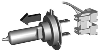
3. Die Lampe aus der Lampenfassung lösen und ersetzen.
