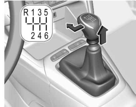
Um bei einem 6-Gang-Getriebe den Rückwärtsgang einzulegen, bei stehendem Fahrzeug und im Leerlauf das Kupplungspedal betätigen, den Ring unter dem Wählhebel ziehen und den Wählhebel ganz nach links und vorne bewegen.
