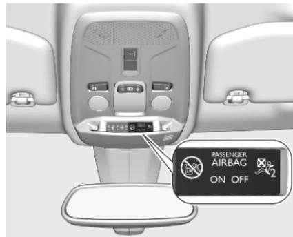
Wenn die Kontrollleuchte
