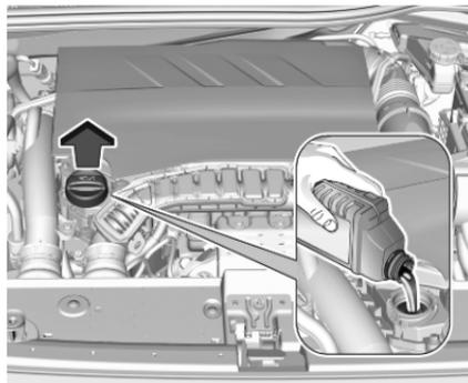
Der Motorölstand darf die obere Marke **MAX** am Messtab nicht überschreiten.
