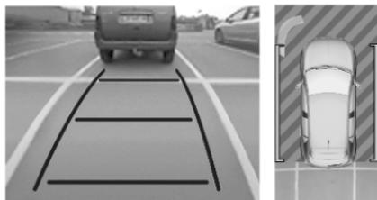
Der Bildschirm im Info-Display ist zweigeteilt. Rechts erscheint ein Bild des Fahrzeugs von oben, links die Ansicht von hinten. Die Einparkensensoren ergänzen die Informationen zur Ansicht von oben.
