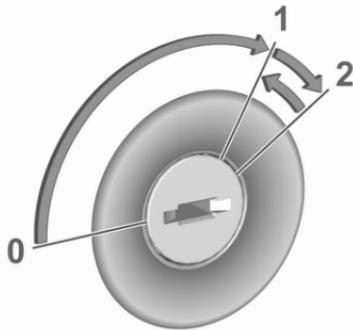
Den Schlüssel in Stellung **1** drehen, um die Lenkradsperrung freizugeben.
