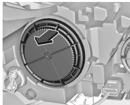
1. Die Schutzabdeckung durch Ziehen entfernen.
