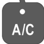
**A/C** drücken, um die Kühlung einzuschalten. Die LED in der Taste leuchtet auf, um die Aktivierung anzuzeigen. Die Kühlung funktioniert nur bei laufendem Motor und eingeschaltetem Gebläse.
