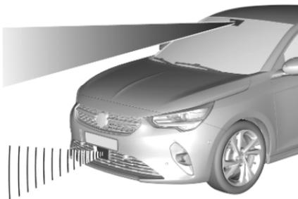
Das System erkennt vor Ihnen befindliche Fußgänger mithilfe der Frontkamera in der Windschutzscheibe und, je nach Fahrzeugkonfiguration, einer Radareinheit im vorderen Stoßfänger.
