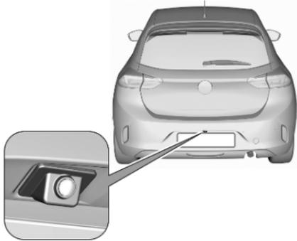
Die Kamera ist im Heckstoßfänger über dem Kennzeichenschild montiert.
