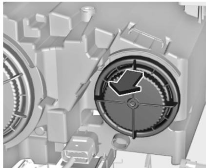
1. Die Schutzabdeckung durch Ziehen entfernen.
