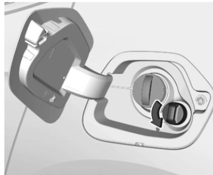
4. Die Schutzkappe vom Einfüllstutzen abschrauben.
