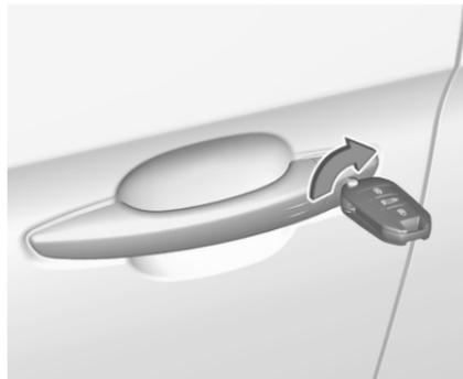
Die Vordertür durch Einsetzen und Drehen des Schlüssels im Schließzylinder von Hand verriegeln.
