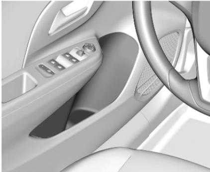
In der Verkleidung der Vorder- und Hintertüren befindet sich ein Ablagefach.
