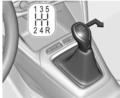
Um bei einem 5-Gang-Getriebe den Rückwärtsgang einzulegen, bei stehendem Fahrzeug und im Leerlauf das Kupplungspedal betätigen und den Wählhebel nach rechts und hinten bewegen.
