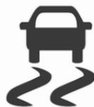
Die elektronische Stabilitätsregelung und die Traktionskontrolle sind nach jedem Motorstart funktionsfähig, sobald die Kontrollleuchte
