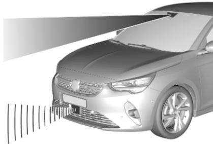
Die Auffahrwarnung erkennt Fahrzeuge, die sich in der gleichen Fahrspur vor dem eigenen Fahrzeug befinden, mithilfe der Frontkamera in der Windschutzscheibe und je nach Fahrzeugkonfiguration mit einer Radareinheit im Frontstoßfänger.
