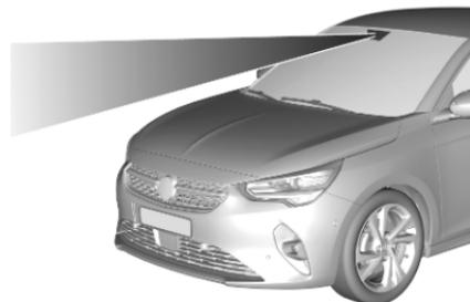
Das aktivierte System beobachtet mithilfe einer Kamera oben an der Windschutzscheibe die Spurmarkierungen. Das System lenkt das Fahrzeug in der erkannten Fahrspur. Der Fahrer spürt dabei, wie sich das Lenkrad dreht.
