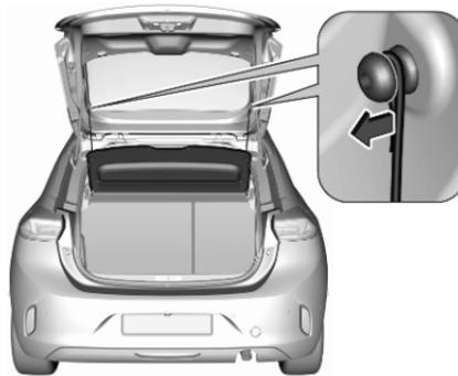
Haltebänder von Heckklappe lösen.
