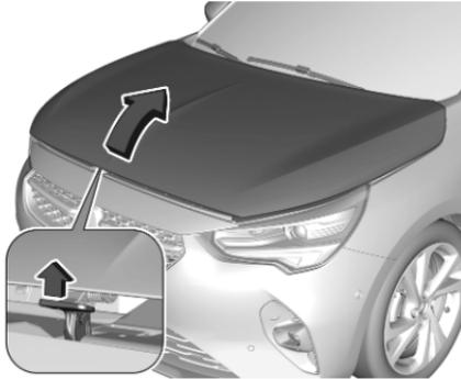
Schnappriegel hochdrücken und Motorhaube öffnen.
