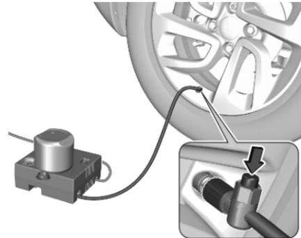
Zu hohen Reifendruck über die Taste am Luftschlauch korrigieren.
