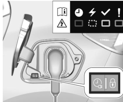
Wenn das Fahrzeug zum Laden angeschlossen und ausgeschaltet ist, zeigt die Ladestatus-Kontrollleuchte wie folgt den Status an:
