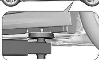
Vordere Arme der Hebebühne mittig unter den entsprechenden Wagenheberaufnahmen positionieren.
