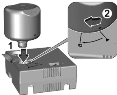
5. Typ A: Zunächst die Flasche mit dem Dichtmittel in den Kompressor einsetzen und die Dreiecksymbole ausrichten. Dann die Flasche mit dem Dichtmittel nach unten drücken und in die Verriegelungsposition drehen.
