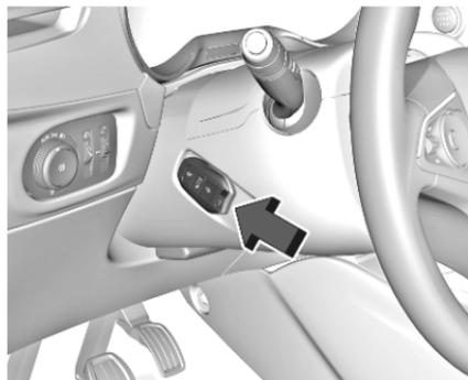
Elektronischen Schlüssel wie in der Abbildung gezeigt an die Markierung an der Lenksäulenabdeckung halten. Bei Fahrzeugen mit Schaltgetriebe in den Leerlauf schalten, das Kupplungspedal betätigen, das Bremspedal betätigen und **Start/Stop** drücken.
