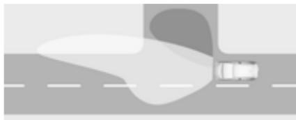
Je nach Lenkwinkel und Blinklicht werden beim Abbiegen spezielle LEDs eingeschaltet, um die Fahrtrichtung auszuleuchten. Er wird bei Geschwindigkeiten von bis zu 40 km/h aktiviert.
