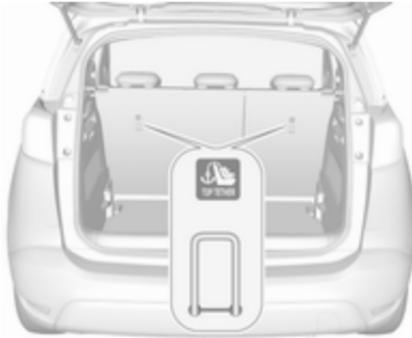
Zusätzlich zu den ISOFIX-Befestigungen den Top-Tether Befestigungsgurt an den Top-Tether Befestigungen verankern.
