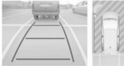
Im linken Displaybereich können verschiedene Ansichten ausgewählt werden. Die Ansicht kann während eines Manövers jederzeit geändert werden, indem das Feld unten links im Display angetippt wird:
