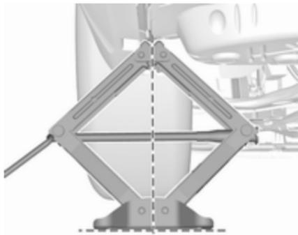
4. Wagenheber auf die erforderliche Höhe einstellen. Direkt unter dem Wagenheberaufnahmeepunkt so positionieren, dass er nicht abrutschen kann.
