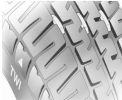
Die gesetzlich zulässige Mindestprofiltiefe (1,6 mm) ist erreicht, wenn das Profil bis zu einem Verschleißanzeiger (TWI = Tread Wear Indicator) abgefahren ist. Deren Lage wird durch Markierungen an der Reifenflanke angezeigt.
