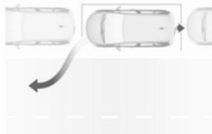
Vor- und zurücksetzen und dabei die Warnungen der Einparkhilfe beachten, bis der Abschluss des Manövers angezeigt wird. Das Manöver ist abgeschlossen, sobald die Vorderäder des Fahrzeugs die Parklücke verlassen haben.  $\text{P}_S$  im Instrument erlischt.
