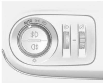
Bei aktivierter Funktion Automatisches Fahrlicht und laufendem Motor schaltet das System abhängig von den äußeren Lichtverhältnissen und den Informationen des Regensensors zwischen Tagfahrlicht und Scheinwerfern automatisch um.
