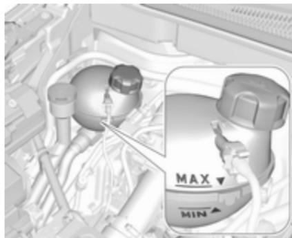
Bei kaltem Kühlsystem sollte der Kühlmittelstand über der **MIN**-Markierung liegen. Bei zu niedrigem Füllstand auffüllen.
