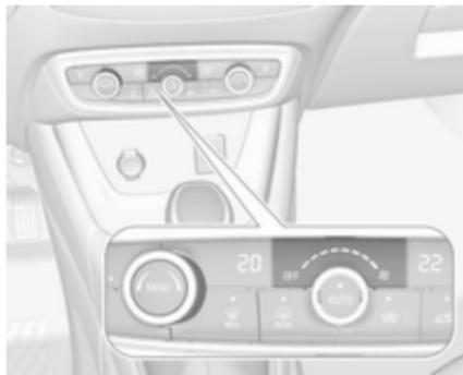
Luftstrom durch Drehen des Drehknopfs
