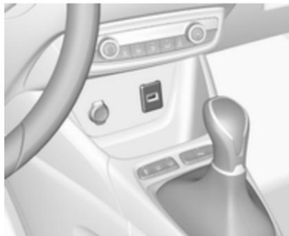
In der Mittelkonsole befinden sich ein oder zwei USB-Anschlüsse. Beide USB-Anschlüsse eignen sich zum Laden von Geräten.
