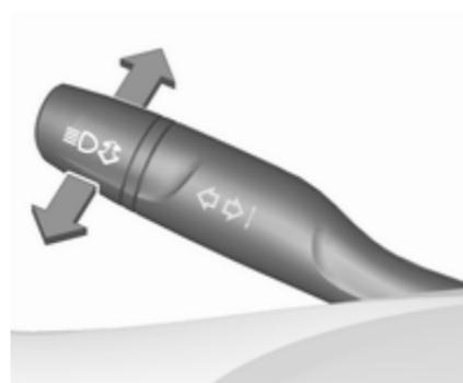
Zum Umschalten von Ablend- auf Fernlicht den Hebel drücken.
