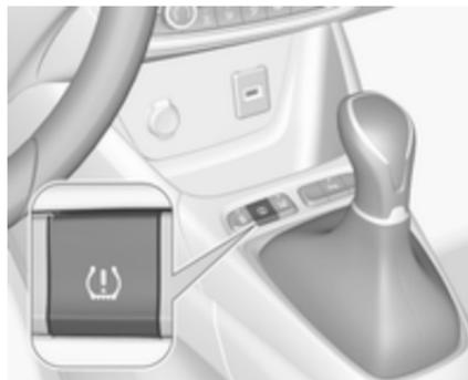
Nach der Korrektur des Reifendrucks und nach einem Radwechsel muss das System neu initialisiert werden, damit die neuen Referenzwerte für den Abrollumfang angelernt werden können:
