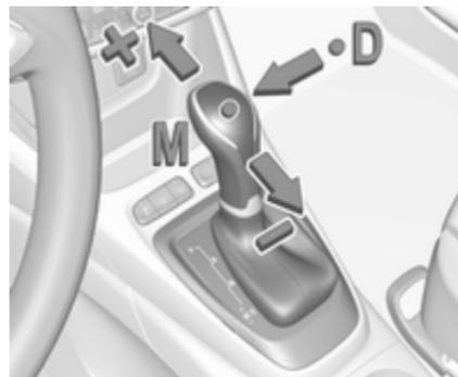
Schieben Sie den Wählhebel aus **D** nach links auf **M**.
