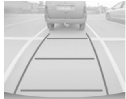
Auf dem Display wird der Bereich hinter dem Fahrzeug angezeigt. Die senkrechten Linien entsprechen der Breite des Fahrzeugs mit ausgeklappten Spiegeln. Die Ausrichtung der Linien ändert sich mit der Lenkradstellung.
