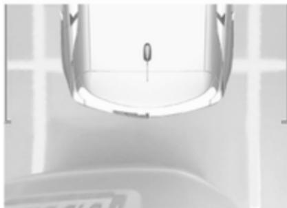
Durch Aufzeichnung der Fahrzeugumgebung während des Manövers rekonstruiert die Kamera die Darstellung dieser Umgebung von oben. So hat der Fahrer eventuelle Hindernisse stets im Blick. Diese Ansicht ist im Automatikmodus und im Menü zur Auswahl der Ansicht verfügbar.
