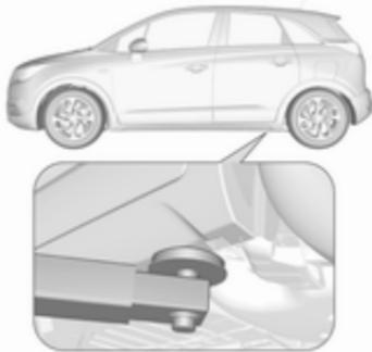
Hintere Arme der Hebebühne befinden sich mittig unter den entsprechenden Wagenheberaufnahmen.
