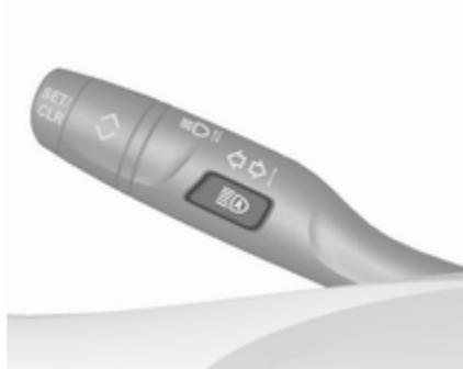
Die Funktion wird durch Drücken einer Taste am Blinkerhebel aktiviert. Wenn der Fernlichtassistent aktiviert ist, leuchtet die LED in der Taste. Bei Geschwindigkeiten über 25 km/h wird das Fernlicht automatisch eingeschaltet.
