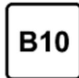
Dieselmotoren gemäß der Norm EN16734, mit Beimischung eines Biokraftstoffs gemäß der Norm EN14214 (der bis zu 10 % Fettsäuremethylester enthalten darf)
