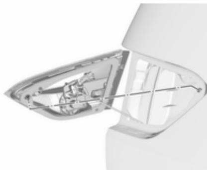
2. Das Lampengehäuse an der Heckklappe befestigen.
