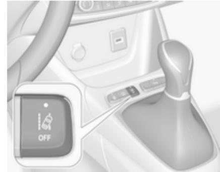
Die Spurverlassenswarnung wird durch Drücken von
