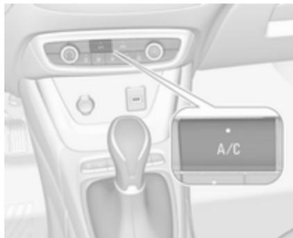
**A/C** drücken, um die Kühlung einzuschalten. Die Betätigung wird durch die LED auf der Taste angezeigt. Die Kühlung ist nur bei laufendem Motor und eingeschaltetem Klimatisierungsgebläse funktionsfähig.
