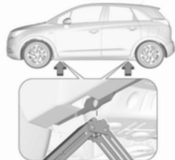
3. Sicherstellen, dass der Wagenheber richtig unter dem entsprechenden Ansatzpunkt ausgerichtet ist.
