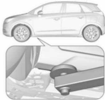
Vordere Arme der Hebebühne befinden sich mittig unter den entsprechenden Wagenheberaufnahmen.
