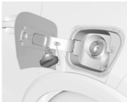
Der Tankdeckel kann am Haken an der Tankklappe eingehängt werden. Die Tankdüse gerade am Einfüllstutzen ansetzen und mit geringem Kraftaufwand einstecken. Zum Tanken die Zapfpistole betätigen. Nach dem automatischen Abschalten des Tankvorgangs darf die Zapfpistole noch maximal zweimal erneut betätigt werden, um den Tank vollständig aufzufüllen.
