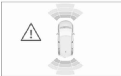
Außerdem wird die Entfernung zu Hindernissen hinter bzw. vor dem Fahrzeug durch veränderliche Abstandslinien im Info-Display ↻ 101 angezeigt.
