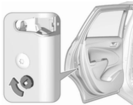
Zum Verriegeln der anderen Türen zuerst die schwarze Abdeckung entfernen. Dazu einen Schlüssel einführen und rechtsherum drehen.
