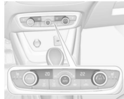
Grundeinstellungen für automatische Regelung mit maximalem Komfort:
