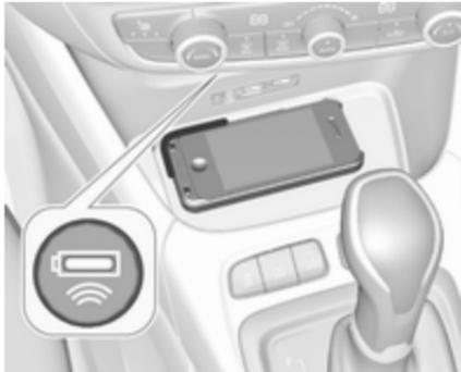
Um ein Gerät zu laden, muss die Zündung eingeschaltet sein.
