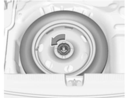
Das temporäre Reserverad befindet sich unter der Bodenabdeckung im Laderaum.
