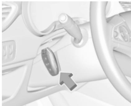
Den elektronischen Schlüssel wie abgebildet mit den Tasten nach außen an die Markierung an der Lenksäule halten.
