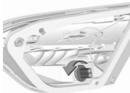
Die Lampenfassung linksherum aus dem Gehäuse herausdrehen.
