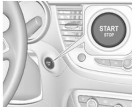
Der elektronische Schlüssel muss sich im Fahrzeug befinden.
