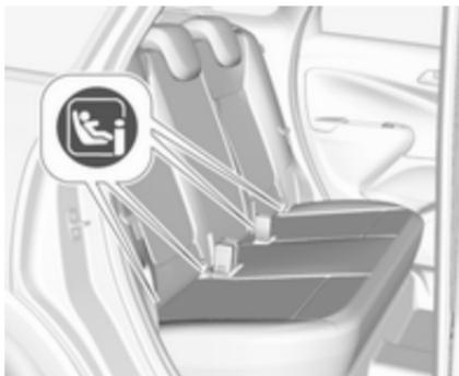
Für das Fahrzeug zugelassene ISOFIX-Kindersicherheitssysteme an ISOFIX-Befestigungen befestigen. Die speziellen Positionen für ISOFIX-Kindersicherheitssysteme sind in der Tabelle mit ISOFIX gekennzeichnet ⇨ 60.
