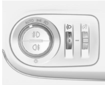
Zur Anpassung der Leuchtweite an die Fahrzeugbeladung, um Blendwirkung zu reduzieren: Daumenrad  $\odot$  in die gewünschte Stellung drehen.
