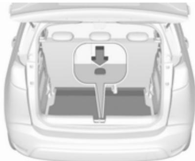
Die hintere Bodenabdeckung kann herausgenommen werden. Abdeckung an der Aussparung anheben und herausnehmen.
