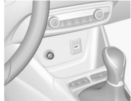
Der Zigarettenanzünder befindet sich hinter der Ablagenabdeckung unter den Bedienelementen der Klimatisierung. Zum Öffnen auf die Abdeckung drücken.
