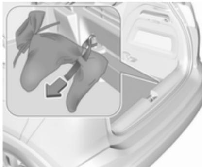
Den Gurt durch die hintere rechte Verzuröse führen, zweimal um den Beutel schlagen und zum Sichern des Beutels spannen.
