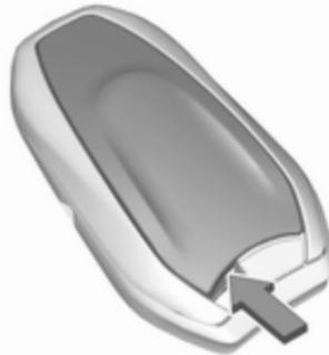
1. Zum Ausclipsen des Deckels einen kleinen Schraubendreher in die Aussparung einstecken.
