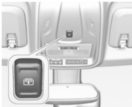
Leichtes Drücken auf
