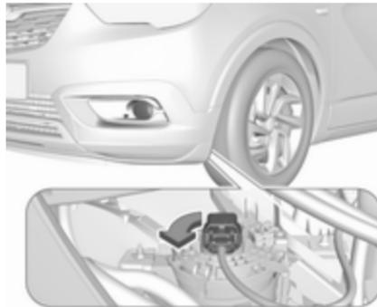
1. Die Lampenfassung linksherum drehen und aus dem Reflektorgehäuse entfernen.
