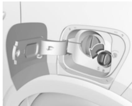
4. Die Schutzkappe vom Einfüllstutzen abschrauben.
