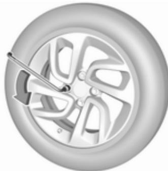
2. Radschraubenschlüssel ausklappen und so ansetzen, dass er gut
