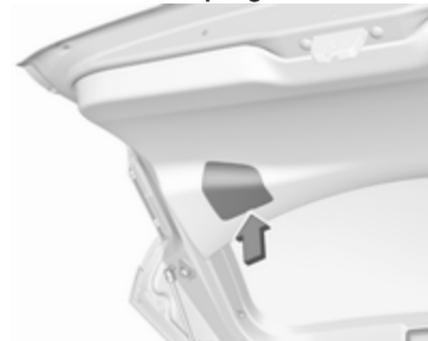
1. Die Abdeckung an der Heckklappe lösen und abnehmen.
