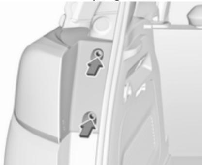
1. Die zwei Schrauben, mit denen das Lampengehäuse befestigt ist, herausdrehen.
