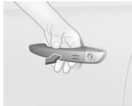
Um einen vorderen Türgriff fassen oder auf die Heckklappentaste drücken, um das Fahrzeug zu entriegeln.
