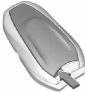
1. Zum Lösen die Abdeckung an der Öffnung mit einem kleinen Schraubendreher loshebeln.
