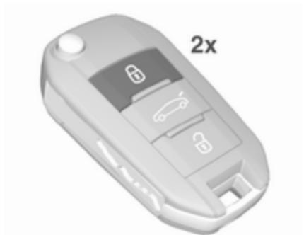
@ an der Funkfernbedienung zweimal innerhalb von 5 Sekunden drücken.
