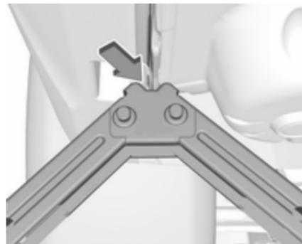
Sicherstellen, dass die Karosserie-riekante in der Kerbe am Wagenheber sitzt.
