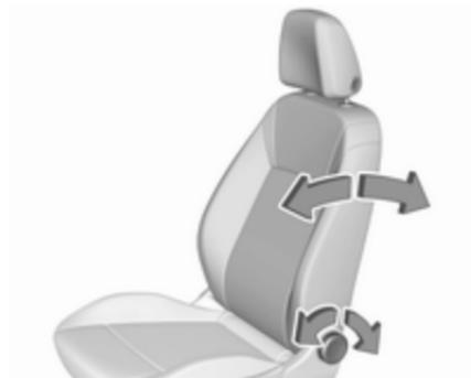
Handrad drehen. Zum Einstellen Rückenlehne entlasten.
