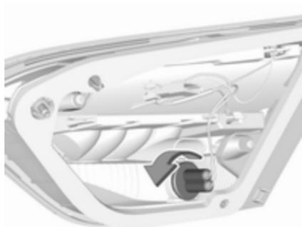
Lampenfassung des Rückfahrlichts nach links aus der Leuchteinheit herausdrehen.
