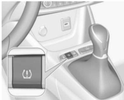
Nach einer Korrektur des Reifendrucks oder einem Reifenwechsel muss das System initialisiert werden, um neue Umfangs-Referenzwerte anzulernen:
