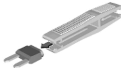
Die Sicherung mit dem Sicherungsabzieher greifen und herausziehen.
