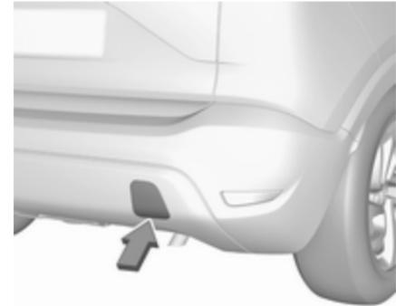
Die Spitze eines Schlitzschraubendrehers mit einem Tuch umwickeln, um den Lack zu schützen. Einen Schraubendreher in den Schlitz unten an der Abdeckung einschieben. Die Abdeckung vorsichtig abhebeln und lösen.
