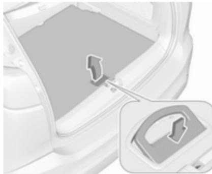
Zum Herausnehmen den Laderaumboden durch Drücken auf den Griff entriegeln und am Griff anheben.
