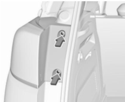
1. Die beiden Befestigungsschrauben der Leuchteneinheit herausdrehen.
