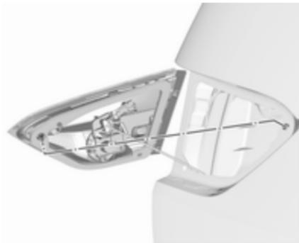
2. Die Leuchteneinheit an der Heckklappe befestigen.
