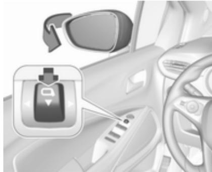
Die Spiegeltaste nach hinten ziehen. Beide Außenspiegel werden eingeklappt.
