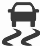
ESC und Traktionskontrolle sind nach jedem Motorstart funktionsfähig, sobald die Kontrollleuchte
