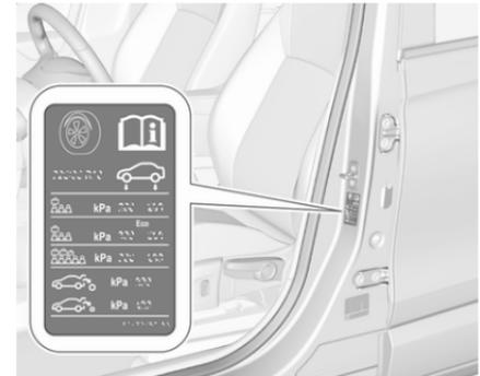
Das Reifendruckhinweisschild am linken vorderen Türrahmen gibt die Originalreifen und die entsprechenden Reifendrucke an.
