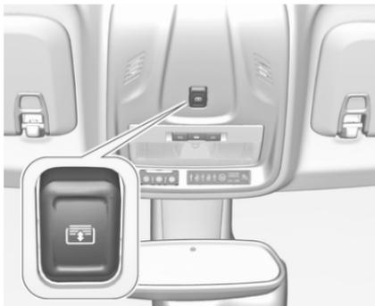
Leichtes Drücken auf
