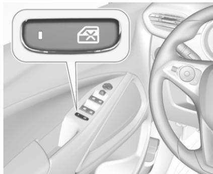
Zur Deaktivierung der elektrischen Fensterheber der hinteren Türen ☒ drücken. Die LED leuchtet auf. Zur Aktivierung erneut ☒ drücken.
