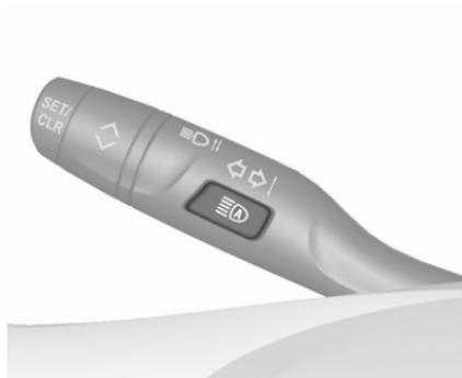
Den Fernlichtassistenten durch Drücken auf **D** aktivieren. Die LED in der Taste leuchtet auf.
