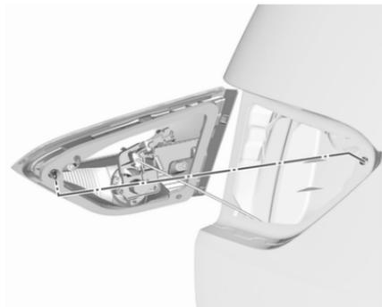
2. Die Leuchteneinheit an der Heckklappe befestigen.
