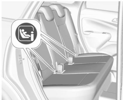
Für das Fahrzeug zugelassene ISOFIX-Kindersicherheitssysteme an den ISOFIX-Befestigungen befestigen. Die speziellen Positionen für ISOFIX-Kindersicherheitssysteme sind in der Tabelle mit ISOFIX gekennzeichnet ↷ 61.
