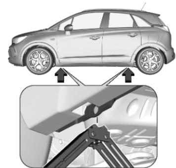
3. Sicherstellen, dass der Wagenheber richtig unter dem entsprechenden Aufnahmepunkt ausgerichtet ist.
