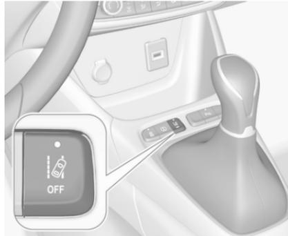
Die Spurverlassenswarnung wird durch Drücken auf
