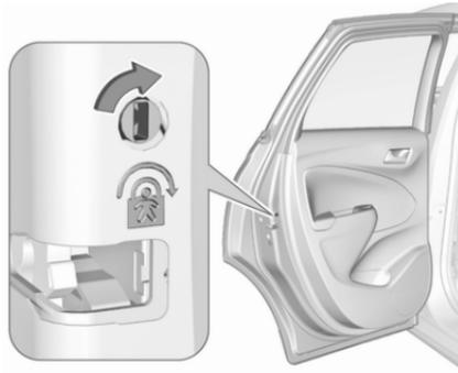
Rote Kindersicherung in den hinteren Türen mit einem Schlüssel in waagerechte Position drehen. Die Tür lässt sich dann von innen nicht öffnen.
