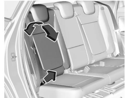
An der Schlaufe ziehen, Neigung einstellen und Schlaufe loslassen. Zum Einstellen Rückenlehne entlasten.
