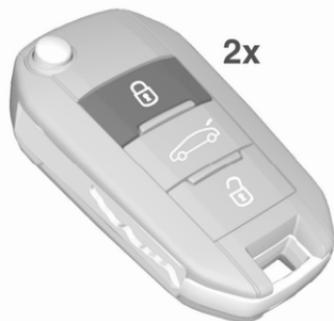
Ⓜ an der Funkfernbedienung zweimal innerhalb von 5 Sekunden drücken.
