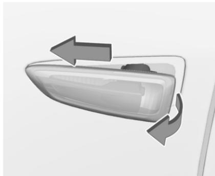
1. Die Leuchteneinheit nach vorn schieben und an der Rückseite abziehen.
