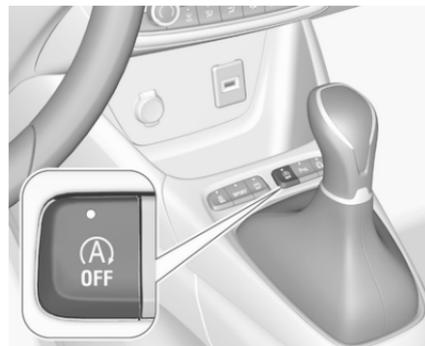
Die Stopp-Start-Automatik lässt sich durch Drücken von
