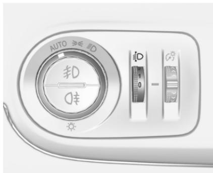
Zur Anpassung der Leuchtweite an die Fahrzeuglast, um die Blendwirkung zu reduzieren: Daumenrädchen  $\text{HD}$  in die gewünschte Stellung drehen.
