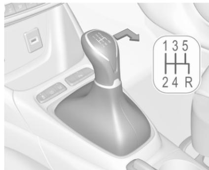
Beim 5-Gang-Getriebe zum Einlegen des Rückwärtsgangs das Kupplungspedal betätigen und den Wählhebel nach rechts hinten bewegen.
