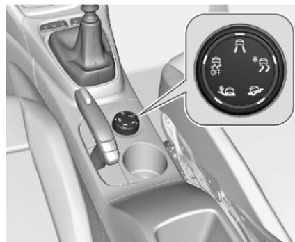
Die selektive Fahrsteuerung bietet die Wahl unter fünf Fahrmodi:
