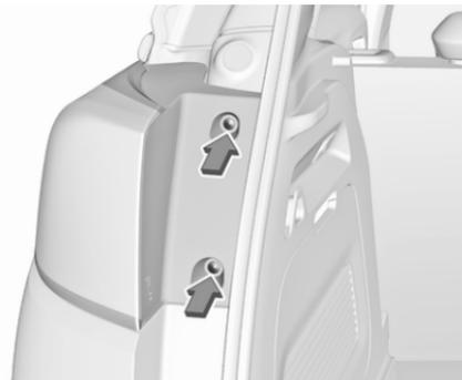
1. Die beiden Befestigungsschrauben der Leuchteneinheit herausdrehen.
