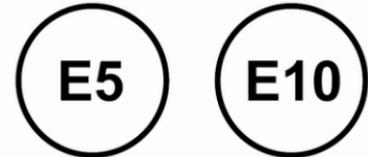
Kraftstoff gemäß der Norm EN228, mit Beimischung eines Biokraftstoffs gemäß der Norm EN15376.
