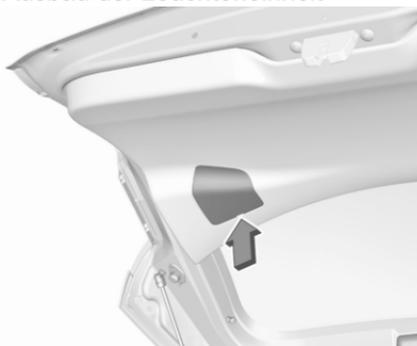
1. Die Abdeckung an der Heckklappe lösen und abnehmen.
