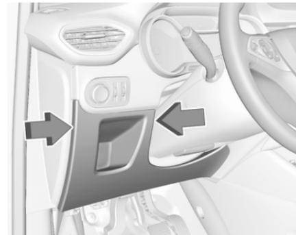
Bei Linkslenkern befindet sich der Sicherungskasten hinter einer Abdeckung in der Instrumententafel. Abdeckung an der Seite lösen und abnehmen.
