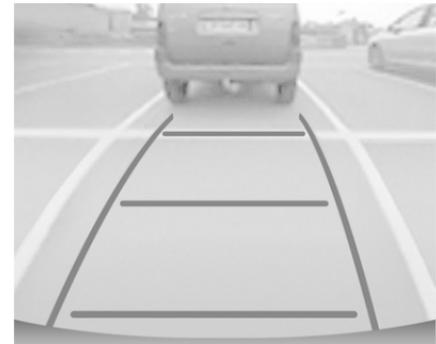
Auf dem Bildschirm wird der Bereich hinter dem Fahrzeug angezeigt. Die senkrechten Linien zeigen die Fahrzeugbreite bei ausgeklappten Seitenspiegeln an. Die Richtung der Linien ändert sich mit dem Lenkwinkel.
