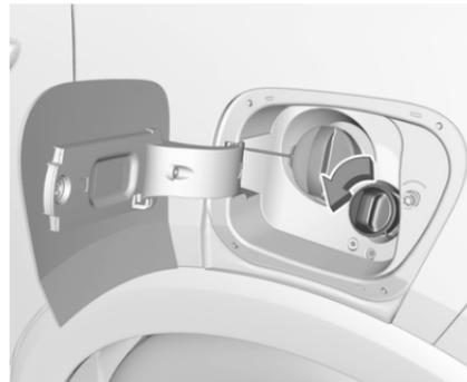
4. Die Schutzkappe vom Einfüllstutzen abschrauben.
