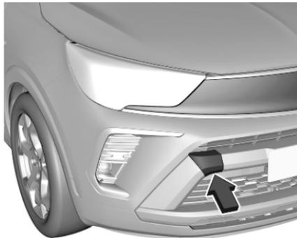
Die Spitze eines Schlitzschraubendrehers mit einem Tuch umwickeln, um den Lack zu schützen. Einen Schraubendreher in den Schlitz unten an der Abdeckung einschieben. Die Abdeckung vorsichtig abhebeln und lösen.
