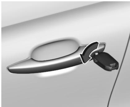
Schlüssel im Schließzylinder der Fahrertür drehen.
