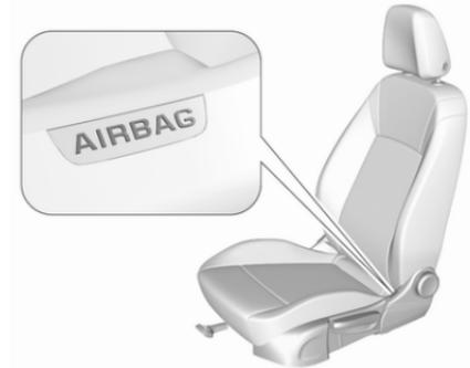
Das Seiten-Airbag-System besteht aus je einem Airbag in der Sitzlehne jedes Vordersitzes. Diese Stellen sind mit dem Wort **AIRBAG** gekennzeichnet.
