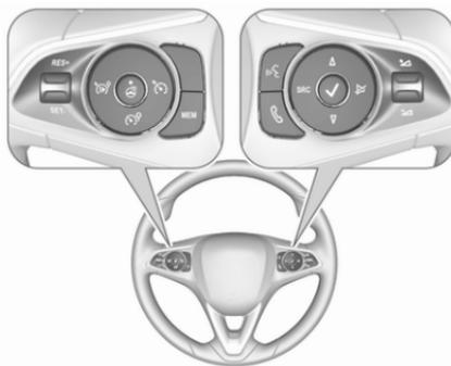
Der Geschwindigkeitsregler und der Geschwindigkeitsbegrenzer werden über die Bedienelemente links am Lenkrad bedient.
