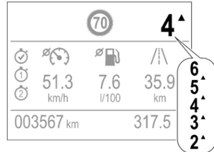
Wenn ein Hochschalten empfohlen wird, um Kraftstoff zu sparen, wird ▲ mit der Zahl eines höheren Ganges angezeigt.
