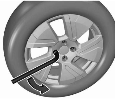
2. Radschlüssel anbringen und jede Radschraube um eine halbe Umdrehung lockern. Die Räder können mit Befestigungsschrauben verriegelt werden. Um diese speziellen Schrauben zu lösen, zunächst den Adapter für die Sicherungsradschrauben auf dem Schraubenkopf anbringen, bevor man den Radschlüssel ansetzt. Der Adapter für die Sicherungsradmutter kann in einer Werkzeugtasche im Laderaum oder in einer Tasche zusammen mit dem Reifenreparaturset untergebracht werden.
