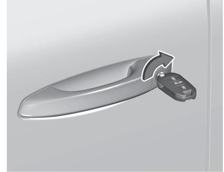
Die linke Vordertür durch Einsetzen und Drehen des Schlüssels im Schließzylinder von Hand verriegeln. Bei funktionsfähiger Zentralverriegelung wird das Fahrzeug verriegelt.
