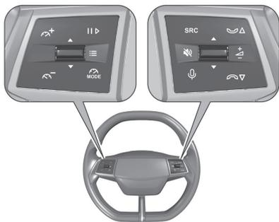
Das Menü des Kombiinstrument, bestimmte Fahrerassistenzsysteme, das Infotainment-System und ein verbundenes Mobiltelefon können über die Bedienelemente am Lenkrad bedient werden.
