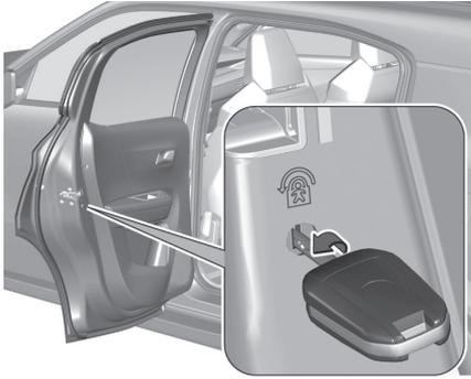
Rote Kindersicherung in den hinteren Türen mit einem Schlüssel in Richtung Fahrzeuginnenraum in die waagerechte Stellung drehen. Die Tür lässt sich dann von innen nicht öffnen.
