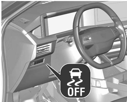
ESC und Antischlupfregelung (ASR) können bei Bedarf deaktiviert werden:
