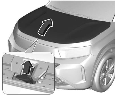
Heben Sie den äußeren Sicherheitsbügel an, und öffnen Sie die Motorhaube. Die Motorhaubenstütze aus ihrer Halterung lösen und in der Raste fixieren, um die Motorhaube offen zu halten.
