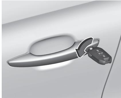
Die linke Tür durch Einsetzen und Drehen des Schlüssels im Schließzylinder entgegen den Uhrzeigersinn von Hand entriegeln. Durch Einschalten der Zündung wird die Diebstahlsicherung deaktiviert. Die anderen Türen können durch Ziehen am Innengriff geöffnet werden. Der
