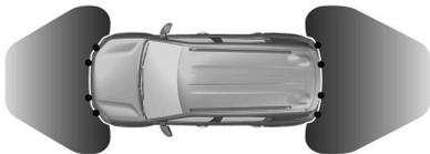
Das System arbeitet mit Ultraschall-Parksensoren im hinteren und vorderen Stoßfänger.
