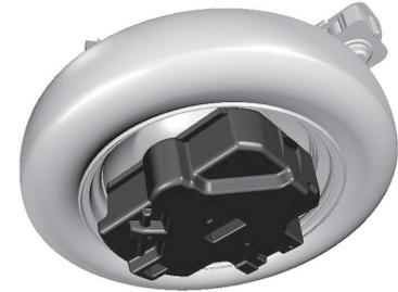
4. Entfernen Sie den Wagenheber mit seinem Befestigungsclip, um die gesamte Rad-/Werkzeugbaugruppe zu lösen.
