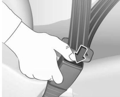
Zum Lösen des Sicherheitsgurts die rote Taste am Gurtschloss drücken und den Sicherheitsgurt zurückführen.
