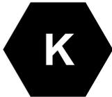
FF-Stecker bzw. -Anschluss zum Laden mit Gleichstrom
