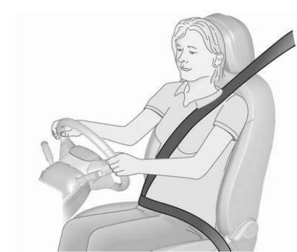
Bei starker Beschleunigung oder Verzögerung des Fahrzeugs blockieren die Sicherheitsgurte, um die Insassen in ihrer Sitzposition zu halten. Dies verringert die Verletzungsgefahr drastisch.
