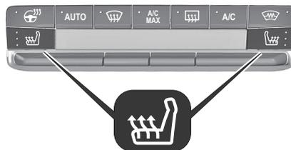
Je nach gewünschter Heizleistung die Taste für den jeweiligen Sitz ein- oder mehrmals drücken. Die Kontrollleuchten in der Taste zeigen die Einstellungen an. Die Heizung funktioniert nur bei Außentemperaturen unter 20 °C. Für Personen mit empfindlicher Haut wird ein längerer Einsatz der höchsten Einstellung nicht empfohlen. Die Sitzheizung funktioniert nur bei laufendem Motor. Während eines Autostopps ist die Sitzheizung auch in Betrieb.
