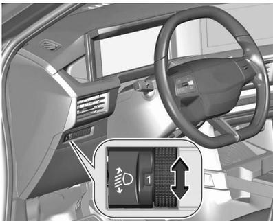
Zur Anpassung der Leuchtweite der Scheinwerfer an die Fahrzeuglast, um die Blendwirkung zu reduzieren: Daumenrädchen in die gewünschte Stellung drehen.
