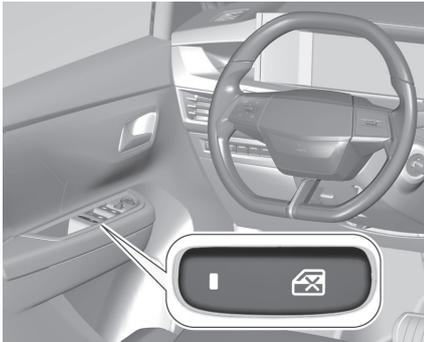
Zur Deaktivierung der elektrischen Fensterheber der hinteren Türen die Taste drücken. Die LED leuchtet auf. Zur Aktivierung, erneut drücken.
