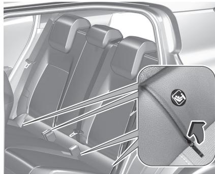
Für das Fahrzeug zugelassene ISOFIX-Kinderrückhaltesysteme an den ISOFIX-Befestigungen befestigen. Die speziellen Positionen für ISOFIX-Kinderschutzsysteme sind in der Tabelle der Kinderrückhaltesysteme gekennzeichnet.
