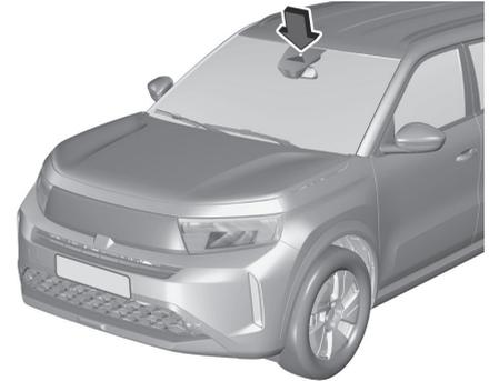
Windschutzscheibenaufkleber wie etwa Autobahnvignetten o.ä. nicht im Bereich des Innenspiegels anbringen. Sensor frei von Staub, Schmutz und Eis halten. Andernfalls könnten die Abtastzone des Regen-/Lichtsensors und der Sichtbereich der Kamera im Spiegelgehäuse beeinträchtigt werden.
