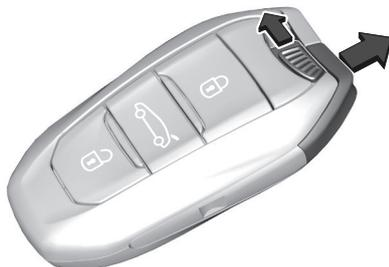
Die Arretierung drücken, um den integrierten Schlüssel zu entnehmen.
