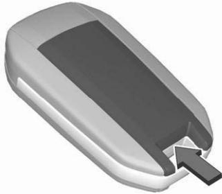
1. Um die Abdeckung zu lösen, führen Sie einen kleinen Schraubendreher zwischen der hinteren Abdeckung und der Fernbedienung ein.
