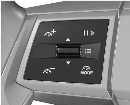
Die eingestellte Geschwindigkeit kann durch Drücken auf  $\curvearrowright^+$  erhöht und durch Drücken auf  $\curvearrowleft^-$  verringert werden. Durch kurzes Drücken wird die Geschwindigkeit in Schritten von 1 km/h geändert, bei langem Drücken in Schritten von 5 km/h.
