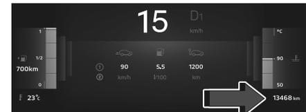
Die aufgezeichnete Gesamtstrecke des Fahrzeugs wird in der rechten unteren Ecke des Kombiinstruments angezeigt.
