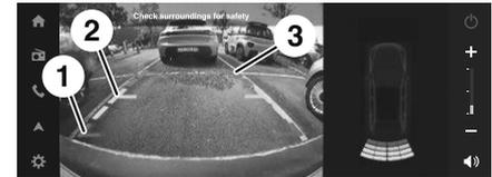
Auf dem Bildschirm wird der Bereich hinter dem Fahrzeug angezeigt. Die senkrechten Linien zeigen die Fahrzeugbreite bei ausgeklappten Seitenspiegeln an.
