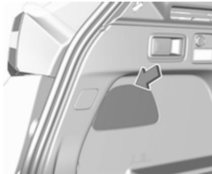
1. Die Heckklappe öffnen und dann die Zugangsabdeckung auf der entsprechenden Seite abclipsen.
