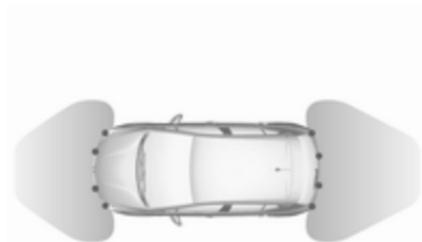
Das System arbeitet mit je vier Ultraschall-Parksensoren im hinteren und vorderen Stoßfänger.
