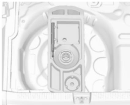
Die Abschleppöse und Unterlegkeile befinden sich in einem Kasten unter der Bodenabdeckung im Laderaum. Reifenreparaturset ↪ 237.
