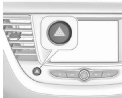
Wird durch Drücken von
