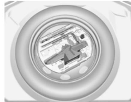
Wagenheber, Abschleppöse, Unterlegkeile und Werkzeuge befinden sich im Werkzeugkasten.
