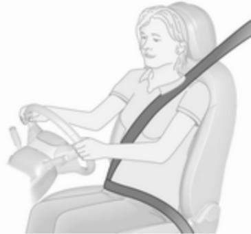
Bei starker Beschleunigung oder Verzögerung des Fahrzeugs blockieren die Sicherheitsgurte, um die Insassen in ihrer Sitzposition zu halten. Daher ist die Verletzungsgefahr deutlich geringer.
