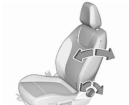
Handrad drehen. Zum Einstellen Rückenlehne entlasten.
