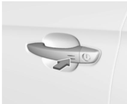
Mit einem Finger oder dem Daumen auf die Markierung an einem der Außentürgriffe oder das Touchpad an der Heckklappe drücken.
