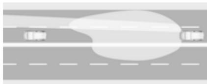
Der Fernlichtassistent beinhaltet einen speziellen Autobahnmodus. Wird auf Autobahnen schneller als 115 km/h gefahren, verkleinert sich der Lichtstrahl, damit der entgegenkommende Verkehr nicht geblendet wird. Beim Fahren hinter Fahrzeugen bzw. beim Überholen wird die Spiegelblendwirkung in diesen Fahrzeugen verringert.
