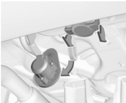
Die Steckdose ausrasten und nach unten klappen. Verschlussstopfen von der Öffnung für die Kugelstange entfernen und verstauen.
