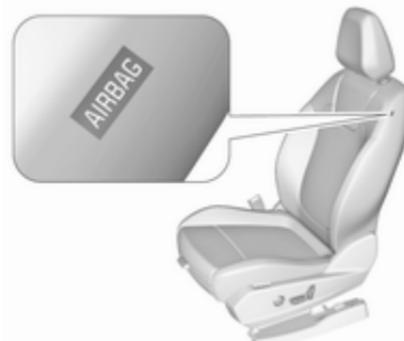
Das Seiten-Airbag-System besteht aus einem Airbag in der Rückenlehne der Vorder- und äußeren Rücksitze. Diese Stellen sind mit dem Wort **AIRBAG** gekennzeichnet.
