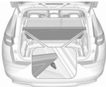
Um die Laderaumabdeckung in aufrechter Position zu halten, diese an den versenkbaren Anschlägen anheben.
