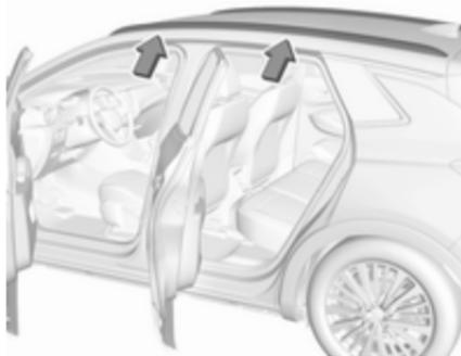
Den Dachgepäckträger im Dachgepländer über den Befestigungspunkten befestigen, die sich in den Türschwelleren der Fahrzeugkarosserie befinden.
