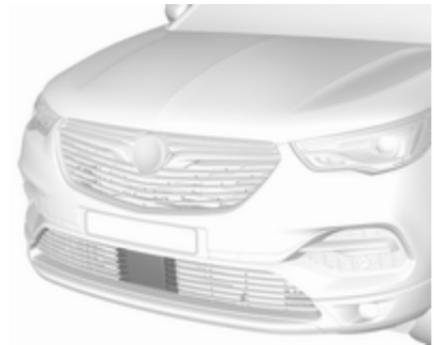
Die Radareinheit befindet sich in der Mitte des vorderen Stoßfängers.
