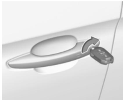
Zum manuellen Verriegeln der Fahrertür den Schlüssel in den Schließzylinder stecken und drehen.
