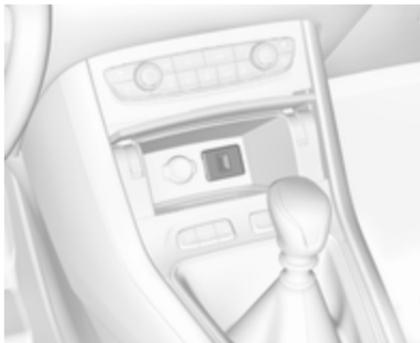
Unterhalb der Bedienelemente der Klimatisierung befindet sich hinter der Ablagenabdeckung ein USB-Anschluss. Zum Öffnen auf die Abdeckung drücken.
