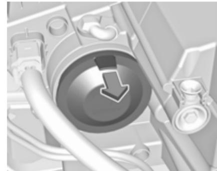
1. Die Schutzabdeckung durch Ziehen der Nase entfernen.
