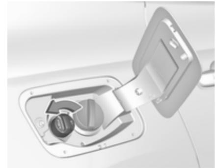
4. Die Schutzkappe vom Einfüllstutzen abschrauben.
