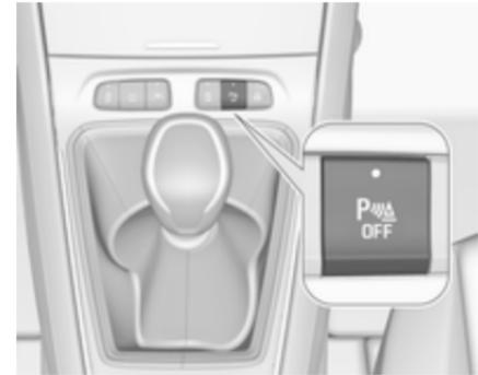
Beim Ausrücken des Rückwärtsgangs wird das System ausgeschaltet. Um das System manuell zu deaktivieren,  $P_{\text{off}}$  drücken. Bei deaktiviertem System leuchtet die LED in der Taste. Wenn das System manuell deaktiviert wurde, wird es beim nächsten Einschalten der Zündung nicht automatisch neu aktiviert.
