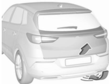
Zum Öffnen oder Schließen der Heckklappe den Fuß unter dem Heckstoßfänger im Bereich des Kennzeichens vor und zurück bewegen (siehe Abbildung). Der Schlüssel darf höchstens einen Meter entfernt sein. Bei Fahrzeugen mit Einparkhilfe ist der Bereich unter dem abgebildeten Sensor erkennbar. Den Fuß nicht länger unter den Heckstoßfänger halten oder zu langsam hin und her
