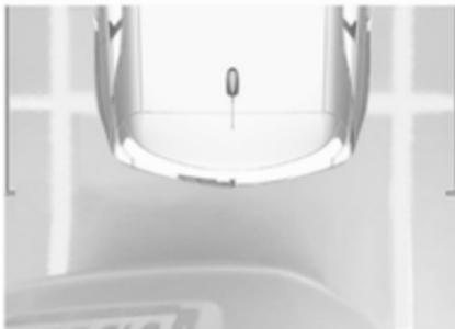
Durch Aufzeichnung der Umgebung an der Vorder- oder Rückseite des Fahrzeugs während des Manövers rekonstruiert die Kamera die Darstellung dieser Umgebung von oben. So hat der Fahrer eventuelle Hindernisse stets im Blick. Diese Ansicht ist im Automatikmodus und im Menü zur Auswahl der Ansicht verfügbar.
