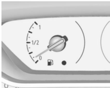
Zeigt den Füllstand im Kraftstofftank an.
