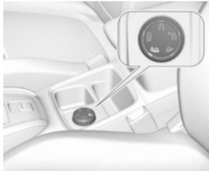
Bei diesem Modus drehen beide Antriebsräder gleichzeitig etwas durch, sodass das Fahrzeug fährt und das Risiko eines Feststeckens verringert wird.
