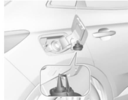
Der Tankdeckel kann am Haken an der Tankklappe eingehängt werden. Zum Tanken die Zapfpistole so weit wie möglich in die Tanköffnung einführen und dann betätigen.
