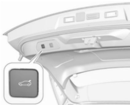
Zum Schließen auf
