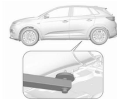
Hintere Arme der Hebebühne befinden sich mittig unter den entsprechenden Wagenheberaufnahmen.
