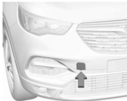
Entfernen Sie den Verschlussdeckel. Die Abschleppöse befindet sich beim Wagenwerkzeug ↪ 231.
