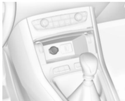
Unterhalb der Bedienelemente der Klimatisierung befindet sich hinter der Ablagenabdeckung eine 12-Volt-Zubehörsteckdose. Zum Öffnen auf die Abdeckung drücken.
