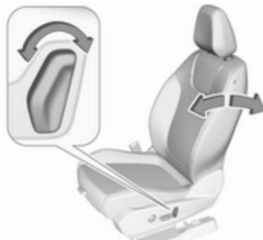
Schalter nach vorne/hinten drehen. Lendenwirbelstütze, verstellbare Oberschenkelauflage, siehe manuelle Sitzeinstellung ↗ 50.
