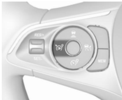
☹ drücken: Der Geschwindigkeitsregler ist im Pausenmodus. Pause wird angezeigt. Das Fahrzeug wird ohne Geschwindigkeitsregler gefahren.
