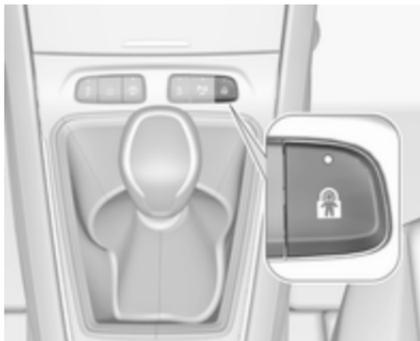
Ferngesteuertes System, das ein Öffnen der Hintertüren über die Innengriffe und die Betätigung der elektrischen Fensterheber hinten verhindert. Das Bedienelement befindet sich in der Mittelkonsole vor dem Wählhebel.
