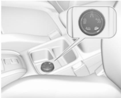
Dieser Modus sorgt beim Start für ein beträchtliches Durchdrehen des Rads mit der geringsten Bodenhaftung, wodurch Schlamm entfernt und die Traktion wieder hergestellt werden.
