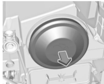
1. Die Schutzabdeckung durch Ziehen entfernen.
