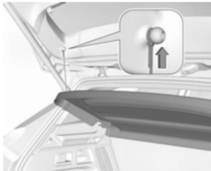
Haltebänder von der Heckklappe lösen.
