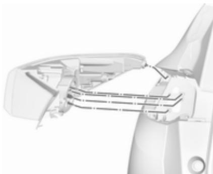
5. Den Leuchtensammenbau von außen vorsichtig aus der Aussparung herausziehen und entfernen. Aufpassen, dass der Kabelkanal nicht verschoben wird.
