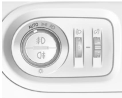
Bei aktivierter Funktion Automatisches Fahrlicht und laufendem Motor schaltet das System abhängig von den äußeren Lichtverhältnissen und den Informationen des Wischersystems zwischen Tagfahrlicht und Scheinwerfern automatisch um. Tagfahrlicht ⇨ 121.
