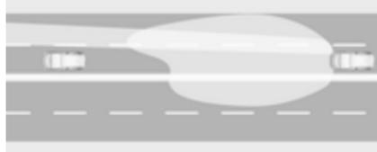
Der Fernlichtassistent beinhaltet einen speziellen Autobahnmodus. Wird auf Autobahnen schneller als 115 km/h gefahren, verkleinert sich der Lichtstrahl, damit der entgegenkommende Verkehr nicht geblendet wird. Beim Fahren hinter Fahrzeugen bzw. beim Überholen wird die Blendwirkung für Fahrer dieser Fahrzeuge verringert.
