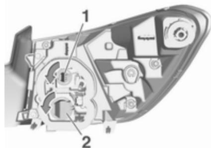
7. Die Lampe aus der Lampenfassung lösen und ersetzen.
