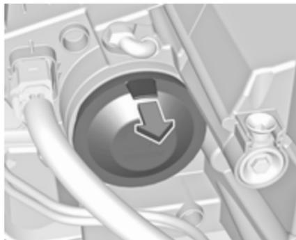
1. Die Schutzabdeckung durch Ziehen der Nase entfernen.
