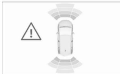
Außerdem wird die Entfernung zu Hindernissen hinter bzw. vor dem Fahrzeug durch veränderliche Abstandslinien im Info-Display ↻ 106 angezeigt.
