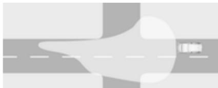
Wird automatisch bei Geschwindigkeiten bis ca. 55 km/h und in Situationen mit Außenumgebungslicht aktiviert. Das Licht ist weit und symmetrisch. Wenn die Geschwindigkeit geringer als 30 km/h beträgt, werden die Scheinwerfer etwas nach außen geschwenkt, um Fußgänger und Objekte auf beiden Straßenseiten früher zu erkennen. Eine spezielle Lichtverteilung sorgt dafür, dass andere Straßenbenutzer nicht geblendet werden.
