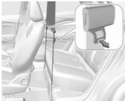
Die Klappe am Spanner an beiden Seiten ziehen, um die Bänder zu lösen. Haken von den Schlaufen lösen.
