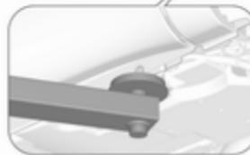
Hintere Arme der Hebebühne befinden sich mittig unter den entsprechenden Wagenheberaufnahmen.
