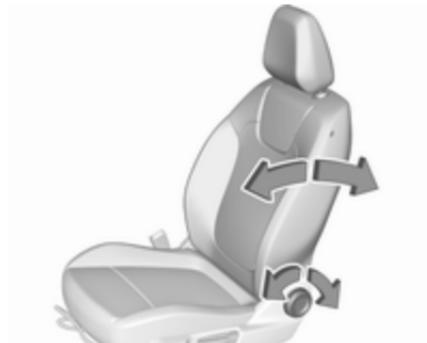
Handrad drehen. Zum Einstellen Rückenlehne entlasten.
