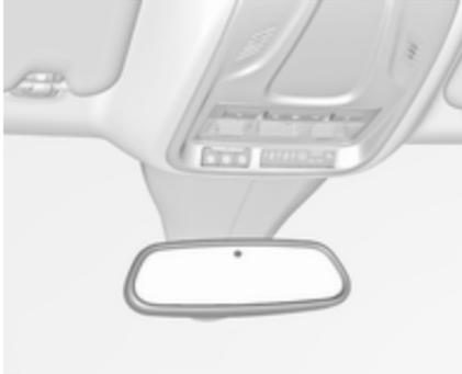
Beim Fahren im Dunkeln wird die Blendwirkung folgender Fahrzeuge automatisch reduziert.
