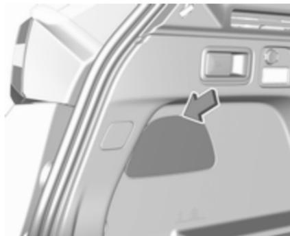
1. Die Heckklappe öffnen und dann die Zugangsabdeckung auf der entsprechenden Seite abklipsen.
