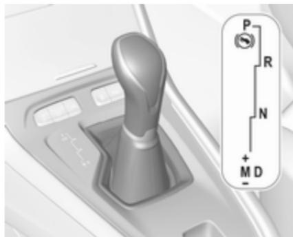
Zum Schalten den Wählhebel wie oben abgebildet durch die Schaltkulisse führen.
