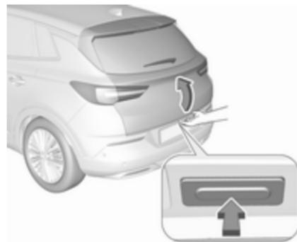
Nach dem Entriegeln die Heckklappentaste drücken und die Heckklappe öffnen.
