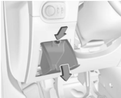
Bei Linklenkern befindet sich der Sicherungskasten hinter einer Abdeckung in der Instrumententafel auf der linken Seite. Die Abdeckung öffnen und durch Drücken auf die Verriegelung entfernen.
