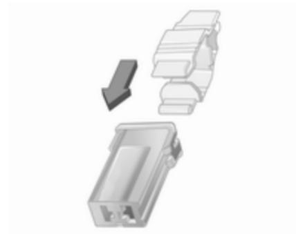
Die Sicherung je nach Bauart von oben oder von der Seite mit dem Sicherungszieher fassen. Die Sicherung abziehen.
