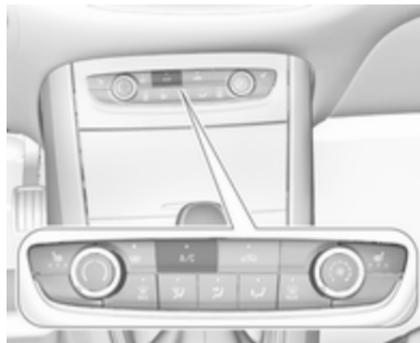
**A/C** drücken, um die Kühlung einzuschalten. Die LED in der Taste leuchtet auf, um die Aktivierung anzuzeigen. Die Kühlung ist nur bei laufendem Motor und eingeschaltetem Gebläse funktionsfähig.
