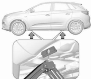
3. Sicherstellen, dass der Wagenheber richtig unter dem entsprechenden Ansatzpunkt ausgerichtet ist.
