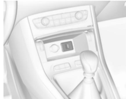
Unter der Stauraumabdeckung befindet sich ein USB-Anschluss. Zum Öffnen auf die Abdeckung drücken.
