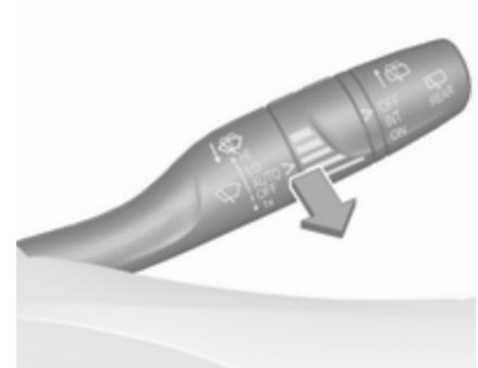
Hebel ziehen. Waschflüssigkeit spritzt auf die Windschutzscheibe und der Wischer wird für einige Wischbewegungen eingeschaltet. Waschflüssigkeit
