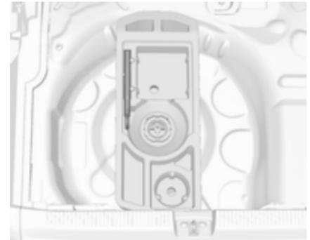
Die Abschleppöse und Unterlegkeile befinden sich in einem Kasten unter der Bodenabdeckung im Laderaum. Reifenreparaturset ⇨ 239.
