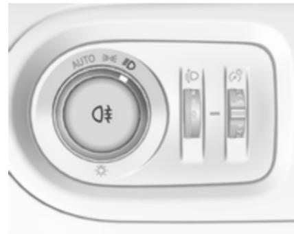
Wird durch Drücken von  $\text{D}$  bedient. Lichtschalter auf **AUTO**: Beim Einschalten der Nebelschlussleuchte werden die Scheinwerfer automatisch eingeschaltet.
