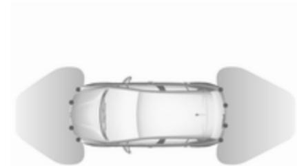
Das System arbeitet mit je vier Ultraschall-Parkensensoren im hinteren und vorderen Stoßfänger.
