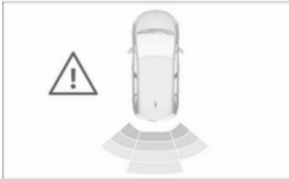
Außerdem wird die Entfernung zu Hindernissen hinter dem Fahrzeug durch veränderliche Abstandslinien im Info-Display ↪ 106 angezeigt. Wenn der Abstand zum Hindernis sehr klein ist, wird das Gefahrensymbol angezeigt.
