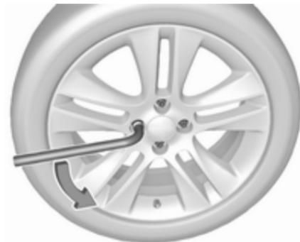
2. Radschraubenschlüssel herausklappen und sicherstellen, dass er gut sitzt. Jede Radmutter um eine halbe Drehung lösen.
