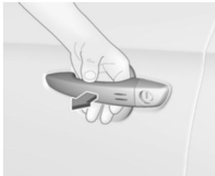
Eine Hand hinter den Türgriff einer der vorderen Türen führen, um das Fahrzeug zu entriegeln, oder die Taste an der Heckklappe drücken.
