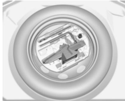
Wagenheber, Abschleppöse, Unterlegkeile und Werkzeuge befinden sich im Werkzeugkasten.
