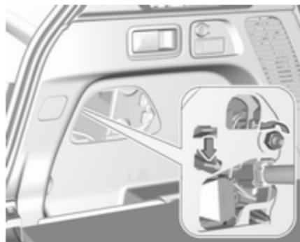
2. Die Leuchtenbefestigungsmutter mit einem Steckschlüssel lösen.
