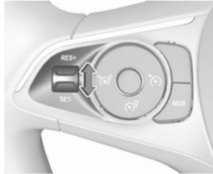
Auf die gewünschte Geschwindigkeit beschleunigen und das Daumenrädchen einmal kurz auf **SET/-** bewegen. Die aktuelle Geschwindigkeit wird gespeichert und konstant gehalten. Gaspedal kann gelöst werden.
