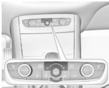
Den Luftstrom durch Drehen des Drehrings auf die gewünschte Geschwindigkeit einstellen. Zum Senken linksherum, zum Erhöhen rechtsherum drehen. Die Gebläsezahl kann ebenfalls im Menü der Klimatisierungseinstellungen geändert werden. Zum Öffnen des Menüs auf **MENU** drücken.
