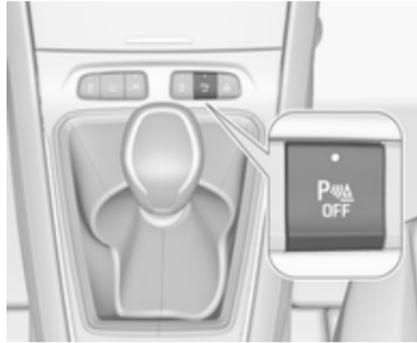
Beim Ausrücken des Rückwärts-gangs wird das System ausgeschaltet. Um das System manuell zu deaktivieren, **P OFF** drücken. Bei deaktiviertem System leuchtet die LED in der Taste. Wenn das System manuell deaktiviert wurde, wird es beim nächsten Einschalten der Zündung nicht automatisch neu aktiviert.
