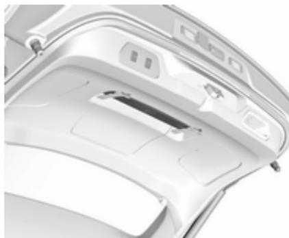
Das Warndreieck im Fach innen in der Heckklappe verstauen und mit dem Klettband sichern.
