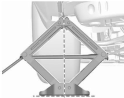
4. Wagenheber auf die erforderliche Höhe einstellen. Direkt unter dem Wagenheberaufnahme punkt so positionieren, dass er nicht abrutschen kann.
