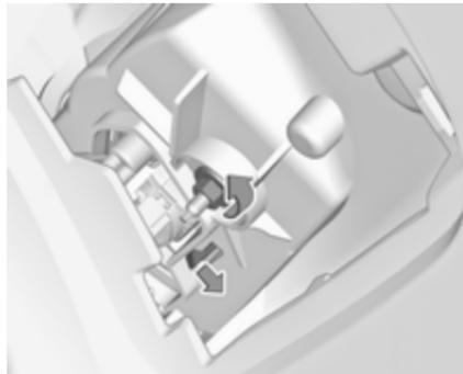
2. Die Leuchtenbefestigungsmutter mit einem Steckschlüssel lösen.
