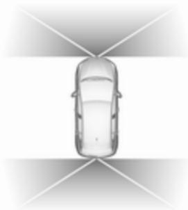
Die 180°-Ansicht erleichtert das Ausparken aus einer Parklücke, indem sie sich nähernde Fahrzeuge, Fußgänger und Radfahrer anzeigt. Für ein vollständiges Einparkmanöver wird diese Ansicht nicht empfohlen. Die Ansicht setzt sich aus drei Bereichen zusammen: links (1), Mitte (2) und rechts (3). Die Ansicht ist nur über das Menü zur Auswahl der Ansicht verfügbar.
