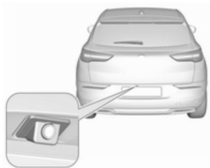
Die Kamera ist in der Heckklappe montiert.
