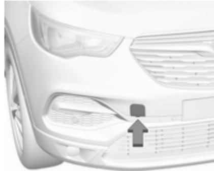
Entfernen Sie den Verschlussdeckel. Die Abschleppöse befindet sich beim Wagenwerkzeug ↪ 233.
