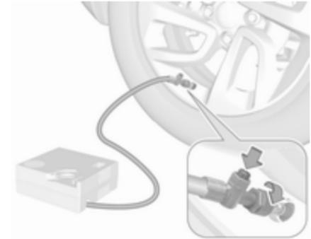
16. Fahrt unverzüglich fortsetzen, damit sich das Dichtmittel im Reifen gleichmäßig verteilt. Nach ca. 5 km Fahrtstrecke (spätestens jedoch nach 10 Minuten) anhalten und den Reifendruck kontrollieren. Hierzu den Luftschlauch des Kompressors direkt auf das Reifenventil schrauben. Den Reifen wie zuvor beschrieben mit Luft befüllen. Zu hohen Reifendruck mithilfe der Taste am Luftschlauch korrigieren.
