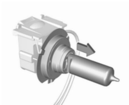
3. Die Lampe aus der Lampenfassung lösen und ersetzen.
