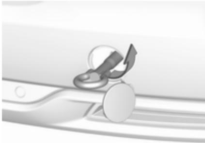
Abschleppöse bis zum Anschlag in waagrechter Stellung einschrauben.
