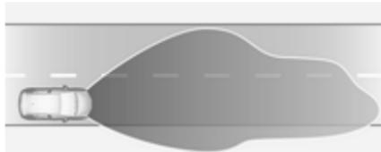
Wird automatisch bei einer Geschwindigkeit über 115 km/h. Die Beleuchtung wird an die höhere Geschwindigkeit auf Autobahnen angepasst. Ohne Gegenverkehr wird die Sicht auf der Fahrzeugseite erhöht. Der Sichtbarkeitsbereich wird von 70 m auf 140 m erhöht; so können entfernte Objekte auf der gesamten Fahrbahnbreite erkannt werden.
