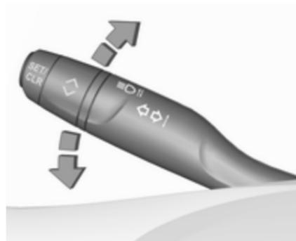
Hebel nach oben : Blinker rechts
