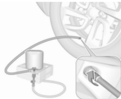
7. Einfüllschlauch an Reifenventil anschrauben.
