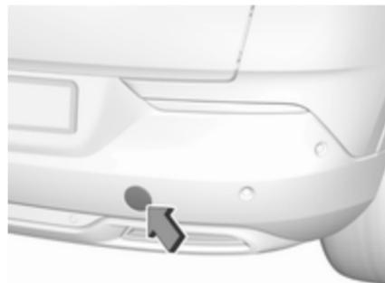
Entfernen Sie den Verschlussdeckel. Die Abschleppöse befindet sich beim Wagenwerkzeug ↗ 233.
