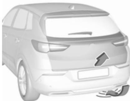
Zum Öffnen oder Schließen der Heckklappe den Fuß unter dem Heckstoßfänger im Bereich des Kennzeichenschildes vor und zurück bewegen. Der Schlüssel muss sich in einem Abstand von max. 1 m befinden. Den Fuß nicht länger unter dem Stoßfänger halten oder zu langsam bewegen. Der elektronische Schlüssel muss sich außerhalb des Fahrzeugs in einer Entfernung von ca. 1 m zur Heckklappe befinden.
