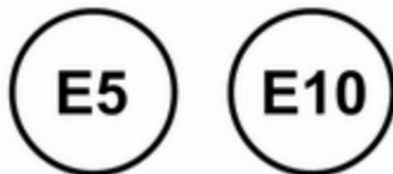
Nur bleifreien Kraftstoff verwenden, der Europeanorm EN 228 oder E DIN 51626-1 oder einer gleichwertigen Bestimmung entspricht.
