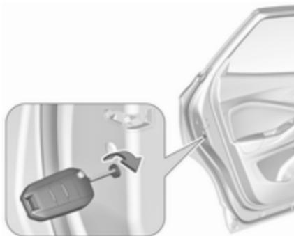
Um die anderen Türen zu verriegeln, die schwarze Abdeckung mit einem Schlüssel entfernen.
