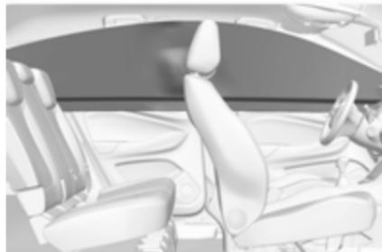
Der aufgeblähte Airbag dämpft den Aufprall, wodurch die Verletzungsgefahr für den Kopf bei einem Seitenaufprall deutlich verringert wird.
