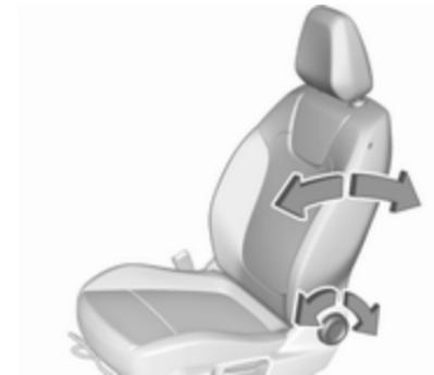
Handrad drehen. Zum Einstellen Rückenlehne entlasten.
