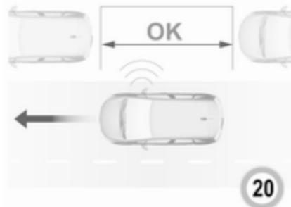
Wenn eine freie Parklücke erkannt wird, wird eine entsprechende Abbildung im Info-Display angezeigt und ein erster Signalton ertönt. Langsam vorwärts fahren. Wenn das zweite akustische Signal ertönt, das Fahrzeug anhalten, den Rückwärtsgang einlegen, das Lenkrad loslassen und langsam anfahren. Im Info-Display wird eine optische Rückmeldung gegeben.
