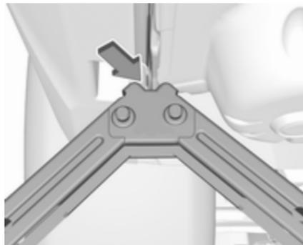
Sicherstellen, dass die Karosserie-riekante in die Kerbe am Wagenheber passt.
