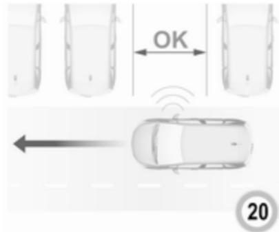
Wenn eine freie Parklücke erkannt wird, wird eine entsprechende Abbildung im Info-Display angezeigt und ein Signalton ertönt. Das Fahrzeug anhalten, den Rückwärtsgang einlegen, das Lenkrad loslassen und mit maximal 7 km/h fahren.
