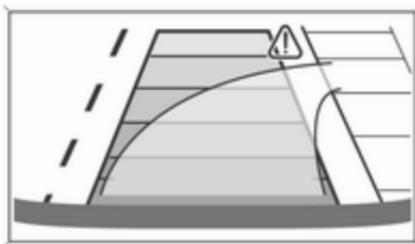
Die Fahrzeugspur wird entsprechend des Lenkwinkels angezeigt.
