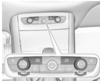
Gewünschte Temperaturvoreinstellungen für Fahrer und Beifahrer separat über linken und rechten Drehring festlegen. Über den Drehring auf der Beifahrerseite lässt sich die Temperatur für die Beifahrerseite ändern. Mit dem Drehring auf der Fahrerseite wird je nach Aktivierung der Synchronisierung **MONO** im Menü der Klimatisierungseinstellungen die Temperatur entweder nur für die Fahrerseite oder für beide Seiten geändert. Zum Öffnen des Menüs auf **MENU** drücken.
