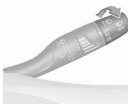
Zum Einschalten des Heckscheibenwischers die äußere Kappe drehen:
