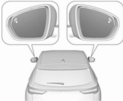
Wenn das System beim Vorwärtsfahren ein Fahrzeug im toten Winkel erkennt, leuchtet im entsprechenden Außenspiegel eine LED.
