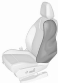
Der aufgeblähte Airbag dämpft den Aufprall, wodurch die Verletzungsgefahr für Oberkörper und Becken bei einem Seitenaufprall deutlich verringert wird.
