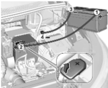
Die Pluspol Schutzkappen an beiden Fahrzeugbatterien öffnen.
