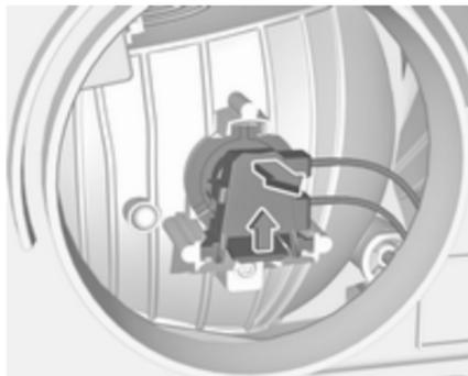
2. Die Halteklammer nach oben drücken und die Lampenfassung nach hinten ziehen.
