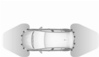
Die erweiterte Einparkhilfe ist immer mit der Front-Heck-Einparkhilfe kombiniert.
