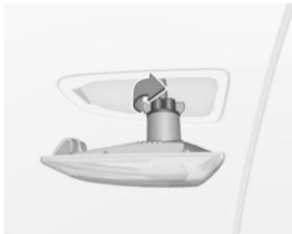
2. Lampenfassung im Uhrzeigersinn drehen, um sie aus dem Gehäuse zu entfernen.
