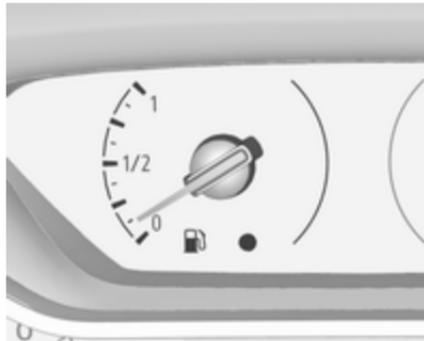
Zeigt den Füllstand im Kraftstofftank an.
