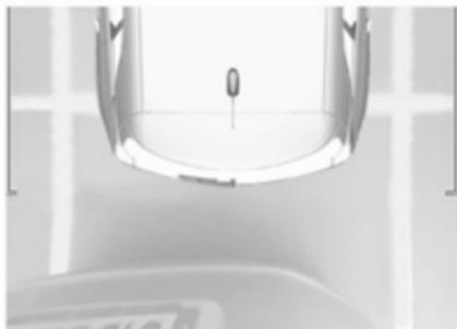
Durch Aufzeichnung der Umgebung an der Vorder- oder Rückseite des Fahrzeugs während des Manövers rekonstruiert die Kamera die Darstellung dieser Umgebung von oben. So hat der Fahrer eventuelle Hindernisse stets im Blick. Diese Ansicht ist im Automatikmodus und im Ansichtsauswahlmenü verfügbar.
