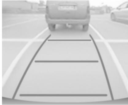
Auf dem Display wird der Bereich hinter dem Fahrzeug angezeigt. Die senkrechten Linien entsprechen der Breite des Fahrzeugs mit ausgeklappten Spiegeln. Die Ausrichtung der Linien ändert sich mit der Lenkradstellung.
