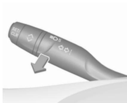
Zum Betätigen der Lichthupe den Hebel zum Lenkrad ziehen.
