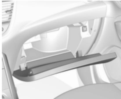
Bei einigen Versionen ist das Handschuhfach belüftet. Belüftung und Temperatur hängen von den Einstellungen des Klimatisierungssystems ab. Die Belüftungsdüse im Handschuhfach kann geschlossen werden ⇨ 138.
