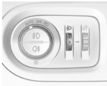
Um die Leuchtweite an die Fahrzeugbeladung anzupassen und so die Blendwirkung zu reduzieren, das Daumenrädchen  $\text{D}$  in die gewünschte Stellung drehen.
