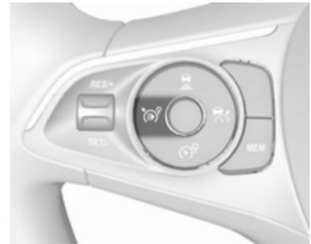
☞ drücken. Der adaptive Geschwindigkeitsregler wird in den Pausemodus versetzt und eine entsprechende Meldung wird angezeigt. Das Fahrzeug wird ohne adaptiven Geschwindigkeitsregler gefahren.
