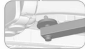
Vordere Arme der Hebebühne befinden sich mittig unter den entsprechenden Wagenheberaufnahmen.
