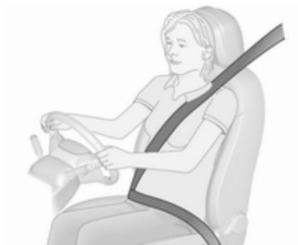
Bei starker Beschleunigung oder Verzögerung des Fahrzeugs blockieren die Sicherheitsgurte, um die Insassen in ihrer Sitzposition zu halten. Daher ist die Verletzungsgefahr deutlich geringer.
