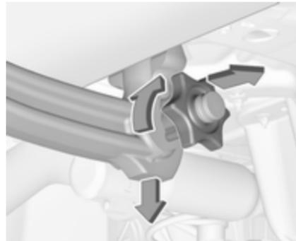
Die Schutzklappe öffnen und zum Entriegeln der Kugelstange den Schlüssel in Position
