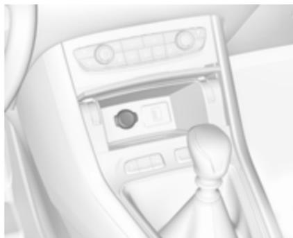
Hinter der Stauraumabdeckung befindet sich eine 12-V-Zubehörsteckdose. Zum Öffnen auf die Abdeckung drücken.
