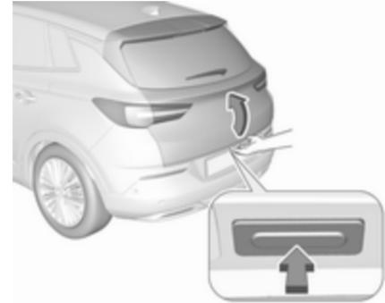
Zum Öffnen der Heckklappe die Heckklappentaste drücken, bis die Heckklappe sich zu bewegen beginnt. Wenn das Fahrzeug verriegelt ist, muss sich der elektronische Schlüssel außerhalb des Fahrzeugs in einer Entfernung von ca. 1 m zur Heckklappe befinden.
