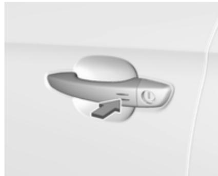
Mit einem Finger oder dem Daumen auf die Markierung an einem der Außentürgriffe oder auf die Taste an der Heckklappe drücken.
