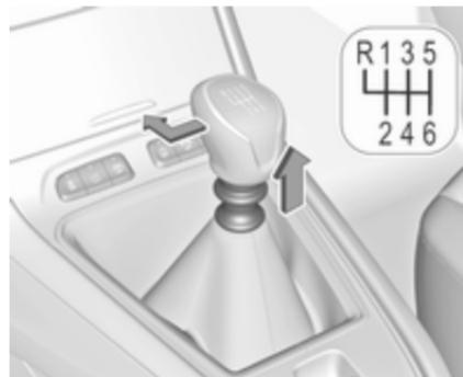
Zum Einlegen des Rückwärtsgangs beim 6-Gang-Getriebe das Kupplungspedal betätigen, den Ring unter dem Wählhebel nach oben ziehen und den Wählhebel nach links und nach vorne bewegen.
