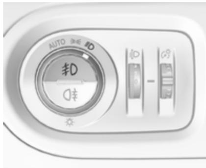
Wird durch Drücken von  $\text{D}$  bedient. Lichtschalter auf **AUTO**: Beim Einschalten der Nebelscheinwerfer werden die Scheinwerfer automatisch eingeschaltet.
