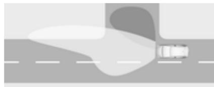
Wird bei einer Geschwindigkeit bis zu 40 km/h beim Abbiegen aktiviert. Das Licht stammt von besonderen LEDs, die den Weg in Fahrtrichtung ausleuchten. Diese LEDs werden abhängig vom Lenkwinkel und von der Aktivierung der Blinker ausgelöst.
