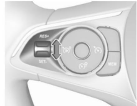
Auf die gewünschte Geschwindigkeit beschleunigen und das Daumenrädchen einmal kurz auf **SET/-** bewegen. Die aktuelle Geschwindigkeit wird als Höchstgeschwindigkeit gespeichert.
