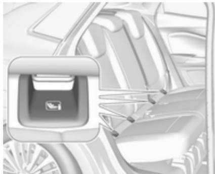
Für das Fahrzeug zugelassene ISOFIX-Kindersicherheitssysteme an ISOFIX-Befestigungshalterungen befestigen. Die speziellen Positionen für ISOFIX-Kindersicherheitssysteme sind in der Tabelle mit ISOFIX gekennzeichnet ↻ 67.
