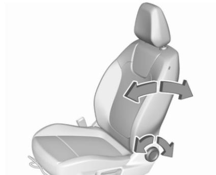
Handrad drehen. Zum Einstellen Rückenlehne entlasten.
