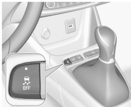
ESC und Traktionskontrolle können im Bedarfsfall durch Drücken auf
