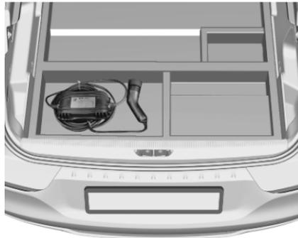
3. Die Heckklappe öffnen. Die Bodenabdeckung anheben und das Ladekabel entnehmen.
