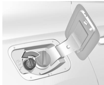
4. Die Schutzkappe vom Einfüllstutzen abschrauben.
