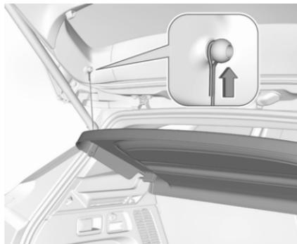
Haltebänder von Heckklappe lösen.
