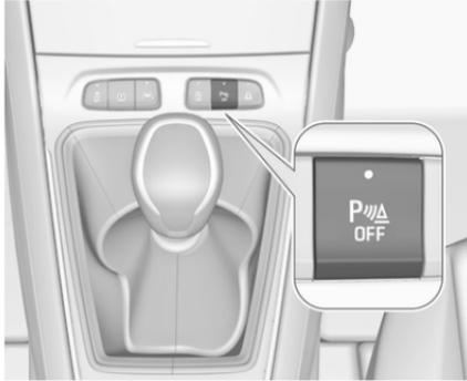
Beim Ausrücken des Rückwärtsgangs wird das System ausgeschaltet. Auf
