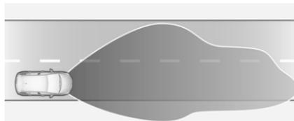
Wird bei einer Geschwindigkeit über 115 km/h automatisch aktiviert. Die Leuchtwerte werden an die höhere Autobahngeschwindigkeit angepasst. Ohne Gegenverkehr wird die Sicht
