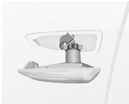
2. Lampenfassung rechtsherum drehen und aus der Leuchteneinheit entfernen.
