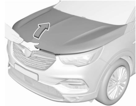
Schnappriegel hochdrücken und Motorhaube öffnen.
