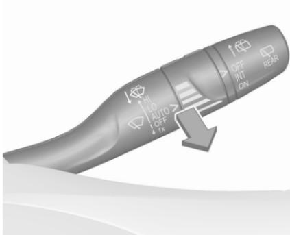
Hebel ziehen. Waschflüssigkeit spritzt auf die Windschutzscheibe und der Wischer wird für einige Wischbewegungen eingeschaltet. Waschflüssigkeit ↗ 225.
