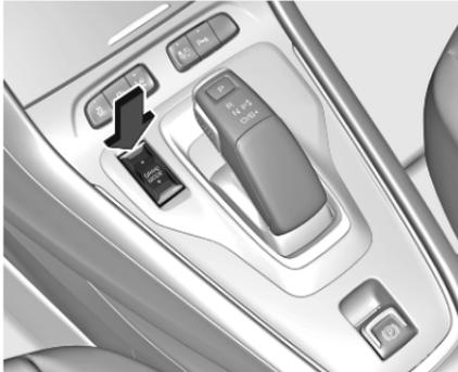
Der Allradmodus wird über den Fahrmoduswechsler aktiviert. Die Aktivierung wird im Fahrerinfodisplay und im Info-Display angezeigt.
