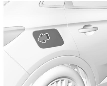
Die Tankklappe lässt sich nur bei entriegeltem Fahrzeug öffnen. Die Tankklappe durch Drücken der Klappe öffnen.
