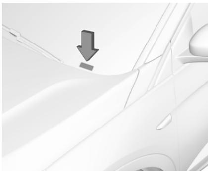
Die Fahrzeug-Identifizierungsnummer kann in der Instrumententafel, durch die Windschutzscheibe sichtbar, oder im Motorraum am rechten Karosserieblech eingestanz sein.
