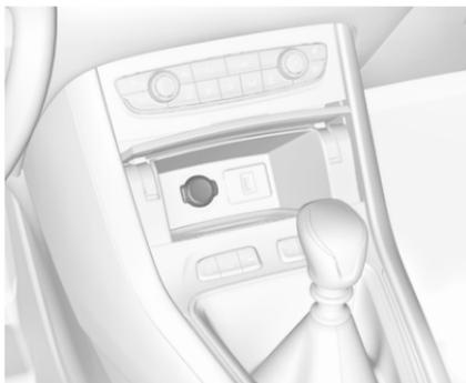
Hinter der Abdeckung des Stauraums befindet sich eine 12-V-Steckdose. Zum Öffnen auf die Abdeckung drücken.
