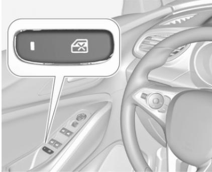
Zur Deaktivierung der elektrischen Fensterheber der hinteren Türen
