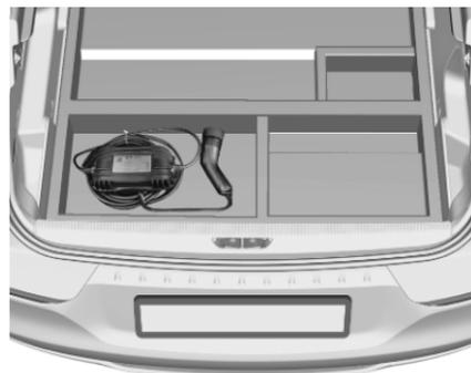
Ein tragbares Ladekabel zum Laden der Hochvoltbatterie des Fahrzeugs ist unter der Bodenabdeckung im Laderaum verstaut ↗ 202. Das Ladekabel ist mit Haushaltssteckdosen des betreffenden Lands kompatibel. Es verfügt über ein Kontrollgerät mit Ladestatus-Kontrollleuchten.
