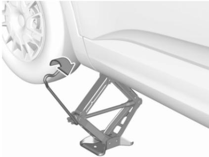
Radschlüssel bei korrekt ausgerichtetem Wagenheber drehen, bis das Rad vom Boden abhebt.
