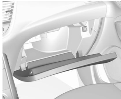
Bei einigen Versionen ist das Handschuhfach belüftet. Belüftung und Temperatur sind von den Einstellungen der Klimaanlage abhängig. Die Belüftungsdüse im Handschuhfach kann geschlossen werden ↷ 134.
