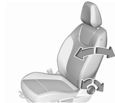
Handrad drehen. Zum Einstellen Rückenlehne entlasten.
