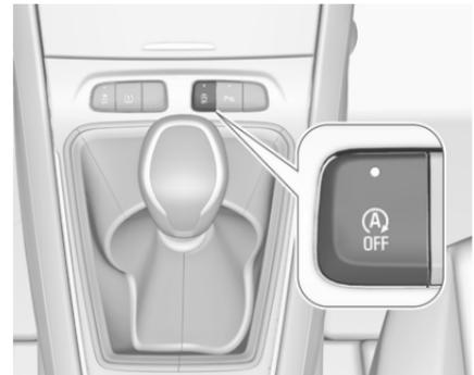
Die Stopp-Start-Automatik lässt sich durch Drücken von
