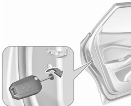
Zum Verriegeln der anderen Türen die schwarze Abdeckung mit einem Schlüssel entfernen.
