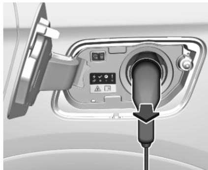
2. Den Fahrzeugstecker innerhalb von 30 Sekunden vom Ladeanschluss trennen.
