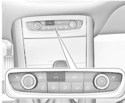
**A/C** drücken, um die Kühlung einzuschalten. Die LED in der Taste leuchtet auf, um die Aktivierung anzuzeigen. Die Kühlung funktioniert nur bei laufendem Motor und eingeschaltetem Gebläse.
