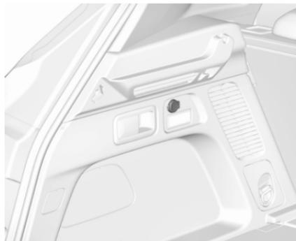
Eine weitere 12-V-Steckdose befindet sich an der linken Seitenwand des Laderaums.
