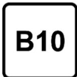
Diesekraftstoff gemäß der Norm EN16734, gemischt mit einem Biokraftstoff gemäß der Norm EN14214 (mit bis zu 10 % Fettsäuremethylester).
