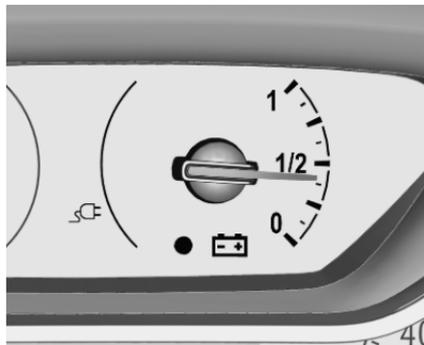
Die Batterieanzeige zeigt den Ladezustand der Hochvoltbatterie an.
