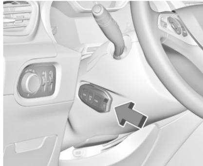
Elektronischen Schlüssel wie in der Abbildung gezeigt mit den Tasten nach außen an die Markierung an der Lenksäulenabdeckung halten.
