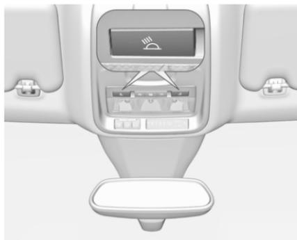
Die Bedienung erfolgt durch Drücken auf ☀️ und ☀️ an den Innenleuchten.
