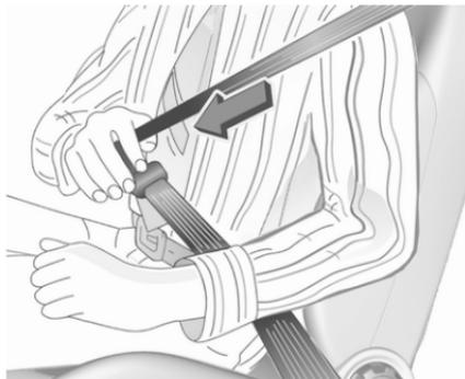
Den Sicherheitsgurt aus dem Aufroller herausziehen, unverdreht über den Körper legen und die Schloßzunge in das Gurtschloß einführen, bis sie einrastet. Sicherstellen, dass der Gurt während der Fahrt eng am Körper anliegt.
