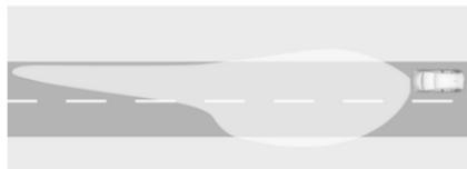
Wird beim Fahren in ländlichen Gebieten automatisch bei Geschwindigkeiten zwischen 55 und 115 km/h aktiviert. Die eigene Fahrbahn und deren Rand werden besser ausgeleuchtet. Entgegenkommende und vorausfahrende Fahrzeuge werden nicht geblendet.
