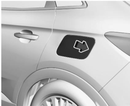
2. Auf die hintere Kante der Ladeanschlussklappe drücken und wieder loslassen, um die Klappe zu öffnen.
