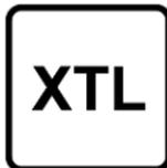
Paraffinischer Diesekraftstoff gemäß der Norm EN15940, gemischt mit einem Biokraftstoff gemäß der Norm EN14214 (mit bis zu 7 % Fettsäuremethylester).
