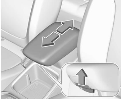
Die Armlehne kann um 10 cm nach vorne verschoben werden. Zum Verschieben der Armlehne am Griff ziehen. Unter der Armlehne befindet sich ein Ablagefach.
