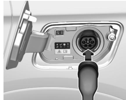
5. Den Fahrzeugstecker des Ladekabels am Ladeanschluss des Fahrzeugs anschließen.
