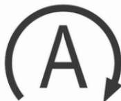
Ein Autostopp wird durch die Kontrollleuchte (A) angezeigt.
