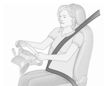
Sicherheitsgurt herausziehen und im Gurtschloss einrasten lassen. Der Sicherheitsgurt muss unverdreht und eng am Körper anliegen. Die Rückenlehne darf nicht zu weit nach hinten geneigt sein (maximal ca. 25°).
