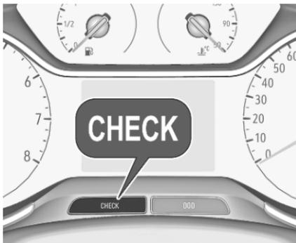
Der Status der Serviceinformationen kann jederzeit durch Drücken auf die Taste **CHECK** abgerufen werden. Die Serviceinformationen werden einige Sekunden lang angezeigt.
