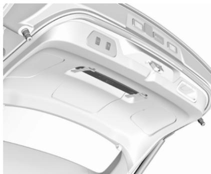
Warndreieck im Fach innen an der Heckklappe verstauen und mit dem Klettband sichern.
