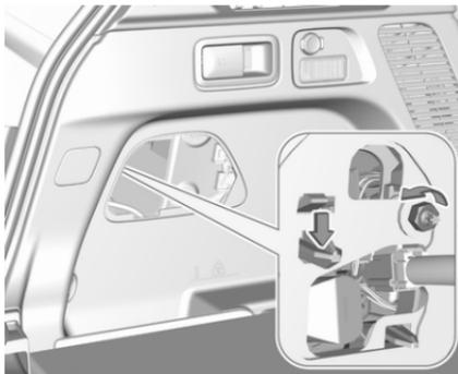
2. Die Leuchtenbefestigungsmutter mit einem Steckschlüssel lösen. Zunächst ein Tuch unter die Mutter legen um zu verhindern, dass sie in die Flügelverkleidung fällt.
