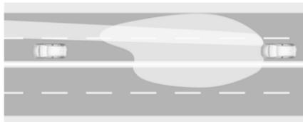
Bei Fahrzeugen mit Uplevel-LED-Scheinwerfern umfasst der Fernlichtassistent einen besonderen Auto-bahnmodus. Wird auf Autobahnen schneller als 115 km/h gefahren, verkleinert sich der Lichtstrahl, damit der entgegenkommende Verkehr nicht geblendet wird. Bei vorausfahr-
