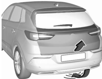
Zum Öffnen oder Schließen der Heckklappe den Fuß im Bereich des Kennzeichenschildes vor und zurück bewegen. Den Fuß nicht zu lange unter dem Heckstoßfänger halten und nicht zu langsam bewegen. Der elektronische Schlüssel muss sich außerhalb des Fahrzeugs in einem Umkreis von ca. 1 m um die Heckklappe befinden.
