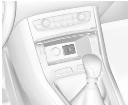
Hinter der Abdeckung des Stauraums befindet sich ein USB-Anschluss. Zum Öffnen auf die Abdeckung drücken.
