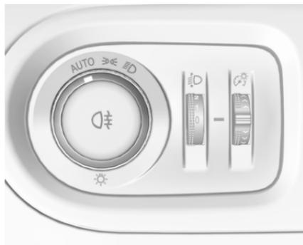
**AUTO** : Automatische Lichtsteuerung, schaltet automatisch zwischen Tagfahr- und Abblendlicht um
