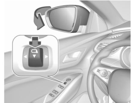
Die Spiegeltaste nach hinten ziehen. Beide Außenspiegel werden eingeklapt.
