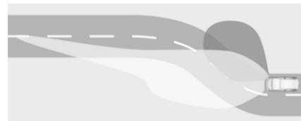
Je nach Lenkwinkel und Geschwindigkeit werden spezielle LED zusätzlich eingeschaltet, um in Kurven das Scheinwerferlicht zu verbessern. Diese Funktion ist bei einer Geschwindigkeit zwischen 40 und 70 km/h aktiviert.
