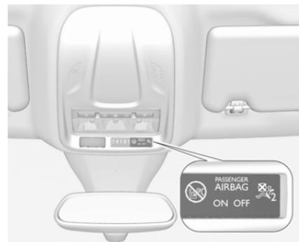
Wenn die Kontrollleuchte
